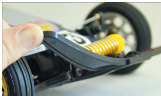
Der Frontrammer ist aus extrem flexiblem Plastik gefertigt und steckt Unfälle sehr gut weg
