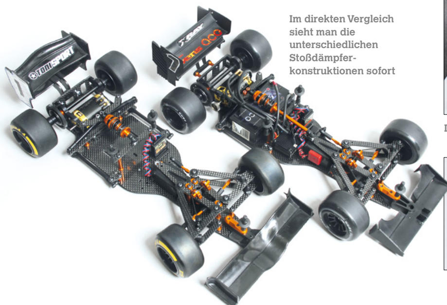
Der Stoßdämpfer kann nun deutlich verlängert werden, je nach Bedarf der Strecke
