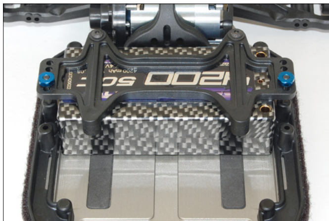
Der weit hinten sitzende Motor des B6D ermöglicht eine ebenfalls hecklastige Platzierung des Shorty-Akkus
