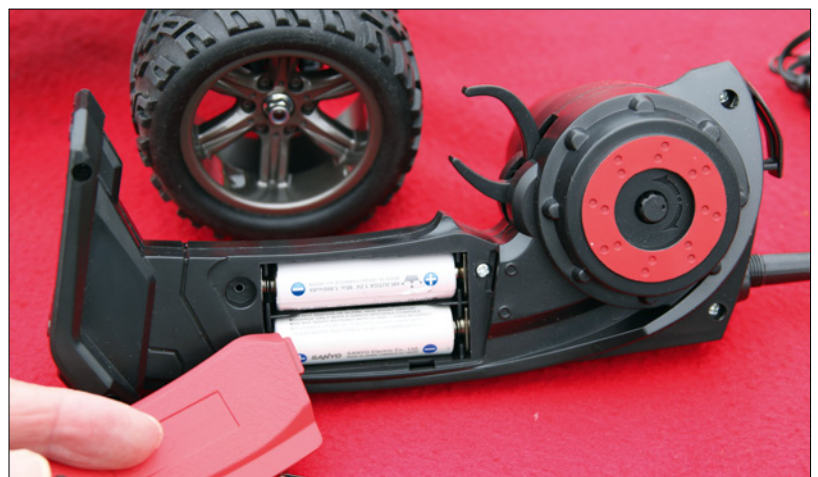
Durch Lösen einer kleinen Schraube ist der Batteriedeckel am Sender entfernt, um Akkus oder Batterien einzusetzen
