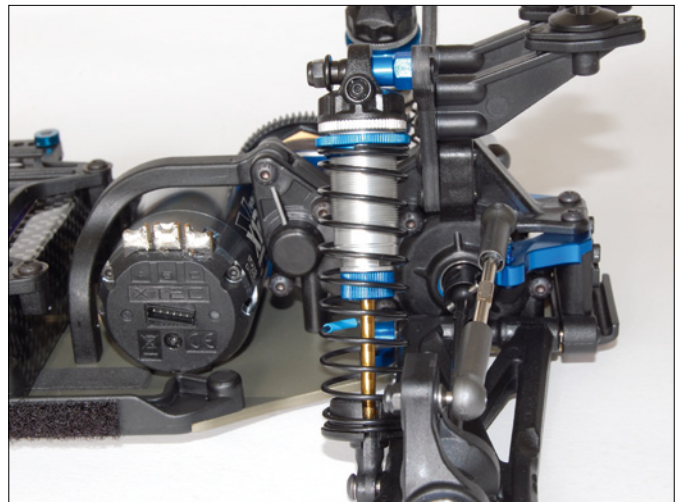
Heckfedern B6 Blau, Härtegrad 2,3. Stoßdämpfer in Fahrtrichtung vorne an der Dämpferbrücke. Dämpferbrücke in Fahrtrichtung vorne am Dämpferbrückenhalter. Dämpfer und Dämpferbrücke können auch nach hinten versetzt werden
