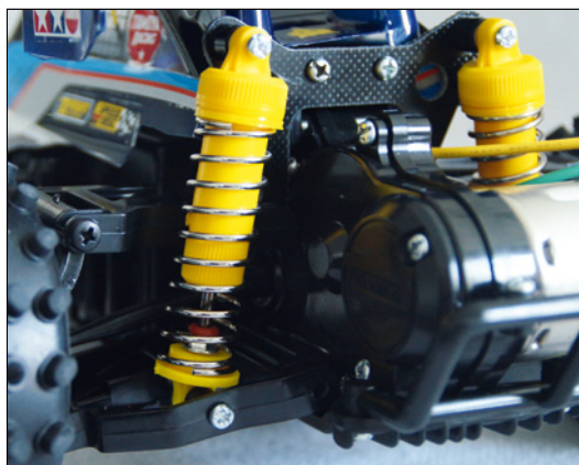
Die Hinterachse wird von zwei klassisch montierten CVA-Stoßdämpfern beruhigt
