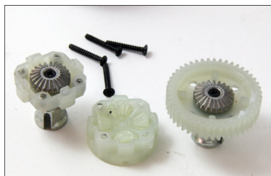
Das Differenzial von MT12 und DT12 von innen. Es verfügt über Kugellager für wenig Widerstand
