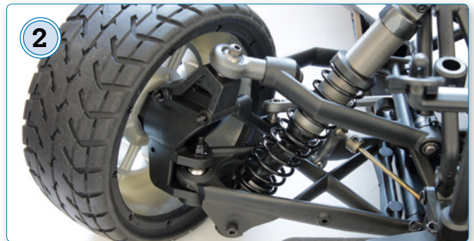
2 Das Fahrwerk ist vom Baja-Buggy übernommen. Lediglich die Federn fallen kürzer aus, damit das Chassis tiefer liegt
