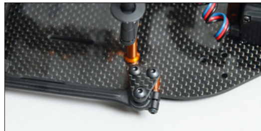
Die neue Halterung der Links ermöglicht den Einsatz von Unterlegscheiben
