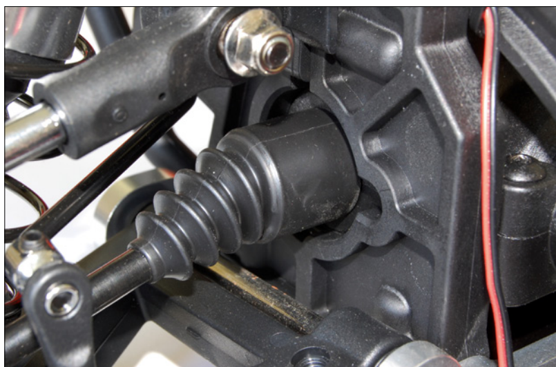
Die Kugelköpfe und Gelenke der Antriebswellen wurden werkseitig gefettet. Um Sand und Schmutz fernzuhalten, hat man ihnen Gummibälle übergestülpt
