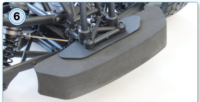
6 Neu am Onroader: Der Frontrammer aus Schaumstoff
