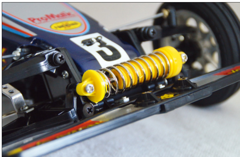
An der Vorderachse verrichtet ein CVA-Öldruckstoßdämpfer als Monoshock seinen Dienst
