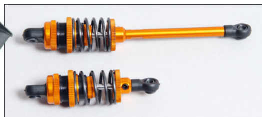
Der Stoßdämpfer kann nun deutlich verlängert werden, je nach Bedarf der Strecke
