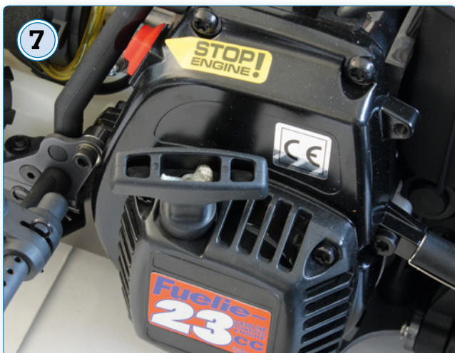
7 Der 23-Kubikzentimeter-Fuelie-Motor sitzt an gewohnter Stelle im Chassis
