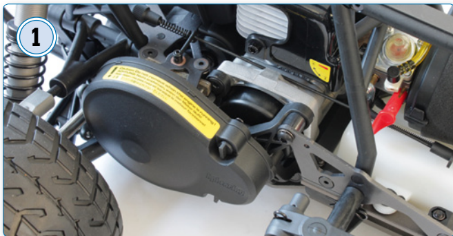
1 Über das Vorgelege lässt sich die Übersetzung verändern. Ebenfalls ist hier die Scheibenbremse zu finden
