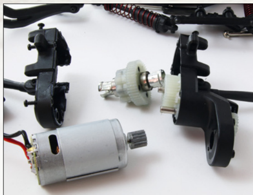
Nach etwas Schraubarbeit ist das Heck zerlegt. Getriebegehäuse, Differenzial und Motor bilden eine Einheit
