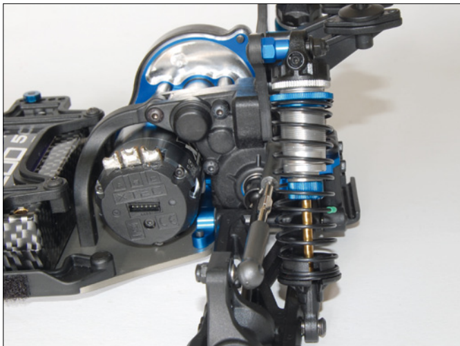
Heckfedern B6D Grün, Härtegrad 2,0. Stoßdämpfer in Fahrtrichtung hinter der Dämpferbrücke. Dämpferbrücke in Fahrtrichtung hinten am Dämpferbrückenhalter
