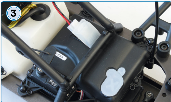
3 Die spritzwassergeschützte RC-Box beinhaltet neben dem Empfänger auch den Akku. Dank des Tamiya-Anschlusses kann man letzteren auch von außen laden
