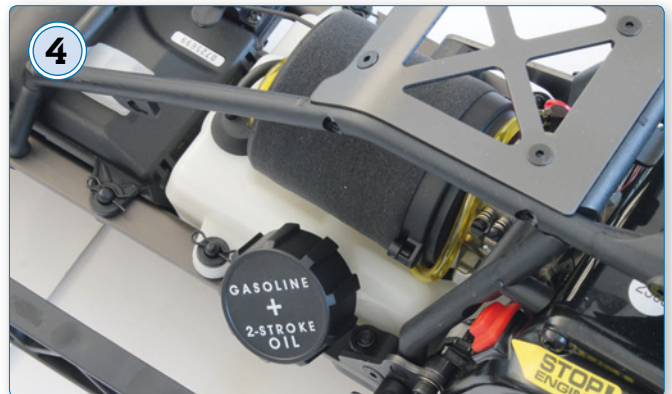
4 Zum Tanken muss die Karosserie runter. Tank, Luftfilter und Vergaser sind von den Offroad-Brüdern bekannt
