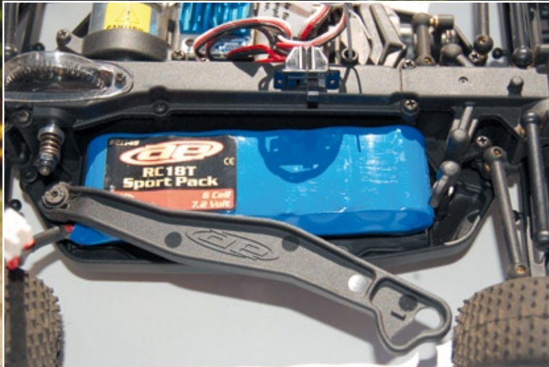
Beide Mini-Racer verfügen über das neue Akkuschnellwechselsystem
