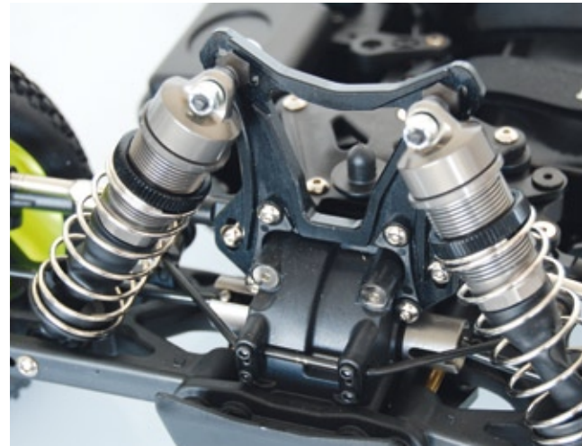
Die vier Bigborestoßdämpfer schlucken alle Stöße souverän
