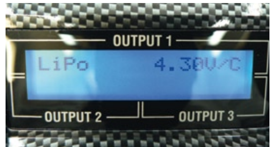
Leider ermöglicht das Menü ein Laden auf 4,3 Volt pro Zelle bei LiPos. Dies ist jedoch bereits ein schädlicher Bereich für die Zellen, besser sind maximal 4,22 Volt
