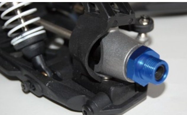
C-Hub-Lenkung und Lenkhebel aus gegossenem Aluminium sind Teil der Vorderachse
