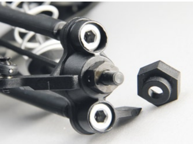
Unter den 17-Millimeter-Sechskantminehmern befinden sich Standard-12-Millimeter-Mitnehmer, sodass unterschiedliche Felgenformate montiert werden können
