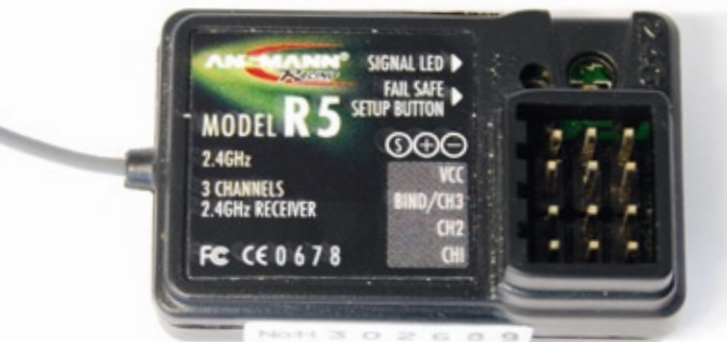
Der kleine Dreikanalempfänger mit der Bezeichnung R5 wiegt gerade einmal 5 Gramm
