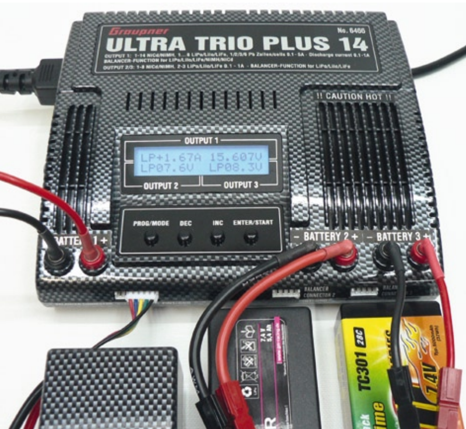
Gut ausgelastet wird das Gerät beim Laden eines 4s- und zwei 2s-Akkus. Hier darf die Ladeleistung für alle drei Ausgänge 50 Watt nicht übersteigen
