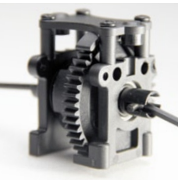
Etwas untypisch für einen Monstertruck verfügt der DMT VE über ein Mitteldiff. Dadurch sind leider keine Wheellys möglich
