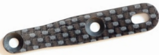
Auf diesem kleinen Carbonteil sitzt später das Servo
