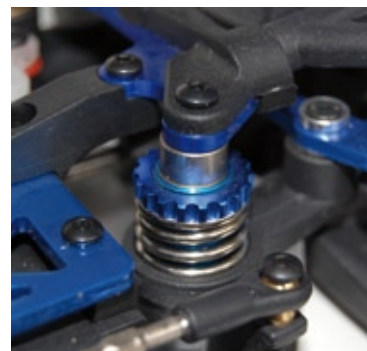
Ein einstellbarer Servosaver schützt das Lenkservo vor Belastungsspitzen
