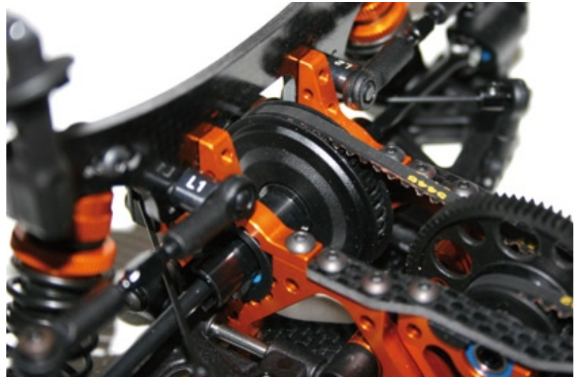
Achsschenkel, Lenkhebel und C-Hubs kommen in der bewährten Geometrie
