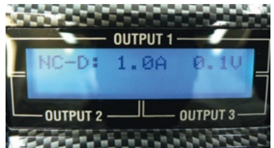
Im NiCd-Programm können die Packs sogar auf bis zu 0,1 Volt entladen werden. Man sollte unbedingt darauf achten, in dieser Einstellung nur einzelne Zellen zu nutzen
