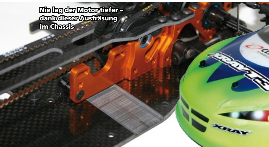
Die Alu-Sechskant-Aufnahmen werden mit einer Klemmung fixiert
