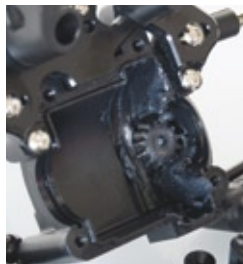
Gut geschmiert: das Kegelzahnrad, das das Differential antreibt
