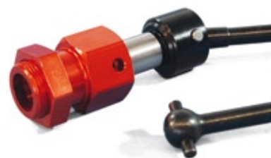
CVD-Wellen sorgen für die Kraftübertragung vom Diff zu den Rädern. Die Zentralwelle besteht aus einzelnen Knochen
