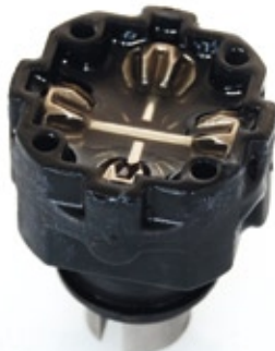
Im mittleren und vorderen Differential brems 5.000er-Silikonöl die Vierspiderdiffs
