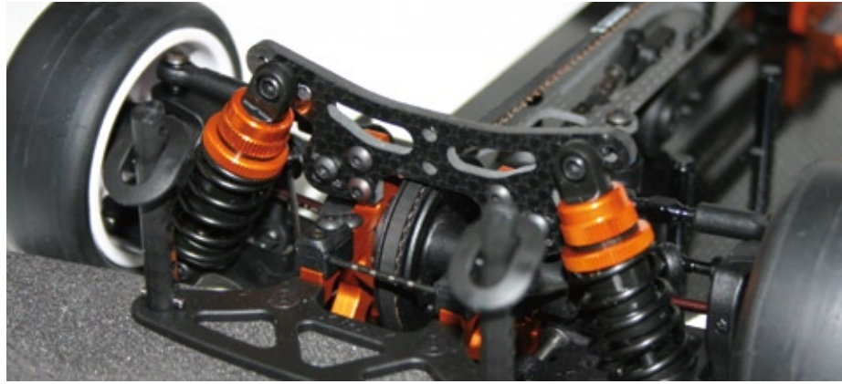
Die Dämpferbrücken sind aus 3 Millimeter starkem Carbon gefertigt
