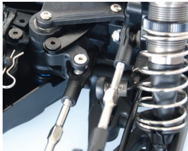
Der Ackermannwinkel und die Lenkgeometrie passen auf Antrieb
