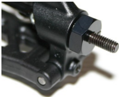
Die Alu-Sechskant-Aufnahmen werden mit einer Klemmung fixiert
