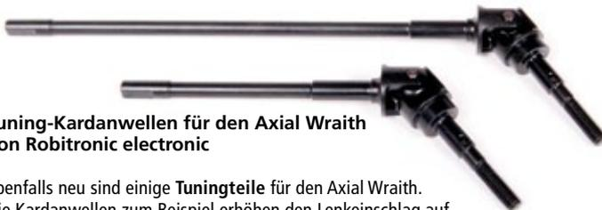
**Tuning-Kardanwellen für den Axial Wraith von Robitronic electronic**
