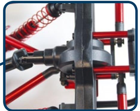
In den Starrachsen sind Stahl-Kegelraddifferenziale verbaut. Diese sichern den Allradantrieb des Low Rider
