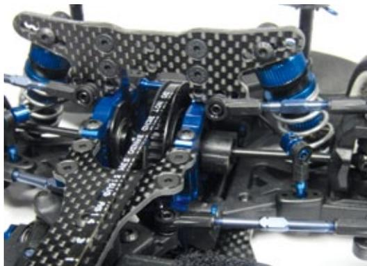
An beiden Dämpferbrücken finden sich Unmengen an Dämpferpositionen, was das Abstimmen des Fahrwerks für jede Strecke ermöglicht
