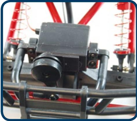
Ein stellstarkes Servo sorgt an der Vorderachse für die Umsetzung der Lenkbefehle
