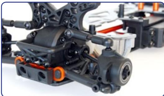
Die unteren Querlenker der Hinterachse lassen sich auch umgedreht montieren. So ist eine Spurweite zwischen 210 und 225 Millimeter einstellbar
