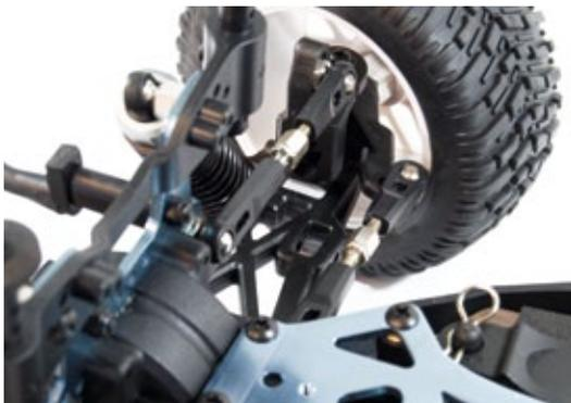
Das Lenkgestänge und die oberen Querlenker sind als Gewindestangen ausgelegt, über die sich das Setup anpassen lässt
