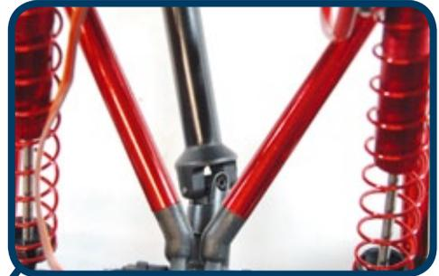
Teleskopantriebswellen dienen zur Übertragung der Motorkraft an die Achsen
