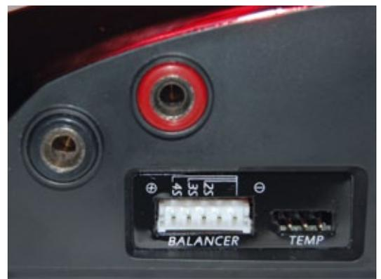
**4-Millimeter-Buchsen repräsentieren das gängige Maß an der Ausgangsseite. Per EHR-Stecker können LiXX-Zellen bis zur 4s-Konfiguration verarbeitet werden**
