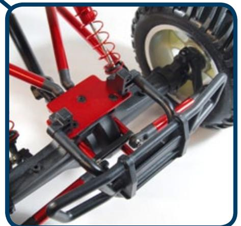
An der Hinterachse sind ebenfalls Lenkhebel verbaut. Stangen, die mit diesen und der Achse verbunden sind, halten die Räder in Position
