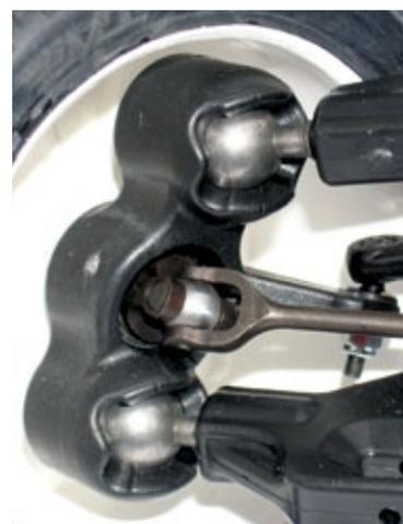
**Massive Kugeln an der Pivotball-Vorderachse sorgen für Stabilität, großzügige Ausformungen in den Lenkhebeln für maximale Lenkausschläge**
