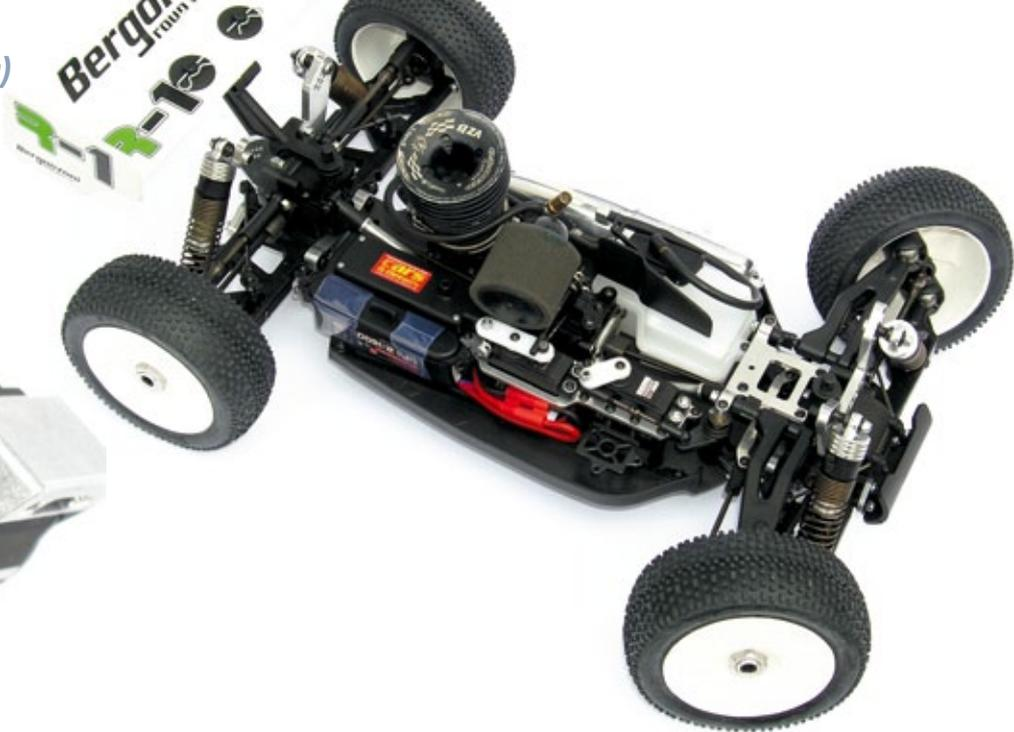
Eine Besonderheit des Bergonzoni R-1 ist die Zweibackenkupplung, die bei Wärmeentwicklung leider etwas zu früh einkuppelt
