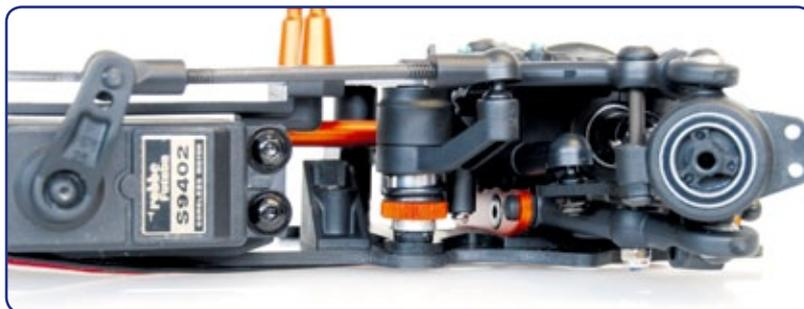
Das Lenkservo wird liegend eingebaut. Verwendet man ein so genanntes Low-Profile-Servo, kann es auch stehend verschraubt werden. Die Lenkpfosten sind doppelt Kugelgelagert und mit einem Servosaver ausgestattet
