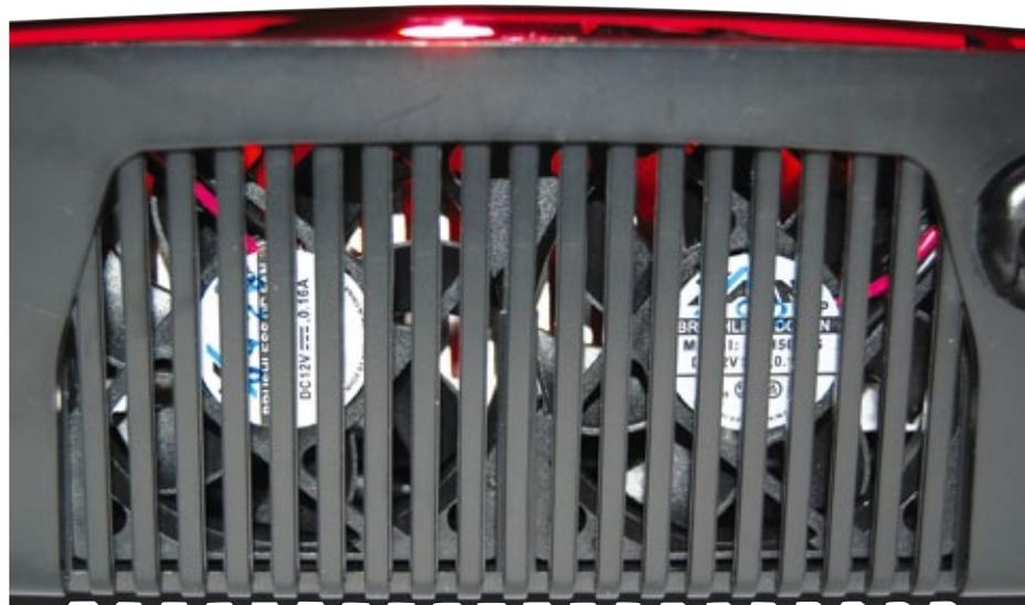
Zwei große aktive Lüfter schaufeln Arbeitswärme aus dem Gehäuse
