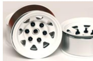
Die RC4WD-Beadlockfelgen sind aus Stahl gefertigt und passen wie die Faust aufs Auge
