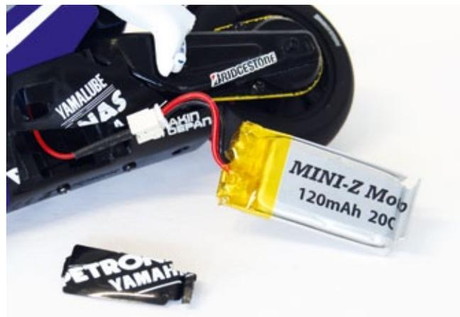
Der 120-Milliamperestunden-LiPo wird seitlich in die Verkleidung geschoben. Die Fahrzeit liegt damit bei rund fünf Minuten
