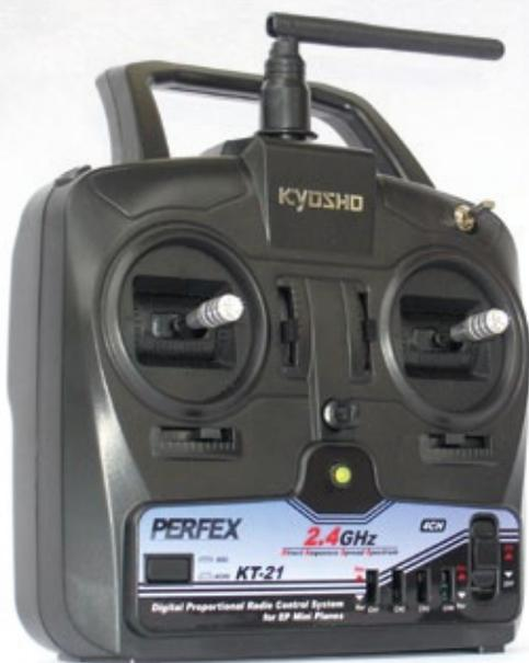
Für volle Kontrolle der beiden Antriebsmotoren und der absenkbaren Schneeschaukel muss ein robuster Knüppelsender her, der neben der 2,4-Gigahertz-Modulation auch über die wichtigsten Feintrimmmöglichkeiten verfügt und bei Bedarf auch als Simulatorsender verwendet werden kann
