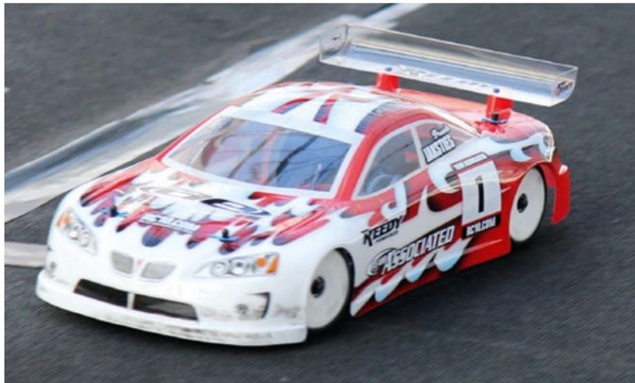
Durch die relativ weichen, silbernen Federn neigt sich der Tourenwagen in Kurven sehr stark um die Längsachse. Abhilfe schafft hier der Einbau härterer Federn
