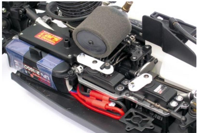
Auf der Elektronikseite rücken die Komponenten wie die RC-Box und die stehend montierten Servos auf der RC-Platine sehr nah an die Chassismitte heran
