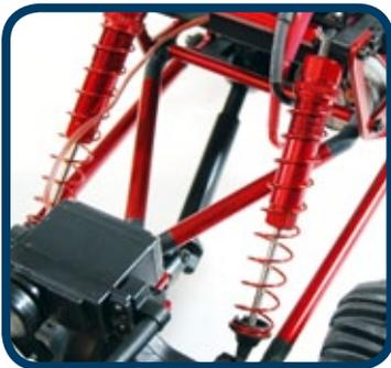
Vier lange, einstellbare und bereits befüllte Aluminium-Öldruckstoßdämpfer sorgen für Federung und eine gute Verschränkung im Gelände
