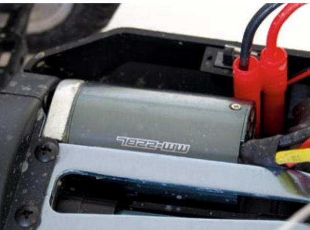
Der MM-22BL-Motor im Strada Evo S leistet 3.215 Umdrehungen pro Minute und Volt. Er ist bereits ab Werk mit dem Regler verbunden und auch das Zahnflankenspiel zwischen Ritzel und Hauptzahnrad bedurfte keiner Korrektur
