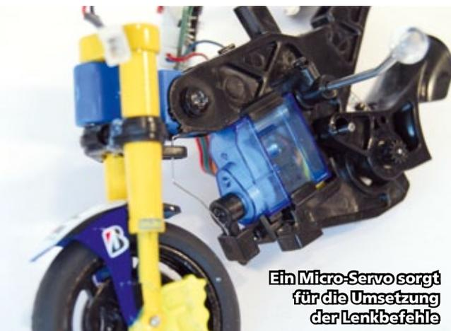
Ein Micro-Servo sorgt für die Umsetzung der Lenkbefehle
