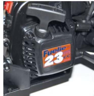
Im Gegensatz zu den Seilzugstartern der Nitro-Motoren sind entsprechende Umsetzungen an Großmodellen in der Regel deutlich solider. Sofern man sie vor eindringendem Sand schützt, gibt es kaum Probleme
