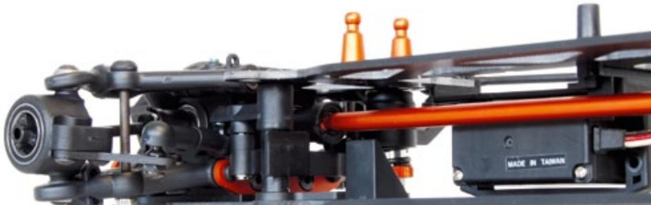
Die Kardanwelle zur Vorderachse besteht aus Orange eloxiertem Aluminium. In diesem Freiraum wird später der Akku fixiert
