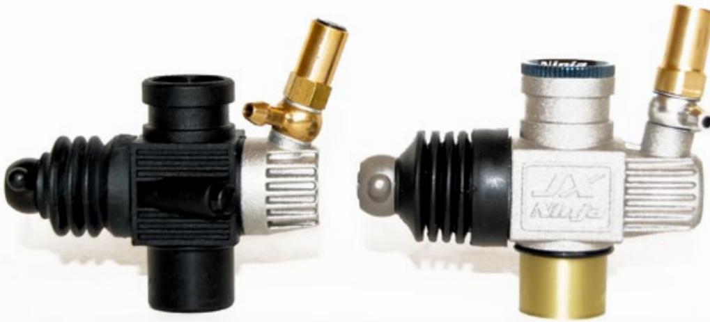
Zwei Wege, ein Ziel: Zur thermischen Abschirmung wurde der linke Vergaserkörper vollständig aus Komposit gefertigt, rechts kommt eine entsprechende Buchse zum Einsatz. Zugegeben, beide Vergaser stammen aus Wettbewerbs-Triebwerken, aber einige RTR-Modelle können Entsprechendes aufbieten. Ein genauer Blick lohnt also
