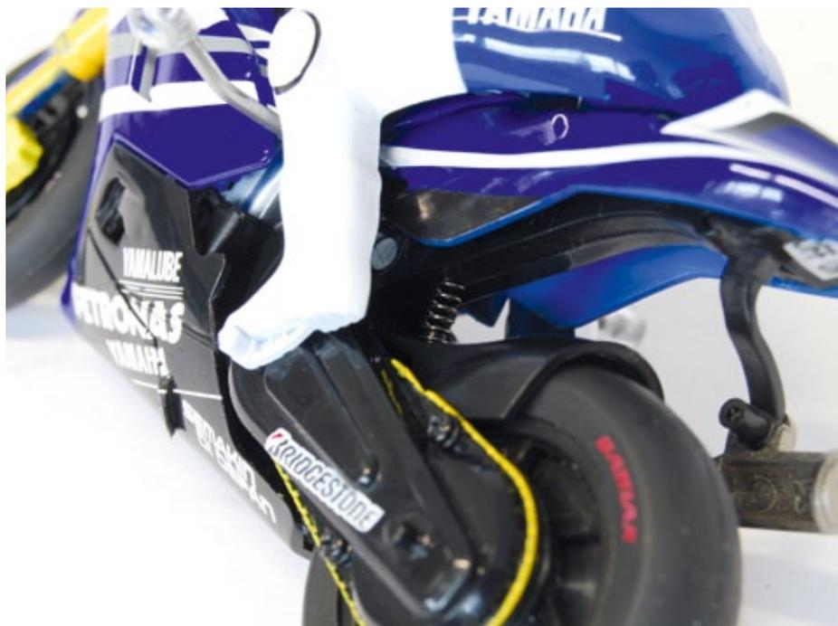
Ein kleines Servo sorgt für die Umsetzung der Lenkbefehle. Es greift mit einem flexiblen Federstahldraht an der Gabel in ein großzügig bemessenes Langloch. Werkseitig ist hier alles fertig eingestellt und motorradtypisch scheint das Rad in die falsche Richtung auszuschlagen, was aber natürlich bei RC-Bikes normal ist.
