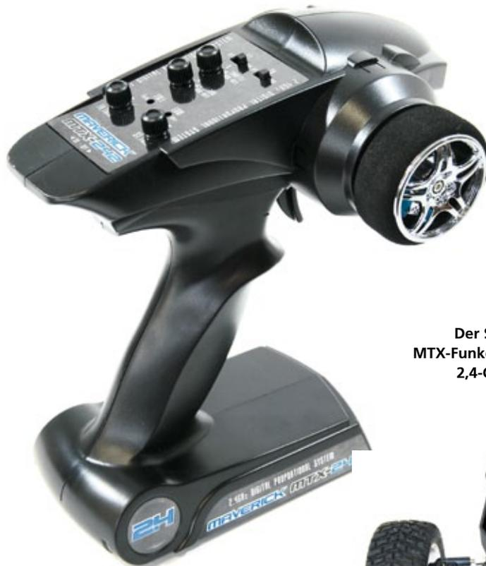
Der SC Evo S wird mit einer Maverick MTX-Funke ausgeliefert. Diese arbeitet mit 2,4-Gigahertz-Technik und bietet alle erforderlichen Einstelloptionen
