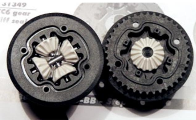
Das hintere Differenzial verfügt über extrem leichte Komponenten, die in Silikonöl laufen. Abgedichtet wird das Ganze mit einem Formring
