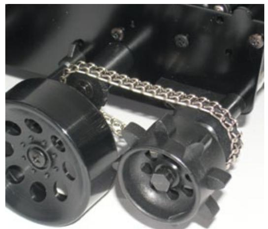
Für den eigentlichen Kraftschluss zwischen Getriebe und Raupenbändern sorgen zwei kleine Leiterketten, die die Kraft der Antriebsmotoren an das verzahnte Antriebsrad (rechts im Bild) der Raupenbänder weitergeben
