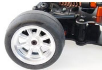
Die Radsätze liegen dem Bausatz bei. Sie müssen noch montiert werden: Einlagen zusammenfügen und die Reifen auf den Felgen verkleben
