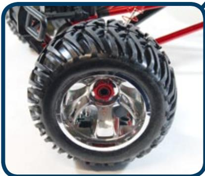
Für den Vortrieb auf der Offroad-Piste und in steinigem Gelände sorgen die grobstolligen Pneu, die auf verchromten Felgen verklebt sind
