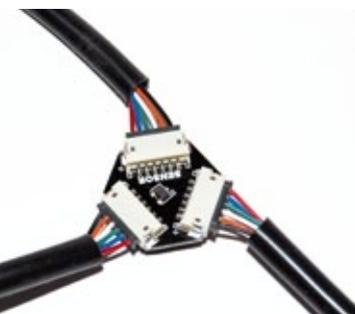
Der Sensorsplitter zur Überprüfung von sensorbasierten Brushless-Systemen ist zusammen mit seiner Verkabelung bereits im Lieferumfang enthalten
