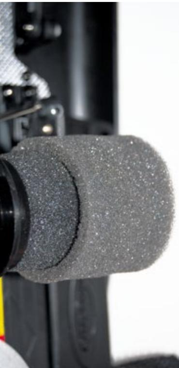
Ist ein Schaumstoff-Luftfilter – in diesem Fall das innere Element – ab Werk nicht mit Öl versehen worden, muss unbedingt vor der ersten Fahrt nachgebessert werden
