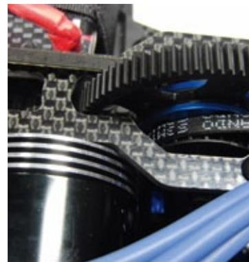
Das Topdeck stößt bei gewissen Motoren an deren Gehäuse. Das kleinste Ritzel zählt hier schon 23 Zähne und ist nur für große Strecken zu empfehlen
