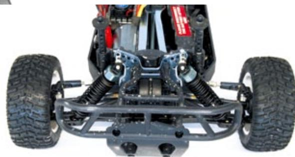
Sowohl an der Hinterachse ist wie auch vorne ein großer Rammer verbaut. Dieser schützt die Karosserie und das verwindungssteife Wannenchassis bei Crashes vor Beschädigungen
