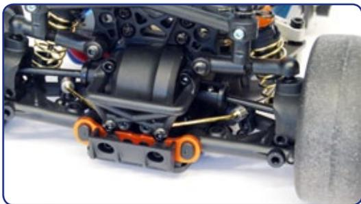
Stabilisatoren helfen, die Wankbewegung in Kurven zu minimieren. Auch der Cup Racer profitiert hiervon
