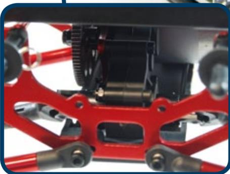
Die Seitenplatten des Low Rider bestehen aus eloxiertem Aluminium. An diesen sind die äußeren Links befestigt. Zwischen den Platten, unter dem Oberdeck befindet sich das Getriebe samt Motor
