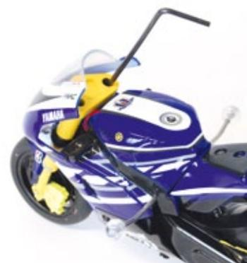
Die Höhe der Vorderradgabel lässt sich über zwei Inbuschrauben stufenlos verstellen
