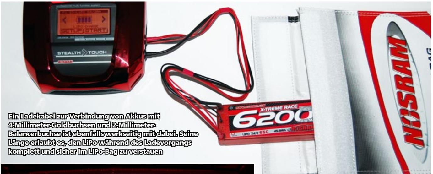
Ein Ladekabel zur Verbindung von Akkus mit 4-Millimeter-Goldbuchsen und 2-Millimeter-Balancerbuchse ist ebenfalls werkseitig mit dabei. Seine Länge erlaubt es, den LiPo während des Ladevorgangs komplett und sicher im LiPo-Bag zu verstauen
