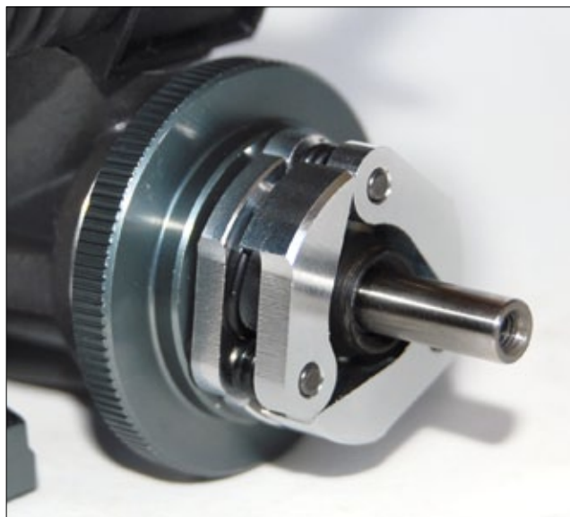
Kupplungen mit drei separaten Backen – in diesem Fall aus Aluminium – stellen die wohl am weitesten verbreitete Bauweise dar
