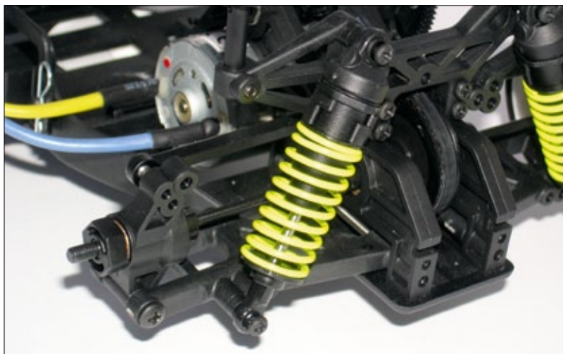
An der Hinterachse des TS2e werkeln lange Doppelquerlenker und sorgen mit den Öldruckstoßdämpfern für satten Bodenkontakt
