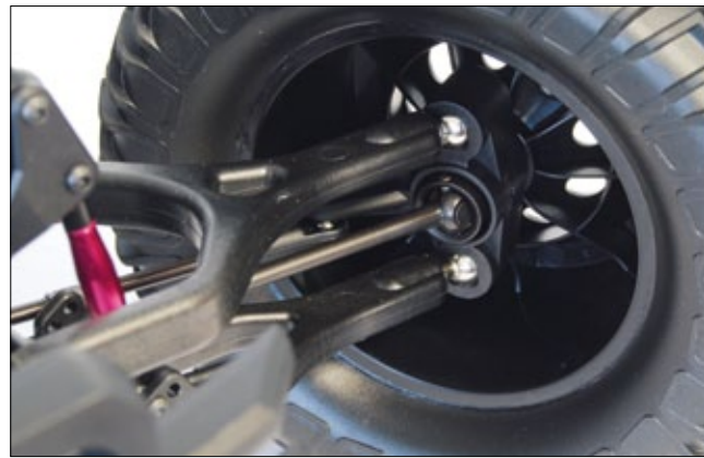
CVD-Antriebswellen und Pivot-Ball-Aufhängungen zeichnen die soliden Achsen aus
