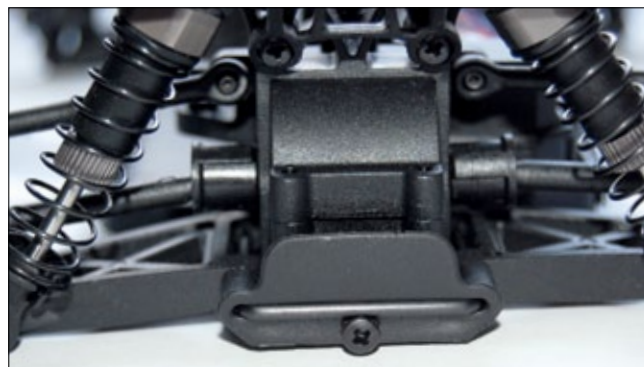
Im Inneren der Achsen werkeln Kegelrad-Differenziale
