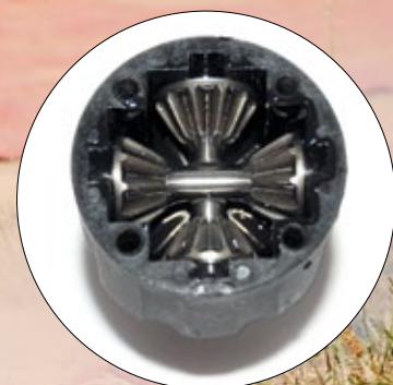
Kegelrad-Differenziale werden durch die Befüllung mit unterschiedlichen Silikonölen mehr oder weniger stark gesperrt
