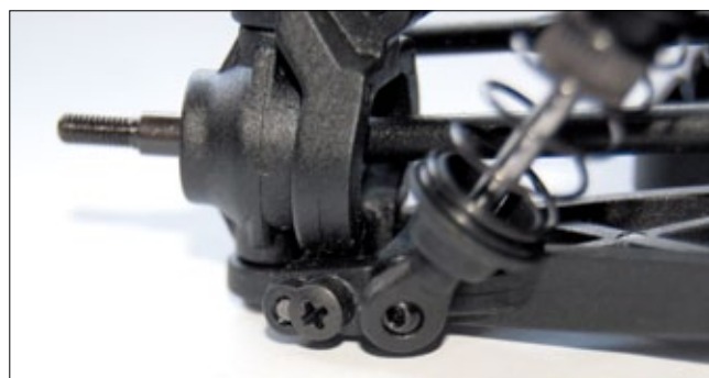
Sehr loblich: Maverick setzt auch weiterhin auf Modelle ohne E-Klipse. So wird der Hinge-Pin des Radträgers mit Schrauben gesichert
