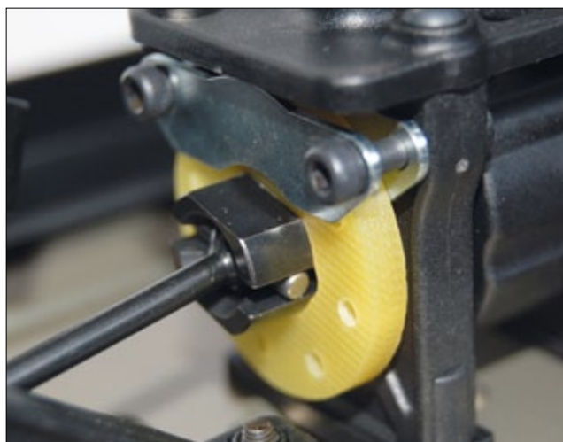
Bevorzugt bei Verbrenner-Modellen sorgen mechanische Bremsen für Verzögerung
