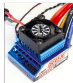
Der SPX Brushless Bullet Regler in Kombination mit einem 4,5 Turns Vector X12 Brushless Modified-Motor macht aus dem Blast TC ein regelrechtes Geschoss
