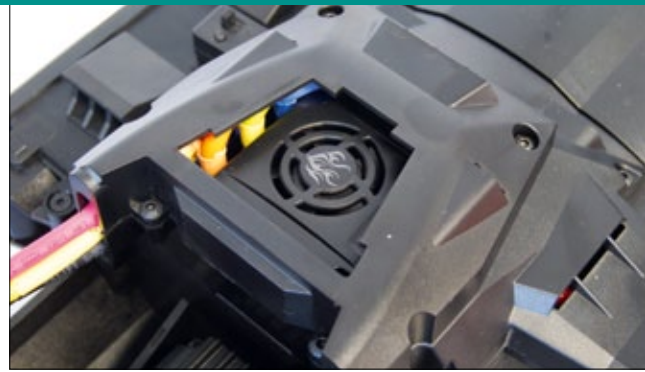
Der 150-Ampere-Regler sitzt unter einer Kunststoffabdeckung, die sich abnehmen lässt. Im Falle eines Hitzestaus kann man dem Controller so Luft machen
