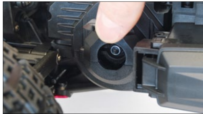
Unter einer kleinen Kunststoffabdeckung befindet sich die Mutter zur stufenlosen Einstellung des Slippers
