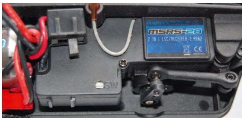
Regler und Empfänger bilden eine Einheit. Das Microservo ist liegend verbaut
