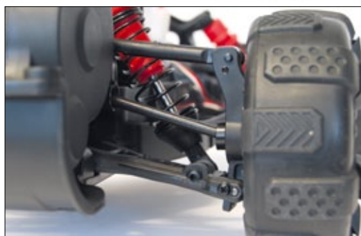
Solide Doppelquerlenkerachsen mit Stahl-Knochenwellen sind bewährte Bauteile
