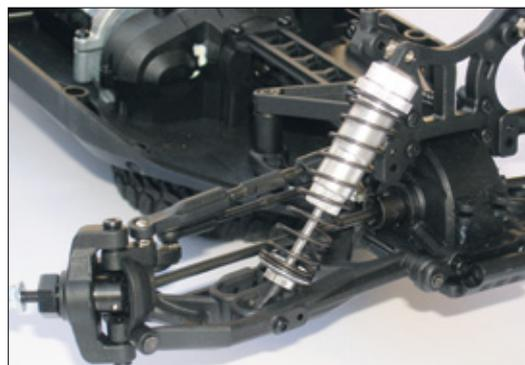
Extrem lange Querlenker schlucken in Verbindung mit den schlanken 14-Millimeter-Aluminiumölstoßdämpfern auch ruppige Bodenwellenpassagen
