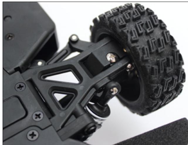
Solide Kunststoffquerlenker halten den Belastungen im Fahrbetrieb locker Stand
