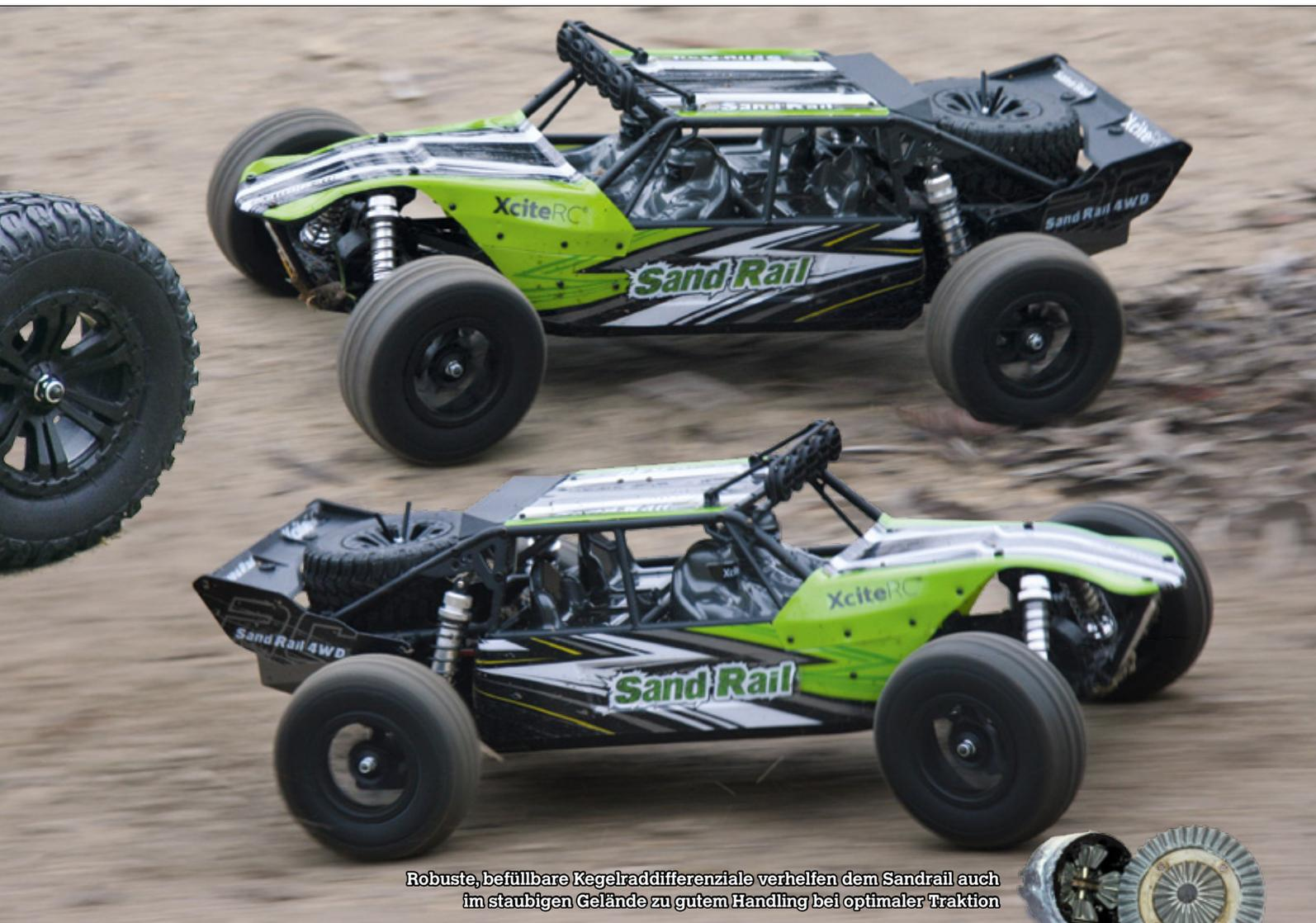
Robuste, befüllbare Kegelraddifferenziale verhelfen dem Sandrail auch im staubigen Gelände zu gutem Handling bei optimaler Traktion
