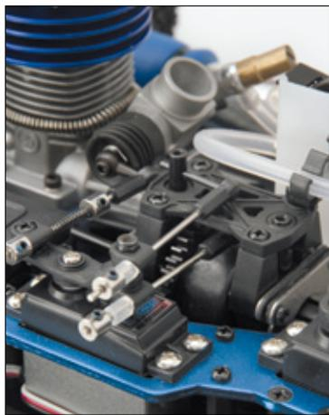
Gas und die beiden Scheibenbremsen werden über ein R-7030 Standard servo angesteuert
