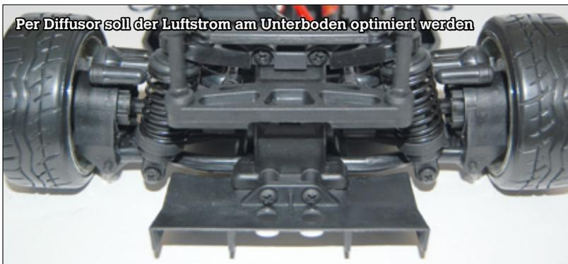
Per Diffusor soll der Luftstrom am Unterboden optimiert werden
