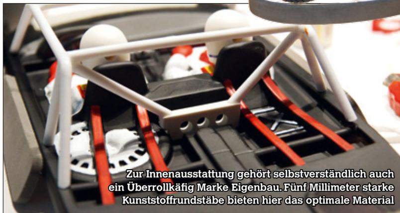
Zur Innenausstattung gehört selbstverständlich auch ein Überrollkäfig Marke Eigenbau. Fünf Millimeter starke Kunststoffrundstäbe bieten hier das optimale Material
