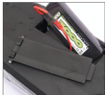
Die Klappe auf der der Chassisunterseite erlaubt den Wechsel des Fahrakkus in Sekundenschnelle
