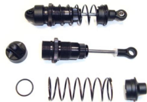
Die Funktion und Verarbeitung der Dämpfer mit Aluminiumgehäuse ist tadellos. Auf einen Volumenausgleich wurde, nach amerikanischem Vorbild, bewusst verzichtet
