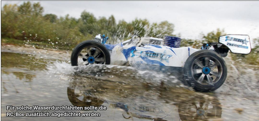
Für solche Wasserdurchfahrten sollte die RC-Box zusätzlich abgedichtet werden
