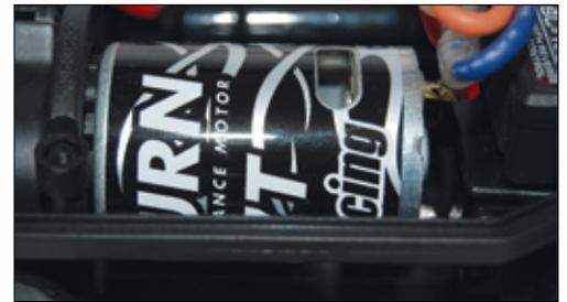
„Der werkseitig fahrfertig aufgebaute Drifter hat seinen Motor weit vorne platziert, um viel Gewicht auf die Vorderachse zu verlagern.“
