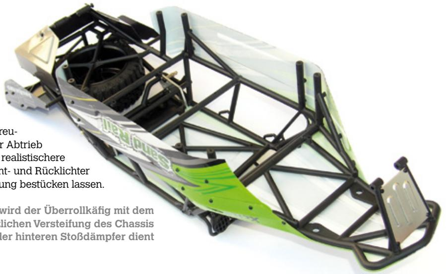
Unter dem Überrollkäfig baut der Sandrail auf einem klassischen 1:8er-Buggy-Chassis mit bewährtem Fahrwerkskonzept und gekapseltem Allradantrieb über drei Differentiale auf
