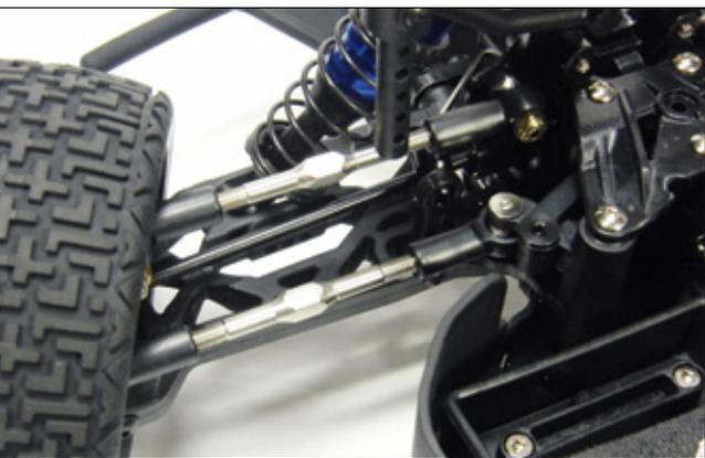
Dicke Rechts-links-Gewindestangen vereinfachen die Einstellarbeiten am Fahrwerk
