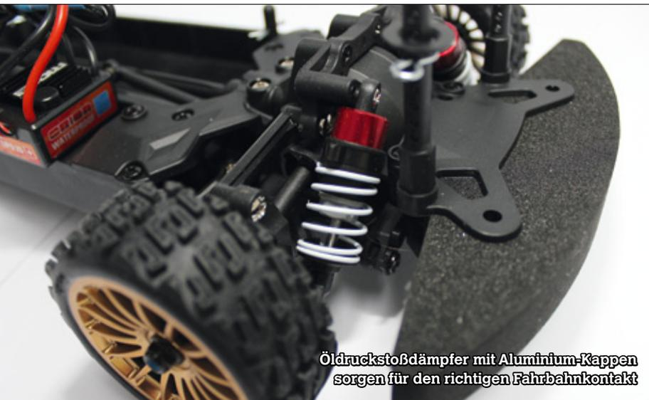
Öldruckstoßdämpfer mit Aluminium-Kappen sorgen für den richtigen Fahrbahnkontakt
