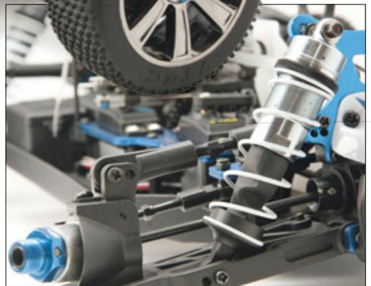
Die Einstellung der Federvorspannung erfolgt mit einer Rändelschraube, Gummitüllen über dem Kolben schützen vor Schmutz und Beschädigung
