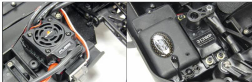
130 Ampere verkräftet der wasserdichte Fuze Brushless-Regler. Er kann wahlweise mit 2s- oder 3s-LiPos betrieben werden
