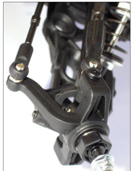
Aus dem 1:8er-Buggybereich stammen die Form und Mechanik der Lenkhebel
