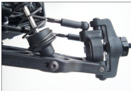
Die Aufhängung der Vorderachse ist mit der des 4WD-Modells identisch, lediglich die Antriebswellen entfallen
