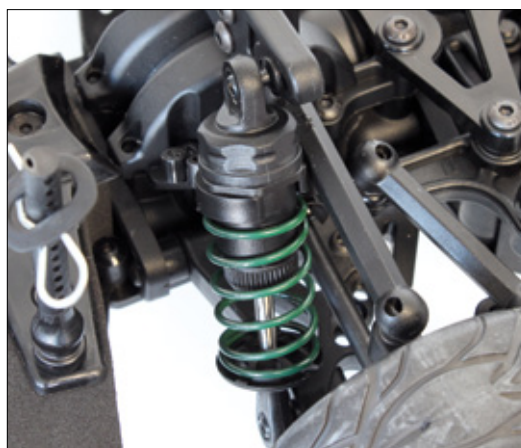
Die Federvorspannung der Dämpfer wird über C-Klipse eingestellt. Rändelschrauben wären hier wünschenswert gewesen
