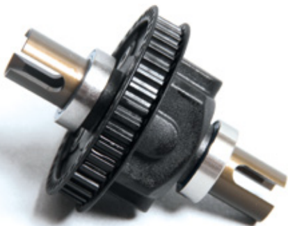
Das Kegelraddifferential für die Hinterachse kann mit verschiedenen Silikonölen befüllt werden
