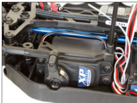
Das digitale Lenkservo gehört nicht zu den kräftigsten Vertretern seiner Zunft, allerdings ist er den Anforderungen im Apex gewachsen
