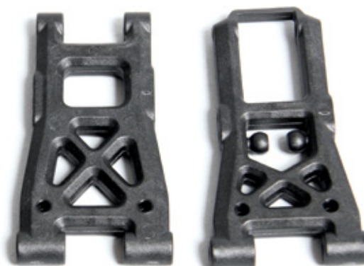
Die Schwingen des ARC bieten mehrere Bohrungen für die Stoßdämpfer
