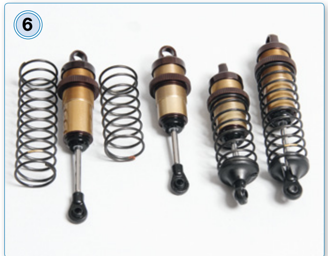
Die Bigbore-Stoßdämpfer von Kyosho haben sich schon beim 2WD-Buggy bewährt
