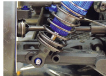
Man beachte den unteren Kugelkopf am Dämpfer. Leider ab Werk defekt. Das trübt den Gesamteindruck
