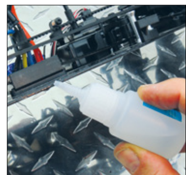
Die Chassiskanten sollten leicht abgerundet und mit dünnflüssigem Sekundenkleber versiegelt werden, um ein Aufplatzen zu verhindern
