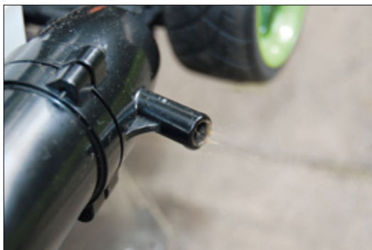
Einige Öltropfen aus dem Resonanzrohr sind anfangs okay, sollten sich aber im Rahmen halten
