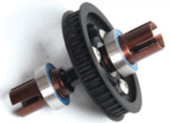
Die Starrachse für die Vorderachse zeugt von der guten Bausatzqualität
