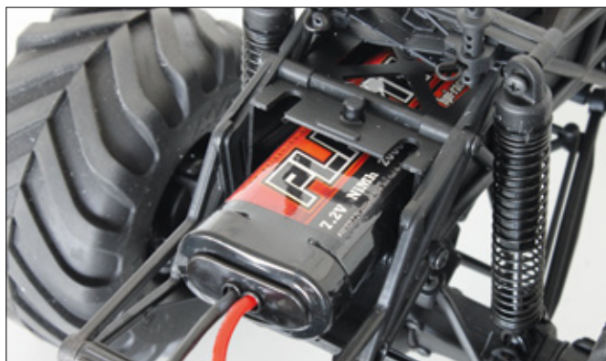
Der Plazma-Akku gehört zum Lieferumfang. Er wird über eine Klappe am Heck in das Chassis geschoben
