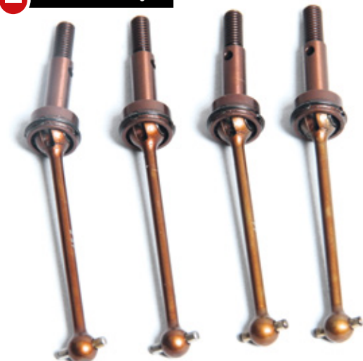
Die Kardangelenke aus Stahl. Im Test wurden die vorderen gegen Doppelgelenke ausgetauscht
