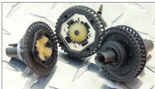
Die verbauten Differenziale sind gut geschmiert und abgedichtet. Sie laufen ruckelfrei
