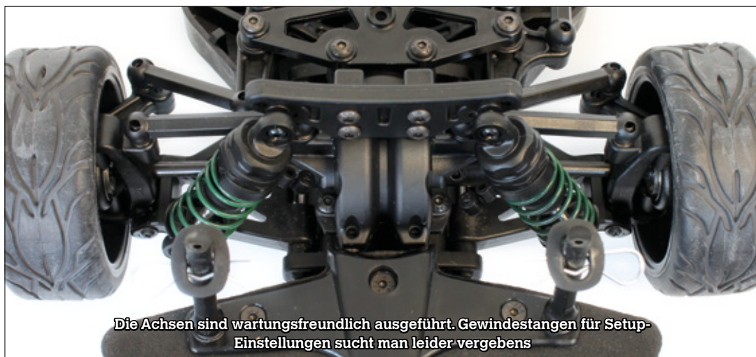
Die Federvorspannung der Dämpfer wird über C-Klipse eingestellt. Rändelschrauben wären hier wünschenswert gewesen
