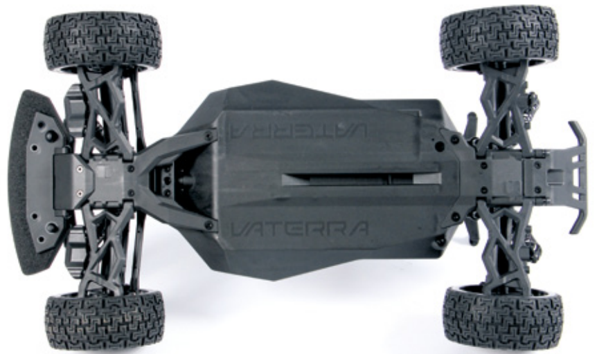
Das komplette Chassis inklusive der Achsen besteht aus Kunststoff. Alu ist hier nicht zu finden
