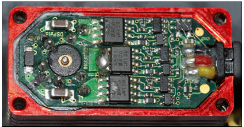
Die Elektronikplatine der HSB-93xx-Servos, die ebenfalls hochwertig vor Vibrationseinflüssen geschützt ist
