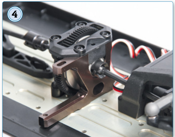
Die Motorhalterung aus Aluminium verfügt über eine Schiene, mit deren Hilfe das Ritzelspiel eingestellt wird
