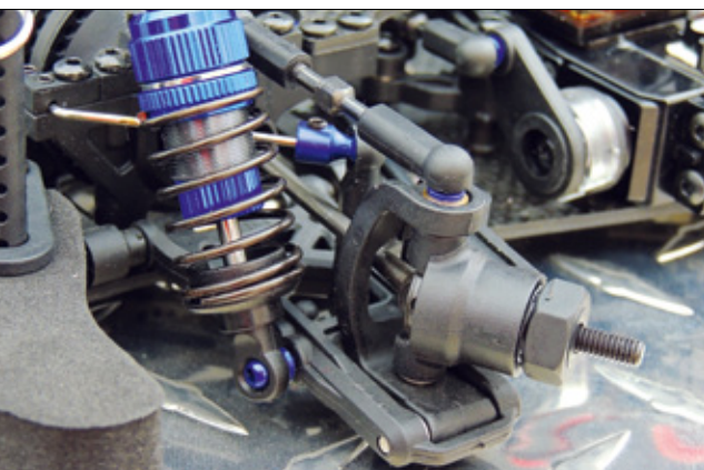
Die Vorderachsaufhängung sorgt für besten Fahrbahnkontakt und gutes Einlenkverhalten
