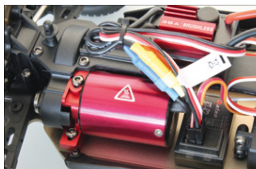
Der Brushless-Innenläufer dreht mit 4.500 kv. Das Ritzelspiel lässt sich stufenlos einstellen
