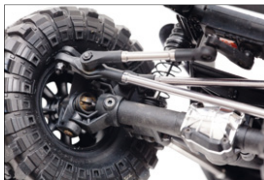
Die Lenkung besteht komplett aus Alulinks. Die Anlenkung erfolgt von oben, da das Servo im Leiterrahmenchassis verbaut wurde. Die Lenkung funktionierte im Test tadellos und sehr direkt
