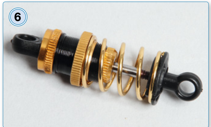
6 Der zentrale Stoßdämpfer. Eine gewisse Ähnlichkeit zum XRAY-Dämpfer ist erkennbar
