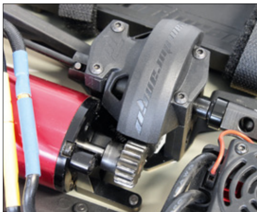
Die Einstellung des Zahnflankenspiels erfolgt durch Verschieben des Mitteldifferenzials. Hierzu müssen lediglich einige Schrauben auf der Unterseite gelöst werden
