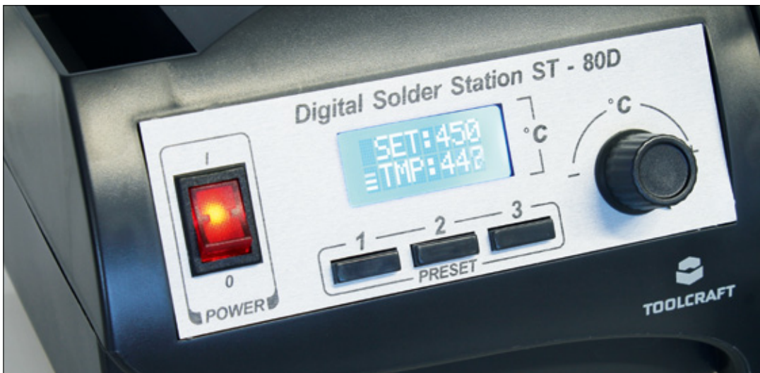
Das Display ist zweizeilig und zeigt neben der eingestellten Temperatur (oben) die aktuelle Temperatur (unten) sowie den Heizfortschritt des Kolbens in Form einer Balkenanzeige (links)
