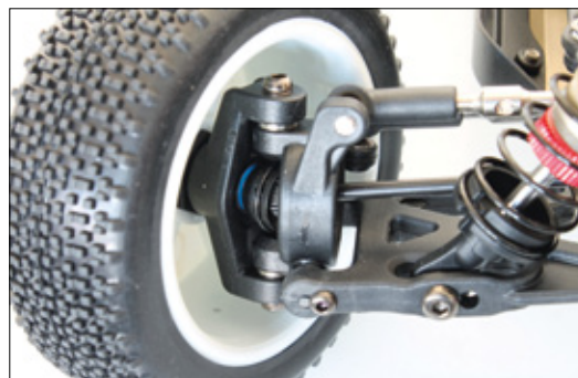
Das gesamte Modell überzeugt mit guter Qualität. Sauber gefertigte Kunststoffteile, Kugellager und wenig Spiel zeichnen die Achskonstruktionen aus
