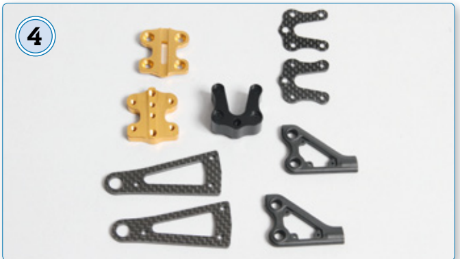
4 Die oberen und unteren Querlenker und die Blockkonstruktion für das Einstellen des Nachlaufs
