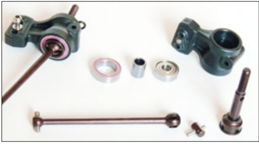
Übergroße innere Lager dienen als Halter für den CVD-Stift und ermöglichen die werkzeuglose Demontage der Antriebswelle
