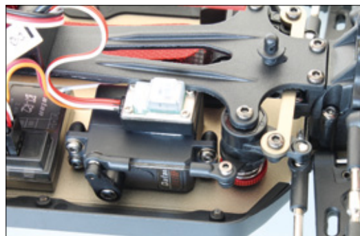
Das liegend verbaute Lenkservo überträgt seine Kraft auf eine Zweipfosten-Lenkung mit integriertem Servosaver
