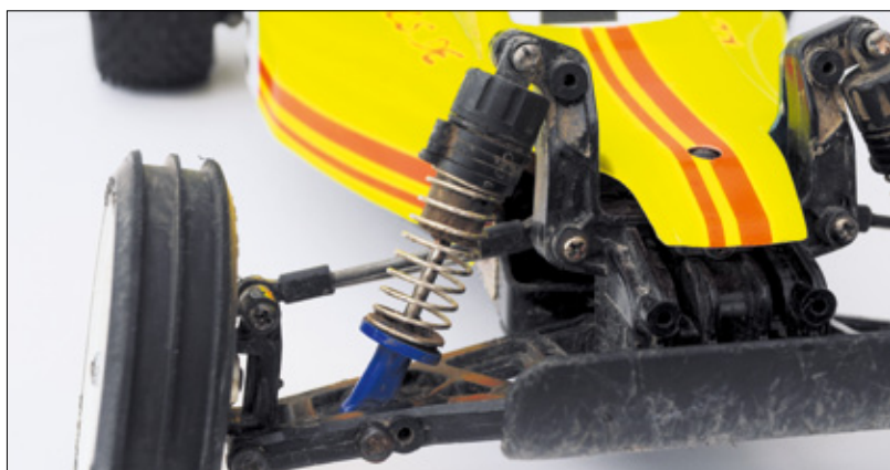
Auch im oberen Bereich gibt es in der Regel verschiedene Aufhängungspunkte für die Stoßdämpfer
