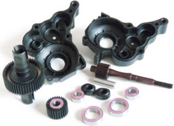
Das mit zwölf Kugeln bestückte Differential lässt sich sehr gut justieren und überträgt selbst hohe Motorkräfte ohne Probleme. Die breiten Zahnräder und die am ganzen Modell zu findenden gummidichteten Lager sorgen für sehr lange Wartungsintervalle
