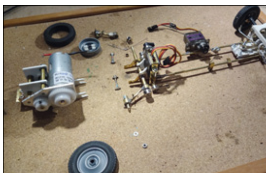
Die Einzelteile der Hinterachse inklusive Federverstellung und ansteckbarer Antriebseinheit
