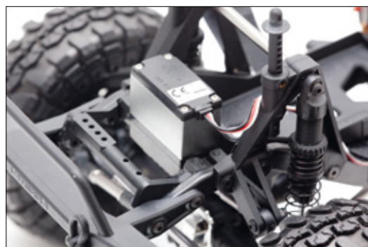
Die Lenkung besteht komplett aus Alulinks. Die Anlenkung erfolgt von oben, da das Servo im Leiterrahmenchassis verbaut wurde. Die Lenkung funktionierte im Test tadellos und sehr direkt
