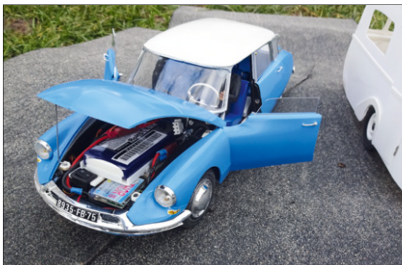
Die Seitentüren lassen sich ferngesteuert öffnen. Der Akku ist gut erreichbar unter der Motorhaube platziert
