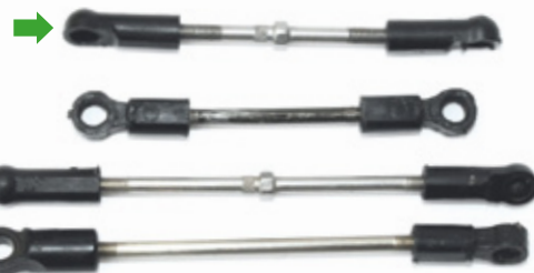
Rechts-links-Gewindestangen (Pfeil) ermöglichen ein Einstellen von Spur und Sturz
