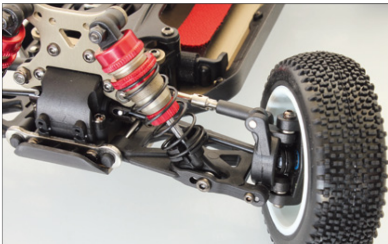
Vielfach einstellbare Doppelquerlenkerachsen mit CVD-Wellen vorne und Alu-Öldruckstoßdämpfern vorne sind in dieser Preisklasse nicht unbedingt üblich
