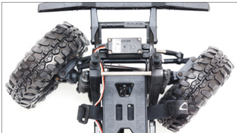
Dank eines Lenkeinschlags von 45 Grad kommt der US-Truck ohne aufwändige Wendemanöver um engere Kurven
