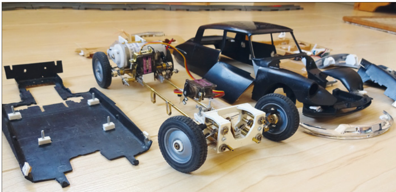
Die Einzelteile der Göttin werden nicht zusammengeklebt, sondern können miteinander verschraubt werden
