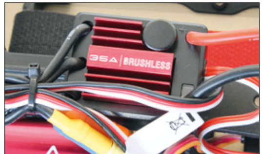
Der Regler verkraftet einen Maximalstrom von 35 Ampere. Er kann sowohl mit Nickel- als auch mit LiPo-Akkus betrieben werden
