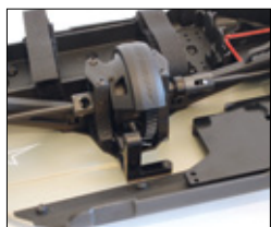
Der Kraftschluss vom Mitteldiff zu den Achsen erfolgt über zwei zentrale CVD-Wellen
