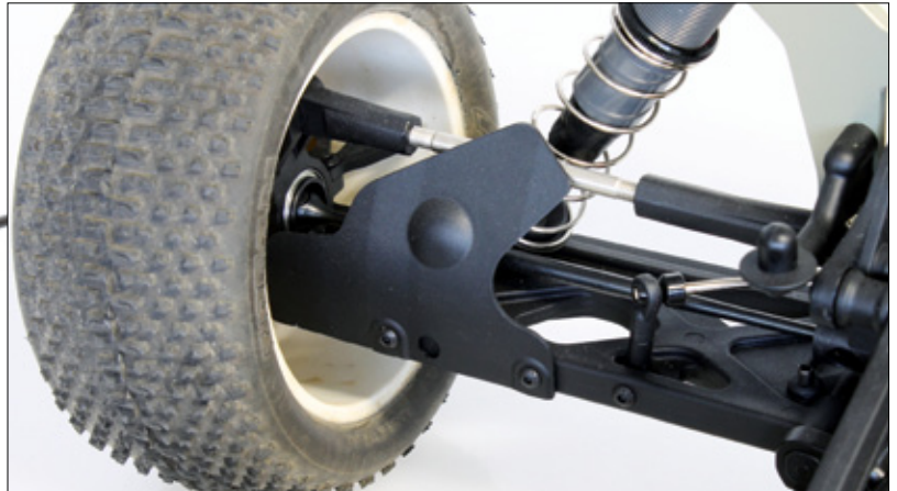
Mud-Guards an der Hinterachse fangen im Gelände den schlimmsten Dreck ab und schützen so Wellen und Aufhängung
