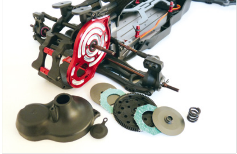
Die mit zwei großen Reibpads bestückte Rutschkupplung wird zuverlässig von einer in der Motorhalterplatte versenkt angebrachten Abdeckung geschützt
