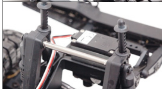
Das Lenkservo ist im Leiterrahmen montiert. So ist es schön scalig versteckt. Des Weiteren ist es so besser vor Dreck und Wasser geschützt. Die Dämpferbrücken sind aus Kunststoff gefertigt und sehr stabil. Durch eine Aluminiumstrebe ergibt sich eine noch bessere Verwindungssteifigkeit
