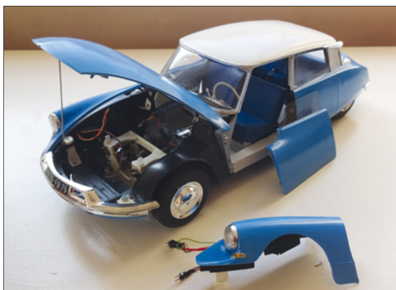
Die letzten Handgriffe der Endmontage. Die Karosserieteile werden nicht verklebt, sondern mit M2-Schrauben verschraubt und die Verkabelung gesteckt
