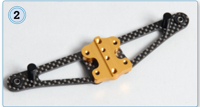
2 So werden die unteren Querlenker am zentralen Block montiert
