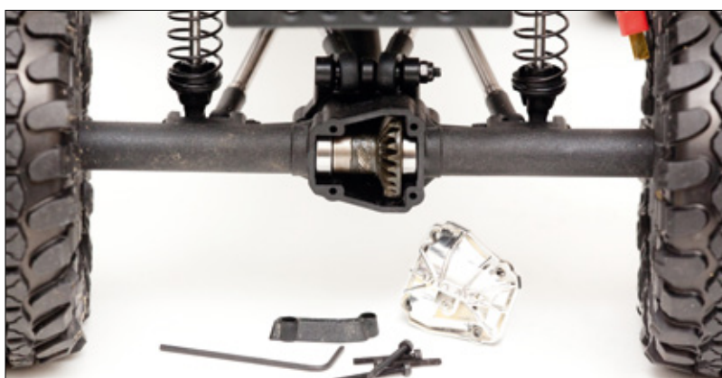
Die Deckel der Differenziale lassen einfach durch das Lösen von vier Inbusschrauben abnehmen. Für schnellere Wartungsarbeiten ideal. Ab Werk waren die Zahnräder ausreichend gefettet
