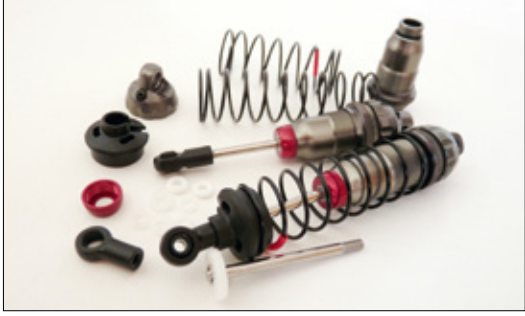
Die aus 24 Teilen zu montierenden Dämpfer überzeugen durch ein sehr geringes Losbrechmoment und gehören mit zum Besten, was derzeit erhältlich ist. Dem Baukasten liegen neben einer Flasche 350 CPS-Öl auch diverse weitere Kolbenplatten zur Abstimmung bei
