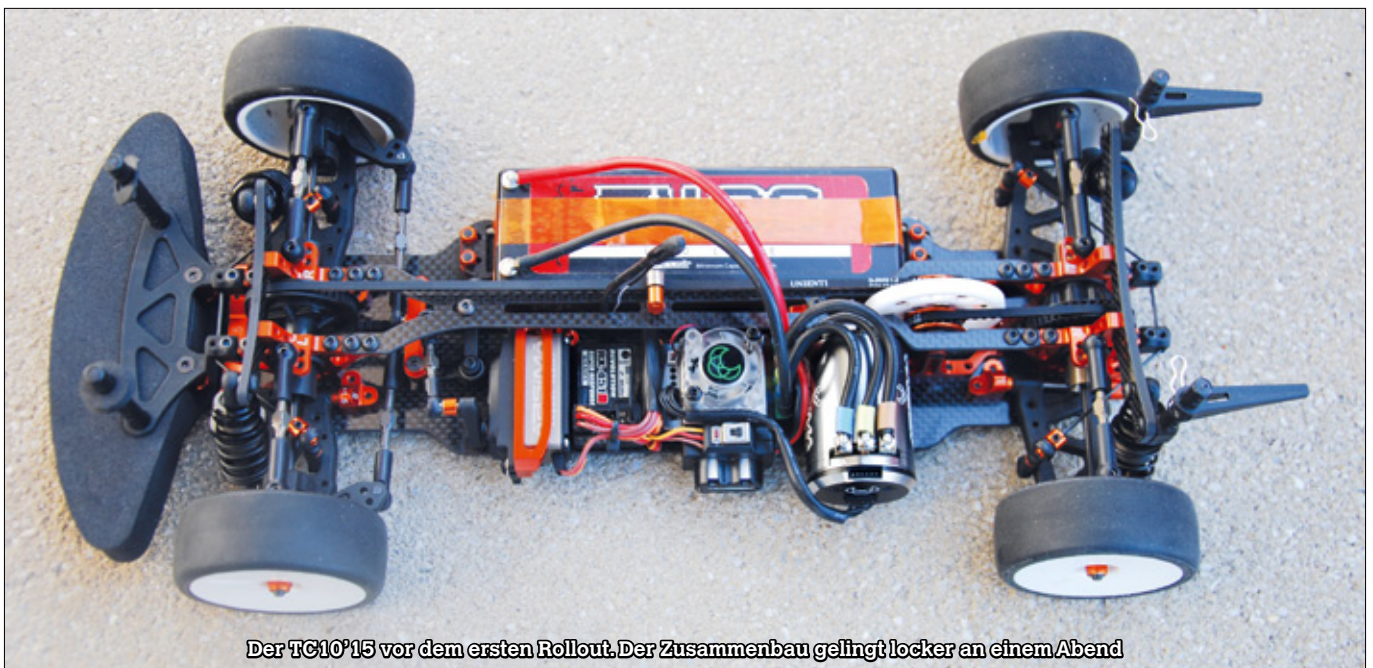
Die Montage der Schwingen erfolgt vorne/hinten sowie hinten/vorne anhand geteilter Lagerböcke. Sie lassen sich, ebenso wie die einteiligen Schwingenhalter an den Extremitäten der Chassisplatte, gegen andere Exemplare mit den gängigsten Spurwerten austauschen
