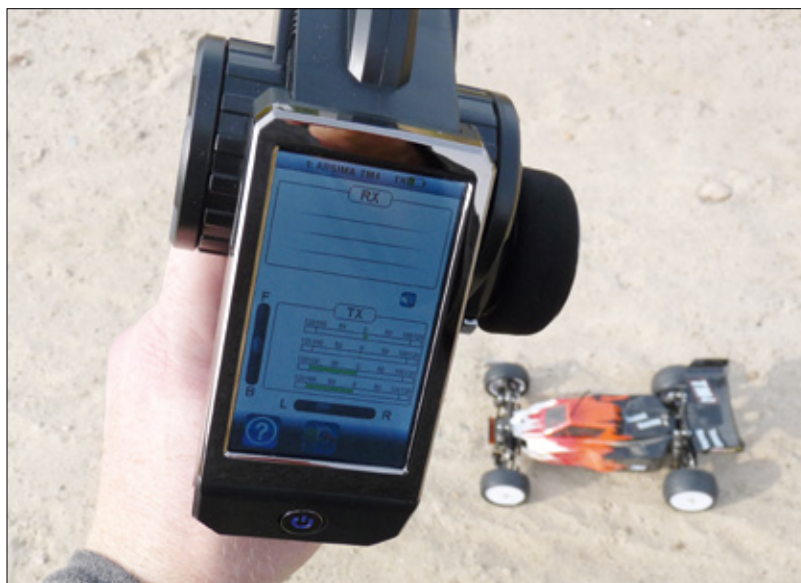
Selbst bei sehr hellem Umgebungslicht lässt sich der transflektive Bildschirm gut ablesen und je nach Situation kann auch die Displayhelligkeit noch herunter geregelt werden
