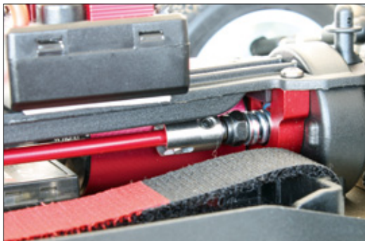
In der zentralen Antriebswelle ist auch eine Slipperkupplung integriert, die Lastspitzen dämpfen soll
