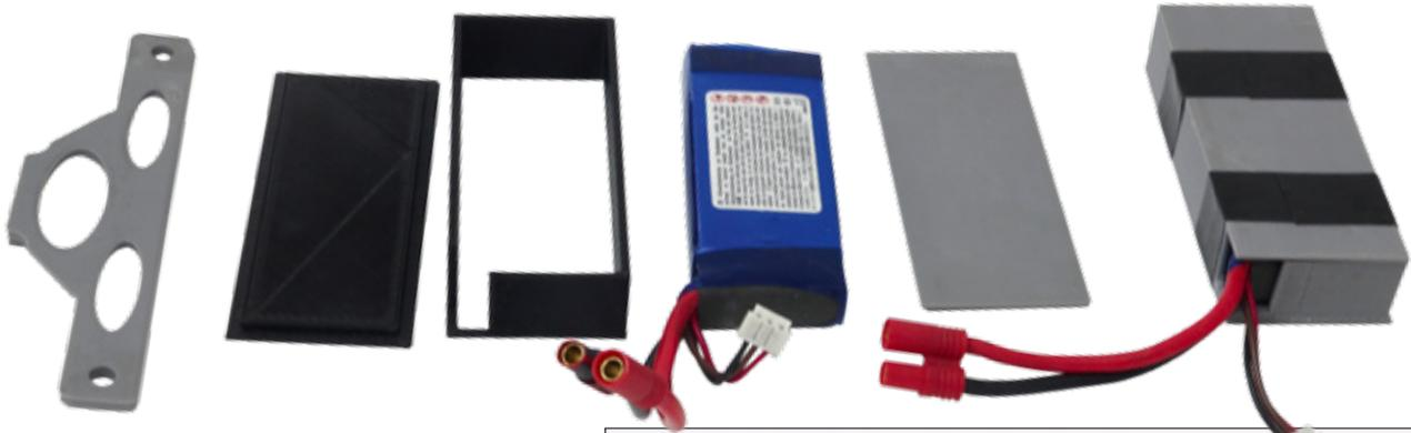
Das Hardcase für den LiPo-Akku in Teilen und rechts zusammengesteckt und mit Tape gesichert
