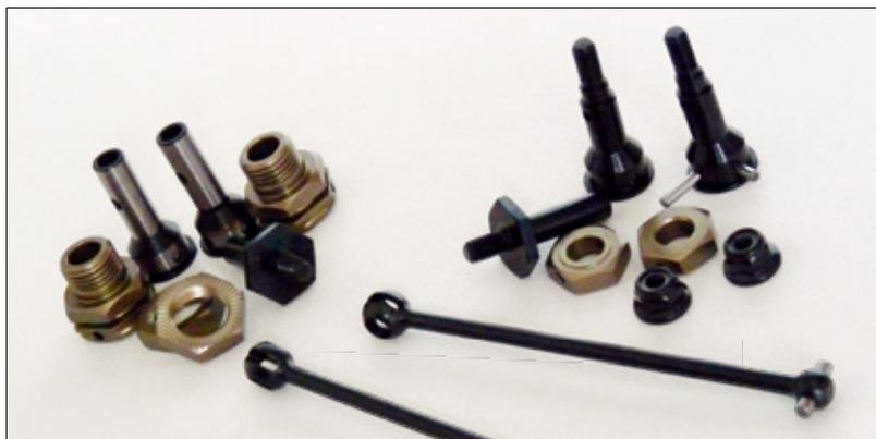
Vorne nutzt der S12-1M die weit verbreiteten 12-Millimeter-Sechskantmitnehmer. An der Hinterachse hat man die Wahl zwischen einem 14- oder 12-Millimeter-Mitnehmer. Für die 14-Millimeter-Version liegen zudem passende hintere Felgen bei
