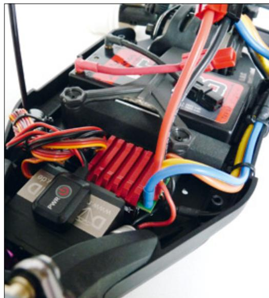
Wer die Akkuhalterung ausschließlich für Shorty-Akkus einstellt, gewinnt noch mehr Platz für den Regler, verzichtet aber beim Einsatz des Shorty-Akkus auf die damit einhergehenden Verschiebmöglichkeiten
