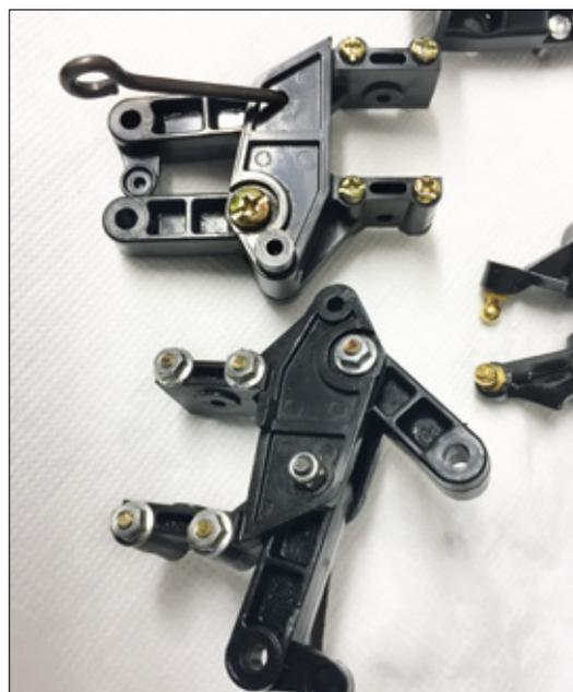
Die Teile gehen der Reihe nach in den Ultraschallreiniger. Damit werden Dreck und Öl aus allen Nischen und Ecken gelöst
