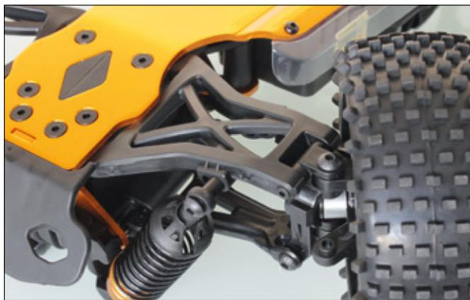
Auch die unteren Querlenker sind sehr robust ausgeführt. Die Räder sitzen an C-Hub-Aufhängungen
