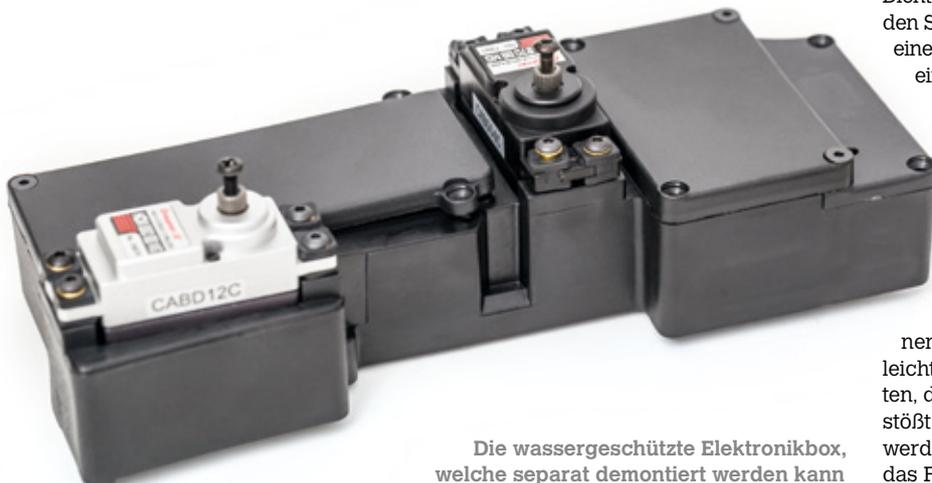
Die wassergeschützte Elektronikbox, welche separat demontiert werden kann
