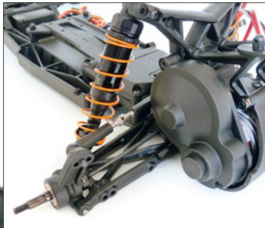
Die Verwendung von Quersplinten bei den Felgenmitnehmern lässt den Einsatz von vielen unterschiedlichen Felgensystemen zu. Serienmäßig setzt der H2 Pro allerdings an der Hinterachse auf das 12-Millimeter-Sechskantsystem und vorne 9,8-Millimeter-Sechskante
