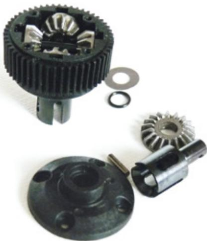
Das Differenzial des Hyper H2 besteht aus gesinterten Kegelrädern und einem breit verzahnten Gehäuse. Die Dimensionierung der Bauteile lässt auf sehr lang gezogene Wartungsintervalle schließen
