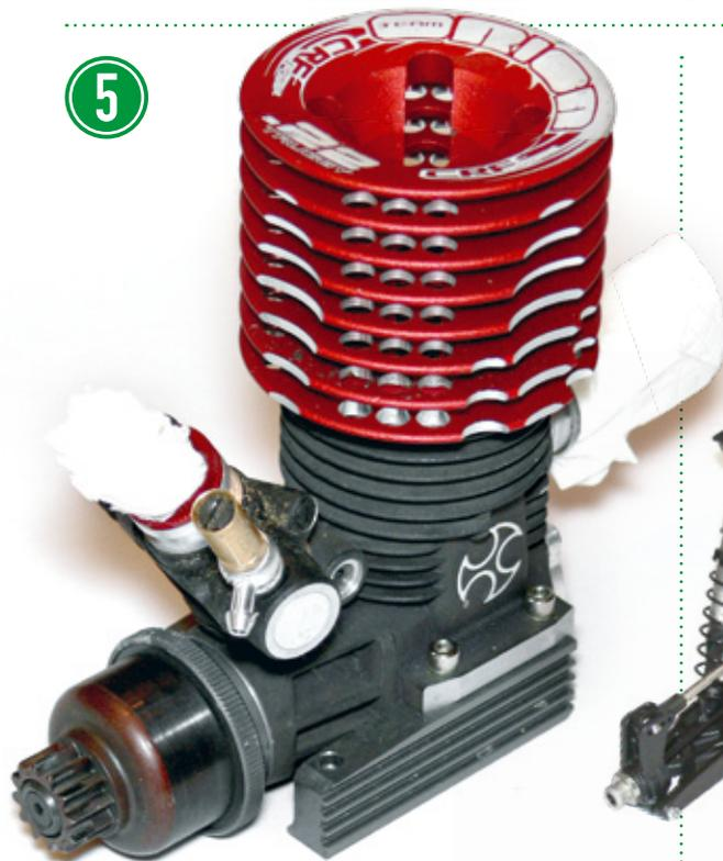
Fast wie bei einem neuen Modell lassen sich die grundgereinigten Teile nach der Aktion wieder zusammensetzen. Werden Schrauben direkt in Metall gedreht, ist Schraubensicherung unerlässlich. Wenn eine Schraube schon beim Auseinanderbau „vernudelt“ war, sollte man sie spätestens jetzt gegen eine neue ersetzen. Danach stellt man sicher, dass die Reifen noch intakt sind und die Klebestellen halten. Ist alles montiert, überprüft man noch das Setup und ist wieder bereit für die erste Ausfahrt.
