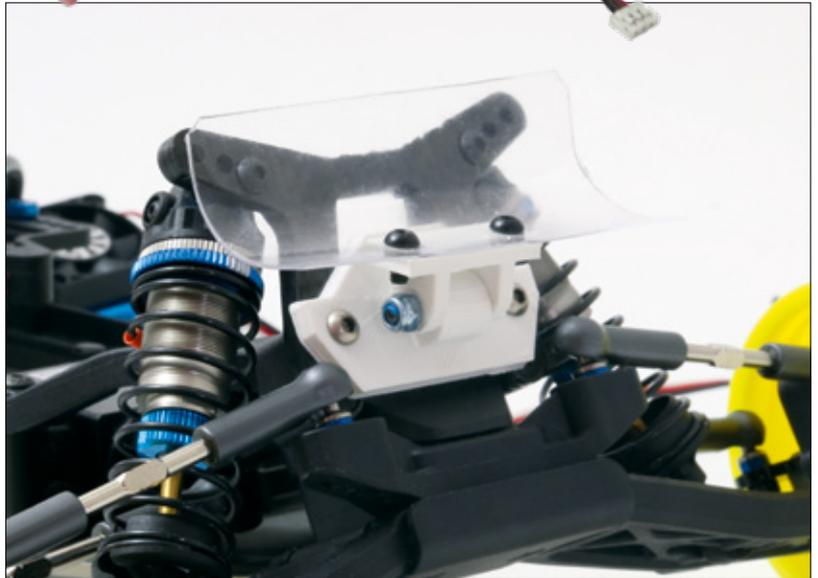
Ein verstellbarer Frontspoilerhalter montiert an einem Team Associated B6. Dieser muss sich im Rennen noch beweisen
