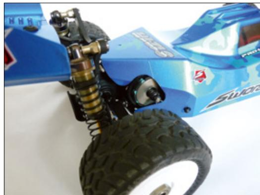
Bedingt durch die Motorposition muss am Heck der ansonsten sehr geräumigen Karosserie ein größerer Ausschnitt im Bereich des Slippers platziert werden. Der Fahrtst zeigte allerdings keinerlei Schäden durch kleine Steine an dem 48-DP-Hauptzahnrad
