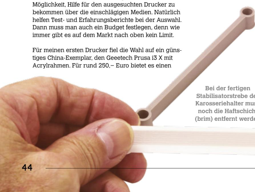
Bei der fertigen Stabilisatorstrebe der Karosseriehalter muss noch die Haftschrift (brim) entfernt werden
