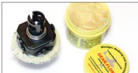
In zerlegtem Zustand hat man alle Möglichkeiten, die beweglichen Teile auf Verschleiß zu prüfen und gegebenenfalls zu erneuern. Besonders Kugellager sind hier beliebte Kandidaten. Ist ein Tausch nicht notwendig, sollte man zumindest neues Schmiermittel verwenden. Auf Zahnräder gehört Fett, in Kugellager ein Tropfen Leichtlauföl und offene Gelenke erhalten eine feine Schicht Trockenschmiermittel.
