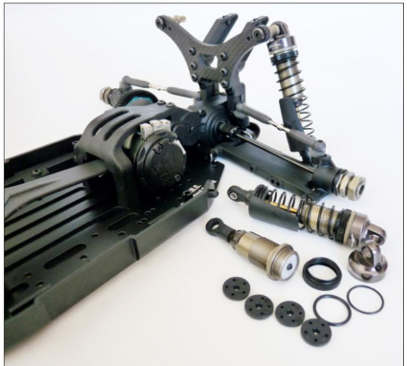
Die schon aus dem S104 bekannten und sehr guten Dämpfer wurden nochmals leicht überarbeitet und neben einer besseren Beschichtung auch mit weicheren Dichtungen versehen. Zusammen mit dem cleveren Kolbenstangenschutz erhält man sehr leichtgängige Dämpfer
