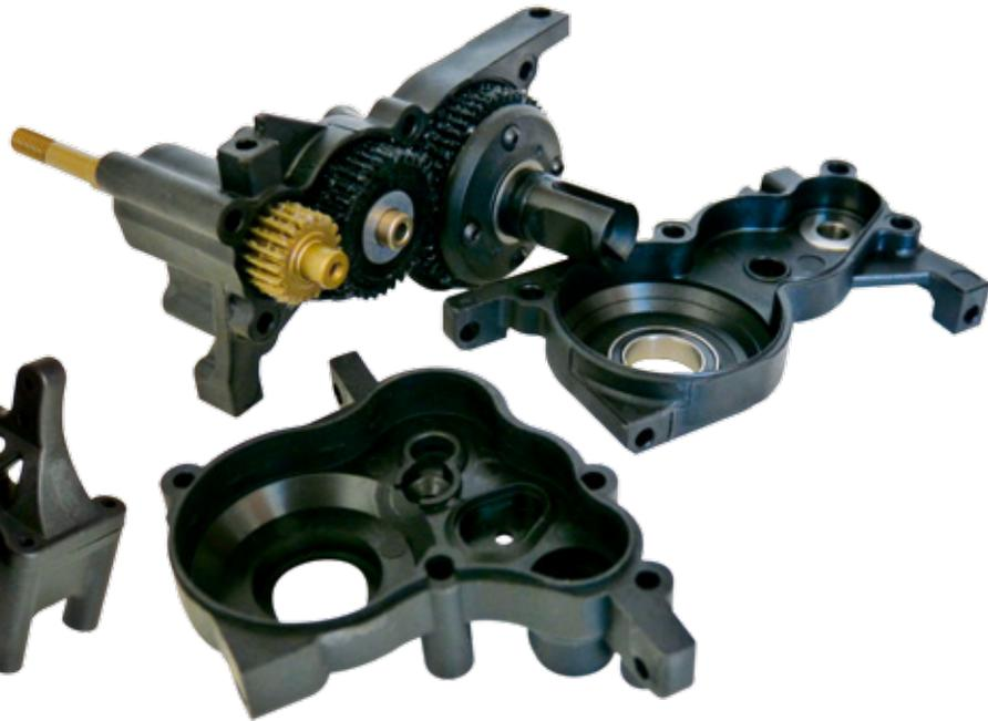
Das Spiel im Getriebe lässt sich mit wenigen Passscheiben auf null reduzieren, um eine verschleißarme Kraftübertragung zu ermöglichen. Mit etwas Molybdänfett versehen, braucht man sich lange Zeit keine Gedanken mehr um das Getriebe zu machen
