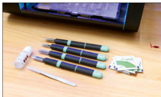
Hilfreiche Utensilien im Lieferumfang des Robox: Das Öl für die Wellenschmierung, eine Pinzette, verschiedene Messer und Reinigungstücher
