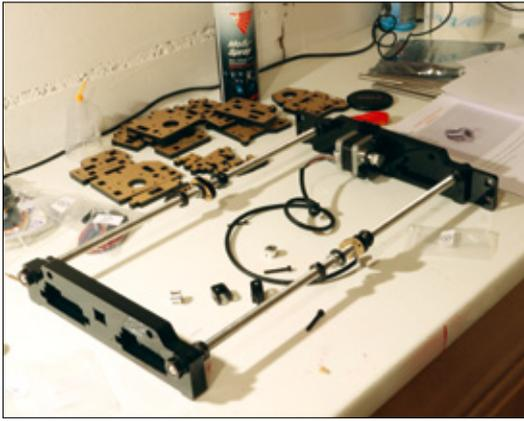
Der Rahmen für das Druckbett des Geeetech ist fertig. Das Riemenrad am Schrittmotor muss gegenüber der Angabe in der Anleitung spiegelverkehrt verbaut werden
