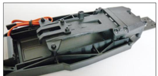
Je nach Motorposition und genutztem Akkupack kann man dem sehr schmalen Chassis etwas Bauraum abringen indem man den Platz unterhalb des Podests bei der Heckmotorvariante zur Platzierung der Elektronik mit benutzt
