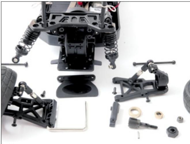
Mit ein paar wenigen Schrauben hat man die Hinterachse ausgebaut und zerlegt
