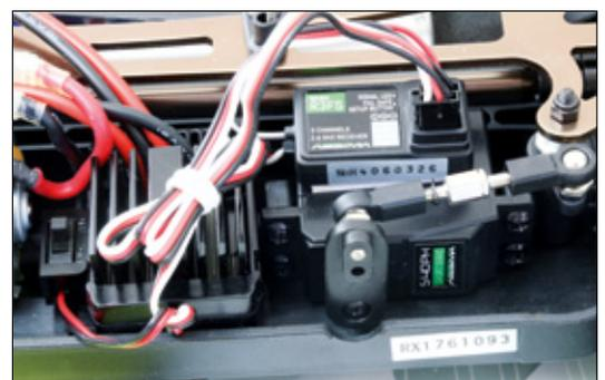
Von links nach rechts: Der Ein-aus-Schalter, Regler, Servo und oben drauf der Empfänger
