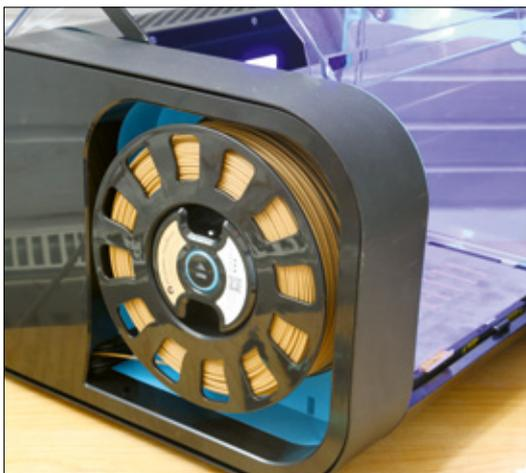
Auf der Seite steckt die spezielle programmierbare Spule. Auch Fremdmaterial kann benutzt werden
