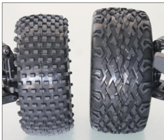
Die Räder der Truggys (rechts) haben ein etwas anderes Profil als die Buggys. Der Grip ist jedoch bei beiden Varianten gut, wobei die Minipin-Reifen der Buggys auf losem Untergrund etwas mehr Seitenhalt bieten
