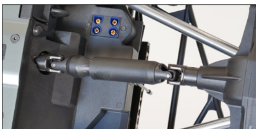
Die Verbindung vom Mitteldiff zur Hinterachse ist über eine Teleskop-Antriebswelle realisiert. Sie besteht aus Kunststoff mit Stahl-Gelenken
