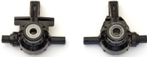
Um mehr Lenkausschlag zu erhalten, wurden die vorderen Radträger mit einem Schleifgerät bearbeitet (rechts)
