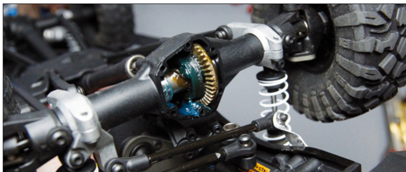
Robuste Stahlzahnräder findet man am kompletten Modell. Nicht nur die Tellerräder sind gut gefettet. Eine Nacharbeit ist hier nicht notwendig
