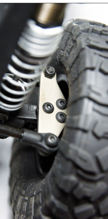
Als Verbindungsstück bei der BTA-Lenkung dient eine massive Aluminiumplatte
