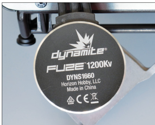
Der Dynamite-Motor mit 1.200 Umdrehungen pro Minute und Volt ist mit 58 Millimeter deutlich dicker als Motoren in 1:8er-Modellen
