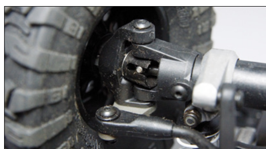
Wie bei einem Ready-to-Run-Modell zu erwarten, hat auch der Venture an der Vorderachse nur Antriebsknochen. Trotzdem ist ein ganz passabler Lenkeinschlag zu realisieren
