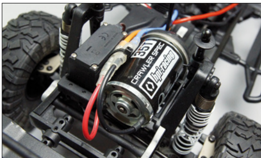
Neben dem Lenkservo ist der Motor untergebracht. Für ein Einsteigermodell ist das absolut erwähnenswert
