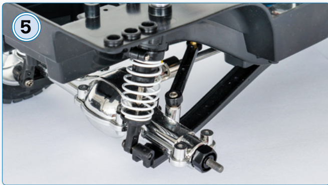
5 Die Hinterachse ist über vier Links mit der Chassis-Wanne verbunden. Der Aktionsradius dieser Aufhängung ist jedoch sehr begrenzt
