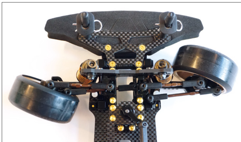
85 Grad Lenkeinschlag – das ist selbst für ein Drift-Chassis eine Menge Holz, die aber auch beherrscht werden möchten
