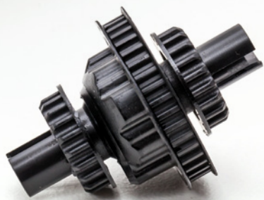
Das fertig montierte Vierspider-Kegeldifferenzial. Zum Einstellen der Riemenspannung sind außen zwei Exzenter vorhanden
