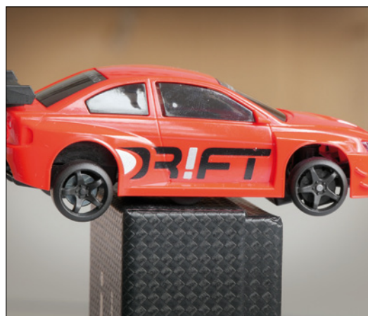
Der „Ausfederweg“ ist beachtlich. Er sorgt dafür, dass die Räder bei Wankbewegungen nicht die Bodenhaftung verlieren
