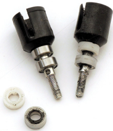
Preisgünstige Industriekugellager im Antriebsstrang reduzieren den Rollwiderstand und das Spiel
