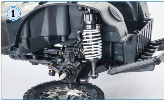
1 An der Vorderachse sind Doppelquerlenker-Aufhängungen zu finden. Die ölbefüllten Stoßdämpfer mit Tonnenfedern arbeiten schön sanft, hinten sind die Federn jedoch zu hart
