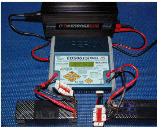
Die eindeutig leistungsfähigste Lösung stellen ein Ladegerät sowie ein Netzteil in getrennten Ausführungen dar. Sie eröffnet Möglichkeiten, die alle erdenklichen Anforderungen des RC-Car-Sports abdecken – und weit darüber hinaus
