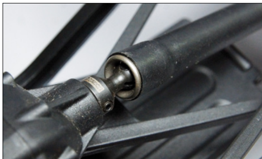
Bei den Antriebswellen sind lediglich die Verbindungsrohre aus glasfaserverstärktem Kunststoff. Der Rest ist Metall
