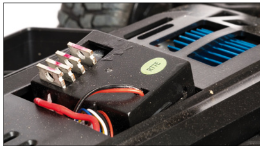
Der Regler musste noch einmal mit doppelseitigem Klebeband fixiert werden
