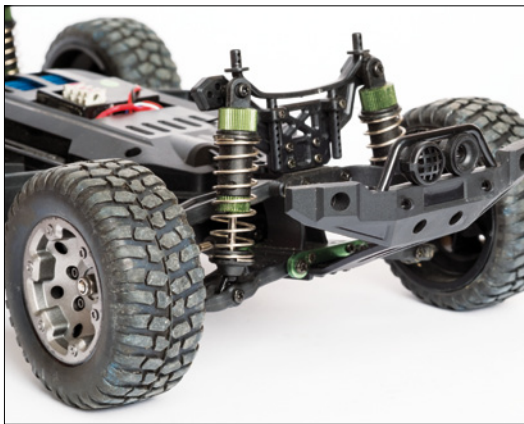
An den Achsen zeigt sich die einfache aber solide Bauweise des Modells
