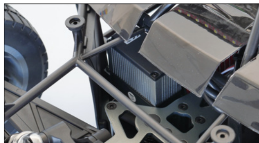
Das Lenkservo hat eine Stellkraft von über 35 Kilogramm, ist aber ohne aufwändige Demontage-Arbeiten der Karosserie kaum erreichbar
