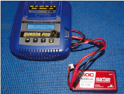
Einfache Kompaktlader mit Leistungen im Bereich von 50 Watt sind vor allem in der Einsteigerklasse beliebt
