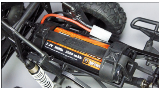
Der mitgelieferte NiMH-Akku wird zwecks Gewichtsverteilung über der Hinterachse platziert. Für den LiPo-Betrieb können die halbrunden Halter demontiert werden
