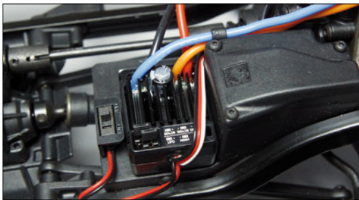
Der wasserdichte Regler sitzt gleich hinter der spritzwassergeschützten Empfängerbox
