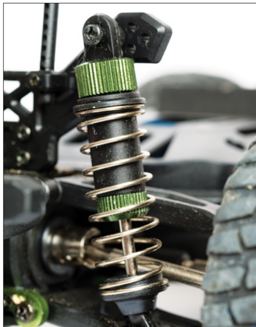
Die Öldruckstoßdämpfer haben Kappen aus Aluminium und sind ab Werk dicht
