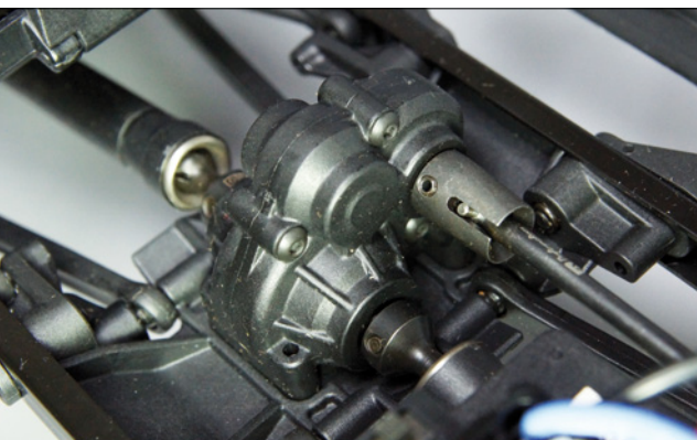
Das Verteilergetriebe ist sehr kompakt gebaut und mit Zahnrädern aus Stahl bestückt
