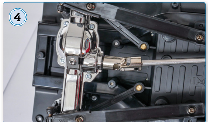
4 Die Starrachse hinten verfügt über ein verchromtes Gehäuse. Darin arbeitet ein Kegelraddifferential
