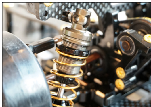
Die seidenweich agierenden Dämpfer verfügen über eine durchgehende Kolbenstange. Ein Volumenausgleich wird damit überflüssig
