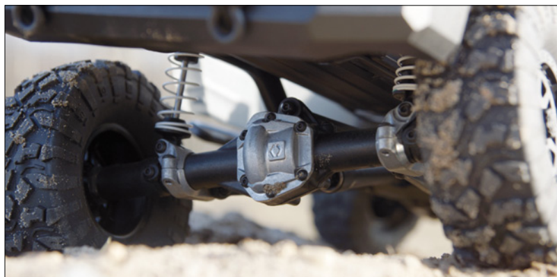
An der Hinterachse finden sich Bauteile aus Aluminiumspritzguss. Neben den Dämpferhaltern zählen auch die Differenzialdeckel dazu
