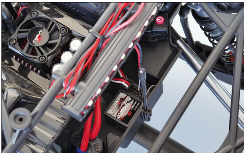
Im hinteren Chassis-Bereich ist der Empfänger platziert. Der Ein-aus-Schalter oben ist relativ schwer zugänglich
