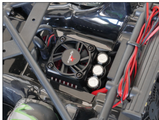
Der Dynamite-Regler sitzt in der offenen Kabine. Hier kriegt er genügend Kühlluft ab, allerdings besteht die Gefahr von Schmutz im Lüfter
