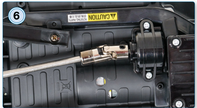
6 Vom Verteilergetriebe in der Chassis-Mitte geht eine Stahlantriebswelle nach hinten. In dem Kardangeln ist ein Längenausgleich integriert
