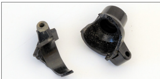
Den Überlegungen hinsichtlich einer Verbesserung der Spurtreue kam ein Bruch des hinteren rechten Radträgers zu vor – er erforderte neue, bessere Teile
