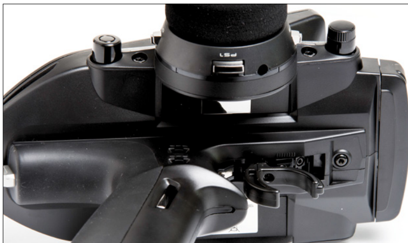
Unter dem Lenkrad-Modul befinden sich weitere Taster, deren Belegung, wie bei den anderen Bedienelementen auch, frei wählbar ist
