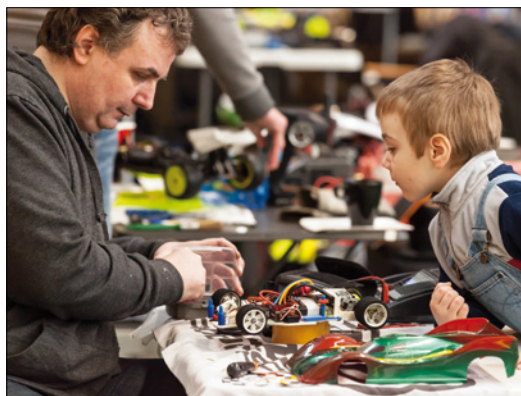
Olivier Meunier startete mit einem Eigenbau in der Klasse 1:12. Die Teile entstanden zum großen Teil mit dem eigenen 3D-Drucker
