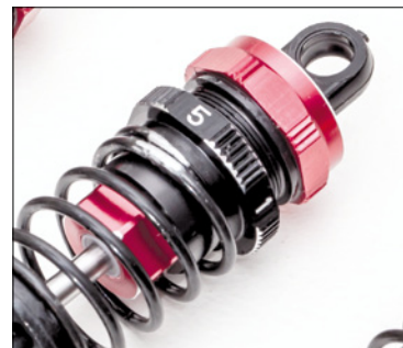
Die Zahlen auf der Rändelmutter erleichtern das Einstellen der Federvorspannung
