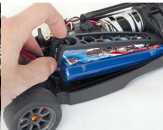
Der 4.000-Milliamperestunden-LiPo von LRP electronic findet in beiden Chassis perfekt Platz. Die Montage ist jeweils sehr einfach (links: Porsche)
