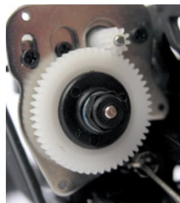
Das als Motor-Up ausgelegte Heckgetriebe verfügt sogar über einen von außen einstellbaren Slipper
