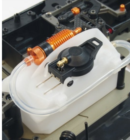
Der Tank gehört zum Lieferumfang. Das Scharnier des Verschlussdeckels kann entweder vorne oder hinten angeschlagen werden
