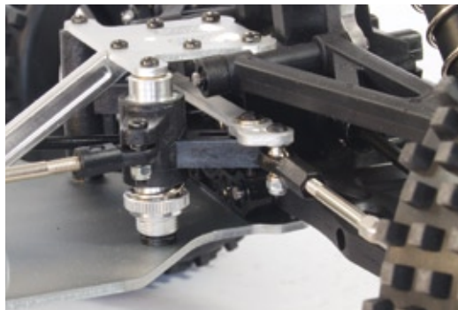
Ein einstellbarer Servosaver schützt das Lenkservo vor übermäßigen Belastungen. Die Feinjustierung der Lenkung erfolgt über Rechts-links-Gewindestangen
