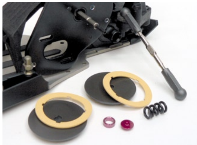
Die Slipperkupplung des 22 – nichts wirklich neues, aber auch hier zeigt Losi seine Fertigungsqualität, denn die Einheit hat einen sehr guten Rundlauf
