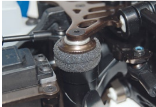
Natürlich verfügt der TKI2 über einen integrierten, einstellbaren Servosaver, den eine Schaumstoffmanschette vor Schmutz schützt
