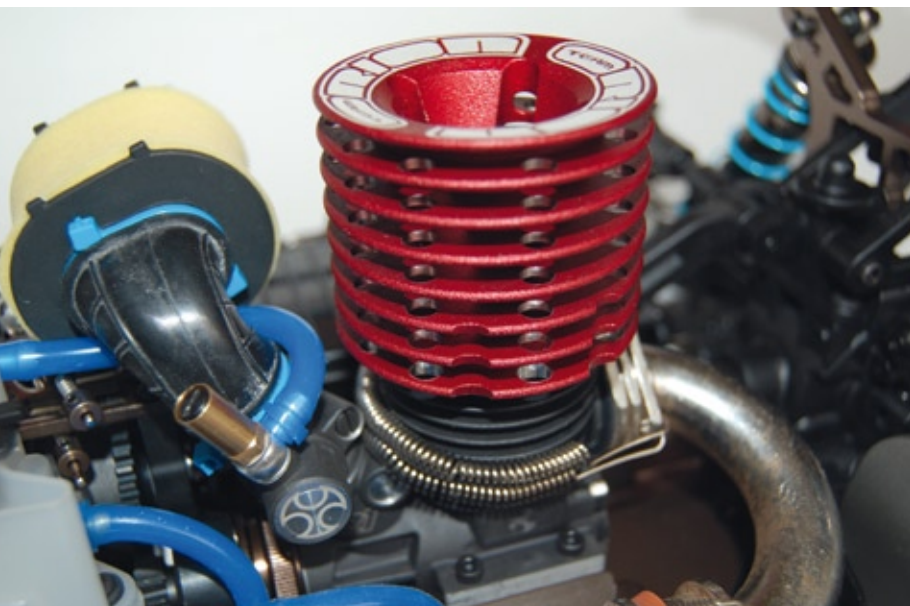
Als Kraftspender diente ein kräftiger CRF Alpha .21 ABI mit drei Einlasskanälen aus dem Hause Team Orion
