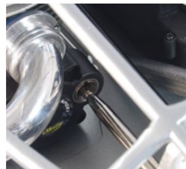
Auf der Rückseite des Motors ist der Mitnehmer für den Elektrostarter platziert
