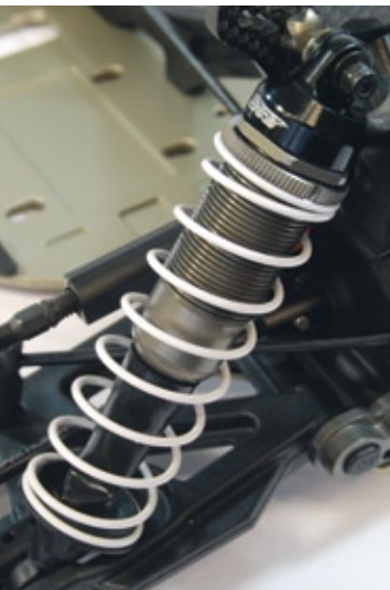
Die Federvorspannung an den Big-Bore-Dämpfern kann über Rändelschrauben verstellt werden
