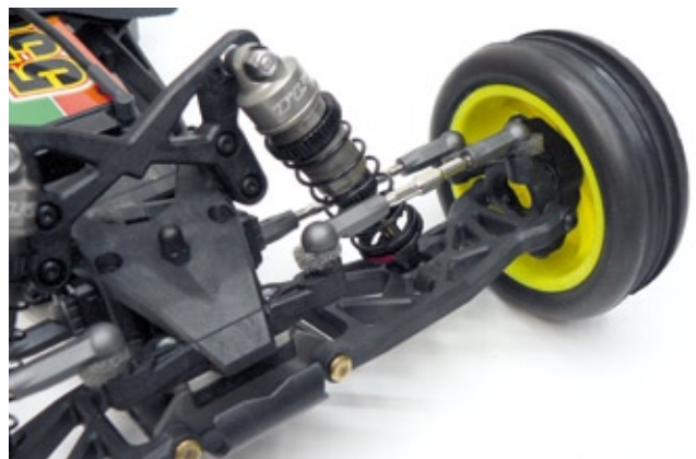
Ohne viele Schnörkel präsentiert sich die Vorderachse des 22, gut ist auch der C-Hub zu erkennen
