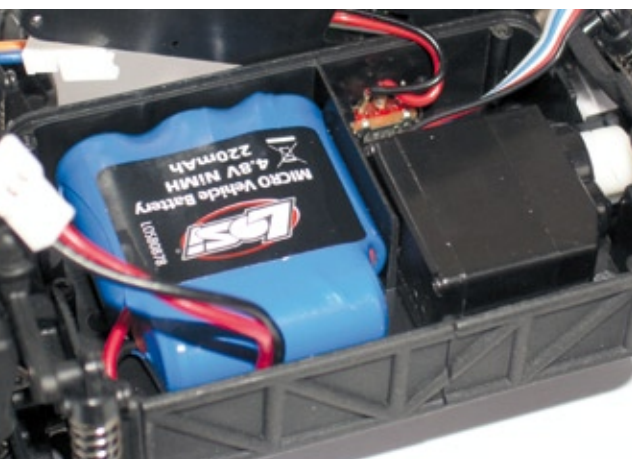
In die große Wanne passt neben dem Microservo auch der 220-Milliamperestunden-Akku
