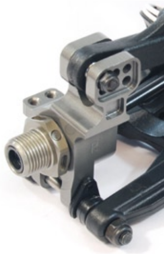
Sowohl an der Vorder- als auch der Hinterachse finden sich Achsschenkel aus Aluminium
