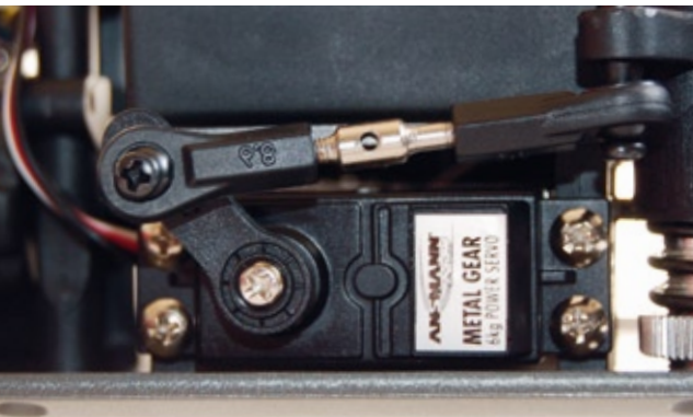
Das verbaute Lenkservo mit 6 Kilogramm Stellkraft und Metallgetriebe reicht locker aus
