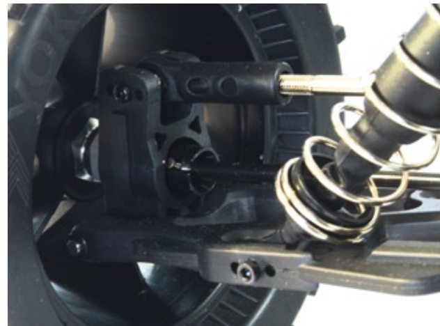
Am gesamten Modell kommen Knochenwellen zum Einsatz. Spur und Sturz können über Rechts-links-Gewindestangen verstellt werden
