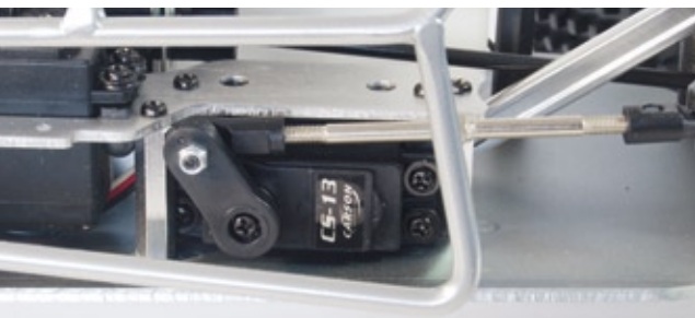
Ein 13-Kilogramm-Servo arbeitet an der Lenkung. Es ist ausreichend stark und schnell genug für jede Situation
