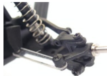
Einfache, schnell zu wechselnde Lexanbügel ersetzen klobige Lenkgestänge, behindern dabei aber etwas die Leichtgängigkeit der Aufhängung
