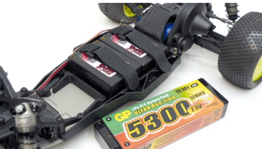
Durch den Einsatz eines Low-Profile-Servos kann man beide Akkuvarianten nutzen und erhält so nebenbei noch mehr Spielraum bei der Gewichtsverteilung
