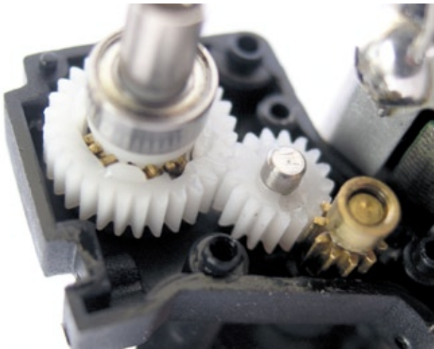
Die Getriebeinnereien fallen sehr klein aus, orientieren sich aber technisch stark an aktuellen 2WD-Offroadmodellen größerer Maßstäbe
