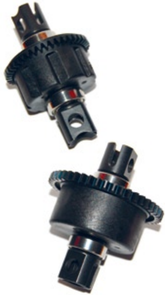
Das mittlere Differenzial (unten) nimmt viel mehr Öl auf als die gängigen Ausführungen von Front und Heck (oben)
