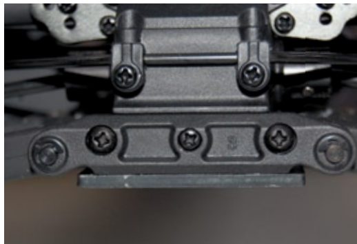
Der hintere Querlenkerhalter weist 3 Grad Vorspur auf. Mehr könnte man durch das Verstellen der hinteren Pivot-Ball-Halterungen erreichen
