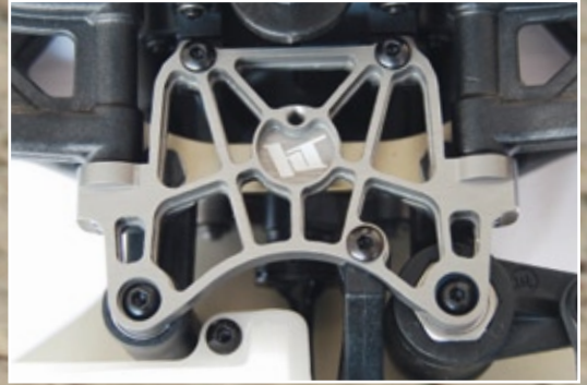
Ein filigran anmutendes aber sehr robustes Aluminiumteil stabilisiert nicht nur die beiden Pfosten der Lenkung, es bildet auch das hintere Lager der Schwingenstifthalter
