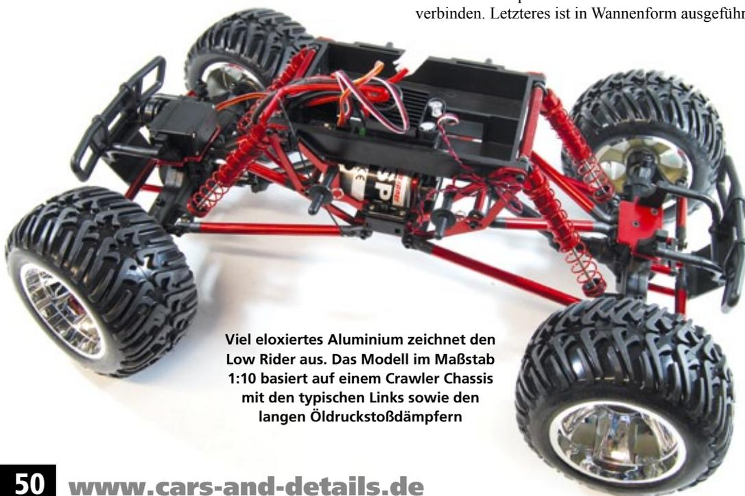
Viel eloxiertes Aluminium zeichnet den Low Rider aus. Das Modell im Maßstab 1:10 basiert auf einem Crawler Chassis mit den typischen Links sowie den langen Öldruckstoßdämpfern
