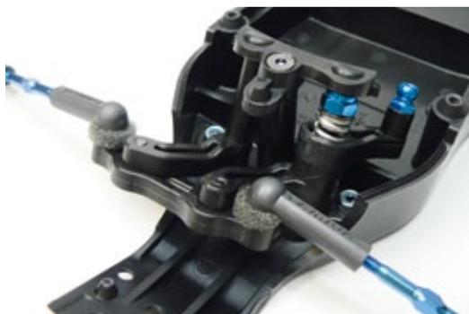
Die Vorderachskonstruktion ist auf das Wesentliche reduziert und gut für Wartungs- oder Einstellarbeiten zugänglich. Die Schaumstoffdichtringe sind Bestandteil des Baukastens
