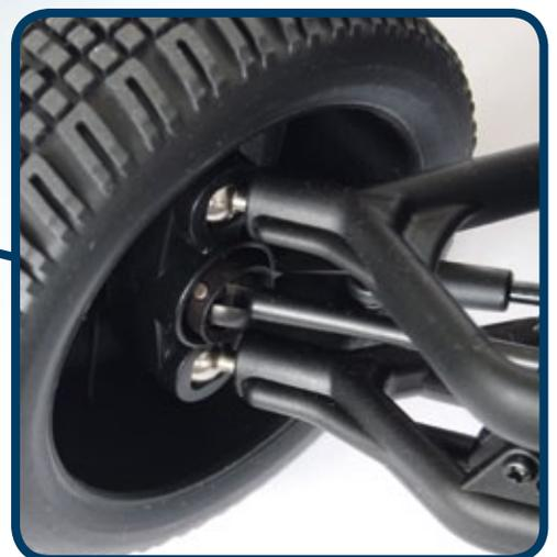
CVD-Wellen und Pivotball-Aufhängungen zur stufenlosen Verstellung des Radsturzes finden sich an allen vier Rädern
