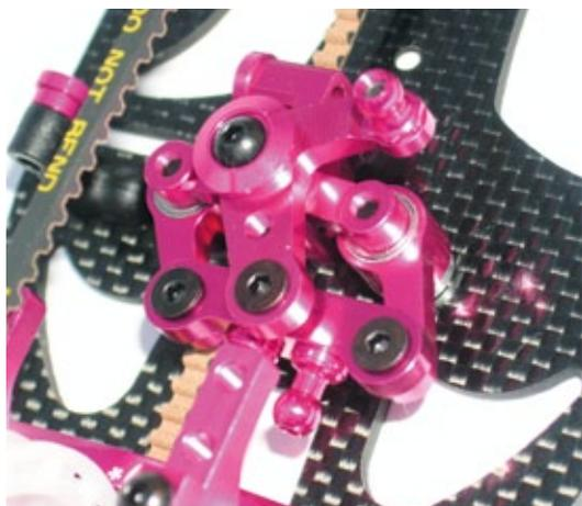
Die neue Doppelarm-Lenkung ersetzt die bisher verwendete Center-Point-Lenkung und soll für agileres Lenkverhalten sorgen
