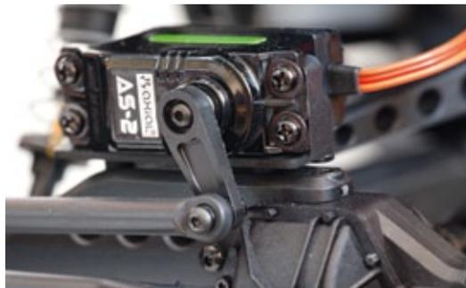
Das AS-2-Lenkservo von Axial beinhaltet Zahnräder aus Metall
