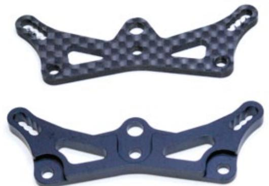
**Die Geometrie der beiden Dämpferbrücken vorne ist identisch, das Tuningmodell aus 4 Millimeter Aluminium macht einen nahezu unzerstörbaren Eindruck**
