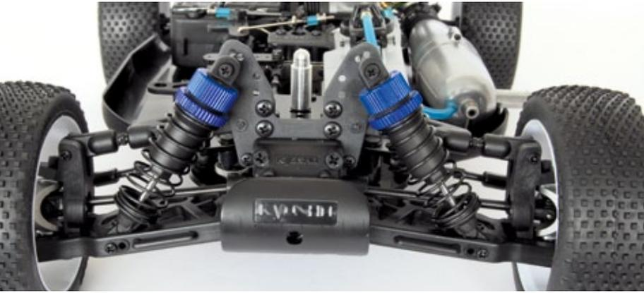
Die Achsen des Neo basieren auf Doppelquerlenkern mit Big-Bore-Stoßdämpfern. An der Vorderachse übernehmen CVD-Wellen die Weiterleitung der Motorkraft vom Diff an die Radachsen
