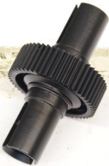
Das serienmäßig verbaute Kegelraddifferential wird durch ein leichteres und schneller justierbares Kugeldifferential ersetzt
