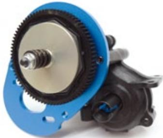
Die Motorhalteplatte ist mit 3 Millimeter extrem robust und die Abdichtung des Vorgeleges gut gelöst
