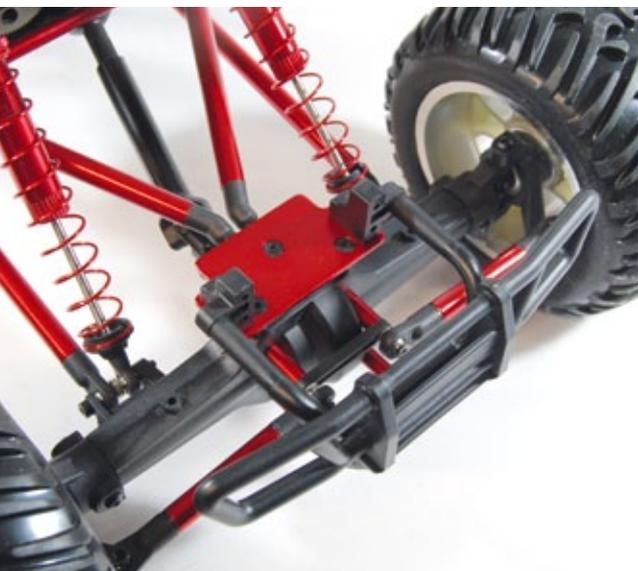
An der Hinterachse sind wie vorne auch Lenkhebel verbaut. Diese werden jedoch nicht über ein Gestänge angelenkt, sondern sind in ihrer Position fixiert
