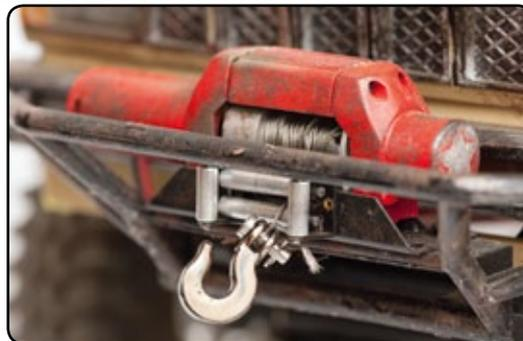
Hier ist alles aus Metall, die Rolle, das Seil, der Haken und auch das Gehäuse. Die Bulldog Winch von RC4WD hat einen hohen Scale-Faktor
