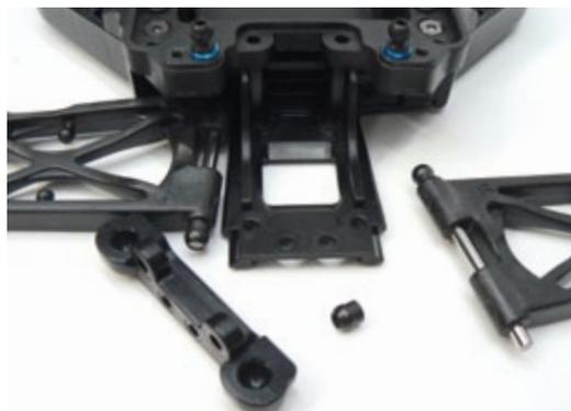
Die Querlenkeraufnahmen sind austauschbar, um verschiedene Antisquat- oder Vorspureinstellungen zu ermöglichen. Die dafür erforderlichen Teile liegen dem Baukasten allerdings leider nicht bei
