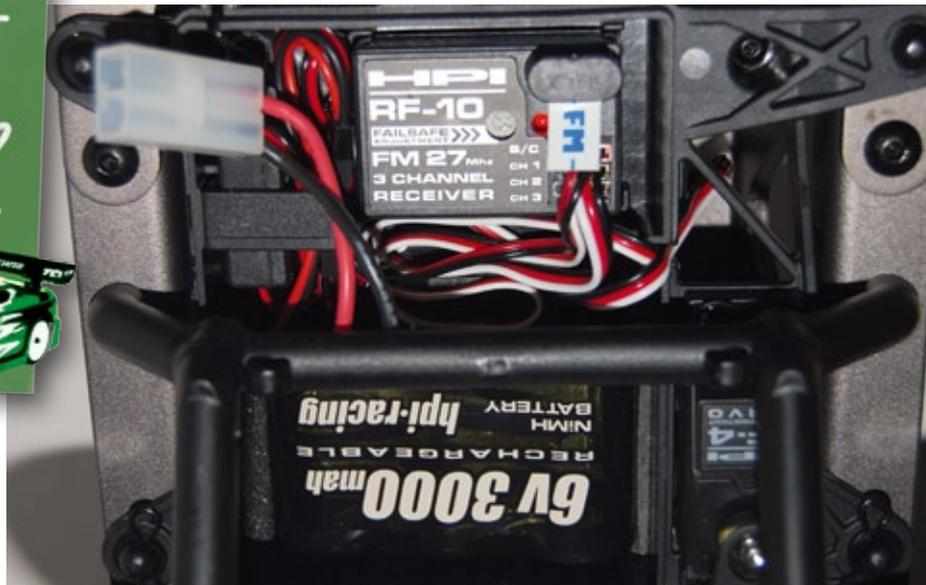
sich um ein Modell mit Elektroantrieb, ist vorher noch sicherzustellen, dass die Räder keinen Kontakt zum Boden haben. Nun kann man prüfen, ob Servos und Fahrregler in die gewünschten Positionen fahren und diese auch halten. Ist das nicht der Fall, sollte das Failsafe mit Hilfe der Bedienungsanleitung neu justiert werden.
