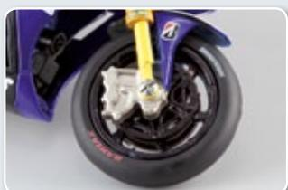
Der Nachlauf am Vorderrad kann eingestellt und damit das Lenkverhalten an die Streckenbedingungen und Setup angepasst werden.
