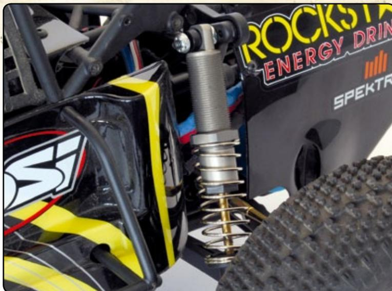
Die langen Gewinde der hinteren Dämpfer ermöglichen eine exakte Anpassung an die jeweiligen Streckenbedingungen. Gleiches gilt für die Gewindestange der oberen Querlenker
