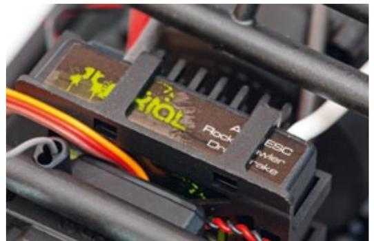
Der von Castle entwickelte Regler ist mit Klipsen befestigt
