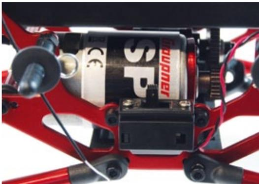
Für den Antrieb sorgt ein Speed 600-Bürstenmotor. Dieser ist zwischen der oberen und der unteren Chassisplatte platziert
