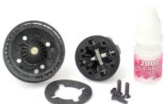
**Über das wartungsarme und leichtgängige Kegelraddifferenzial treibt der Motor die Hinterräder an**
