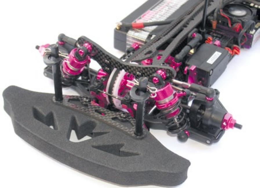
**Neue Bulkheads und neue Schwingen finden sich auch an der Vorderachse**
