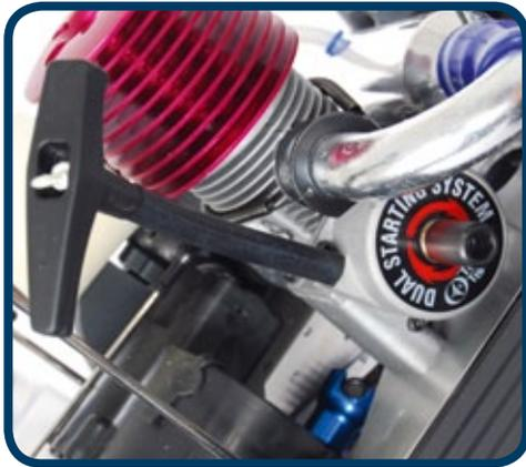
Der 28er-Nitromotor kann über den Seilzugstarter oder den beiliegenden Sechskantmitnehmer, der sich in jeden handelsüblichen Akkuschrauber einspannen lässt, gestartet werden
