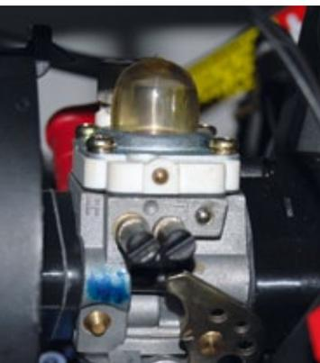
Die Vergaser vieler Großmodelle verfügen über eine halbkugelförmige Kunststoffkonstruktion, mit der sich Sprit bequem zum Vergaser pumpen lässt
