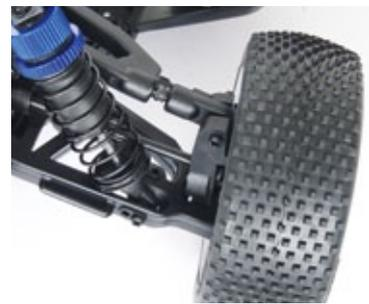
An der Hinterachse sind Knochenwellen verbaut. Sie treiben die genoppten Buggyreifen an
