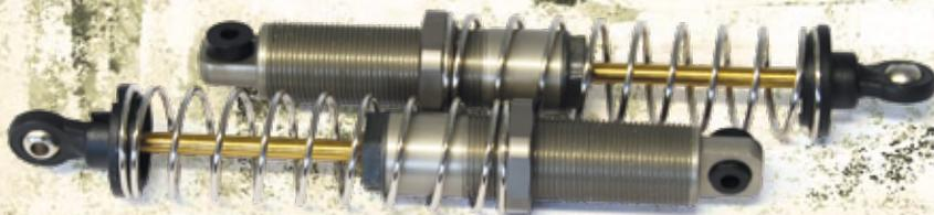
Kunststoff ist bei den Stoßdämpfern passé. Anders als bei den Standardgehäusen, bei denen die Federvorspannung über C-Klipse eingestellt wurde, kommen nun Rändelmuttern zum Einsatz
