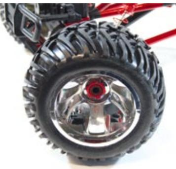
Der Schwerpunkt des Low Rider liegt für effektives Crawl etwas zu hoch. Jedoch sind die Räder – so schick sie auch aussehen mögen – leider verklebt. Der Einsatz von Beadlock-Ringen würde das Aufbleien erleichtern
