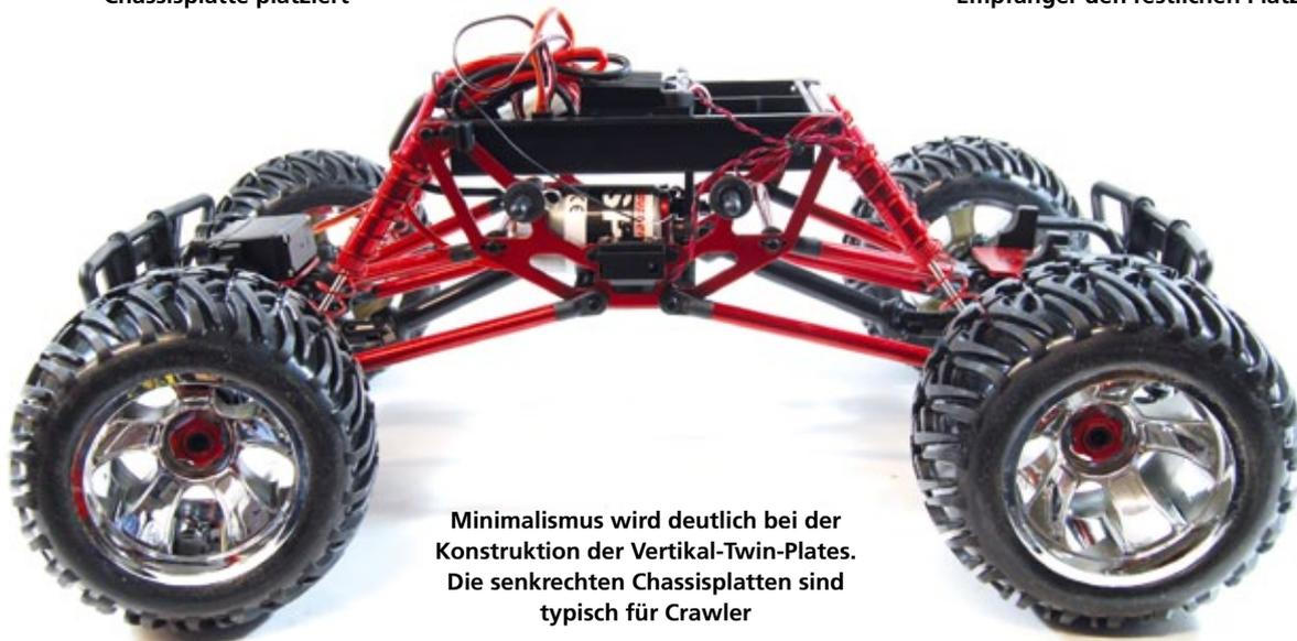
Minimalismus wird deutlich bei der Konstruktion der Vertikal-Twin-Plates. Die senkrechten Chassisplatten sind typisch für Crawler
