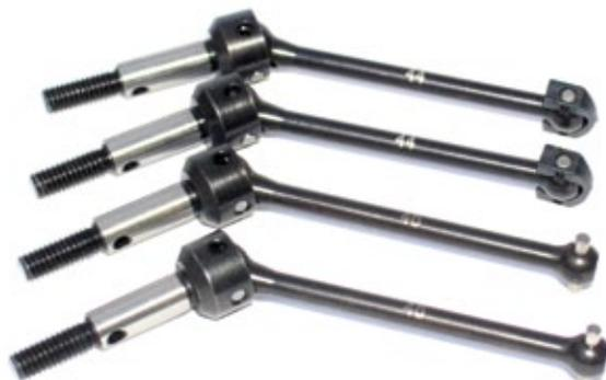
**Damit die Motorleistung sicher an den Räder ankommt, ist ein Doppelsatz CVD-Kardans in der haltbaren Stahlversion verbaut**
