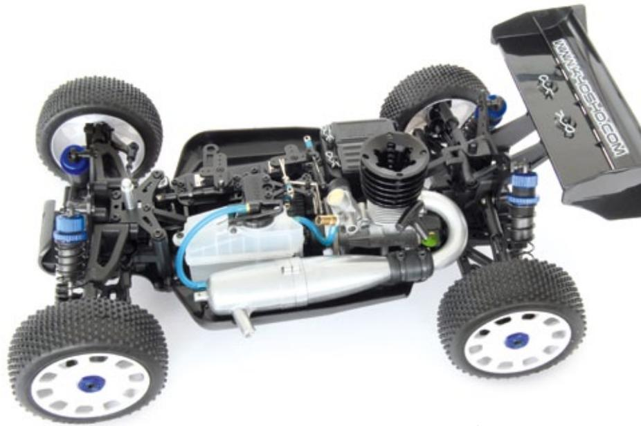
Das Chassis des Boliden präsentiert sich aufgeräumt. Die RC-Komponenten sind in staubgeschützten Boxen neben dem Motor platziert
