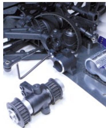
**Die Aluminiumausführung des vorderen Wellenbocks hat gleich mehrere Vorteile: Zum einen sorgt der Bock für eine perfekte Lagerung ohne Verwindungen. Zum anderen dient er zur Befestigung des Reso-Rohrs, das serienmäßig an der Radioplatte fixiert wird**
