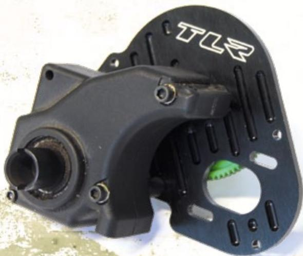
Die Standard-Motorplatte wird durch ein Pendant mit dem TLR-Schriftzug ersetzt. Das Getriebe selber wird vollständig ausgetauscht
