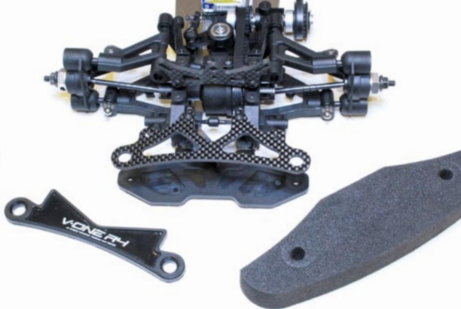
**Im Gegensatz zur serienmäßigen Kunststoffplatte, stützt sich die Kohlenfaser-Variante auf den Bulkheads der Vorderachse ab. Neben dem optischen Effekt, sorgt sie für eine Verstärkung der Rammereinheit**
