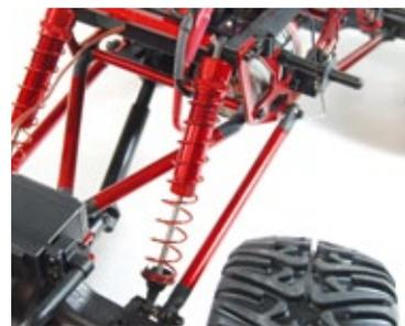
Links in Kombination mit langen Alu-Öldruckstoßdämpfern ermöglichen eine gute Verschränkung
