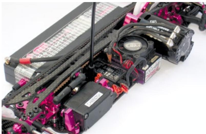
Auf der Elektronikseite sorgt der neu positionierte Motor für einen zentraleren Schwerpunkt, das Lenkservo sitzt längs in Fahrtrichtung und steuert über die neue Doppelarmlenkung die Vorderräder an
