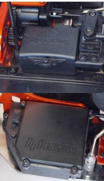
Die RC-Boxen beider Truggys sind wasserdicht ausgeführt. Beim 4.6er (unten) fällt sie größer aus, da neben dem Empfänger noch der Empfängerakku darin untergebracht werden muss
