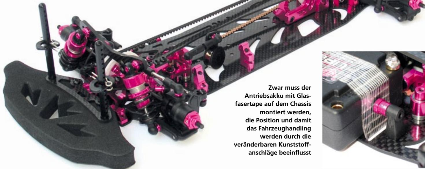
Zwar muss der Antriebsakku mit Glasfasertape auf dem Chassis montiert werden, die Position und damit das Fahrzeughandling werden durch die veränderbaren Kunststoffanschlüge beeinflusst
