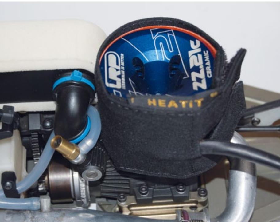
Bei fabrikneuen Nitromotoren empfiehlt sich eine Vorrichtung, mit der sie vor dem ersten Start auf Betriebstemperatur gebracht werden. Dies gilt besonders bei niedrigen Außentemperaturen
