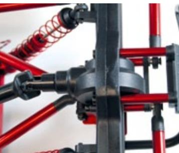
In den starren Pendelachsen des Low Rider verteilen Kegeldifferenziale über Knochenwellen die Motorkraft an die Radachsen
