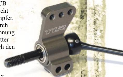
Die Kunststoff-Achsträger an der Hinterachse haben ausgedient. Hier kommen nun Pendants aus Aluminium zum Einsatz
