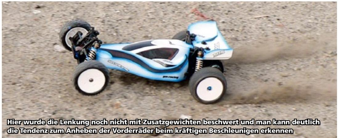
Hier wurde die Lenkung noch nicht mit Zusatzgewichten beschwert und man kann deutlich die Tendenz zum Anheben der Vorderräder beim kräftigen Beschleunigen erkennen
