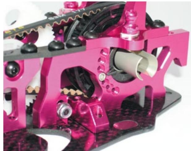
Die Diff-Excenter werden nun an den Bulkheads angeschraubt und können deshalb auch im verbauten Zustand verdreht werden
