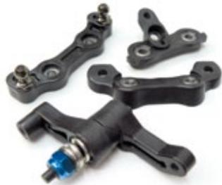
Diverse Kugellager, hochwertiger faserverstärkter Kunststoff und ein einstellbarer Servosaver gehören selbstredend zu einer modernen Lenkung – auch die Qualität und Stabilität der Teile sind optimal
