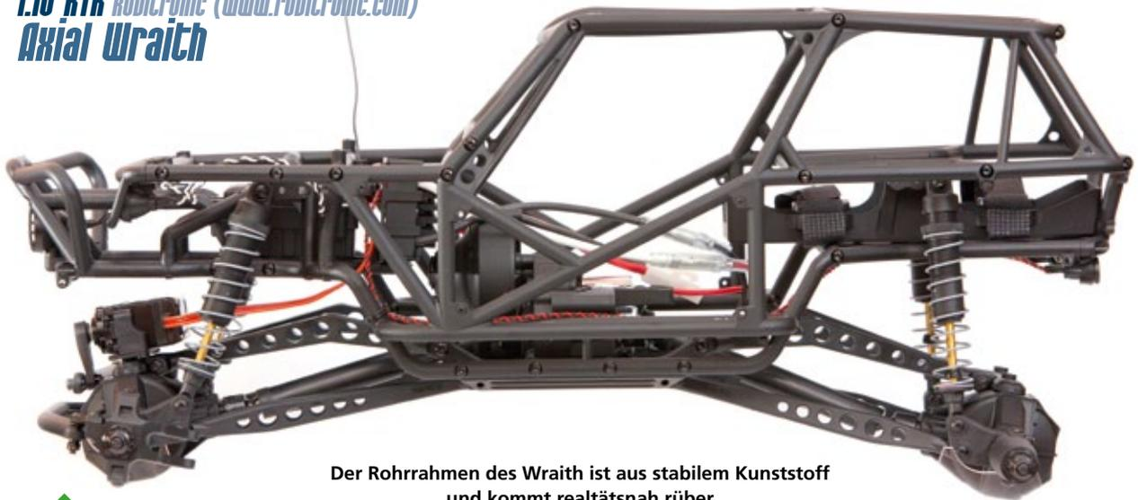
Der Rohrrahmen des Wraith ist aus stabilem Kunststoff und kommt realitätsnah rüber
