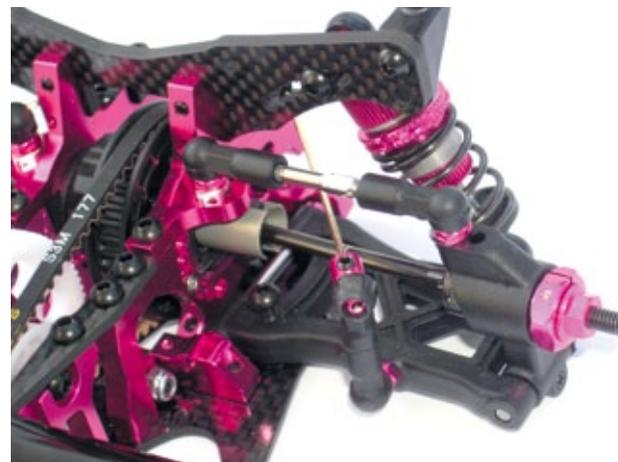
Komplett überarbeitet wurde die Hinterachse: eine geänderte Dämpferbrückenposition, neue Bulkheads, neue Schwingen und ein nun verbautes Kegeldiff sollen für den Anschluss an die Konkurrenz sorgen
