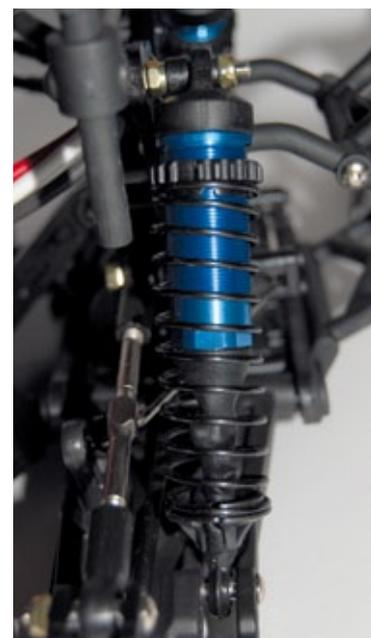
**Großvolumige Öldruckdämpfer aus Aluminium bringen Ruhe ins Fahrwerk**
