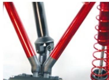
Die Teleskopkardans sind solide ausgeführt und garantieren einen haltbaren Antrieb
