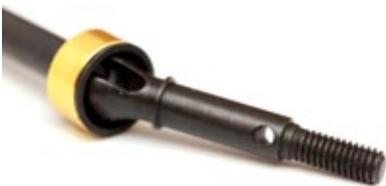
Die CNC-gefertigten Achswellen bestehen aus gehärtetem Stahl und erhöhen den Lenkeinschlag von 32 auf bis zu 36,5 Grad
