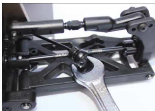
Die Koppelstangen der Stabis werden direkt in die Querlenker geschraubt und sind dort mit einem Kugelkopf gelagert
