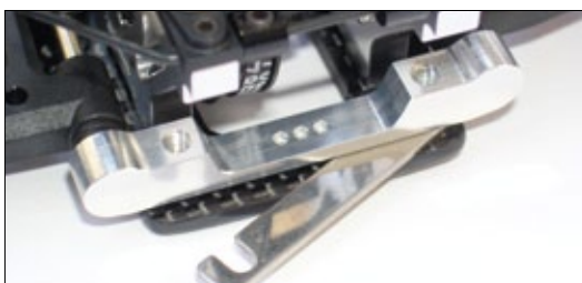
Durch einfaches Unterlegen von Distanzstücken unter die Schwingenstifthalter werden Rollcenter und Kickup verändert
