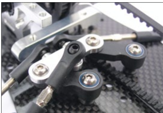
Die kugellagerbestückten Kunststoffarme ergeben im Zusammenspiel mit der Aluminiumlenkbrücke eine verwindungssteife, spielarme und leichtgängige Lenkeinheit
