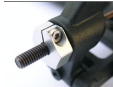
Gefräste Klemm-Radmitnehmer aus Aluminium sorgen für optimalen Rundlauf der Antriebsräder
