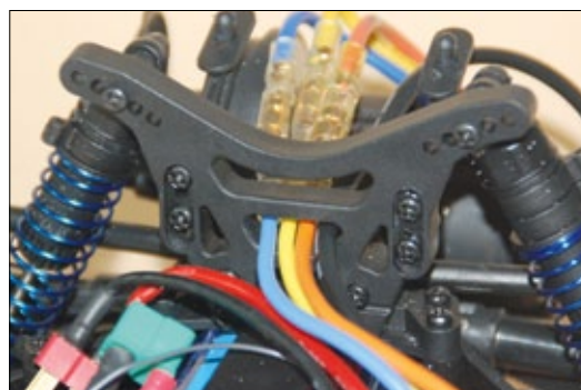
Je fünf Befestigungspunkte bieten individuelle Einstellmöglichkeiten an der hinteren Dämpferbrücke
