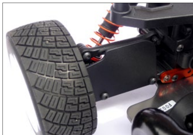
Mudguards an den hinteren Querlenkern schützen die Stoßdämpfer vor übermäßiger Verschmutzung
