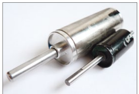
Der Größenunterschied zwischen einem Standard 540er-Rotor (rechts) und einem Rotor aus einem 75 Millimeter langen 1:8er-Buggy-Motor ist gewaltig
