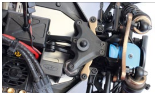
Die Alu-Teile der Sport-Version sind nicht gefräst, sondern gestanzt
