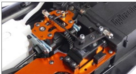
Das Gas/Brems-Servo ist wassergeschützt. Die Bremse lässt sich für vorne und hinten getrennt einstellen
