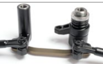
Zur Veränderung des Ackermann-Winkels sind im Serpent-Zubehörsortiment verschiedene Alu-Verbinder der beiden Lenkpfosten erhältlich
