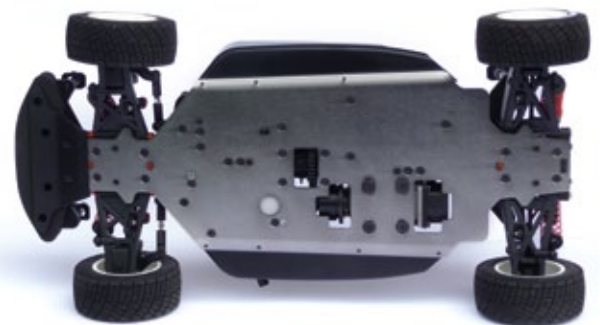
Am Aluminiumchassis kommen durchweg gesenkte Schrauben mit Inbusköpfen zum Einsatz
