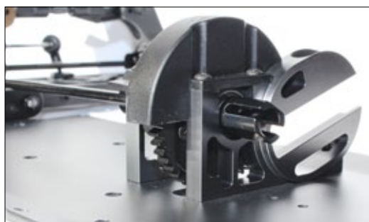
Im vorderen Lagerbock des Mitteldiffs ist auch der Motorhalter integriert
