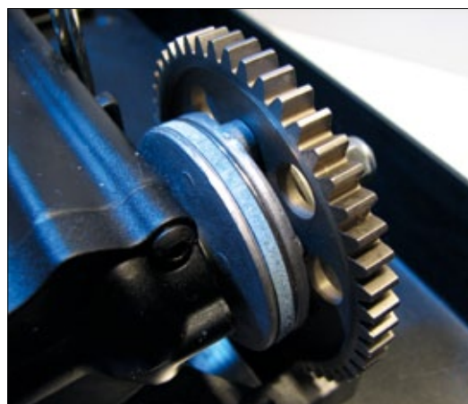
Auch hier setzt Thunder Tiger auf Langlebigkeit: Der Reibbelag der Slipperkupplung ist fast 5 Millimeter stark
