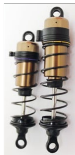
Unter anderem sind die Stoßdämpfer der Abspeckkur der Sportvariante zum Opfer gefallen. Hier kommen keine Rändelschrauben zum Einsatz, sondern C-Klipse
