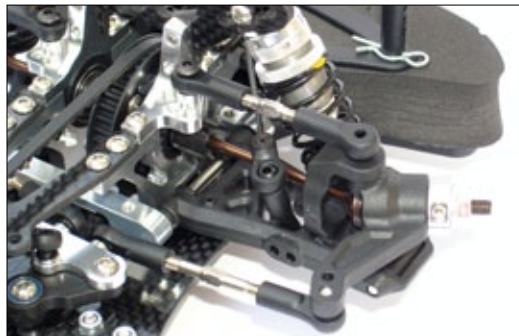
An der klassischen C-Hub-Konstruktion der Vorderachse kommt derzeit kein Hersteller eines wettbewerbsfähigen Tourenwagenchassis vorbei
