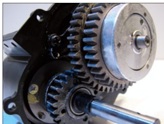
Gut geschmierte Getriebezahnräder aus Stahl für den harten Einsatz
