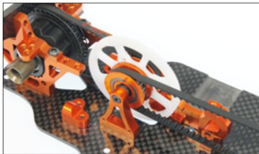
An der Hinterachse des Tourers werkelt ein Vierspider-Diff. Davor ist die Einheit aus Riemen- sowie Hauptzahnrad und Pulley verbaut
