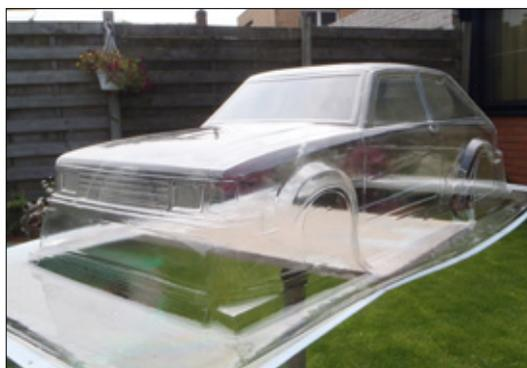
Die tiefgezogene Karosserie besteht nicht aus Lexan, sondern aus 1,5-Millimeter-PET-Material
