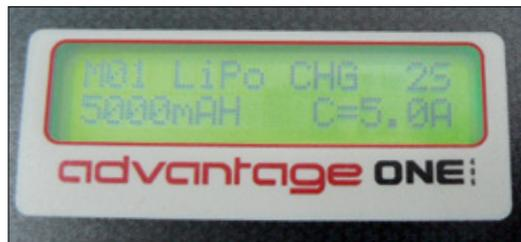
Im Akkuspeicher hinterlegte Daten ermöglichen ein sehr schnelles Laden des passenden Akkus. Das Display zeigt alle relevanten Werte gut ablesbar an
