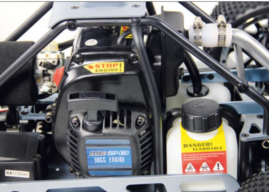
Das Herzstück des ST ist der quer eingebaute Benzinmotor
