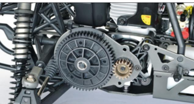
Der Motor überträgt seine Kraft mit einem 17-Zähne-Ritzel auf ein 57-Zähne-Hauptzahnrad aus Kunststoff
