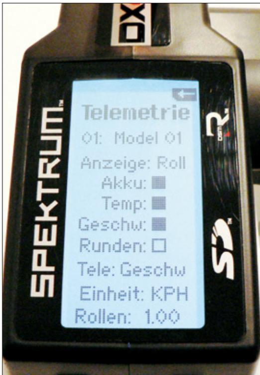
Die integrierte Telemetriefunktion mag nicht bei jedem Rennen erlaubt sein, beim Training hilft sie aber, eventuelle Schwachstellen in der Abstimmung zu finden. Hierzu werden allerdings optionale Sensoren im Modell sowie der telemetriefähige Empfänger SR3300T benötigt
