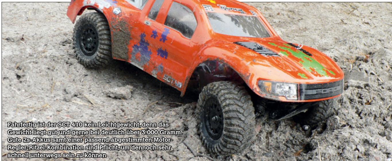
Fahrfertig ist der SCT 410 kein Leichtgewicht, denn das Gewicht liegt gut und gerne bei deutlich über 3.000 Gramm. Gute 2s-Akkus samt einer passend abgestimmten Motor-Regler-Ritzel-Kombination sind Pflicht, um dennoch sehr schnell unterwegs sein zu können
