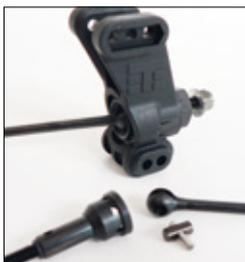
Neben der sauberen Befestigung des Querpins mittels des großen Kugellagers fallen einem die mehrfachen Bohrungen in der Welle auf – ein Austausch der Welle wegen ausgeschlagener Bohrungen fällt somit erst deutlich später an
