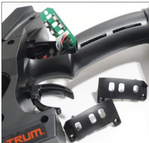
Der Umbau der DX4R Pro zum Linkshändersender ist mitunter etwas fummelig, da die recht kurzen Kabel sehr sauber im Griff verstaut werden müssen, um Beschädigungen vorzubeugen. Alle für den Umbau benötigten Teile und die zölligen Inbusschlüssel liegen dem Set selbstverständlich bei
