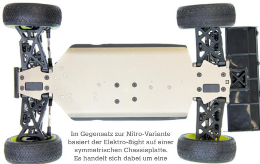
Im Gegensatz zur Nitro-Variante basiert der Elektro-8ight auf einer symmetrischen Chassisplatte. Es handelt sich dabei um eine spezielle Konstruktion, nur für die Brushlessversion
