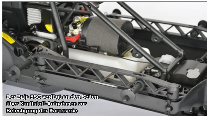
Der Baja 5SC verfügt an den Seiten über Kunststoff-Aufnahmen zur Befestigung der Karosserie
