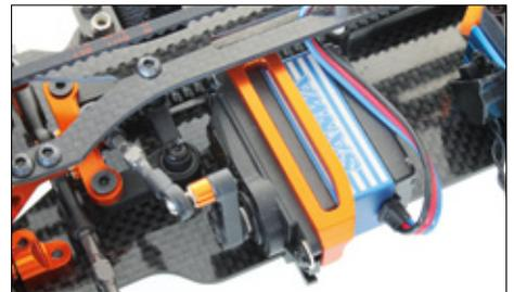
Auf die andere Seite wandert ein 2s-LiPo mit einer Kapazität von 5.300 Milli-amperestunden in die Halterung. Dadurch, dass alle Komponenten nahe der Chassis-Mitte platziert sind, verschiebt sich der Schwerpunkt des Modells dementsprechend, was auf gute, ausgewogene Fahreigenschaften hoffen lässt. Bei der Karosserie fiel die Wahl auf einen Deckel aus dem Hause Protoform – die LTC-R Regular. Diese zeichnet sich dadurch aus, dass sie verstärkt Grip auf der Vorderachse liefert.
