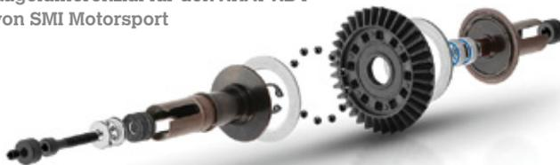
Das neue, von außen einstellbare **Kugeldifferenzial** für den XRAY XB4 wird aus hochwertigem HUDY-Federstahl gefertigt und sorgt für Abhilfe bei Traktionsproblemen. Der Grip auf loseem Untergrund erhöht sich und die rotierende Masse wird verringert. Für eine lange Haltbarkeit verfügt das Kugeldifferenzial sowohl über ein Wolfram-Drucklager als auch über 2,4 Millimeter dicke Kugeln aus Keramik. Die Montage wird durch ein komplett ab Werk eingestelltes Differenzial beschleunigt.
