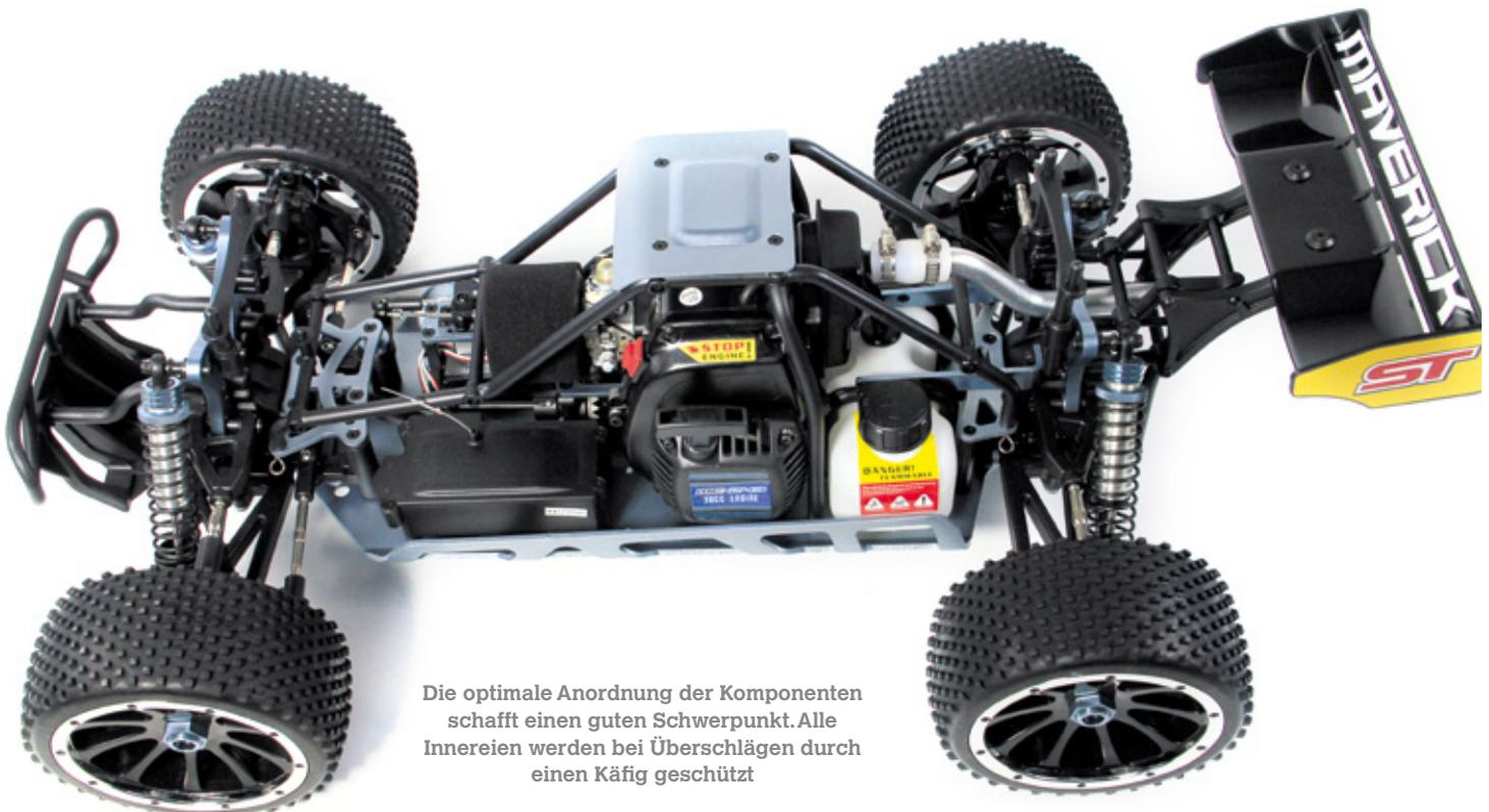
Die optimale Anordnung der Komponenten schafft einen guten Schwerpunkt. Alle Innereien werden bei Überschlügen durch einen Käfig geschützt
