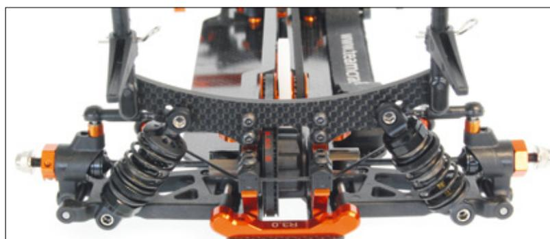
45 Millimeter langen Big Bore-Öldruckstoßdämpfern aus Aluminium, deren Federvorspannung über eine Rändelschraube stufenlos justiert werden kann.
