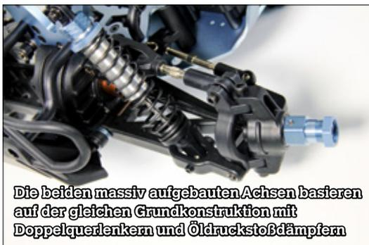
Die beiden massiv aufgebauten Achsen basieren auf der gleichen Grundkonstruktion mit Doppelquerlenkern und Öldruckstoßdämpfern
