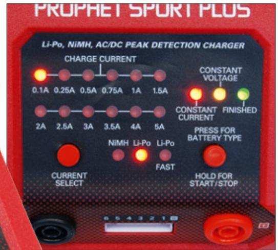
Die Bedienung erfolgt über zwei Taster. Die 18 LED geben Aufschluss über die gewählten Konfigurationen
