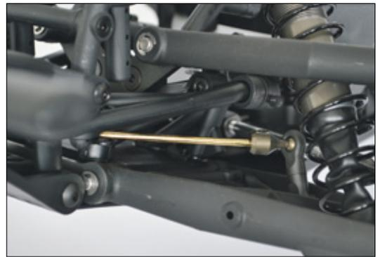
Der Baja 5SC ist serienmäßig mit Stabilisatoren vorne und hinten ausgestattet. Das ist aufgrund des hohen Schwerpunkts auch nötig
