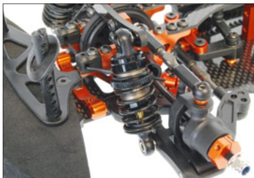
Die Vorspannung der Dämpferfedern kann über Rändelschrauben stufenlos eingestellt werden
