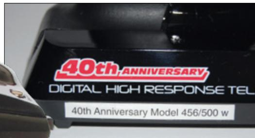
Weniger gelungen erscheint die Anbringung der Seriennummer. Statt sie ins Gehäuse einzugravieren, wurde sie einfach auf ein Klebeschild gedruckt
