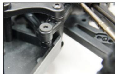
Es empfiehlt sich, an den Chassiswangen etwas Material zu entfernen, um einen größeren Lenkanschlag zu realisieren
