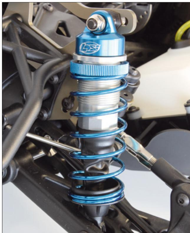
Die hervorragend verarbeiteten Aluminium-Bigbore-Dämpfer kennt man bereits vom 5ive-T
