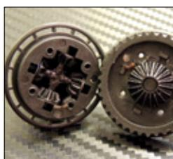
Das Differential ist ab Werk kaum geschmiert. Mit einer Ölfüllung ist ein deutlicher Performance-Zuwachs zu verspüren
