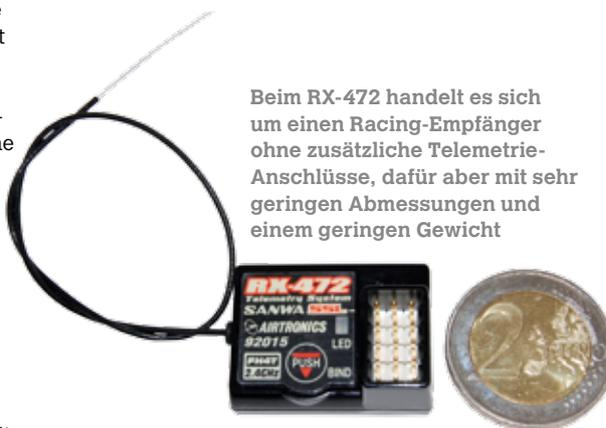
Beim RX-472 handelt es sich um einen Racing-Empfänger ohne zusätzliche Telemetrie-Anschlüsse, dafür aber mit sehr geringen Abmessungen und einem geringen Gewicht
