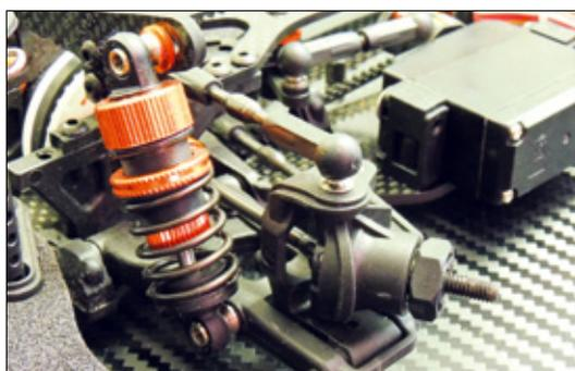
Die Dämpfer verfügen über ein Außengewinde zur Einstellung der Federvorspannung
