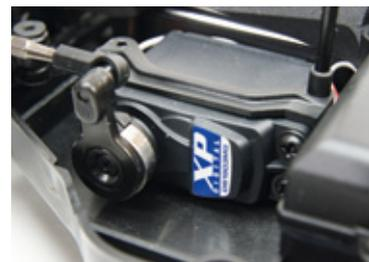
Dank Metallgetriebe und effektivem Servosaver sollte das XP DS1903MG-Lenkservo einiges überstehen. Es ist zwar nicht das schnellste Servo, aber vollkommen ausreichend
