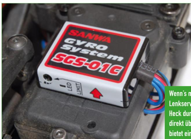
Wenn's mal rutschig wird, kann das Gyrosystem SGS-01C aushelfen. Es wird zwischen Lenkservo und Empfänger geschaltet und korrigiert während der Fahrt ein ausbrechendes Heck durch blitzschnelles Gegenlenken. Der Kreisel lässt sich in einer SSL-Umgebung direkt über den Sender abstimmen. Bei Verwendung von Standardkomponenten ohne SSL bietet ein kleines Poti am Gehäuse die Möglichkeit der manuellen Justierung
