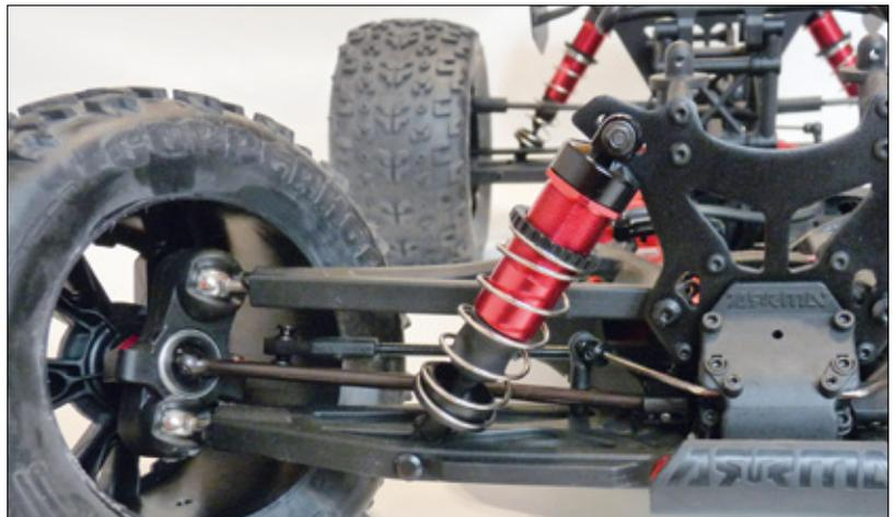
Der Kraton verfügt mit 162 Millimeter über extrem lange hintere Querlenker, die zusammen mit dem gut zum Modellgewicht passenden Dämpfersetup jegliche Bodenunebenheiten einfach wegbügeln
