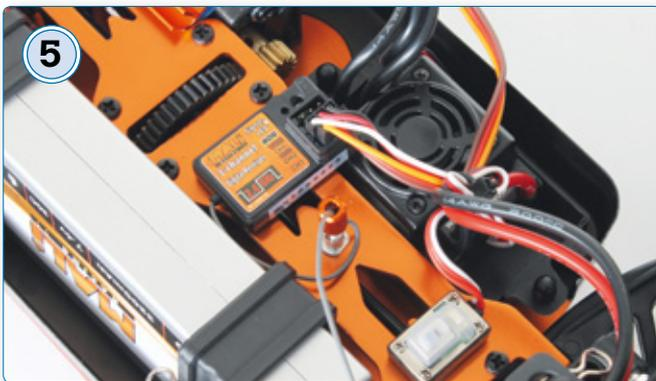
5 Alle Komponenten sind gut zugänglich und die Kabel sind sauber verlegt. Der Empfänger arbeitet im 2,4-Gigahertz-Band
