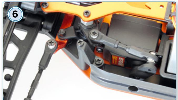
6 Das liegend verbaute Lenkservo mit einer Stellkraft von 9 Kilogramm bewegt die Vorderräder über einen Servo-Saver
