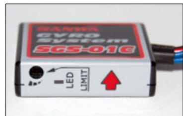
Der rote Pfeil kennzeichnet die Drehachse des Gyros. Er muss je nach Modell immer senkrecht nach oben oder unten zeigen
