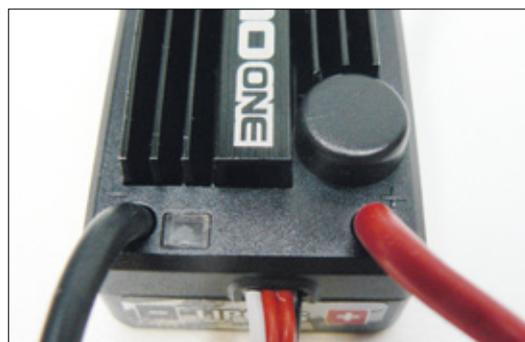
Am komplett spritzwassergeschützten Regler weist nur ein kleines Glas neben dem Minuskabel für die rote LED auf seine Einstellmöglichkeiten hin. Diese lassen sich über Blinkcodes und den ebenfalls spritzwassergeschützten Taster verändern
