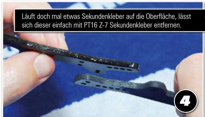
Läuft doch mal etwas Sekundenkleber auf die Oberfläche, lässt sich dieser einfach mit PT16 Z-7 Sekundenkleber entfernen.
