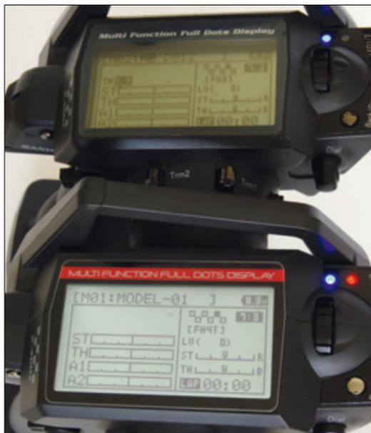
Bei Dämmerlicht zeigt sich der Unterschied besonders deutlich: oben die MT-4 ohne, unten die MT-4S mit Displaybeleuchtung
