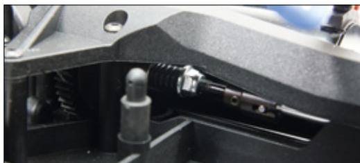
Der Slipper am Pro Rally ist einstellbar und befindet sich auf der Hauptwelle zwischen vorderem und hinterem Differential
