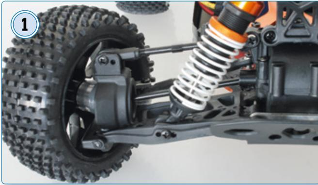
1 Die soliden Doppelquerlenker-Achsen bieten zahlreiche Einstellmöglichkeiten und sind mit verstellbaren Öldruckstoßdämpfern ausgestattet
