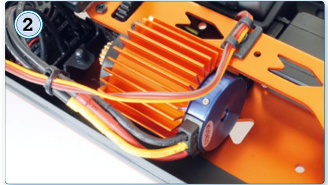
2 Der bürstenlose Innenläufer mit einer spezifischen Drehzahl von rund 3.400 Umdrehungen pro Minute und Volt ist mit einem Kühlfächer versehen
