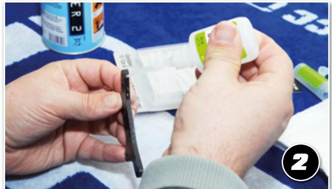
Sekundekleber in Tropfen auf die zu versiegelnden Kanten geben - der Kleber muss nun über die gesamte Kante aufgebracht werden...
