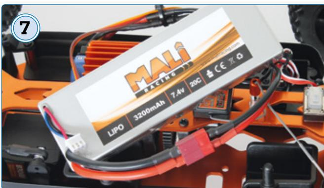
7 Ein 2s-LiPo mit einer Kapazität von 3.200 Milliamperestunden gehört zum Lieferumfang und sorgt für Vortrieb
