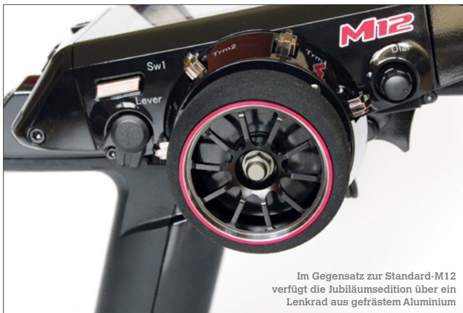
Im Gegensatz zur Standard-M12 verfügt die Jubiläumsedition über ein Lenkrad aus gefrästem Aluminium
