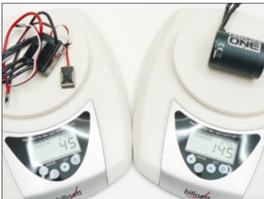
Gerade das Gewicht des Reglers ist trotz langer Kabel extrem gering, wobei auch der sensorlose Motor eher im unteren Gewichtssegment angeordnet ist
