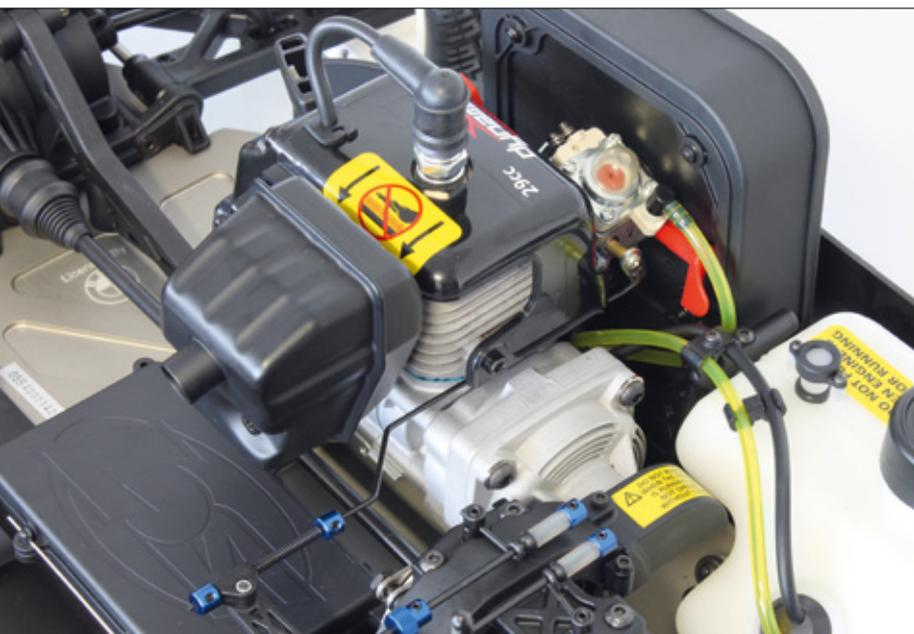
Das Herzstück des Mini ist der 29-Kubikzentimeter-Benziner von Dynamite. Er überzeugt durch sehr gutes Laufverhalten und scheidt ordentlich an
