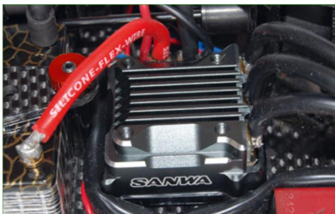
Zur Ansteuerung von sensorbasierten Brushlessmotoren bietet Sanwa den Fahrtenregler Super Vortex Zero an. Er ist grundsätzlich zu allen gängigen Technologien kompatibel, arbeitet also auch mit markenfremden Motoren zusammen. In Verbindung mit dem RX-472-Empfänger und SSL-Technik läuft er zu absoluter Höchstform auf
