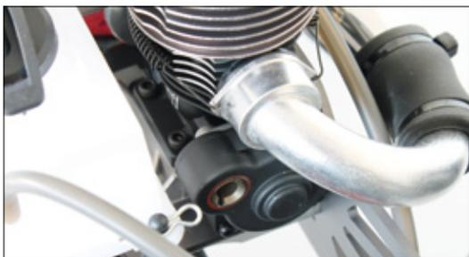
Über diesen kleinen Mitnehmer wird der Motor angelassen. Dazu liegt dem Set das bewährte HPI-Roto-Start-System bei
