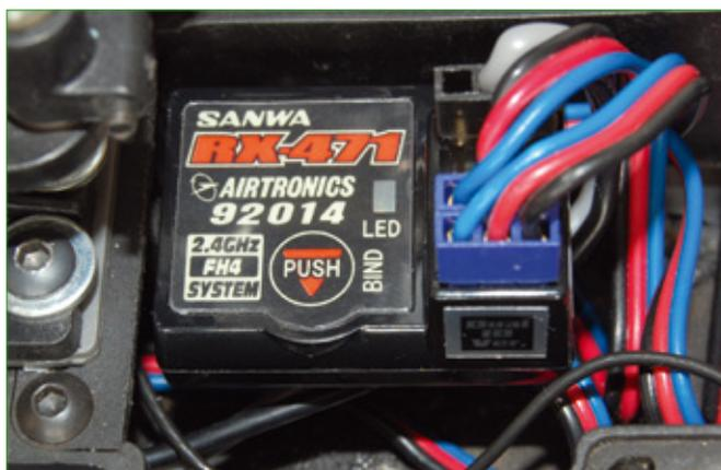
Der RX-471 ist ein moderner, sehr kleiner Vierkanalempfänger. Er unterstützt neben der Standard-Übertragung (NOR) auch Sanwas hauseigene Verfahren SHR und SSR, ist aber nicht SSL-fähig
