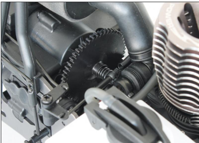
Das Stahl-Hauptzahnrad ist über eine Slipper-Kupplung mit dem Getriebe verbunden
