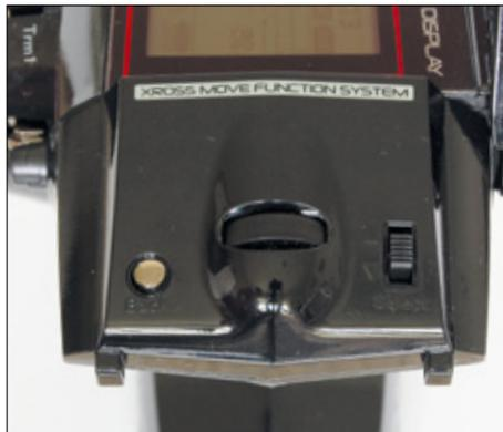
Eingriffe in die Menüstruktur werden mit drei zentralen Steuerelementen vorgenommen. Darüber hinaus gibt es noch diverse Trimmshalter, Drehregler und Schalthebel für direkten Zugriff auf frei definierbare Funktionen
