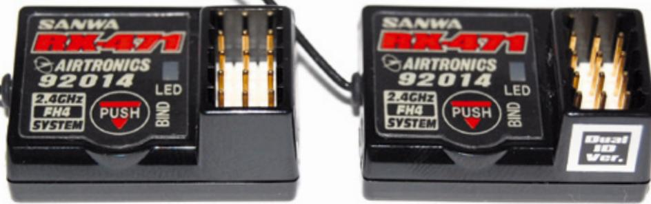
Nur auf den ersten Blick sind die zwei RX-471 identisch. Einer von ihnen verfügt über das Dual-ID-Feature, das die Anbindung von zwei unterschiedlichen Sendern erlaubt
