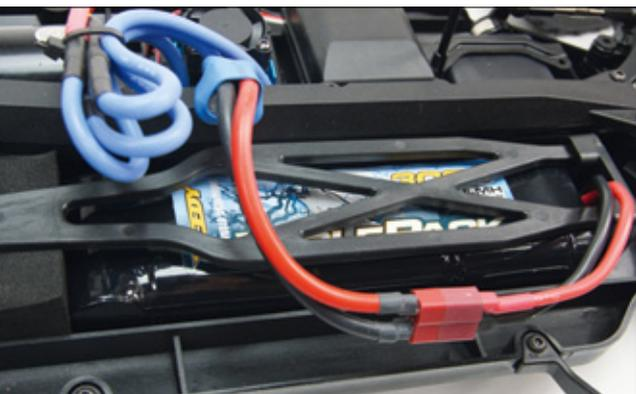
Im langen Akkuschatz kann der mitgelieferte siebenzellige NiMH-Akku in der vorderen oder hinteren Position befestigt werden. 2s- und 3s-LiPos passen ebenfalls
