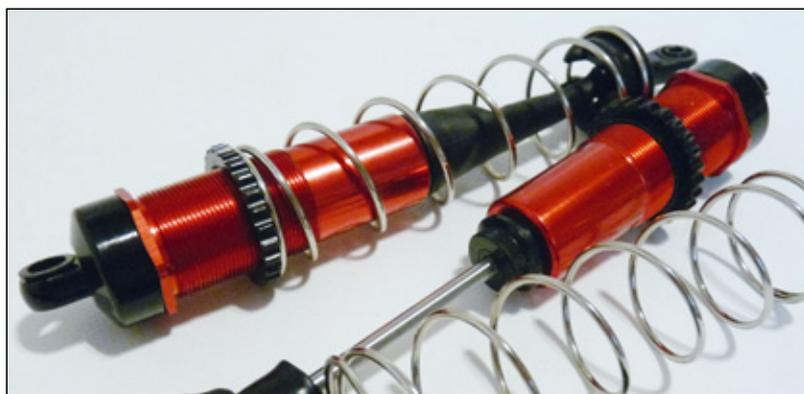
Schraubbare untere Dichtungen, oberen Kappen aus Alu und Gummimanschetten für die Kolbenstangen kombiniert mit einem großen Ölvolumen und sauber dichtenden Dämpfern sorgen für eine optimale Federung des knapp 4.600 Gramm schweren Modells
