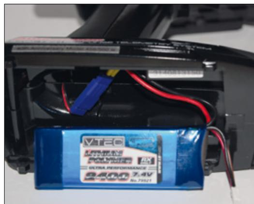
Mittels eines 2s-LiPos lässt sich das Gesamtgewicht der Anlage niedrig halten und gleichzeitig lange Betriebszeiten erreichen
