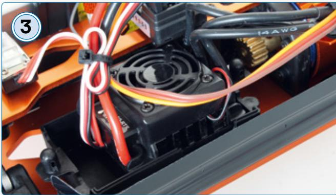
3 Der 45-Ampere-Regler ist wasserdicht und wird über einen kleinen Lüfter aktiv gekühlt
