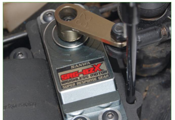
Trägt ein Sanwa-Servo wie dieses BZX Type R das Kürzel SRG am Anfang seiner Bezeichnung, so darf es im ultra schnellen, Sanwa-eigenen SSR-Modus arbeiten
