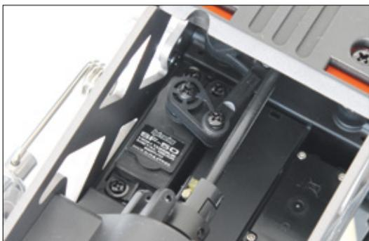
Das SF-50-Metallgetriebeservo hat ausreichend Stellkraft und arbeitet auch nach etlichen Betriebsstunden noch zuverlässig
