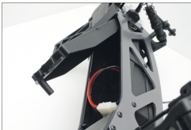
Der Akkufachdeckel ist von unten schnell zugänglich. Erstklassige Sache für schnelle Boxenstopps
