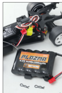
Der Fahrakku wird im Chassis eingehängt und mit zwei Splinten gesichert
