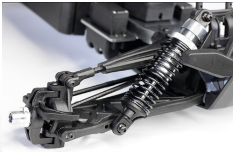
Solide C-Hub-Aufhängungen finden sich an der Vorderachse
