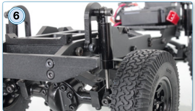
Die Aluminium-Federbeine haben keine Dämpfung und der Arbeitsweg ist eher kurz
