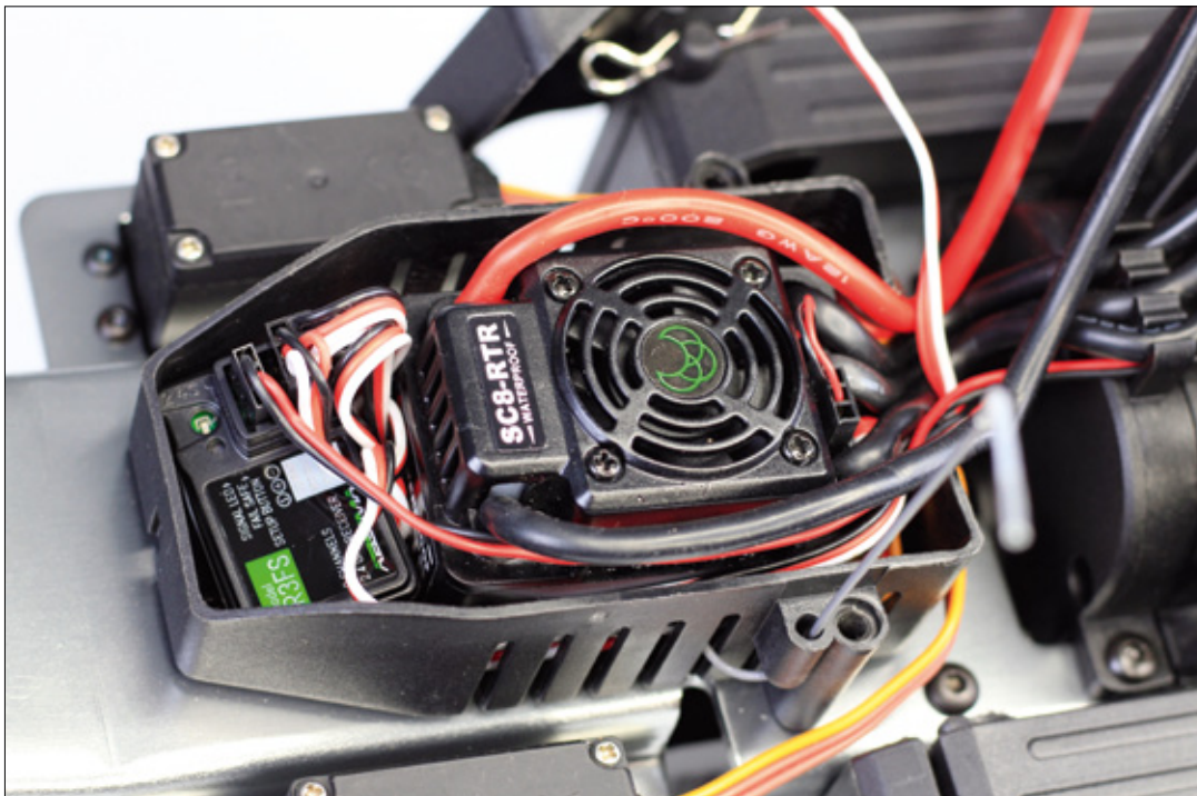
In der RC-Box finden sowohl der Mini-Empfänger als auch der wasserfeste Brushlessregler Platz
