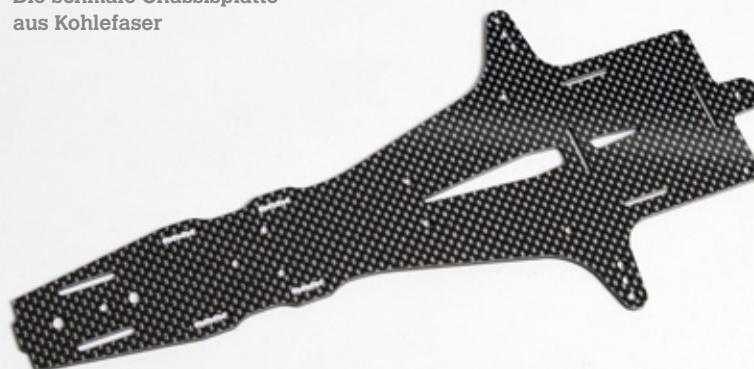
Die schmale Chassisplatte aus Kohlefaser
