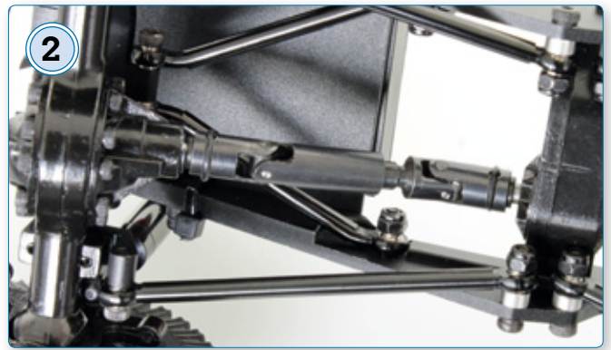
Teleskopwellen aus Stahl übernehmen die Kraftübertragung zu den vollgesperrten Achsen
