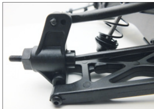
An der Hinterachse kommen typische Antriebsknochen zum Einsatz. Gut dimensionierte Querlenker versprechen gute Haltbarkeit
