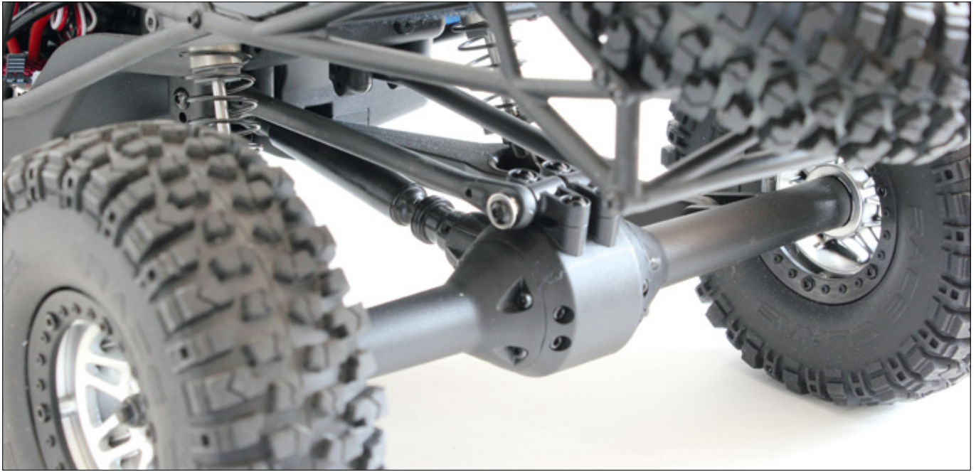
Für enorme Verschränkung sorgt eine Starrachse hinten zusammen mit langen Öldruckstoßdämpfern und einer Vier-Link-Aufhängung
