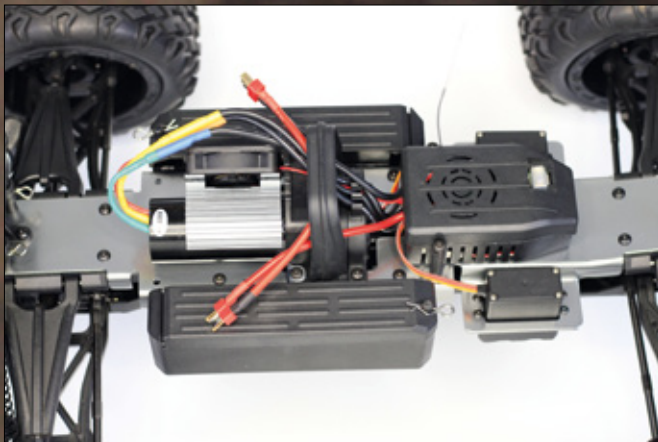
Eine optimale Gewichtsverteilung aller Komponenten sorgt für eine ausgewogene Fahrdynamik
