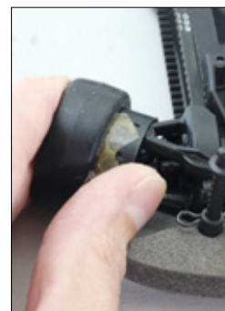
Etwas Packband oder dünnes Klebeband an zwei Stellen des Felgenträgers halten die Steckfelge besser. Die Felge ist aber auch etwas schwerer wieder herunter zu machen
