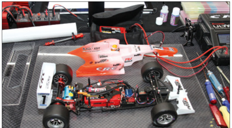
Der CRC Calandra WTF1 verfügt über ein besonders schmales Chassis. Der Akku lässt sich nur längs einbauen
