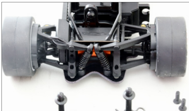
Die Schlitze am schwarzen Felgenhalter sind gut zu sehen. Je nachdem wie die Felge montiert wird, ist die Fahrzeugspur schmaler oder breiter. So passt man die Breite an die verschiedenen Karosserien an
