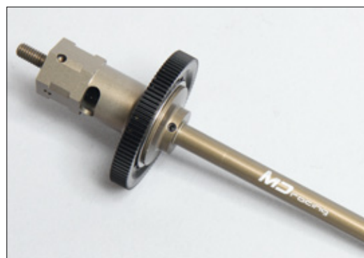
Die Antriebswelle aus Aluminium mit dem darauf montierten Kugeldifferenzial
