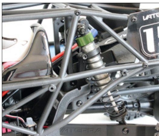
Die Federvorspannung an den Dämpfern kann stufenlos mit Klemmringen eingestellt werden
