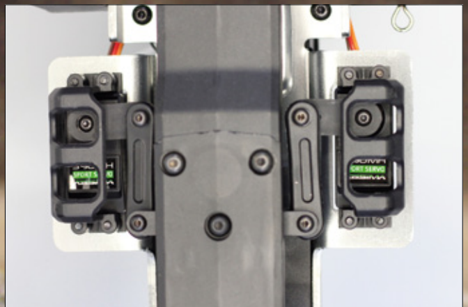
Die beiden hängend montierten Servos leisten jeweils 9-Kilogramm-Stellkraft
