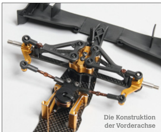
Die schmale Chassisplatte aus Kohlefaser
