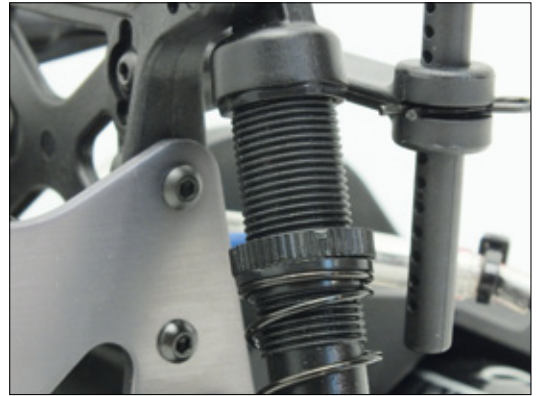
Die Federvorspannung kann stufenlos über Rändelschrauben an die eigenen Vorlieben angepasst werden
