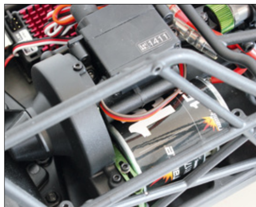
Für Vortrieb sorgt ein 15-Turns-Bürstenmotor von Dynamite
