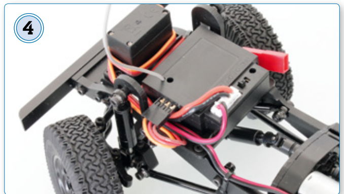
Dieser elektronische Baustein übernimmt sowohl die Regelung des Motors, als auch den Empfang der Steuersignale
