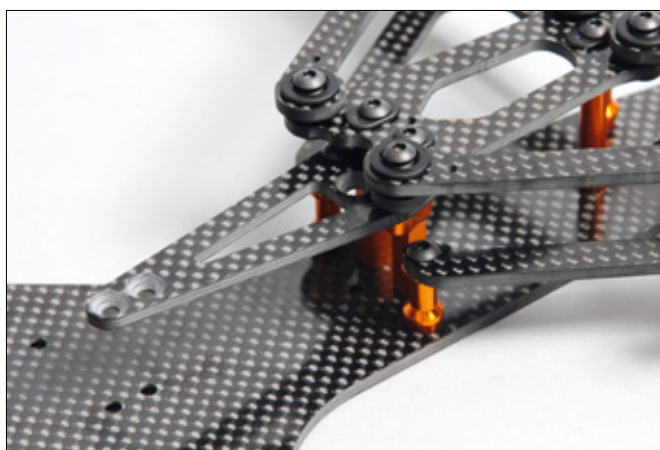
Der neue Servohalter wird direkt an die Vorderachse montiert
