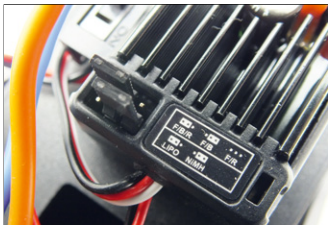
Das Setup des LiPo-fähigen Reglers erfolgt einfach über Versetzen der Jumper
