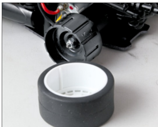
Die Schlitze am schwarzen Felgenhalter sind gut zu sehen. Je nachdem wie die Felge montiert wird, ist die Fahrzeugspur schmaler oder breiter. So passt man die Breite an die verschiedenen Karosserien an
