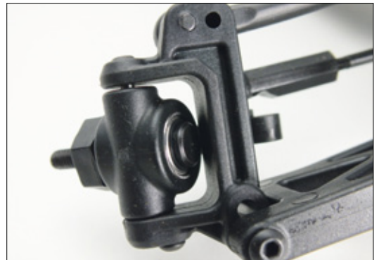
Ein typisches C-Hub-System und großzügige Radlager geben der Vorderachse viel Sicherheit. Verschiedene Befestigungsbohrungen lassen einfache Setup-Einstellungen zu
