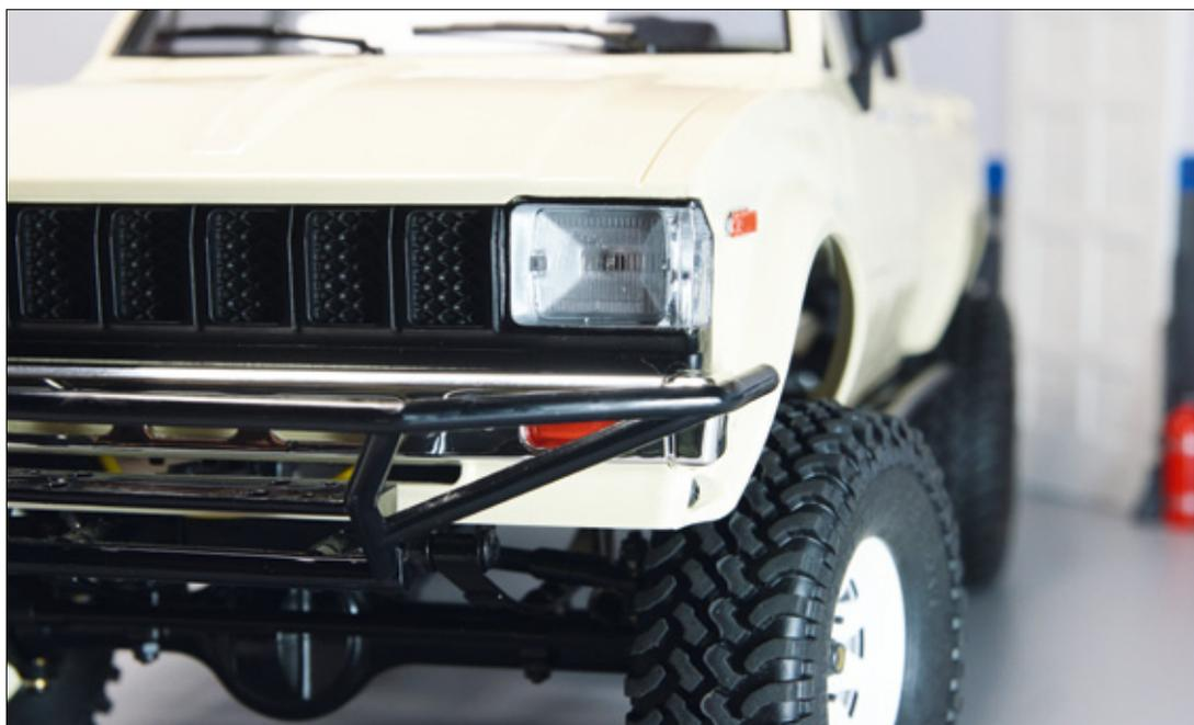
Besser geht es kaum. Streuscheiben mit angedeutetem Prisma machen die Front extrem realistisch. Blinker, Positionslampen und Standlicht fehlen ebenfalls nicht. Alle Lampen sind für den Einsatz von LED vorgesehen
