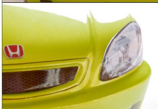
Dem stark vormontierten ABC Hobby-Frontantriebs-Chassis liegen nicht nur Aufkleber für die Scheinwerfer bei, sondern auch alle Bauteile, um diese mit echten Reflektoren und einer LED-Beleuchtung ausrüsten zu können, wie man gut erkennen kann
