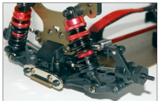
Öldruckstoßdämpfer aus Aluminium bügeln Unebenheiten auf der Piste aus
