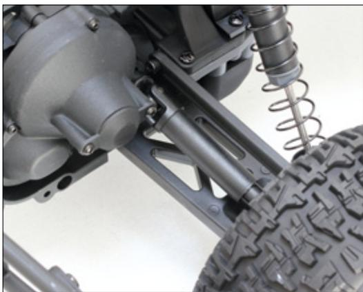
Teleskopantriebswellen sorgen für den Kraftschluss vom Getriebe zu den Radachsen
