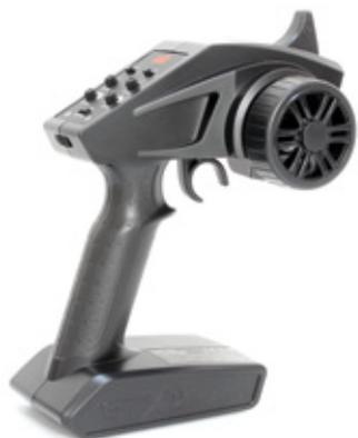
STX2 heißt der 2,4-Gigahertz-Sender, der dem Set beiliegt. Er ist einfach ausgeführt, bietet aber alle relevanten Einstelloptionen
