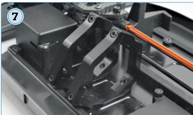
Ein weiteres Highlight ist der sehr robuste Motorhalter, der alle gängigen Brushless-Antriebe durch Klemmen fixiert. Das Ritzelspiel wird, wie beim Verbrenner, durch Verschieben des Halters eingestellt
