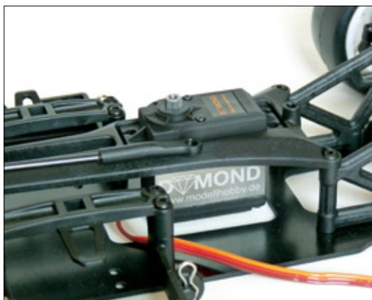
Rechts und links des Servos ist genügend Platz auf der Chassisplatte vorhanden, um Empfänger und Regler unterzubringen
