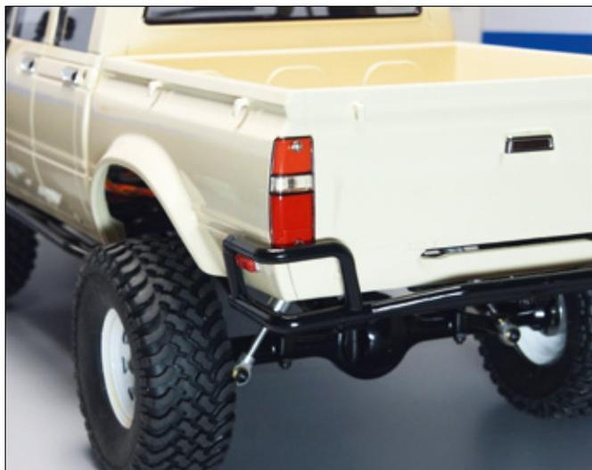
Der hintere Rammschutz, obgleich nur aus Kunststoff, schützt die Heckpartie samt Rückleuchten. Selbst an die Verzurrhaken an der äußeren Bordwand der Ladefläche hat RC4WD gedacht
