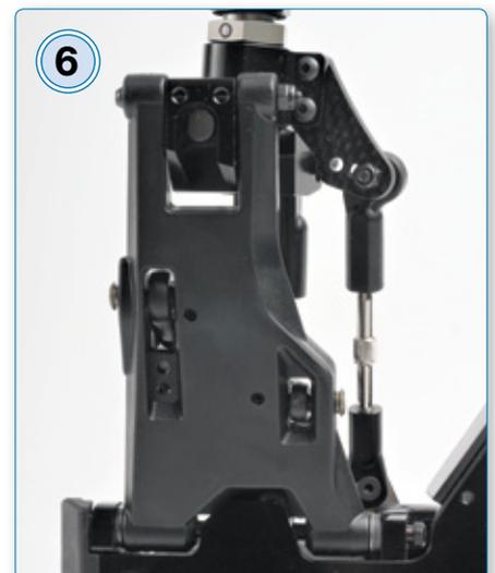
HB Racing war ein Vorreiter in Bezug auf geschlossene Querlenker in Sandwichbauweise. Das Prinzip wurde mittlerweile von einigen Konkurrenten kopiert
