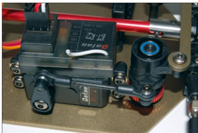
Mini-Lenkservo und Empfänger sitzen übereinander auf dem Chassis. Kugellager mit blauen Dichtringen kommen nicht nur auf den Lenkpfosten, sondern am gesamten Modell zum Einsatz
