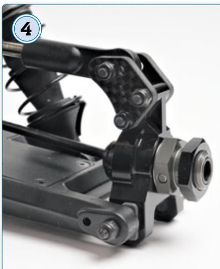
Die Geometrie der hinteren Radträger aus Aluminium wurde überarbeitet. Sie lässt sich vielfach variieren
