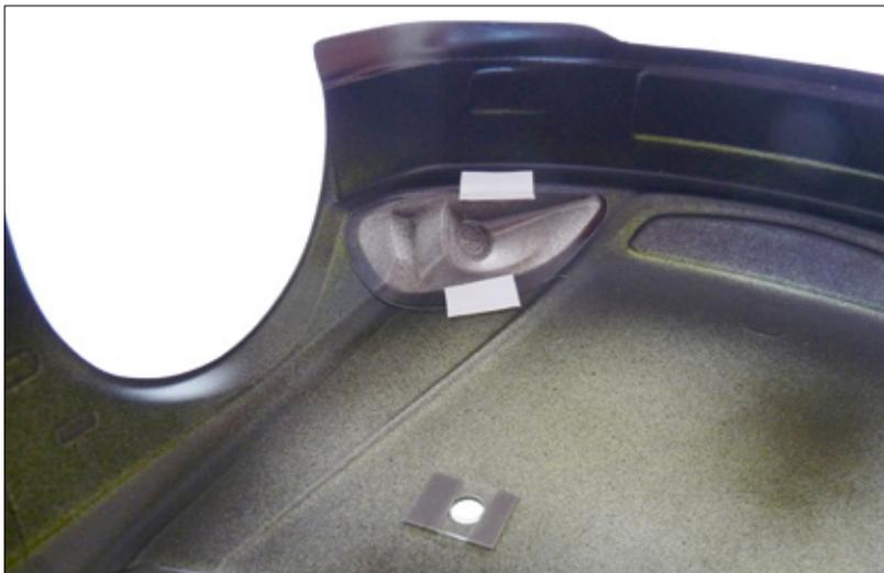
Die Befestigung der Reflektoren ist am einfachsten mit weichem Doppelklebeband mit Schaumstoffmittelteil erledigt. Sinnvollerweise wird die eigentliche Lackierung innen komplett mit Schwarz hinterlegt, um ein Durchscheinen der LED zu vermeiden
