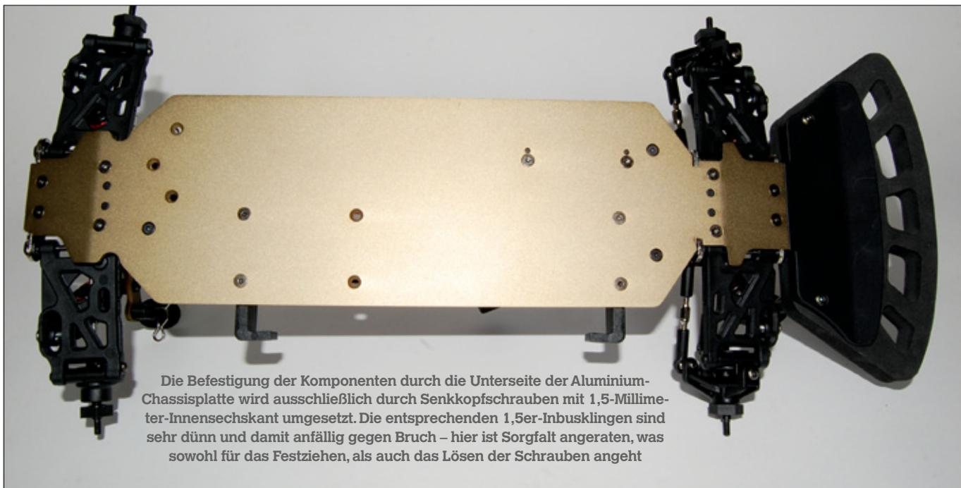
Die Befestigung der Komponenten durch die Unterseite der Aluminium-Chassisplatte wird ausschließlich durch Senkkopfschrauben mit 1,5-Millimeter-Innensechskant umgesetzt. Die entsprechenden 1,5er-Inbusklingen sind sehr dünn und damit anfällig gegen Bruch – hier ist Sorgfalt angeraten, was sowohl für das Festziehen, als auch das Lösen der Schrauben angeht
