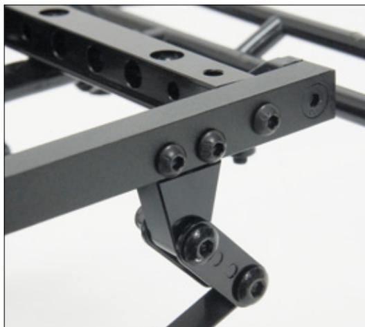
Die meisten Schraubverbindungen sind mit M3-Schrauben realisiert. Leider ist die Maßhaltigkeit der Gewinde nicht sonderlich gut. Ein Überdrehen der Schrauben ist an manchen Stellen schnell geschehen. Hier ist also Vorsicht geboten
