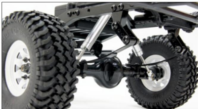
Die Blattfedern sind wie beim Original angebracht. Inklusive Einfeder- und Längenausgleich und schräg angestellten Aluminiumdämpfern
