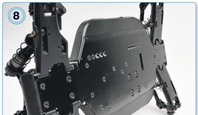
Das schwarz eloxierte Chassis aus Dur-Aluminium ist 3 Millimeter dick, die Schrauben sind tadellos versenkt. Die fünf aneinandergereihten Senk-Bohrungen ermöglichen eine Verschiebung des Fahrakkus in Längsrichtung
