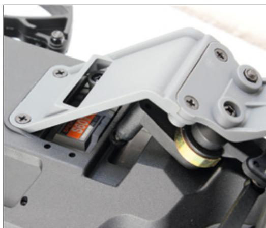
Das Servo ist über Kopf montiert und werkelt durch eine Öffnung im Chassis. Zum Schutz vor Bodenberührung wird es von einer Kunststoffkonstruktion geschützt
