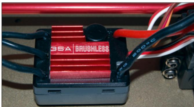
In Sachen Regler hat LC Racing ein passiv gekühltes Exemplar mit einer maximalen Dauerbelastung von 35 Ampere verbaut. Für ein leichtes Modell wie den EMB-TC reicht das aus
