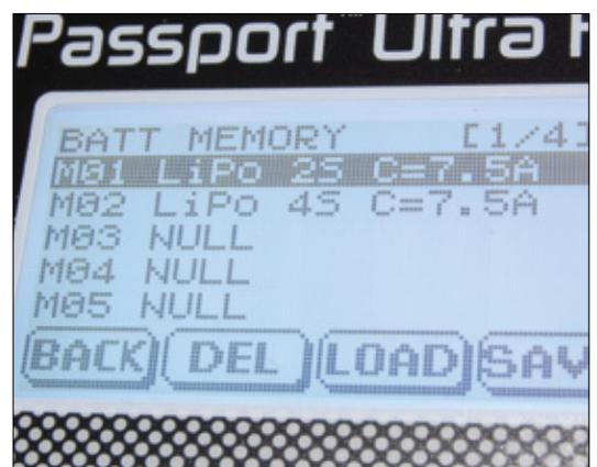
Insgesamt 20 Speicherplätze pro Ladeausgang stehen bereit, um unterschiedliche Akkutypen abzulegen und bei Bedarf wieder aufzurufen. Dieses Feature ist sehr hilfreich, da die Parameter der unterschiedlichen Akkus nicht jedes Mal erneut eingegeben werden müssen
