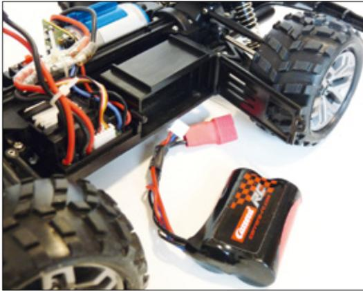
Der beiliegende Lithium-Akku versorgt den F-150 über den großen roten T-Stecker mit Strom, wohingegen der kleine weiße Balancerstecker zum Aufladen genutzt wird
