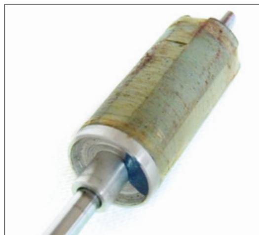
Der aus vier separaten Magneten montierte Rotor wird zur Sicherheit vor abbrechenden Magneteilen mit Kevlarfasern umwickelt. Gut kann man auch die blaue Ausgleichsmasse vom Wuchten erkennen
