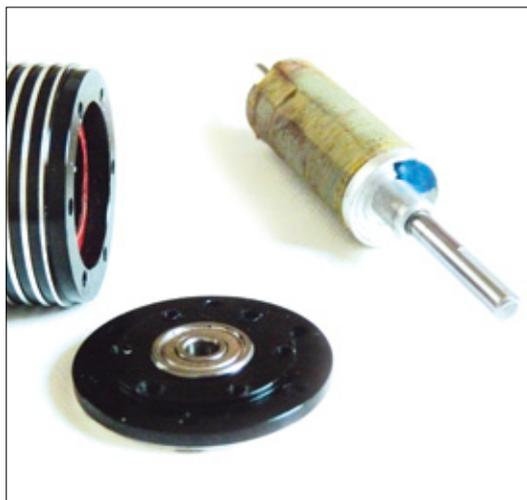
Neben einem bulligen Kugellager ist vor allem die sehr dicke Frontplatte aus Vollmaterial ein Garant für die gute Befestigung des nicht ganz leichten Motors im Modell. Angesichts einer Leistung von knapp über 2.000 Watt ist dies auch notwendig
