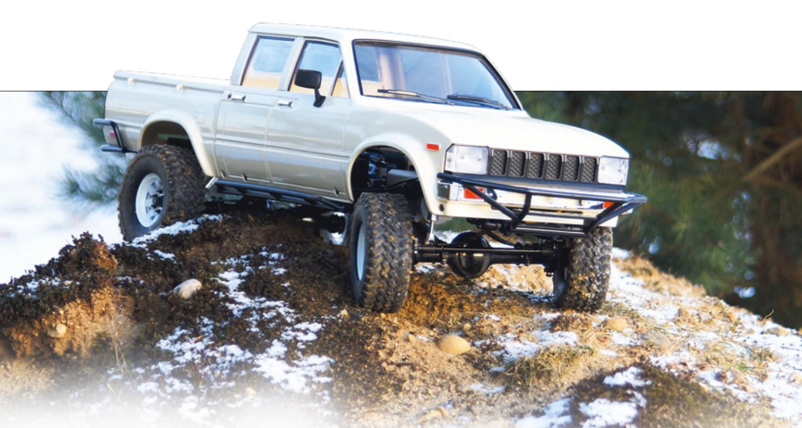
Maßstab 1:1 haben auch keine übermäßige Verschränkung. Zudem muss man wissen, dass sich das RC4WD-Fahrwerk erst einmal ein paar Stunden einfahren muss, bevor es richtig gut funktioniert.
