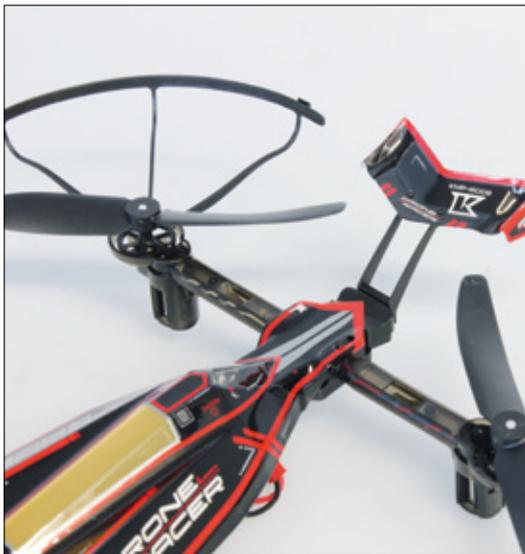
Die Propeller sind ab Werk von Kunststoffrahmen, sogenannten Prop-Guards geschützt. Der Spoiler am Heck des Racers hat nur eine optische Funktion
