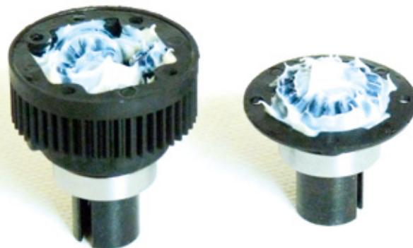
Ab Werk ist das sauber laufende Differential mit festem Maschinenfett gefüllt, alternativ lässt sich aber auch unterschiedlich viskoses Öl für das Setup nutzen
