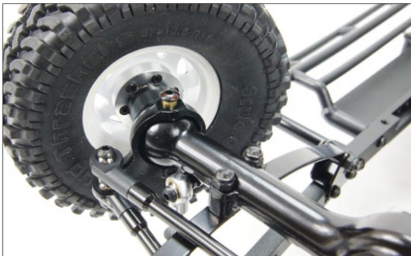
Die Kingpin-Schrauben waren an den Achsen ab Werk nicht richtig festgeschraubt. Man tut Gutes daran, diese mit Schraubensicherungsmittel wieder einzusetzen. Generell sollten alle Schraubverbindungen überprüft und gegebenenfalls damit behandelt werden
