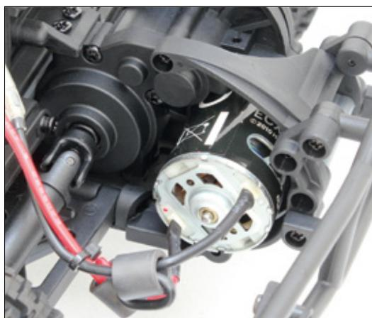
Für Vortrieb sorgt ein Bürstenmotor mit 20 Turns. Die Power reicht, um den Truck auf rund 30 Kilometer in der Stunde zu beschleunigen
