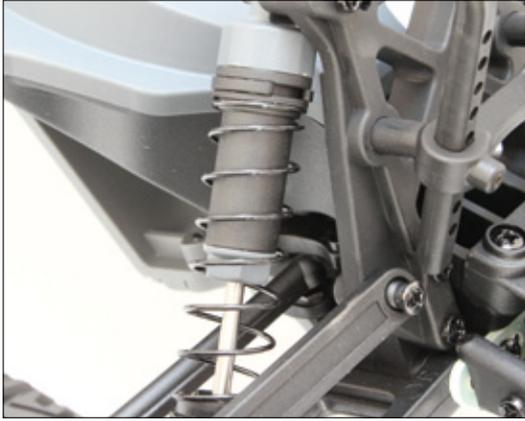
Die Vorspannung der Dämpferfedern wird über C-Klipse reguliert, Rändelschrauben gibt es nicht
