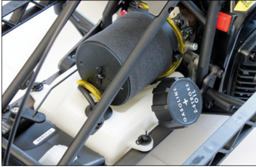
Der 700-Milliliter-Tank sitzt mittig im Chassis. In einer Mulde sitzt der Luftfilter
