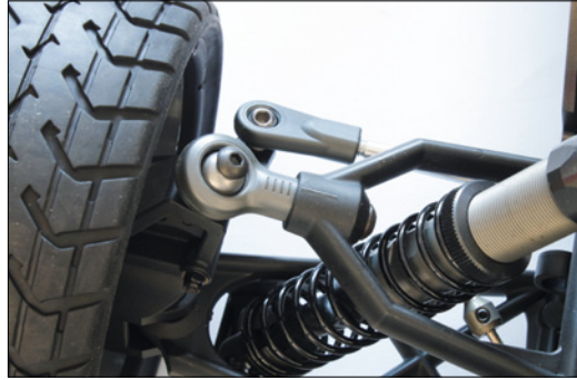
Spur und Sturz lassen sich wie beim Offroad-Baja verstellen
