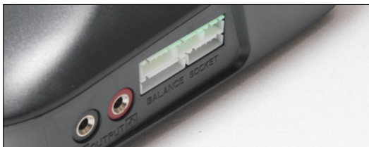
Auf der rechten Gehäusesseite befinden sich die Ladeports sowie der Balancer-Anschluss
