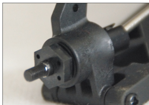
Die Felgenmitnehmer sind aus massivem Aluminium gefertigt
