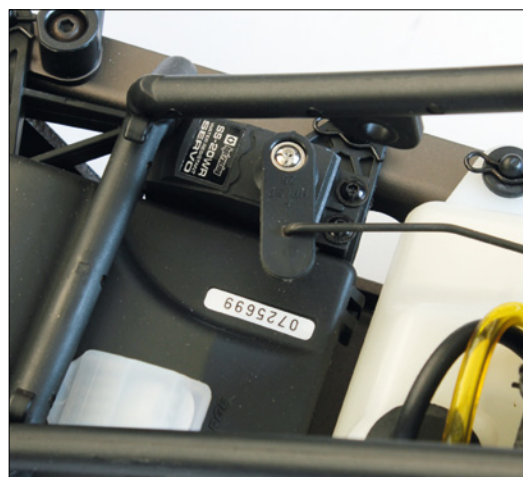
Das Gas-Brems-Servo ist nicht das stärkste, reicht aber für den Einsatz im Baja vollkommen aus
