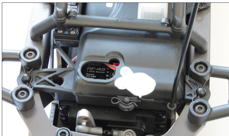
Die RC-Box beinhaltet neben dem fünfzelligem Empfänger-Akku auch den 2,4-Gigahertz-Empfänger
