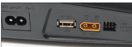
Links befinden sich neben den Anschlüssen für Gleich- und Wechselstrom ein USB- sowie ein Multiport inklusive Servo-Tester
