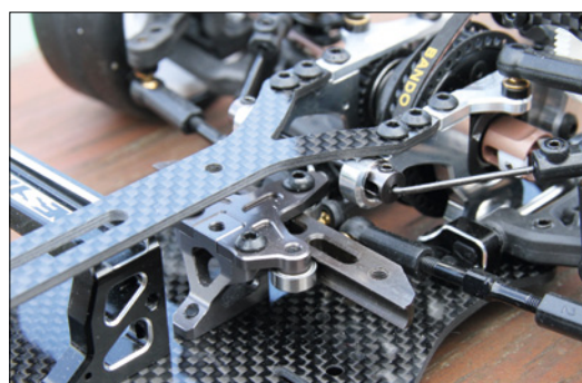
Die präzise, schienenartige Lenkung stammt aus dem Destiny-Tourenwagen
