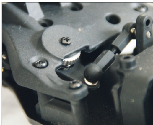
Die Zugänglichkeit zum Servosaver könnte etwas besser sein
