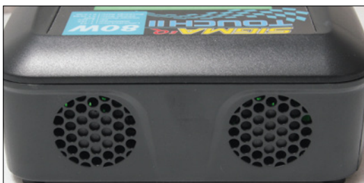
Zwei integrierte Lüfter, die leistungsgesteuert sind, sorgen für die Kühlung im Betrieb
