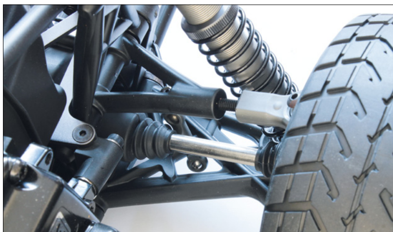
Die Gelenke der dicken Heavy-Duty-Antriebswellen sind mit Gummimanschetten vor Schmutz geschützt
