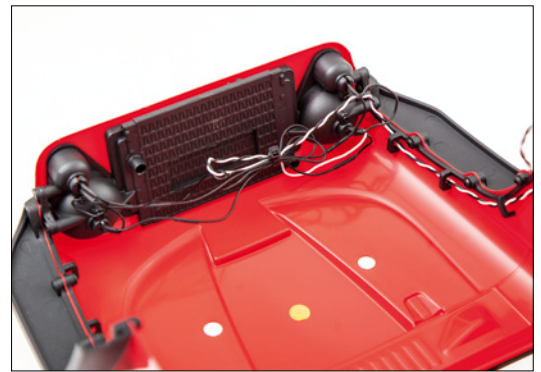
In der Karosserie sind serienmäßig LED verbaut. Hier ein Blick auf die Verkabelung der Frontscheinwerfer
