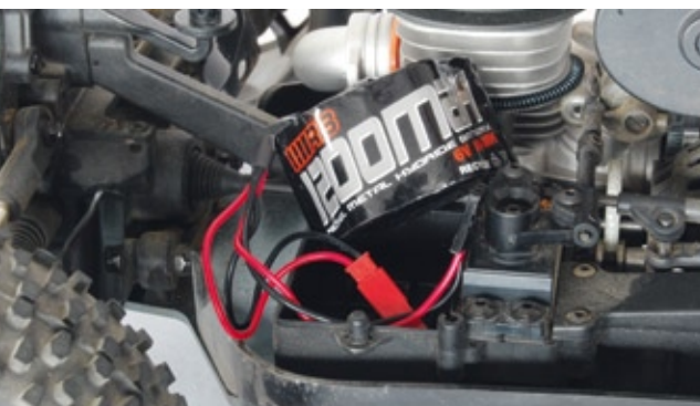
Ein 1.200-Milliamperestunden-Hump-Pack gehört zum Lieferumfang. Die Besonderheit: Der Akku verfügt neben dem Empfänger-Ausgang auch über einen Ladeanschluss
