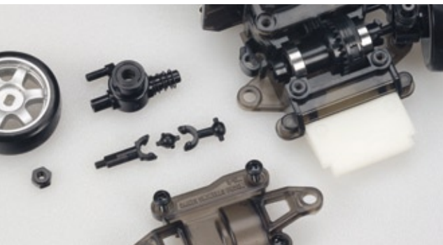
Kleine Kunststoffkardans sorgen für die Kraftübertragung zu den Rädern
