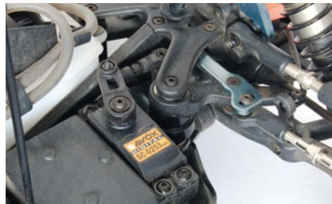
Hochwertige Savöx-Servos arbeiten im RB-One. Die Lenkung basiert auf einer bewährten Zweipfosten-Bausweise
