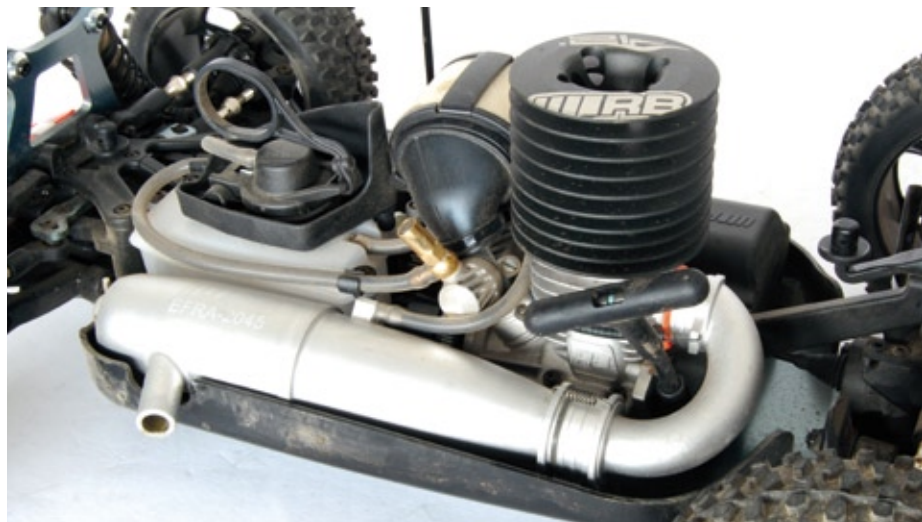
Als Antrieb dient ein RB-3+2-Kanal-Motor mit einer ABC-Laufgarnitur in Verbindung mit einem EFRA-Resorohr
