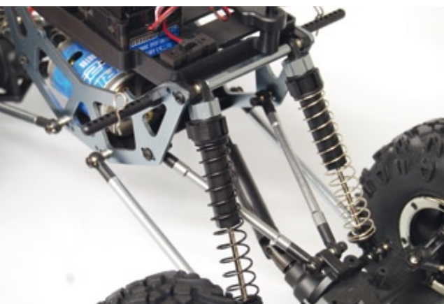
Torque Twist – ein Wort, das alle RC-Rock-Crawler-Fahrer fürchten. Dem Verdrehen des Krabblers wirkt in diesem Fall eine härtere Feder auf dem linken hinteren Dämpfer entgegen
