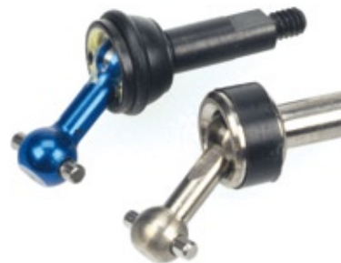
Kardanhalbwelle von Kyosho (oben) im Vergleich zur leichteren Titan-Variante von Atomic
