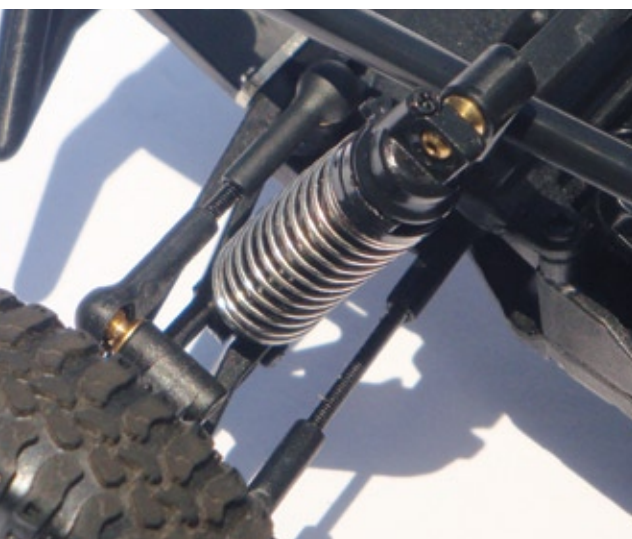
Gewindestangen ermöglichen eine stufenlose Einstellung von Sturz und Spur
