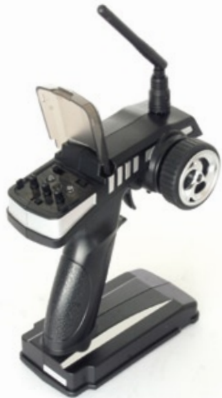
Die beiliegende 2,4-Gigahertz-Fernsteuerung verfügt über die wichtigsten Einstellfunktionen. Eine Servowegbegrenzung für den Gaskanal wäre dennoch wünschenswert gewesen
