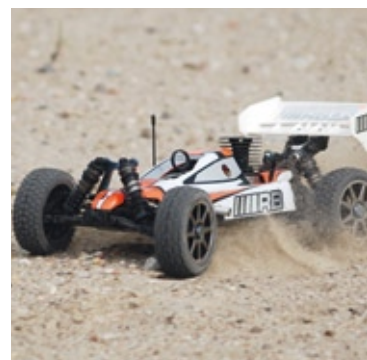
Als Antrieb dient ein RB-3+2-Kanal-Motor mit einer ABC-Laufgarnitur in Verbindung mit einem EFRA-Resorohr
