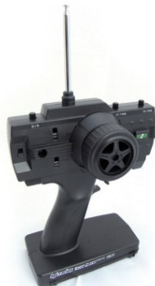
Der 27-Megahertz-Sender verfügt zwar über alle nötigen Funktionen, ist aber sehr einfach gehalten
