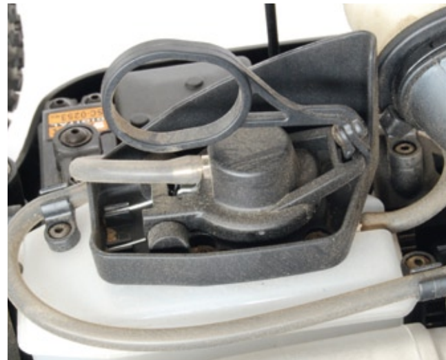
Der Tank ist mit einer Spritzschutzwand und einer Lasche zum Öffnen versehen
