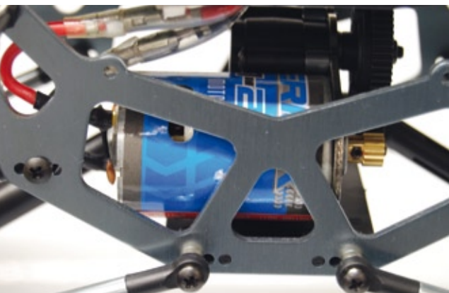
Das Herzstück des Crawlers bildet der MM-25-Bürstenmotor mit 14-Turns in 540er-Baugröße
