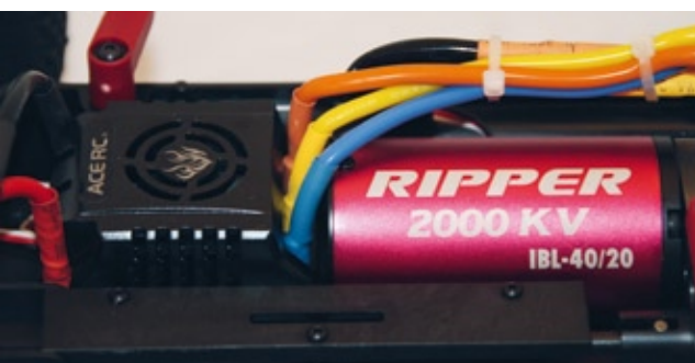
Der Ripper-Brushlessmotor hat genügend Power, um den EB-4 schnell auf die angegebenen 70 Stundenkilometer zu beschleunigen
