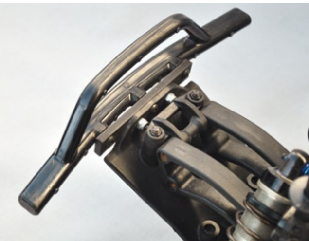
Hier ist der Kunststoffstreifen zur Montage des Bügels am Frontrammer zu sehen. Dieser Streifen wurde von dem RPM SC10 2WD-Bumper abgetrennt
