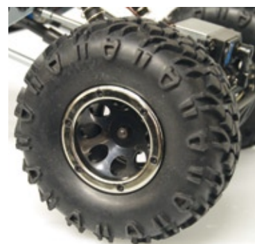
Die grobstolligen Reifen des Scout RC sind auf Beadlock-Felgen platziert. Auf diese Weise ist eine Aufbleien der Räder sehr einfach
