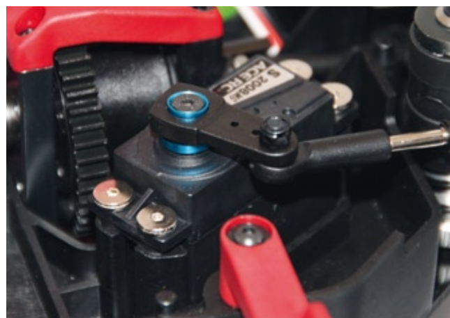
Der Lenkservo ist im 45-Grad-Winkel zur Vorderachse verbaut. Stellgeschwindigkeit und Stellkraft sind – wie bei den meisten RTR-Modellen – völlig ausreichend
