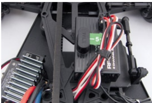
Der 27-Megahertz-Empfänger sitzt auf dem oberen Chassis direkt über dem liegend montierten Servo
