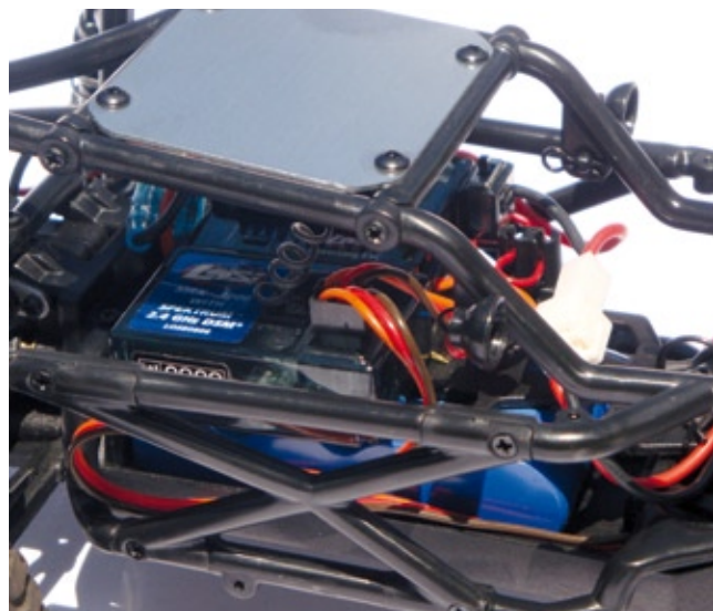
Regler und Empfänger sitzen oberhalb des Fahrakkus auf einem Stück Kunststoff
