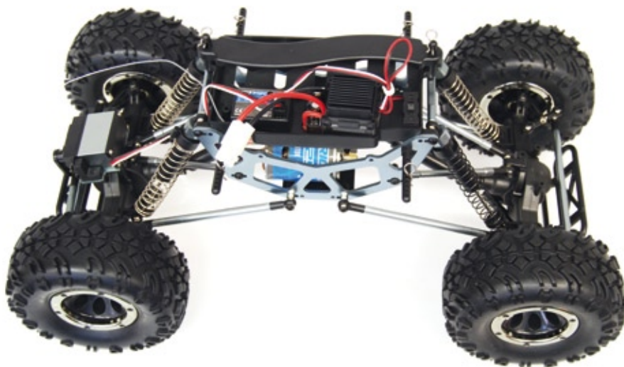
Das Grundgerüst des Scout RC bilden die vertikalen Chassisplatten und das Oberdeck, auf dem der Regler, der 2,4-Gigahertz-Empfänger sowie der Fahrakku Platz finden
