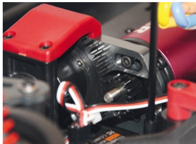
Beim EB-4 kommen, wie bei den meisten Brushlessbuggys, ein Metallmotorritzel und ein Kunststoffhauptzahnrad zum Einsatz
