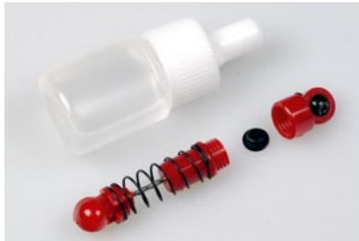
Das Befüllen der Stoßdämpfer mit dem mitgelieferten Silikonöl führt zu einer straffen Abstimmung
