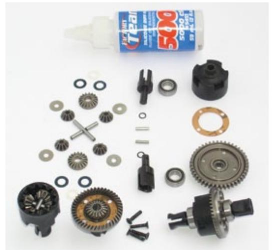
**Aus hochwertigen Einzelteilen entstehen die Vierspider-Diffs. Die ungewöhnliche Rundumfüllung mit 5.000er-Viskosität sorgt für ein durchaus gutes Allround-Fahrzeughandling**
