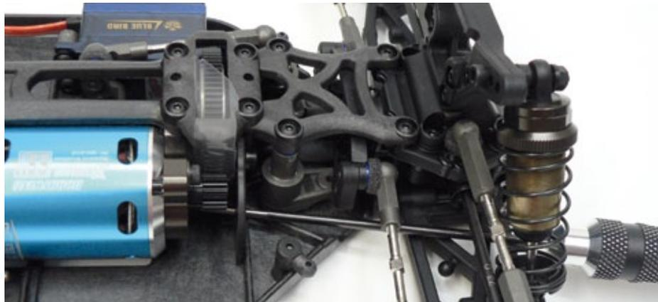
Hier kann man gut ein Detail der neuen Motorplatzierung erkennen, denn zum Verstellen des Getriebespiels sollte man über einen sehr langen Inbus-Schraubendreher mit Kugelkopf verfügen
