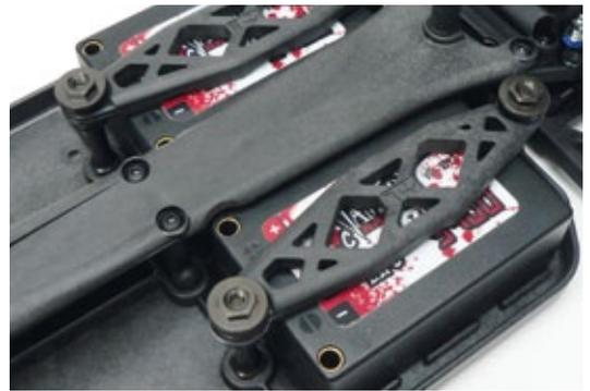
Die Anschlüsse einiger Saddle-Pack-Akkus bedingen ein leichtes Nacharbeiten des Topdecks. Darüber hinaus lassen sich die Akkus allerdings sehr gut mit den Rändelmuttern befestigen
