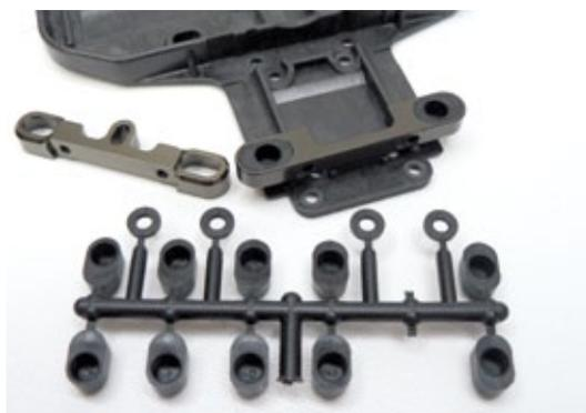
Die hinteren Querlenker werden getriebeseitig in weichen Kunststoffpfannen gelagert und ermöglichen so eine Einstellung der Vorspur der Hinterräder. Ein Wechsel geht auch hier schnell von der Hand, denn es sind nur drei Schrauben zu lösen
