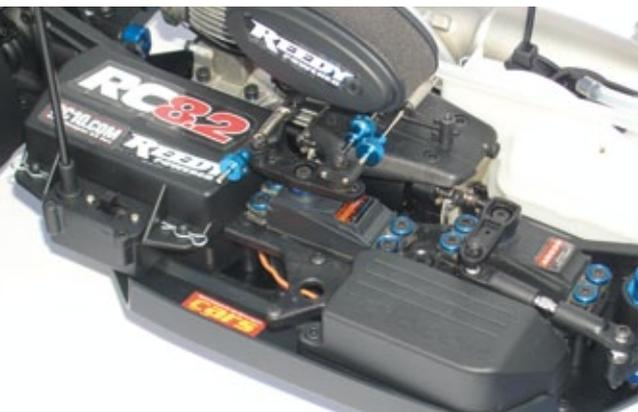
**Auf der RC-Seite übernehmen zwei aufrecht auf der leichten Kunststoffradioplatte montierte Rudermaschinen die Ansteuerung von Gas und Lenkung. Die beiden RC-Boxen bieten diverse Möglichkeiten der Unterbringung von Empfänger und Akku und damit auch die Beeinflussung des Fahrzeughandlings**
