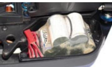
Wird mehr Gewicht auf der Vorderachse gewünscht, einfach den Empfängerakku in der vorderen RC-Box verstauen
