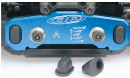
Die Querlenkerstifte sitzen in robusten Aluminiumbrücken. Aufgedruckte Rollcenterangaben erleichtern die Auswahl der gewünschten Stift-Einsätze
