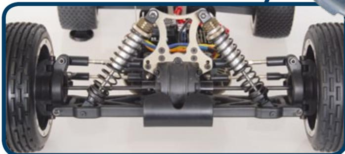
Die Achsen des Pitbull – hier die vordere – basieren auf Doppelquerlenkern. Die unteren sind in Schwingenform, die oberen als Gewindestangen ausgeführt
