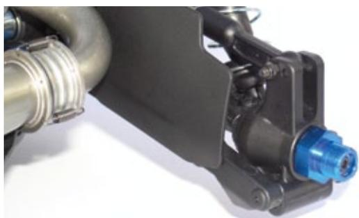
Dem Baukasten liegen Mud-Guards bei, die man an die hinteren, unteren Querlenker schrauben kann. Sie schützen die Wellen wirkungsvoll vor Verschmutzung
