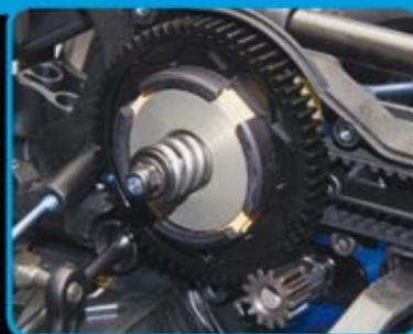
VTS4 Slipper, verstärkte Rutschkupplung
