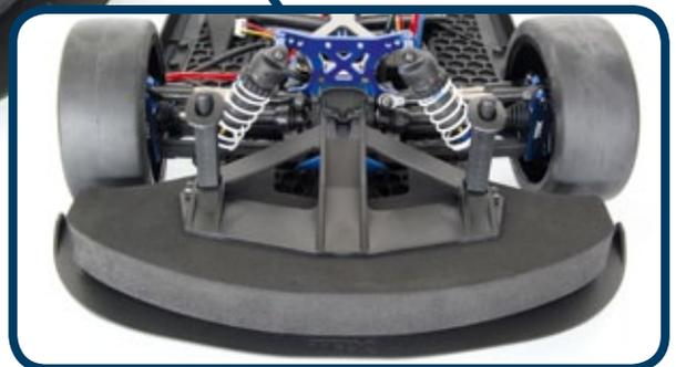
Der XO-1 ist ein wahrer Tiefflieger. Serienmäßig ist ein Frontsplitter unter dem Kunststofframmer der Vorderachse verbaut. Ein zweiter Splitter für Hochgeschwindigkeitsfahrten liegt bei
