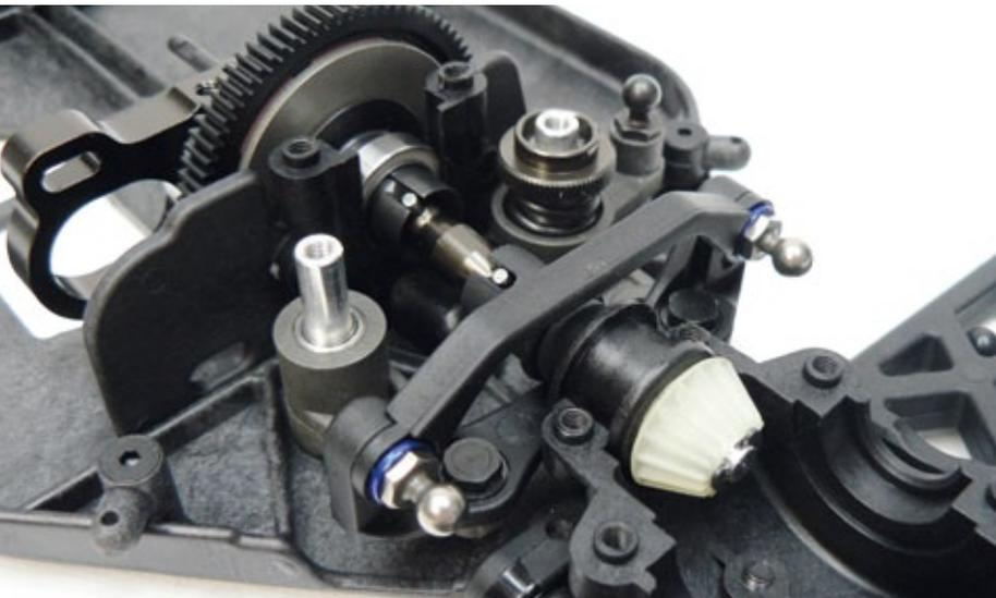
Ein sehr kompakter Aufbau findet sich an der Vorderachse. Etliche Getriebeteile des Vorgängers stehen für hervorragende Qualität und Leichtgängigkeit des Antriebsstrangs
