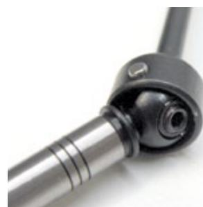
Wie zu erwarten, sind die CVD-Wellen sehr präzise gefertigt und schützen mit der Original CVD-Bauweise zugleich das Gelenk vor Schmutz. Der Pin sollte zusätzlich noch mit einem Ring aus Schrumpfschlauch gesichert werden
