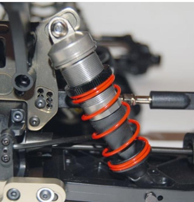
**Die Vorspannung der Stoßdämpferfedern wird hier per Rändelschraube justiert. Sie dient einzig und allein zum Einstellen der Bodenfreiheit**
