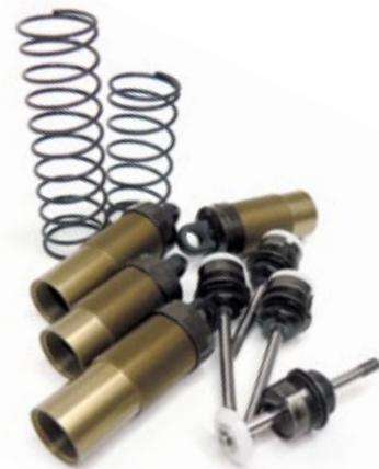
Die Dämpfer wurden dem Trend nach größerem Volumen durch eine Vergrößerung des Durchmessers angepasst. Die Passgenauigkeit ist extrem gut und das Verhalten der fertig befüllten Dämpfer ist auf absolut höchstem Niveau – leider aber wieder ohne Schutz der Kolbenstange
