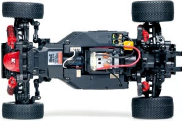
Die Draufsicht zeigt einen symmetrischen Aufbau des Chassis und die mittige Anordnung des Motors
