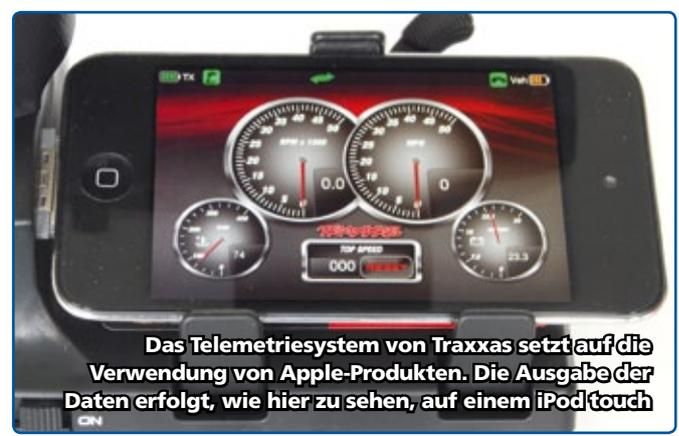
Das Telemetriesystem von Traxxas setzt auf die Verwendung von Apple-Produkten. Die Ausgabe der Daten erfolgt, wie hier zu sehen, auf einem iPod touch
