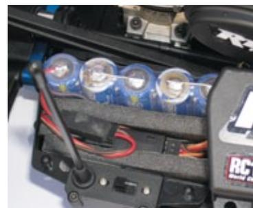
**Die großzügige RC-Box bietet ausreichend Platz für Empfänger und Stromversorgung. Schlecht: für den Ein-aus-Schalter liegt dem Set leider keine Schmutzabdeckung bei**
