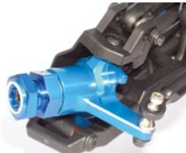
In den ungewöhnlich geformten C-Hubs sitzen gefräste Alulenkhebel mit angeformten Einschlagwinkelbegrenzer
