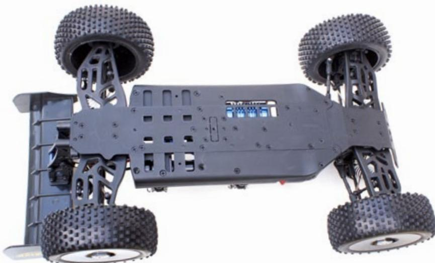
Das mehrteilige Chassis ist solide ausgeführt. Sämtliche Schrauben auf der Unterseite sind versenkt
