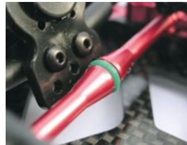
Für ein gewisses Maß an Restflexibilität sorgt der O-Ring zwischen den beiden Vorderachsvorstrebungszapfen
