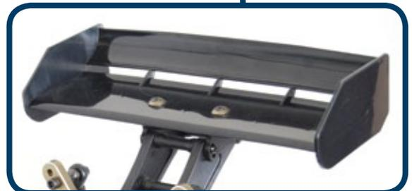
Ein großer Heckspoiler sorgt für ordentlichen Abtrieb auf der Hinterachse
