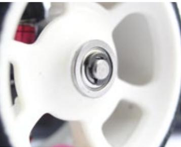
Die Fixierung der Vorderräder auf den Achsen erfolgt mit leichtgewichtigen aber extrem fummeligen C-Klips
