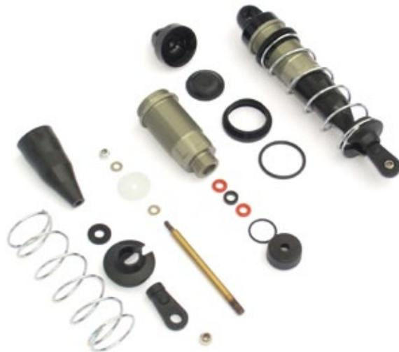
Beschichtete Kolbenstangen, großvolumige Bigbore-Alugehäuse, leichtgängige Dichtpakete und eine guter Schmutzschutz – die beigefügten Dämpfer sind technisch auf dem neuesten Stand
