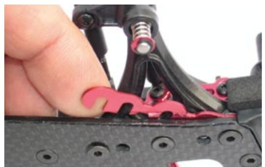
**Über stabile Alu-Unterlegkeile zwischen Vorderachsträgern und Chassis wird die Bodenfreiheit an der Vorderachse verringert**
