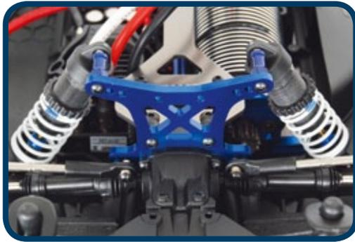
Die Dämpferbrücken – wie in diesem Fall die an der Hinterachse – sind aus eloxiertem Aluminium gefertigt. Sie bietet verschiedenen Aufhängungspunkte für die Öl Druckstoßdämpfer
