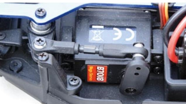
Das Lenkservo hat eine Stellkraft von 9 Kilogramm
