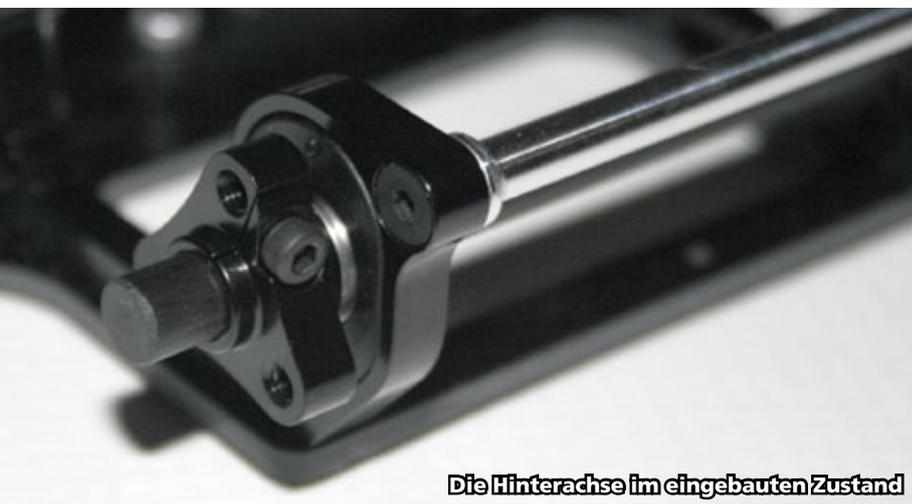
Die Hinterachse im eingebauten Zustand
