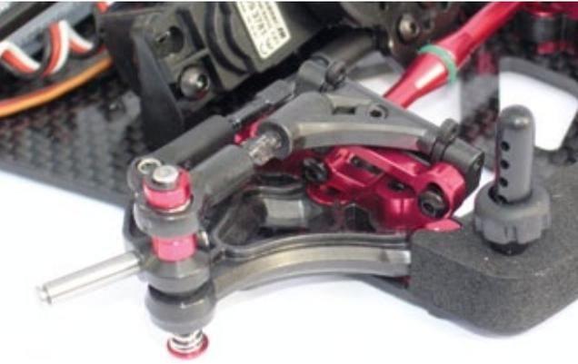
Die Vorderachse erlaubt das Einstellen von Radsturz, Nachlauf, Nachlaufveränderung beim Einfedern, Spurweite und Bodenfreiheit
