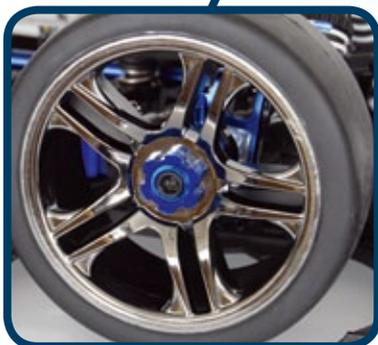
Die profillosen Reifen sind auf Fünfspeichenfelgen in Chromoptik verklebt. Befestigt werden sie über verzahnte und eloxierte 17-Millimeter-Sechskantmitnehmer
