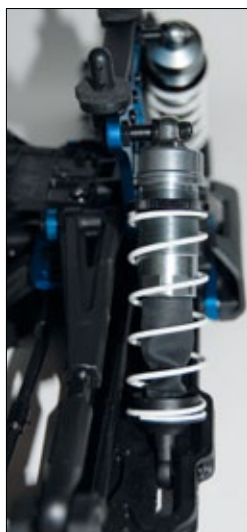
Öldruckstoßdämpfer gehören in dieser Klasse zum guten Ton. Aluminium als Werkstoff ist durchaus positiv hervorzuheben
