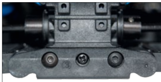
Über unterschiedliche Halter der Querlenkerstifte lassen sich Parameter wie die Vorspur der Hinterachse variieren
