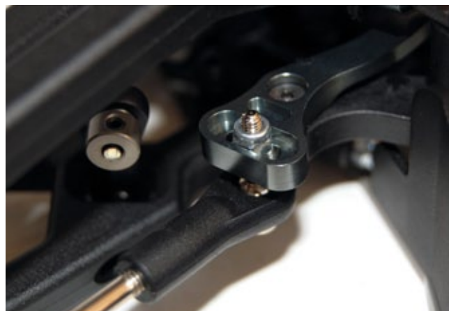
Bei vielen RC-Cars lässt sich der Ackermann-Effekt durch Versetzen der Spurstange an der Lenkmechanik beeinflussen
