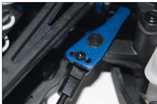
Drei unterschiedliche Ackermann-Winkel sind justierbar
