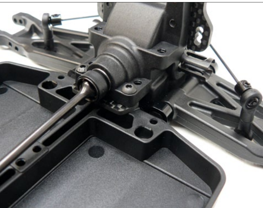
Die hintere Getriebebox stützt sich an der Chassiswanne ab und nutzt ein 2 Millimeter dickes Kohlefaserteil zur Erhöhung der Stabilität
