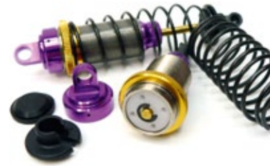
Die Dämpfer werden klassisch von oben befüllt, sie glänzen durch eine sehr hohe Fertigungsqualität und waren zu keinem Testzeitpunkt undicht
