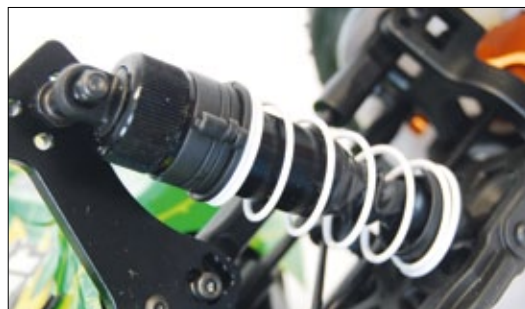
Die Kolbenstangen der Big-Bore-Stoßdämpfer sind mit Gummitüllen vor Schmutz geschützt. Die Federvorspannung lässt sich über C-Klipse einstellen
