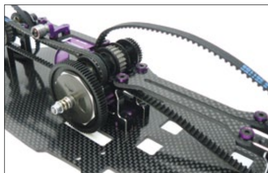
Der mittlere Riemen wird beim SX3 nicht mehr über den Akkupack geführt, sondern weicht lediglich dem Motor und dem Lenkservo aus
