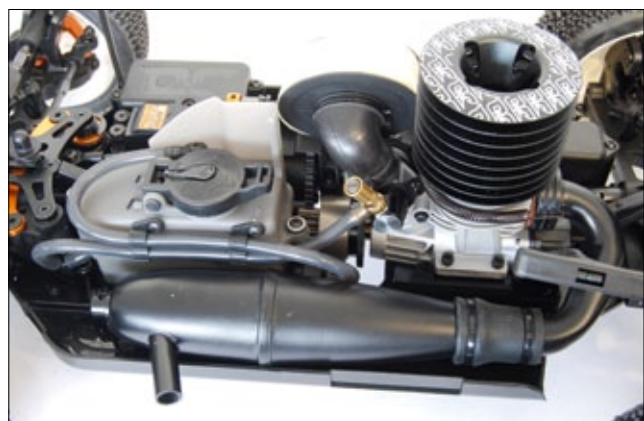
Motor, Resorrohr und Tank sind hervorragend aufeinander abgestimmt
