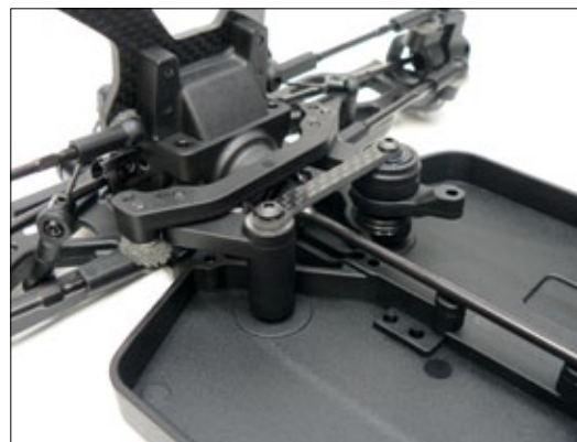
Die Chassiswanne verfügt über Aussparungen unterhalb der Antriebswellen zur Verlegung der Kabel. Ebenfalls bemerkenswert ist die sehr flache Bauweise der Lenkung, die nur geringfügig höher als ein Standard servo ist
