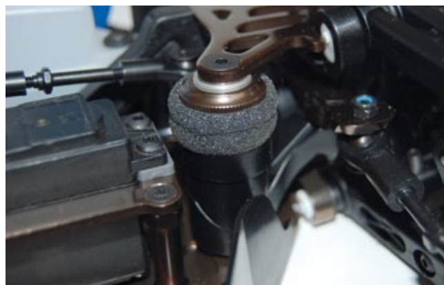
Vor allem bei Offroadern führt an einer Servosaver-Konstruktion kein Weg vorbei
