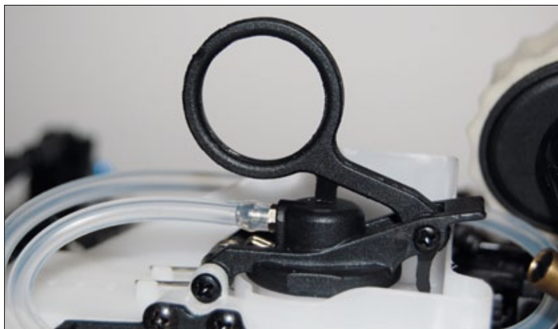
Anleihe aus der Wettbewerbsklasse: Mittels einer Öse lässt sich der Tank bequem, vor allem aber schnell öffnen
