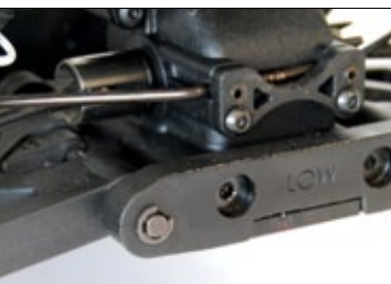
Eigentlich ein No-Go bei einem rundum gelungenen Modell: E-Klipse an den Schwingenstiften der unteren Querlenker
