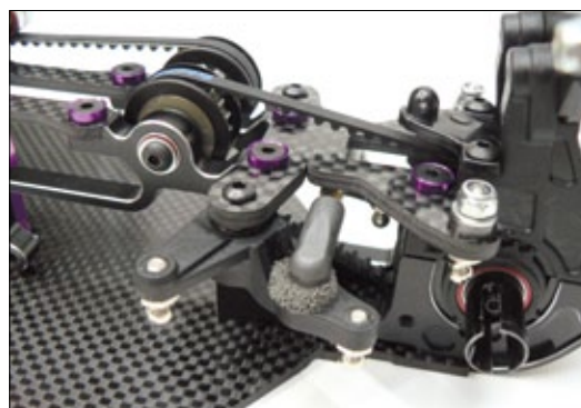
Die Lenkung wird kopfüber-hängend montiert und nimmt so wenig Platz ein. Allerdings muss auf einen Servosaver verzichtet werden, ebenso wie auf unterschiedliche Ackermann-Positionen der Lenkung
