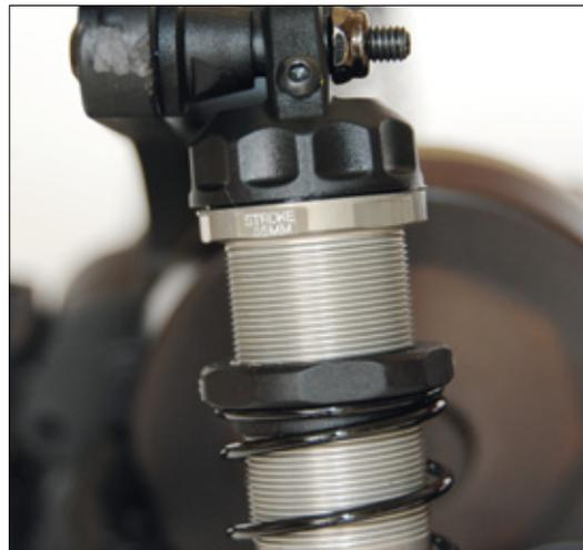
Per Rändelmutter wird die Vorspannung der Fahrwerksfedern justiert
