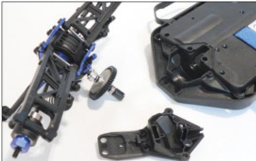
Nach einer schnellen Demontage der Verbindungsplatte gibt der AM10SC den Blick auf die solide Rutschkupplung samt 32DP-verzahntem Hauptzahnrad frei. Angesichts der Kräfte, denen der Antriebsstrang ausgesetzt ist, weisen alle Teile stabile Proportionen und Materialien auf
