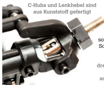
C-Hubs und Lenkhebel sind aus Kunststoff gefertigt
