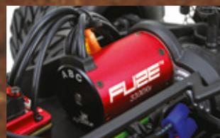
Dynamite Power System mit 4-poligem Sensorless Brushlessmotor
