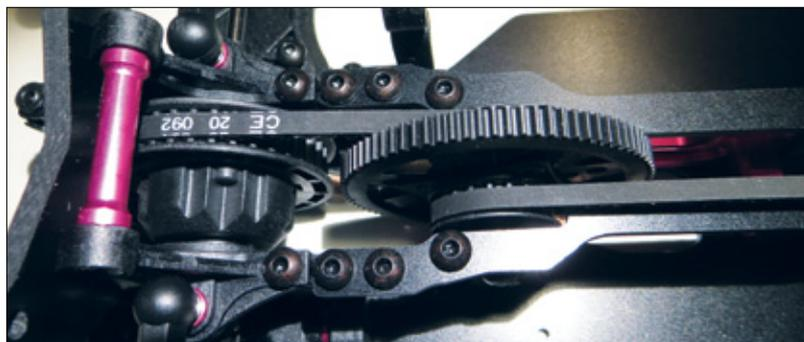
Die Diffböcke verfügen über Exzenterhalterungen. Die korrekte Einstellung und die Fixierung der Riemen- spannung ist damit ein Kinderspiel
