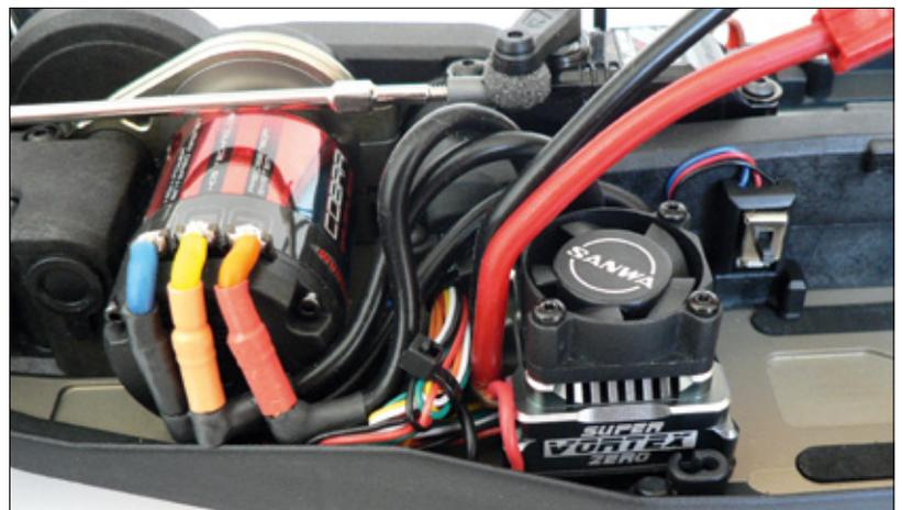
Kompakter geht es kaum, denn der Sanwa Super Vortex Zero passt hervorragend in die etwas beengten Verhältnisse eines Losi 22-4-Buggys. Die Leistungsfähigkeit des Reglers lässt allerdings auch den 2s-Einsatz im 4WD-Short Course-Truck mit 550er-Motor zu
