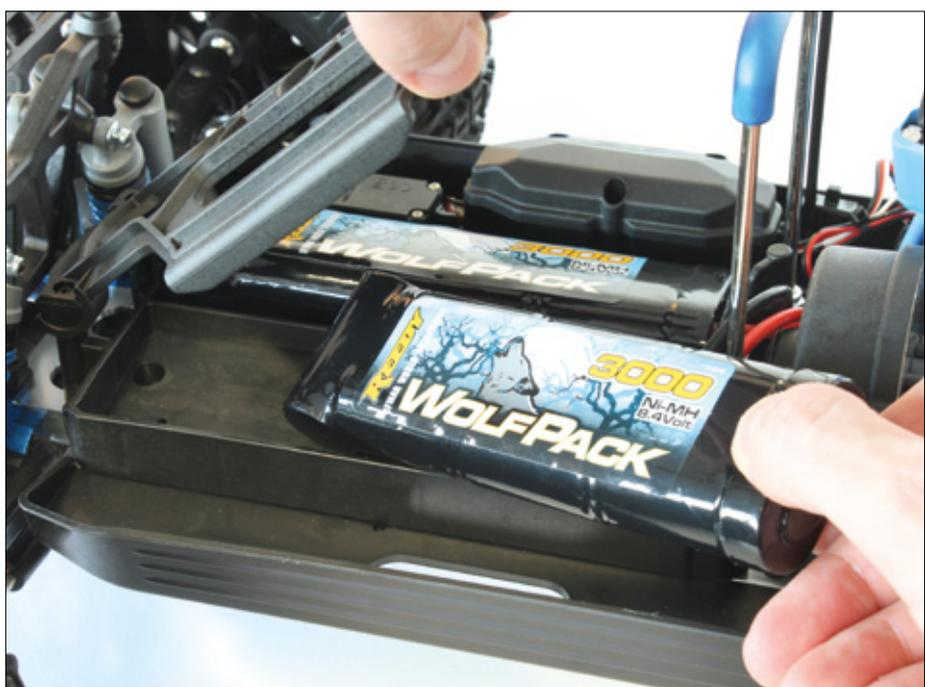
Die 3.000-Milliamperestunden-Nickel-Sticks gehören zum Lieferumfang. Lediglich ein Ladegerät muss man selbst beisteuern
