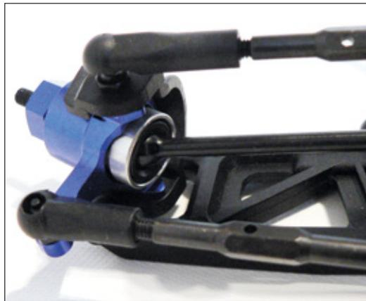
Aluhebel sowie geschützte C-Hubs vorne und jeweils eine demontierbare CVD-Welle samt extra großen Kugellagern und Rechts-links-Gewindestangen spiegeln die überdurchschnittlich gute Ausstattung der Aufhängung des AM10SC wieder
