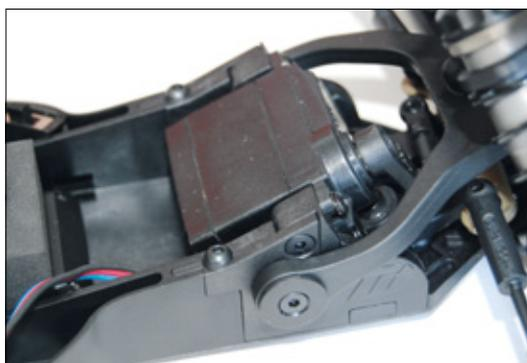
Das Lenkservo sitzt etwas angewinkelt im Modell. Dadurch lässt sich das Servohorn auch im montierten Zustand an- und abbauen
