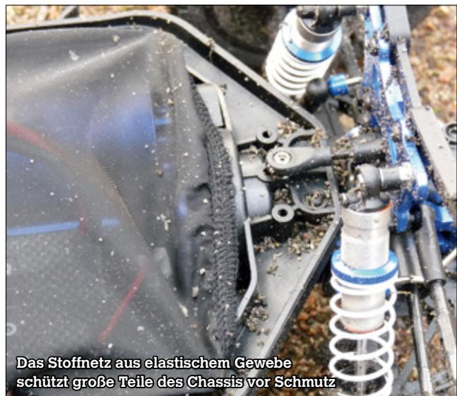
Das Stoffnetz aus elastischem Gewebe schützt große Teile des Chassis vor Schmutz
