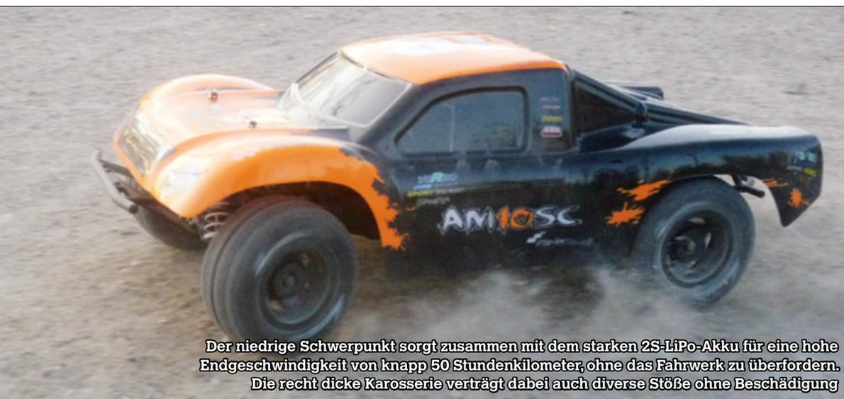
Der niedrige Schwerpunkt sorgt zusammen mit dem starken 2S-LiPo-Akku für eine hohe Endgeschwindigkeit von knapp 50 Stundenkilometer, ohne das Fahrwerk zu überfordern. Die recht dicke Karosserie verträgt dabei auch diverse Stöße ohne Beschädigung
