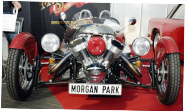
Morgan Aero heißt dieses äußerst agile Dreirad mit dem markanten Zweizylinder V-Triebwerk, dem eigentlich nur noch der Propeller fehlt, um gänzlich abzuheben
