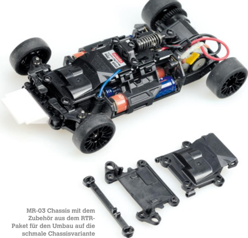
MR-03 Chassis mit dem Zubehör aus dem RTR-Paket für den Umbau auf die schmale Chassisvariante
