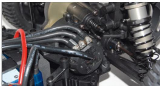
Je nach Streckencharakteristik lässt sich der Motor an insgesamt vier verschiedenen Positionen platzieren
