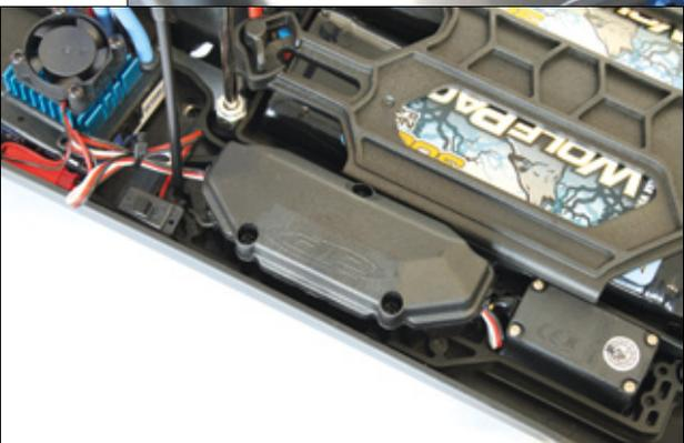
Die schwarze RC-Box hält Wasser und Dreck vom Empfänger fern. Links davon sitzt das 10-Kilogramm-Lenkservo
