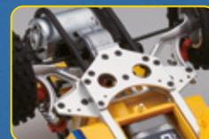
Versenkte Schrauben an der Unterseite des Chassis.
