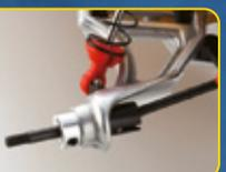
Querlenker vorn und hinten aus hochfestem, leichtem A6061T6 Aluminium. Die breite Spur an der Vorderachse sorgt für optimierte Stabilität.
