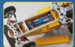
Die Radiobox ist kompatibel mit allen gängigen Akkutypen.
