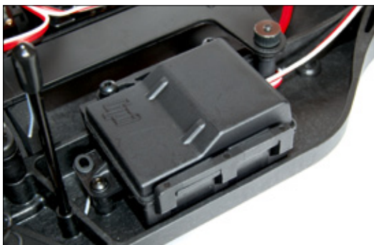
Teil von HPIs Waterproof-Konzept ist die sprintwassergeschützte RC-Box, in der der 2,4-Gigahertz-Empfänger sitzt
