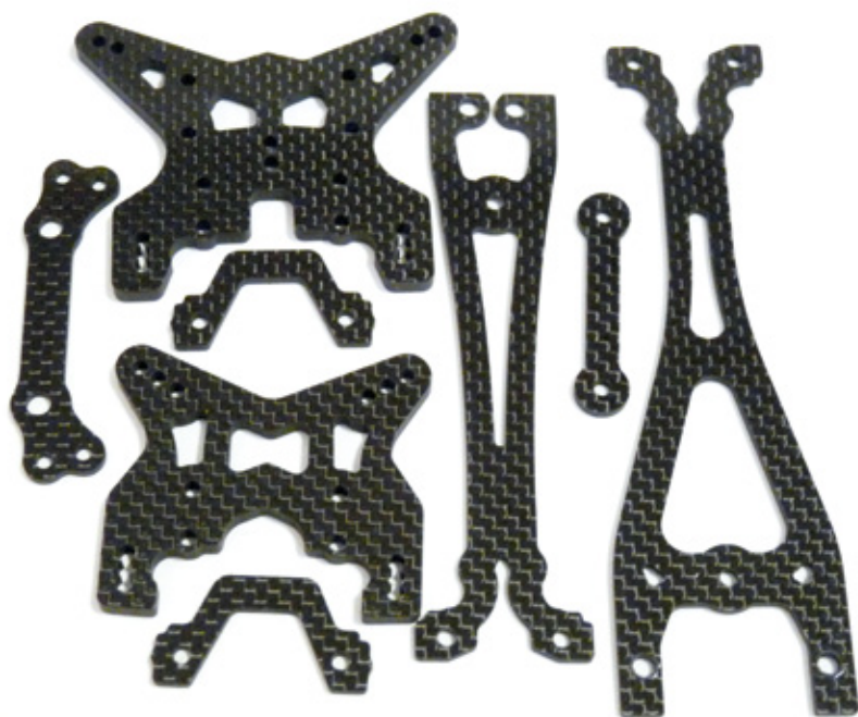
Die vielen Bohrungen in den Dämpferplatten ergeben zusammen mit den Querlenkerbefestigungspunkten vielfältige Setup-Optionen
