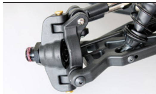
Die C-Hubs aus Kunststoff stammen von der bewährten Wettbewerbsversion
