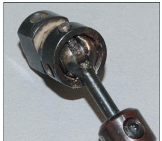
Diese stark verschlissene Kardanwelle zeigt ein Problem, das auftritt, wenn sich Schmierfett und Sand vermischen. Das Resultat ist eine regelrechte Schleifpaste
