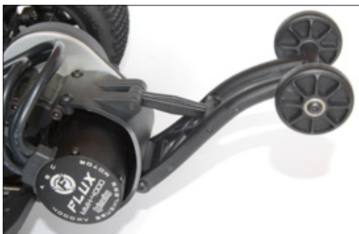
Wenn der 4.000-kV-Motor richtig losgelassen wird, bekommt die Wheeliebar im Heck des Trucks viel zu tun
