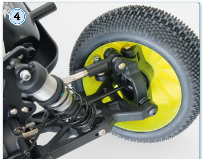
4 Solide C-Hub-Aufhängungen, die man von der 8ight-Baureihe kennt. Vorne kommen CVD-Wellen zum Einsatz
