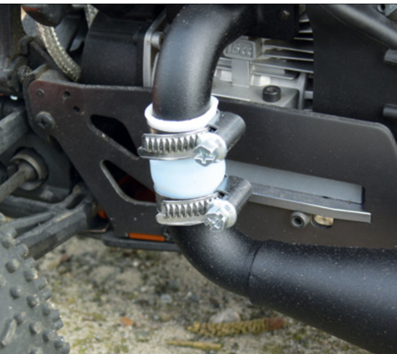
Den weißen Silikonschlauch bekommt man nur aufgezogen, wenn man den Kunststoff vorher in heißem Wasser erhitzt
