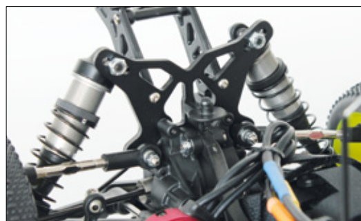
Die Dämpferbrücken zählen zu den wenigen Alu-Teilen am 8ight-E
