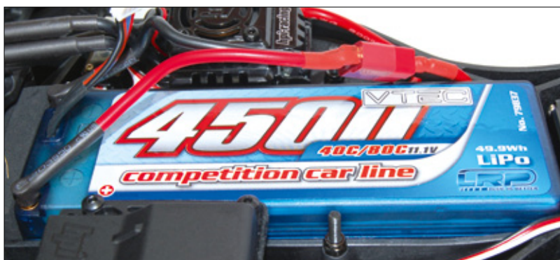
Mit einem hochwertigen 3s-LiPo vom Schlage des 4.500ers aus LRPs Competition Car Line entfesselt der Brushlessantrieb maximale Power
