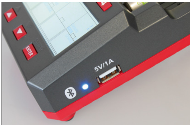
Über die Bluetooth-Schnittstelle bindet sich das X4 Advanced mit einem Smartphone. Praktisch ist der USB-Port
