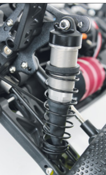
Die hochwertigen Öldruckstoßdämpfer mit Gummi-Tüllen zum Schutz der Kolbenstangen können über Rändelschrauben stufenlos verstellt werden
