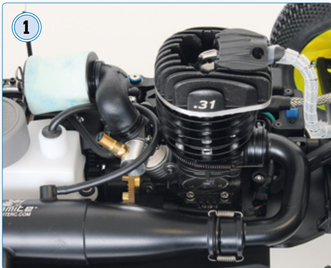
1 Auf den ersten Blick vermutet man hier nicht unbedingt einen Benzinmotor. Doch das Zündkabel und der große Kühlkopf enttarnen das 5-Kubikzentimeter-Aggregat
