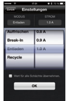
Das Programmieren des Lade-/Entladevorgangs ist dank Smartphone-App komfortabel und einfach
