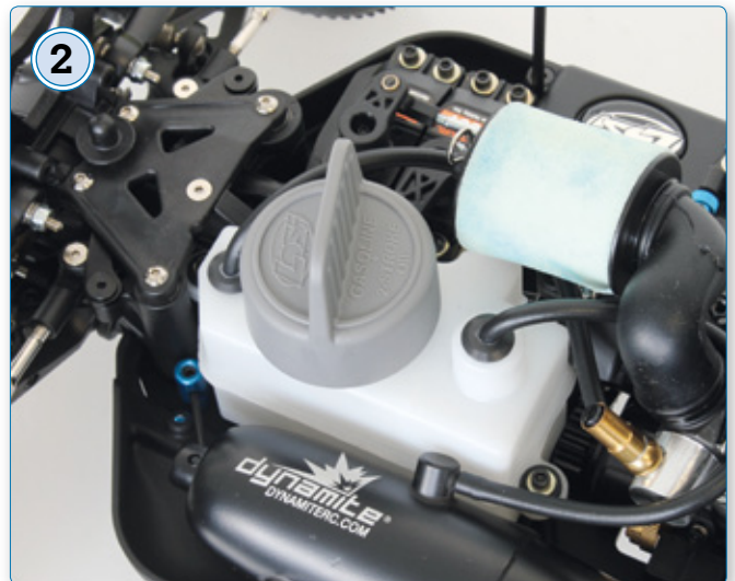
2 Der Tank wirkt etwas unterdimensioniert, dürfte aber in Anbetracht des geringen Spritverbrauchs eines Benziners für ordentliche Fahrzeiten sorgen
