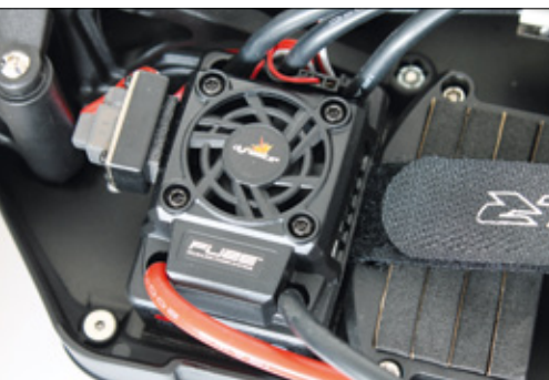
Der Fuze Dynamite-Regler kann mit bis zu 130 Ampere belastet werden
