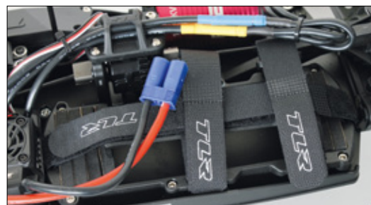
Im Modell ist reichlich Platz für zwei 2s-, einen 3s- oder einen 4s-LiPo
