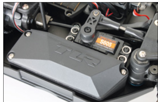
Das Lenkservo hat eine Stellkraft von 9 Kilogramm. In der großen RC-Box sitzt ein AVC-Empfänger
