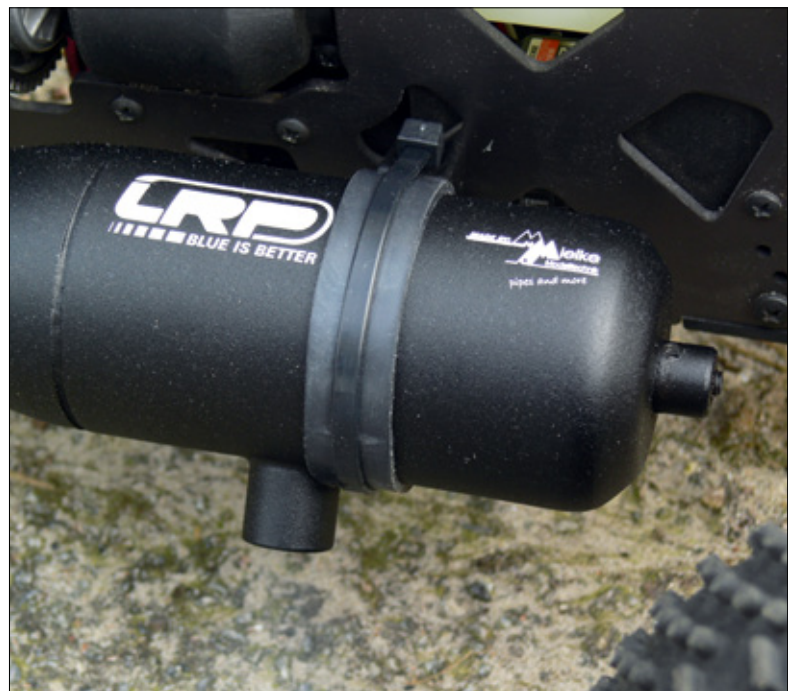
Im vorderen Bereich wird das Mielke Reso-Rohr einfach mit einem Kabelbinder festgezurret
