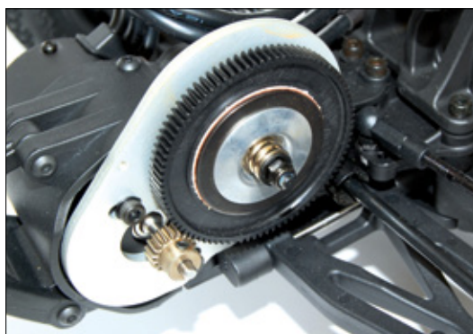
Auch wenn das Firestorm-Getriebe über Metallzahnräder verfügt, wurde ihm zur Sicherheit eine einstellbare Slipperkupplung vorgelagert
