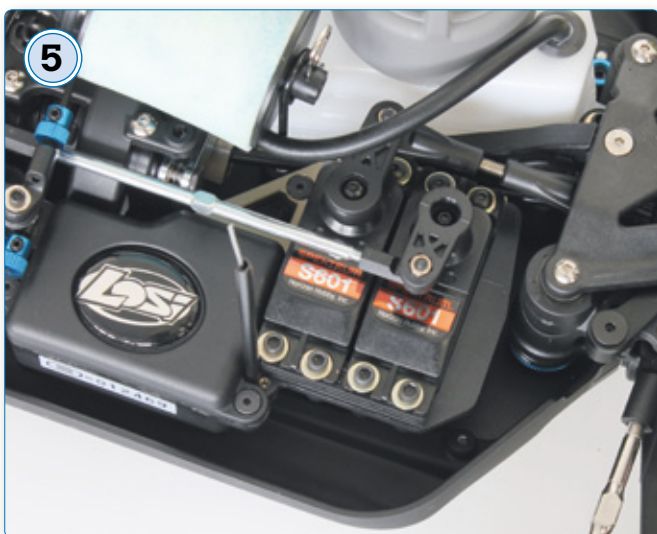
5 Die beiden Spektrum-Servos vom Typ S601 werden direkt aus einem 2s-LiPo gespeist und haben an 6 Volt Spannung bereits eine Stellkraft von knapp 8 Kilogramm
