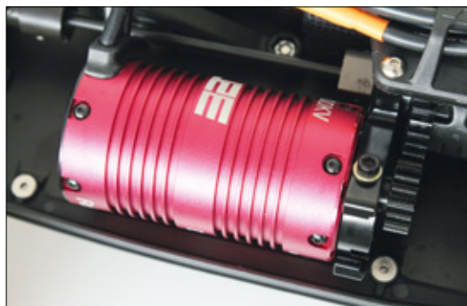
Der vierpolige Innenläufer hat eine spezifische Drehzahl von 1.800 Umdrehungen pro Minute und Volt
