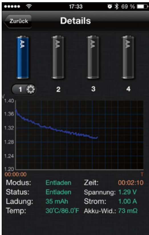
Entladekurven-Diagramm der Zelle 1 mit wertvollen Angaben beispielsweise zum Innenwiderstand
