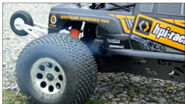
Der High Flow Muffler ist der leiseste im Vergleich. Leider bläst der die Abgase direkt auf das rechte Hinterrad
