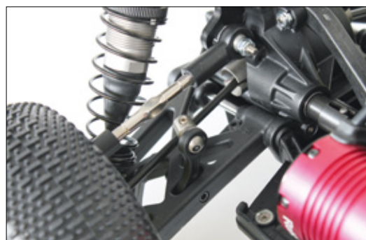
Rechts-links-Gewindestangen und Stabilisatoren zeigen schon, dass der 8ight-E einen Wettbewerbs-Bruder hat
