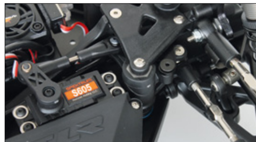
Ein in der Zwei-Pfosten-Lenkung integrierter Servo-Saver schützt das Metallgetriebe des Lenkservos vor Überlastung
