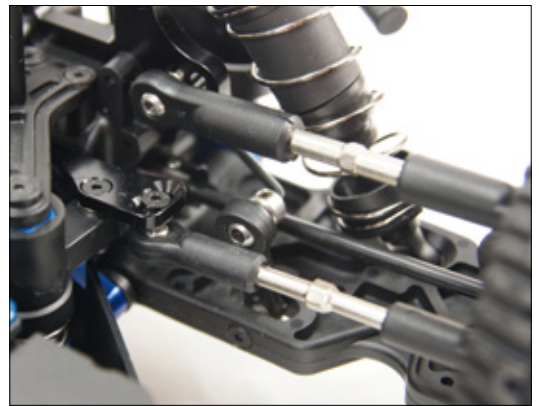
Fette Rechts-links-Gewindestangen gehören ebenso zum Standard wie die geschlossenen Querlenker und die verbauten Stabilisatoren
