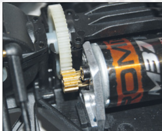
Ein kleiner Bürstenmotor überträgt seine Kraft per Messing-Ritzel in den Kunststoff-Antriebsstrang
