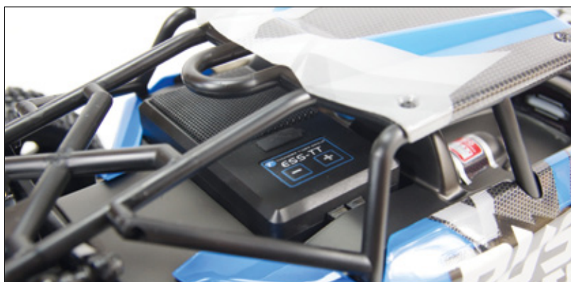
Das ESS TT-Soundmodul ist recht groß und findet oberhalb des Chassis seinen Platz. Durch die große Aussparung in der Karosserie kommt der Sound bestens rüber. Mit den Plus- und Minus-Tasten kann man die Lautstärke einstellen
