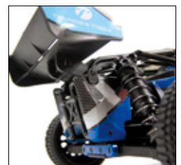
Direkt vor dem riesigen Heckflügel ist der Drehpunkt des klappbaren Käfigs angebracht. Ein kleiner Hilfsrahmen im Heck schützt vor feindlicher Berührung
