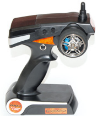
Absolute Gleichheit herrscht bei den Fernsteuerungen der Brüder. Beide sind mit Dromidas durchaus funktionaler D103 mit 2,4-Gigahertz-Technik unterwegs
