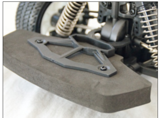
Ein massiver Schaumstofffrontträger schützt im Kampfgetümmel
