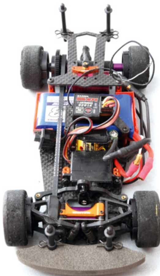
Das fahrfertige Chassis mit allen Komponenten. Vorne sind die Reifen an den Kanten mit Sekundenkleber versiegelt, um den Vorderachsgrip zu reduzieren
