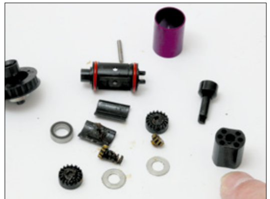
Das zerlegte vordere Differential zum Umbau auf Starrachse. Das Kunststoffteil vorne rechts ist das wesentliche Teil dafür
