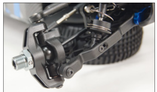
An der Vorderachse sind robuste C-Hubs aus sehr strapazierfähigem Nylon zu finden. In ihnen laufen kugelgelagerte CVD-Wellen für einen reibungslosen Kraftschluss
