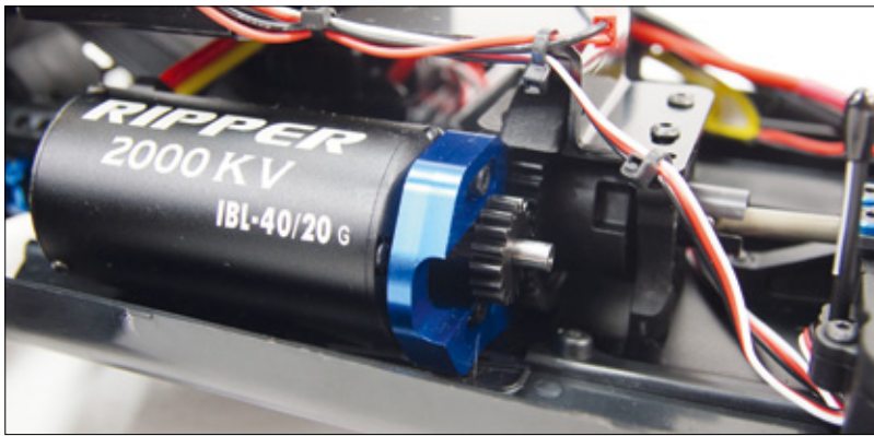
Der riesige Ripper-Brushlessmotor bringt seine Power auf den ausgereiften Antriebsstrang. Er wird von einem gewaltigen Aluminiumhalter fest im Griff gehalten
