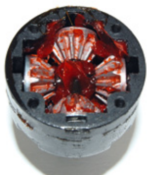
Vierspider-Diffs leiten die Antriebskräfte sicher und zuverlässig weiter
