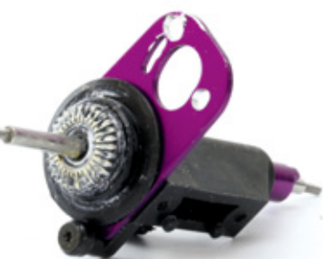
Der für den 3.000er-Brushlessmotor bearbeitete Motorhalter mit einem Teil der Hinterachse
