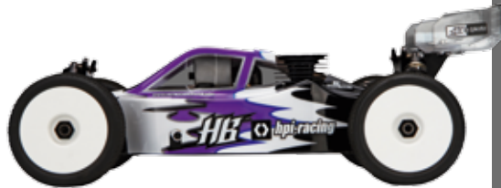
HB D815 inklusive CRF 21-Dreikanal-Motor und passendem Reso-Rohr von LRP electronic
