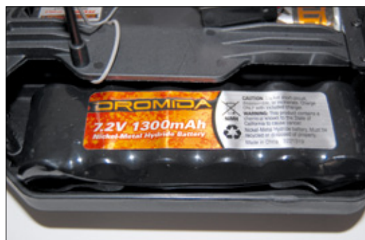
Als Kraftquelle kommt ein NiMH-Akkupack mit einer Kapazität von 1.300 Milliamperestunden und nominellen 7,2 Volt Spannung zum Einsatz
