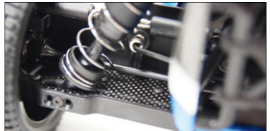
Auf den hinteren Querlenkern sind 2,5 Millimeter starke Carbon-Platten verschraubt, um der Konstruktion ein geschlossenes Design zu verschaffen. Zudem versteift diese Maßnahme die Querlenker
