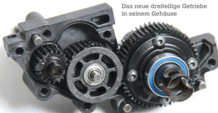
Das neue dreiteilige Getriebe in seinem Gehäuse
