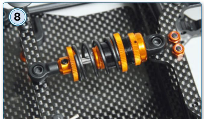
8 Der neue Stoßdämpfer muss nun nicht mehr ausgebaut werden, um den Ausfederweg zu verändern: Hier kann nun einfach der Federteller am Kolben verschoben werden
