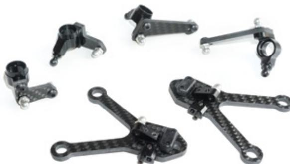
Die Radträger hinten sowie Lenkhebel vorne werden einheitlich mittels eines Kugelkopf an den CFK-Schwingen befestigt
