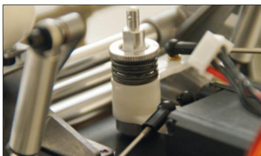
Ein großzügig dimensionierter Servo-Saver schützt das Lenkservo vor allzu harten Schlägen aus dem Fahrbetrieb
