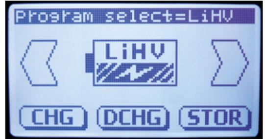
Die moderne Software lässt sich nicht nur über den Touchscreen sehr leicht bedienen, sie verfügt zudem auch über den immer öfter nutzbaren Lithium-HV-Modus
