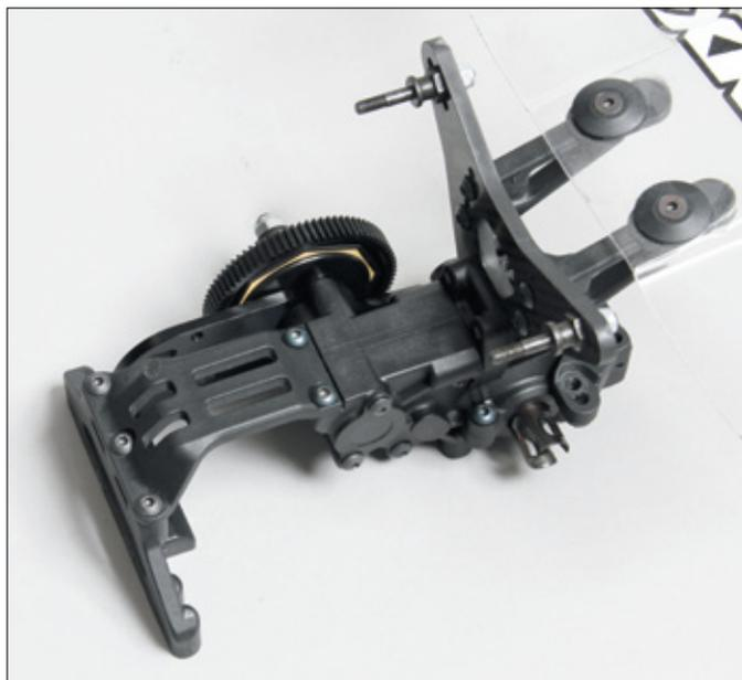
Der komplette hintere Aufbau mit der Getriebebox und dem neuen Motorhalter auf der rechten Fahrzeugseite
