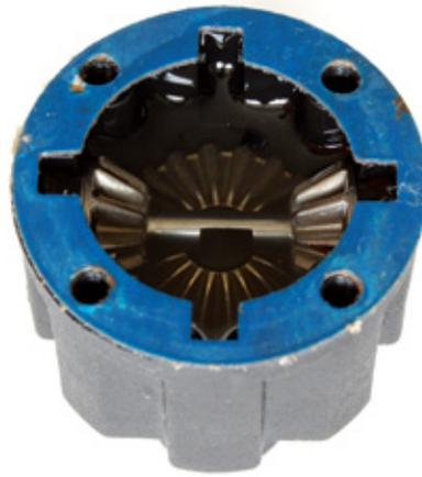
Licht und Schatten bei den Diffs. Sie sind bereits werkseitig mit Silikonöl gefüllt und mit Stahlzahnradern bestückt, verfügen aber nur über ein Paar kleiner Planetenrädchen. Deren zwei hätten die Ideallösung dargestellt
