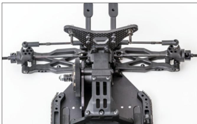
Blick auf die Hinterachse mit dem neuen dreistufigen Getriebe
