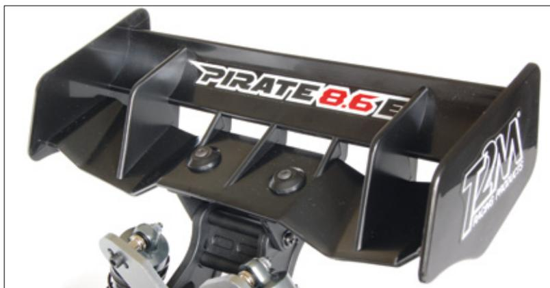
Ein großer Heckflügel gehört bei einem 1:8er-Buggy zum Pflichtprogramm. Die Ausführung am Pirate präsentiert sich mehrstufig und lässt hohen Anpressdruck erhoffen
