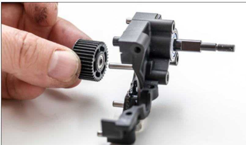
Auf die Einbaurichtung des Zwischenzahnrad
