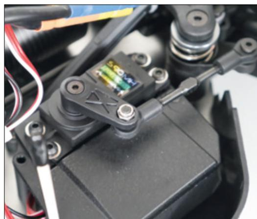
Mit 9,5 Kilogramm Stellkraft ist das Lenkservo ausreichend stark für alle Situationen. Auch die Stellzeit von 0,16 Sekunden fiel im Test nicht negativ auf
