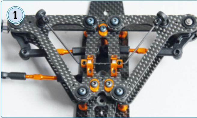
1 Der neue kugelgelagerte Stabilisator an der Vorderachse ist 1,2 Millimeter dick
