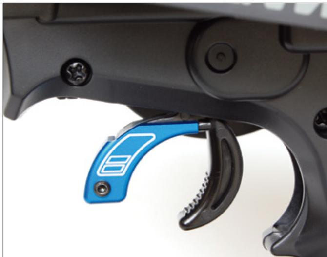
Der wechselbare Gashebelaufsatz aus Aluminium ist in drei Größen vorhanden
