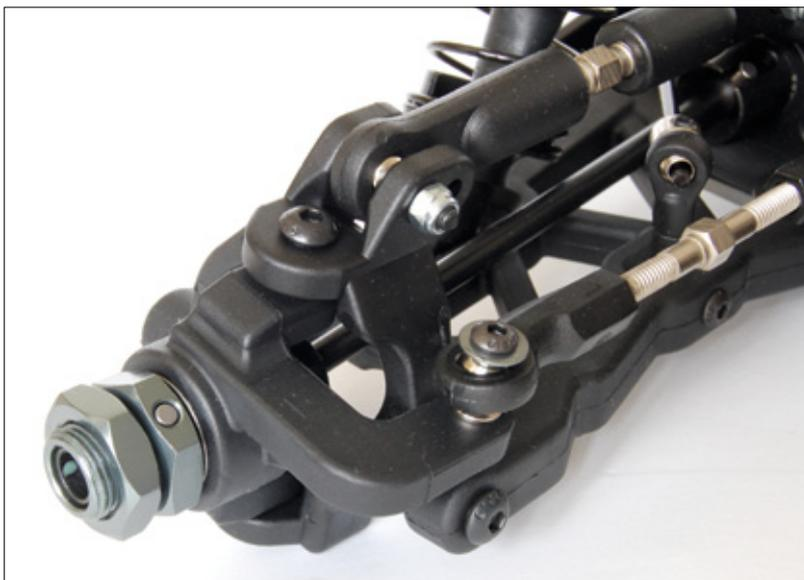
Rechts-links-Gewindestangen für Setup-Eingriffe sowie solide dimensionierte Aufhängungsparts prägen das Bild
