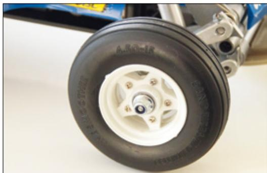
An der Vorderachse kommen kugelgelagerte Buggy-Rillenreifen mit sehr geringem Rollwiderstand zum Einsatz
