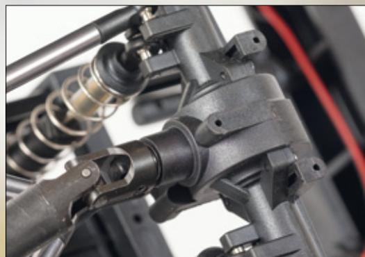
Wer die Geländegängigkeit des Modells noch erhöhen will, kann die beiden Kunststoffpins an den Achsen abschleifen. Somit bleibt man nicht mehr so schnell mit den Achsen irgendwo hängen
