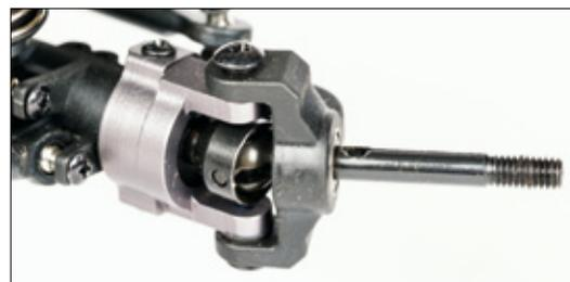
In den Achsen sind sogar CVD-Wellen montiert, die die Haltbarkeit erhöhen und den Lenkeinschlag verbessern sollen. Ein tolles Extra in dem RTR-Paket
