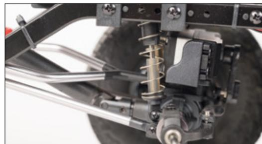
Die vier Öldruckstoßdämpfer haben Schlauchstücke als Anschlagsschutz
