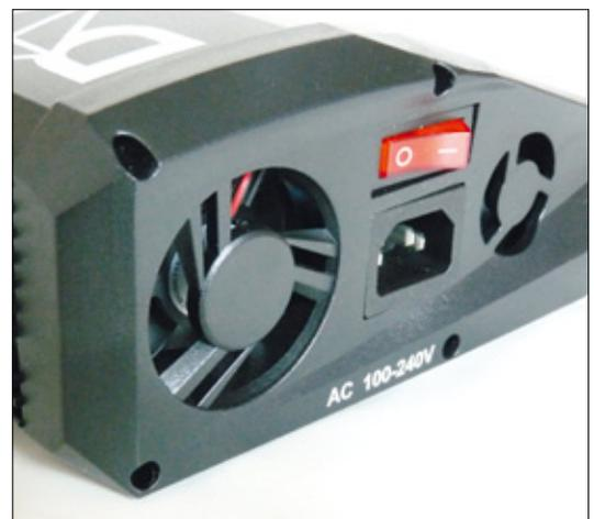
Die linke Seite beherbergt lediglich den AC-Anschluss für das mitgelieferte Netzkabel sowie einen beleuchteten Ein-aus-Schalter. Da das Netzteil den kompletten Leistungsbereich abdeckt, ist es eine vollwertige Alternative zur 12-Volt-DC-Nutzung
