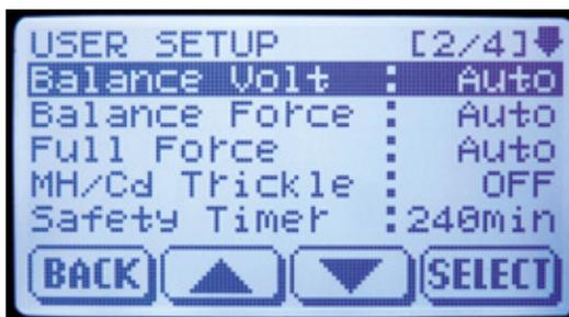
Als Besonderheit kann man im Menü des Duo Touch-Laders sogar Einfluss auf die Stärke des Balancerstroms nehmen – wenn auch nur in einigen vordefinierten Stufen. Zudem ermöglicht die Trickle-Ladung das Regenerieren von älteren NiXX-Akkus
