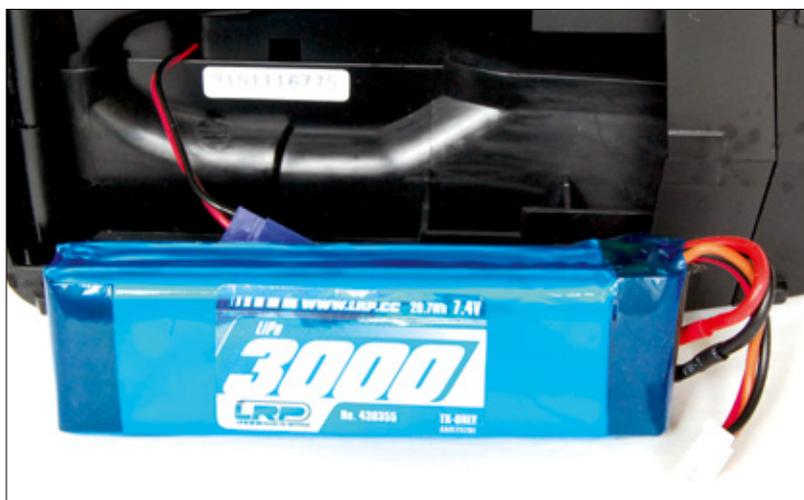
Ein LiPo vom Schläge des 3.000er-2S von LRP bildet in Sachen Spannung, Kapazität und Gewicht eine ideale Stromversorgung
