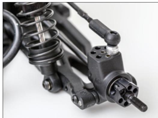
Der hintere Radträger bietet zahlreiche Einstellmöglichkeiten für den oberen Querlenker und zur Änderung des Radstands. Die Spurbreite kann durch andere Felgenmitnehmer variiert werden
