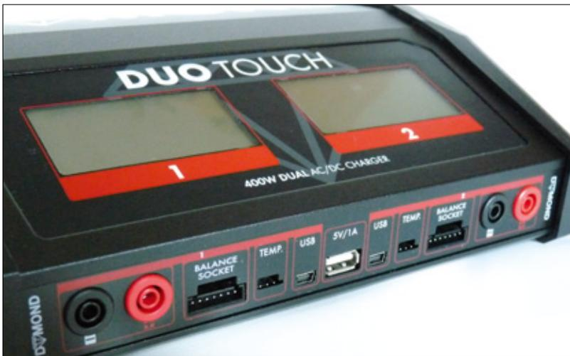
Bedient wird das Duo Touch komplett über die Front, da sich dort auch alle erforderlichen Anschlüsse zu den aufzuladenden Akkus befinden. Der mittige USB-Port ist elektrisch mit dem ersten Ladeausgang verbunden, der Rest ist komplett unabhängig nutzbar
