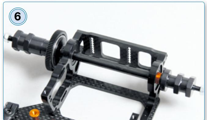
6 Die Antriebswelle aus Aluminium. An den Bulkheads wird der neue Heckflügelhalter aus Kohlefaser montiert
