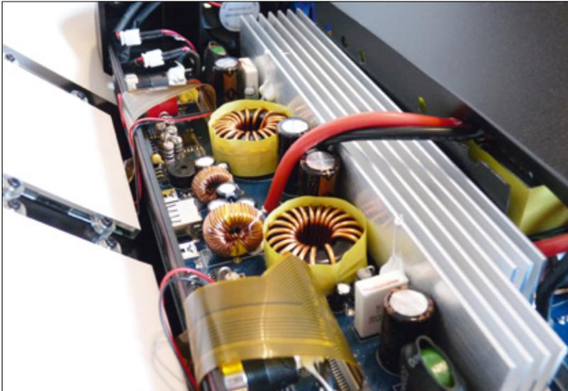
Neben dem bulligen Kühlkörper der Ladeendstufe fällt vor allem der symmetrische Aufbau beider Ladeteile auf. Zudem ist alles sauber verarbeitet und Kabel sowie Kondensatoren wurden an den relevanten Stellen mit Kleber gesichert
