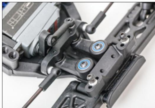
Blick auf die kugellagerte Doppelarm-Anlenkung
