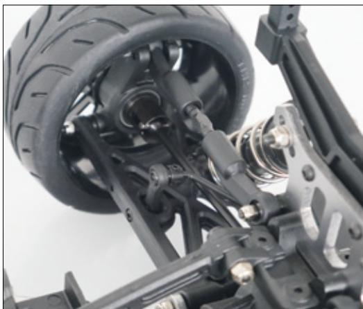
Stabilisatoren gibt es an beiden Achsen ebenso serienmäßig wie Rechts-links-Gewindestangen zum Einstellen des Fahrwerks-Setups
