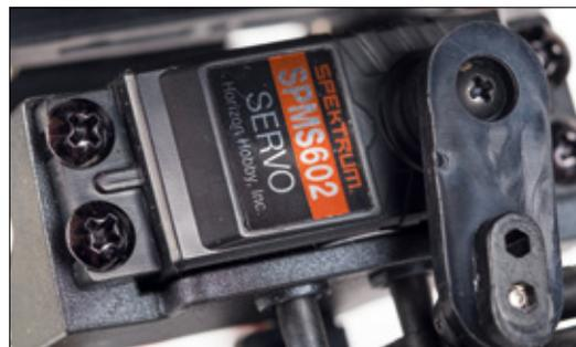
Das Lenkservo ist wie beim Crawler auf der Achse befestigt. Vielleicht nicht ganz so scalig, aber praktisch und effektiv. Das Spektrum-Servo hat Zahnräder aus Nylon und bei 4,8 Volt eine Stellkraft von 1,2 Kilogramm
