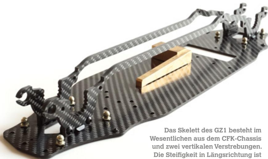
Das Skelett des GZ1 besteht im Wesentlichen aus dem CFK-Chassis und zwei vertikalen Verstrebungen. Die Steifigkeit in Längsrichtung ist tadellos, während gleichzeitig das Flex-Verhalten sichergestellt wird
