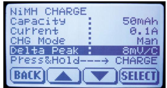
Selbstverständlich beherrscht das Gerät auch NiXX-Akkus und lässt hierbei eine Einstellung des Delta Peak Werts für die Abschaltung im Bereich von 4 bis 20 Millivolt zu. Beim Entladen wird die Gesamtspannung eingestellt und nicht die Anzahl der Zellen und deren Spannung
