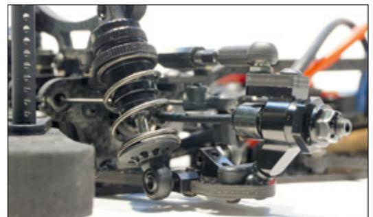
Der Lenkhebel wird oben wie unten durch einen Kugelkopf geführt. Man beachte den hochwertigen Mix aus Aluminium und Carbon
