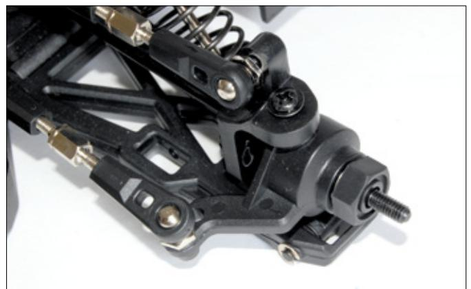
Per C-Hub-Lenkung werden die Vorderräder in die gewünschte Richtung gesteuert. Rechts-links-Gewindestangen für Spur und Sturz bilden zentrale Elemente zur Fahrwerksabstimmung
