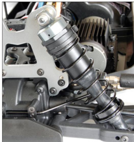
Die mechanisch am höchsten belasteten Bereiche der oberen Stoßdämpferkappen wurden aus Alu gefertigt – gut so
