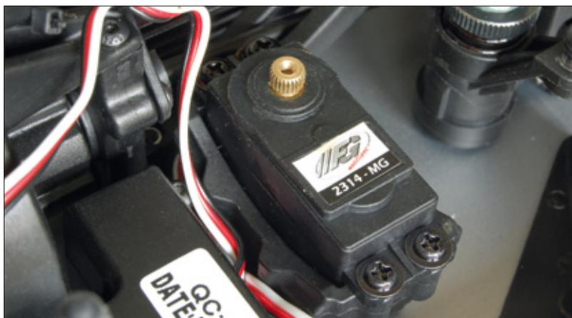
Um Schäden durch Belastungen im harten Offroad-Alltag entgegenzuwirken, hat T2M dem 8.6E werkseitig ein Lenkservo mit Metallgetriebe spendiert
