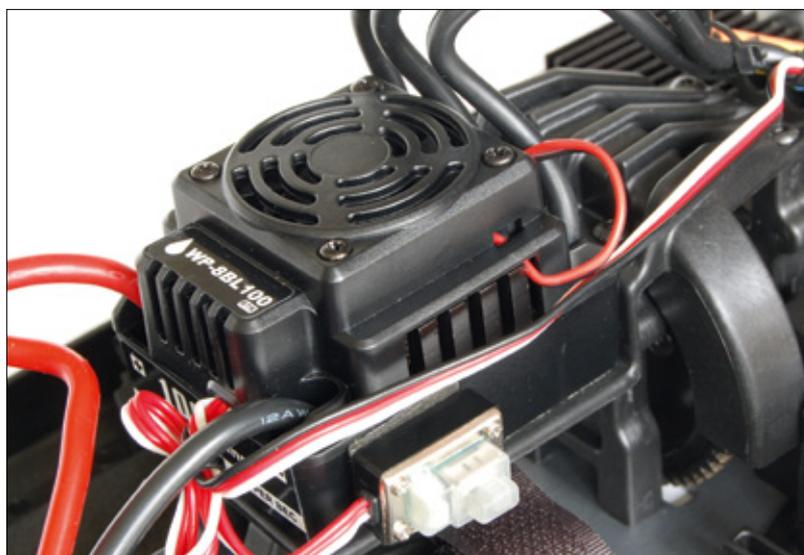
100 Ampere maximale Strombelastbarkeit sind für den Regler eines RTR-Modells durchaus respektabel. Per aktivem Lüfter wird die Arbeitswärme nach außen geführt
