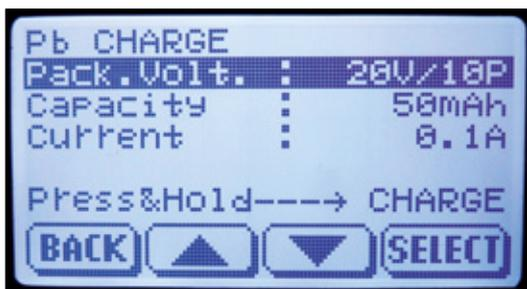
Größere Bleiakkus mit bis zu 50 Amperestunden Kapazität lassen sich komplett überwacht aufladen, wobei Akkus mit bis zu 20 Volt nutzbar sind. Die Ladung erfolgt bis zu einem Wert von 200 Watt mit maximal 10 Ampere
