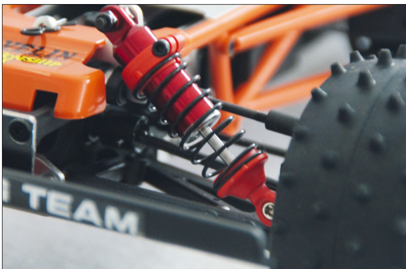
Die großen Alustoßdämpfer weisen vorne leider nur eine Montagemöglichkeit an den massiven Querlenkern aus Kunststoff auf, arbeiten aber absolut smooth
