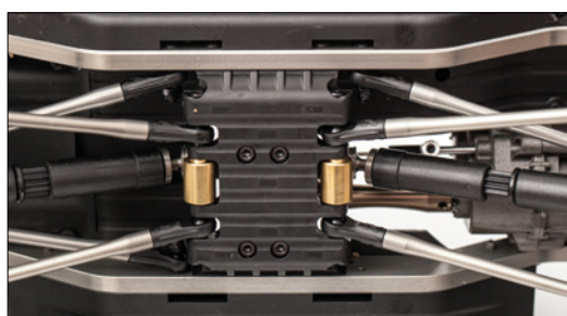
Der Rahmen ist aus metallenen C-Profilen geformt. In der Mitte sind die Links an der Skid-Platte befestigt.
