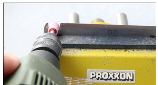
Zum Bearbeiten der Öffnung sollte man das Fühlerblatt in den Schraubstock spannen
