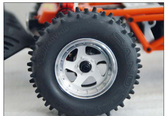
Die Reifen und Felgen des Javelin folgen keiner aktuellen Wettbewerbsnorm. Die verwendete Gummimischung und das grobe Spikeprofil der Reifen ermöglichen dennoch extreme Performance
