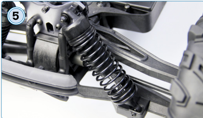
Die Big-Bore-Stoßdämpfer sind komplett aus Kunststoff gefertigt. Mit den mitgelieferten Clips kann die Federvorspannung geändert werden
