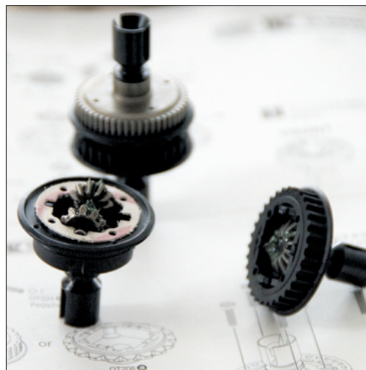
Die beiden Differenziale beherbergen gefräste Metallzahnräder und sind sehr hochwertig ausgeführt
