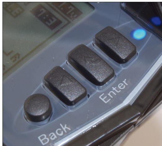
Statt des sonst bei Sanwa-Anlagen häufig verwendeten Scrollrads kommen bei der MT-S vier Knöpfe zur Menüsteuerung zum Einsatz
