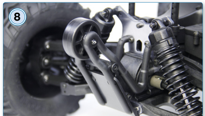
Eine ab Werk angebrachte Wheeliebar ergibt bei so einem leistungsstarken Monstertruck durchaus Sinn
