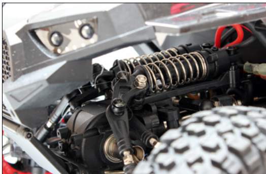
Die Stoßdämpfer an der Vorderachse sind liegend verbaut und verrichten ihre Arbeit über ein Umlenkgestänge
