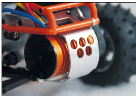
Der verbaute Brushlessmotor wird durch einen massiven Alurammer am Heck gut geschützt
