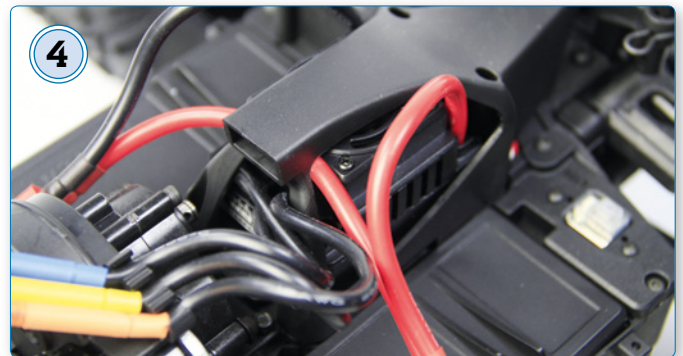
Der wasserfeste Brushlessregler verträgt bis zu 150 Ampere und kann mit bis zu 6s-LiPo-Akkus betrieben werden. Für die optimale Kühlung sorgt der aktive Lüfter der auf dem Regler montiert ist. Zudem bietet der luftzuführende „Käfig“ einen guten Schutz
