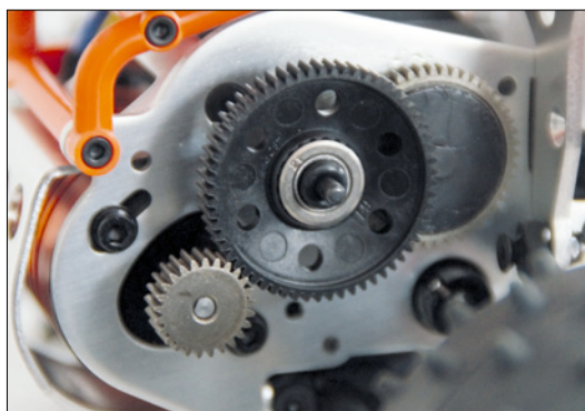
Ein Blick auf das überarbeitete Getriebe: alles kugellagert, einstellbarer Slipper, Motorritzel aus Stahl – so soll es sein
