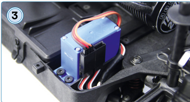
Ein Savox SW0231-Lenkservo mit einer Stellkraft von 15 Kilogramm sorgt zusammen mit dem einstellbaren Servosaver für eine präzise und kraftvolle Steuerung der Räder. Das verbaute Metallgetriebe sorgt zudem für die nötige Haltbarkeit
