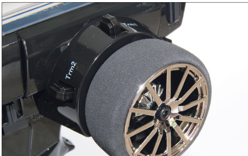
Per griffigem Moosgummi-Überzug auf dem Lenkrad wird die Richtung gewechselt. In direkter Nachbarschaft sitzen drei Trimmshalter zur Direkteingabe frei wählbarer Funktionen
