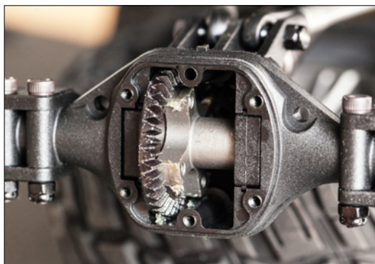
Blick in das hintere Getriebegehäuse mit dem gesperrten Kegelrad
