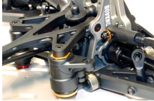
Ein Servosaver im rechten Umlenkhebel ist Programm. Beide Umlenkhebel sind – ebenso wie der gesamte Antriebsstrang – mit gedichteten Kugellagern bestückt
