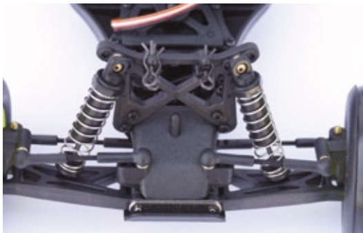
Die Stoßdämpfer sind auf das Gewicht des Fahrzeuges gut abgestimmt
