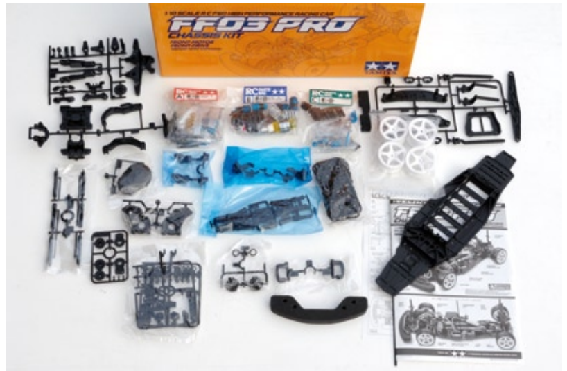
Einzelteile des Bausatzes, der das reine Chassis ohne Motor, Elektronik, Reifen und Karosse enthält
