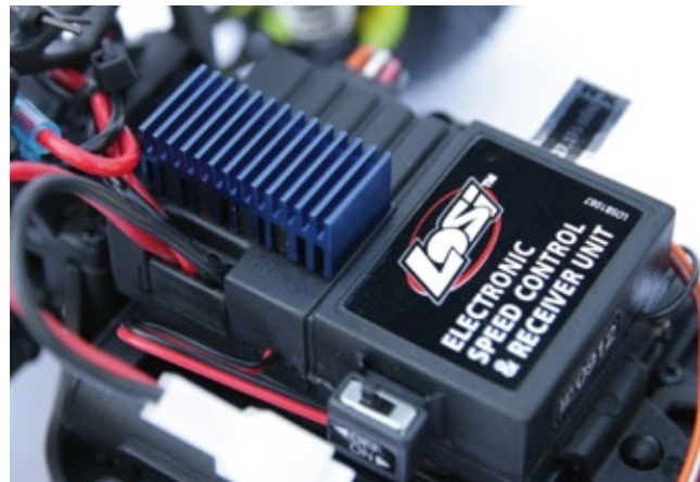
Die Regler- und Empfangseinheit baut relativ hoch und verlagert den Schwerpunkt nach oben
