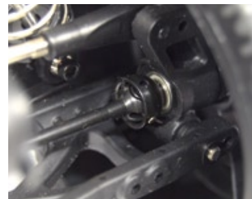
CVD-Wellen sorgen für eine sichere Kraftübertragung
