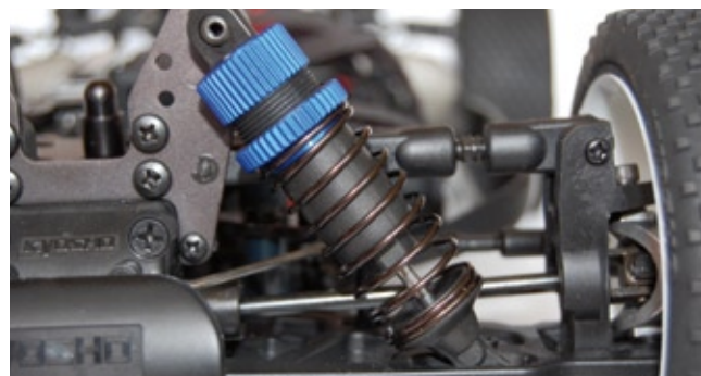
An beiden Buggys bügeln Bigbore-Dämpfer Unebenheiten effizient aus
