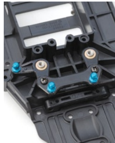
Der Zusammenbau beginnt mit dem Einbau der Lenkbrücke
