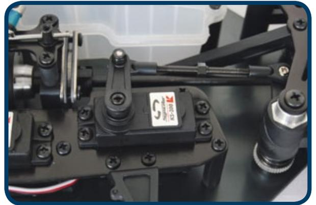
Als Lenkservo fungiert ein Syncro KS-200. Die Lenkmechanik ist mit einem Servosaver versehen
