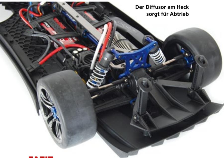
Der Diffusor am Heck sorgt für Abtrieb
