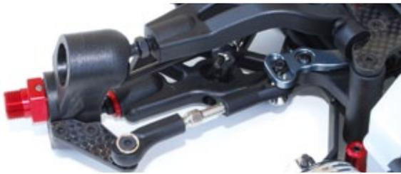
Dank der Pivotball-Aufhängung verfügt der S350BK1 über einen großen Lenkausschlag. Austauschbare Lenkhebelarme sowie die Lenkbrücke ermöglichen diverse Einstellungen der Geometrie
