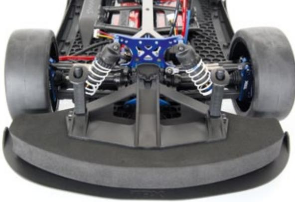
**Der serienmäßige Frontsplitter wird für Hochgeschwindigkeitsfahrten gegen ein Pendant ersetzt. Der Kunststofframmer schützt im Falle eines Crashes die Achse**
