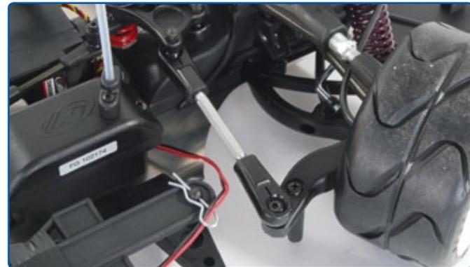
**An der Vorderachse erfolgt die Einstellung der Spur über das Lenkgestänge**
