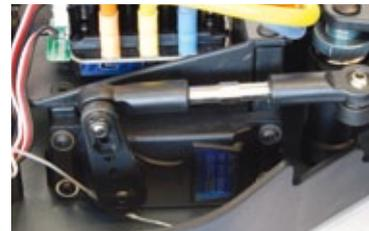
Das MS-241-Servo ist liegend verbaut, verfügt über ein Metallgetriebe und stellt 20 Kilogramm. Die Bewegungen werden über eine Mechanik samt Servosaver weitergeleitet
