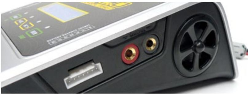
Die beiden 4-Millimeter-Goldbuchsen, der Balanceranschluss und der Lüfterausgang prägen die rechte Seite des in einem technisch schnörkellosen Design gehaltenen XMovE 2.0-Laders
