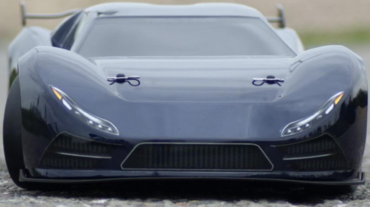
Kunststoffseitenteile sowie zwei Rahmenstücke erweitert. Letztere sorgen für die Fixierung der Karosserie am Chassis. Dies ist bei den anvisierten Geschwindigkeiten sicher nicht verkehrt. Gleiches gilt für den Frontsplitter. Auch dessen Seiten bilden einen Rahmen für die Haube.
