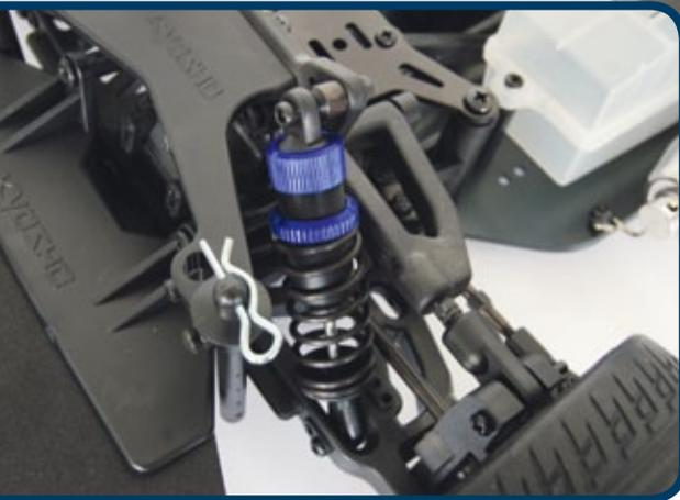
Die Federvorspannung der Öldruckstoßdämpfer lässt sich über Rändelschrauben anpassen
