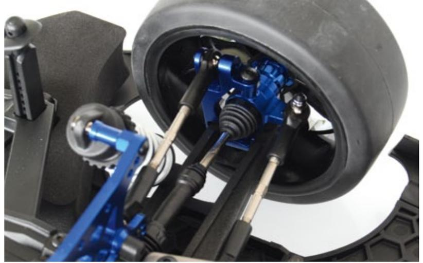
**Die C-Hubs und Achsschenkel an der Vorderachse bestehen aus blauem Aluminium. Bei den Antriebswellen handelt es sich um zweiteilige CVD-Wellen, deren gefettete Gelenke mit Gummiüberzügen vor Staub geschützt sind**
