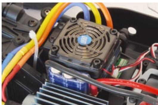
**Der MSC-27BL-Regler verkraftet einen Dauerstrom von 150 Ampere, wird aktiv gekühlt und ist ab Werk mit dem Motor verbunden**
