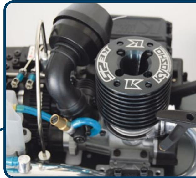
Für Vortrieb sorgt ein KE-25 Xtreme Power-Motor. Bei dem Aggregat handelt es sich um einen 4,17-Kubikzentimeter-Motor mit Seilzugstarter
