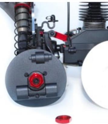
**Die Schutzscheiben (Dust-Disks) können nur in Verbindung mit den originalen Felgen verwendet werden, da sie einen größeren Innendurchmesser besitzen als herkömmliche 1:8er-Felgen**
