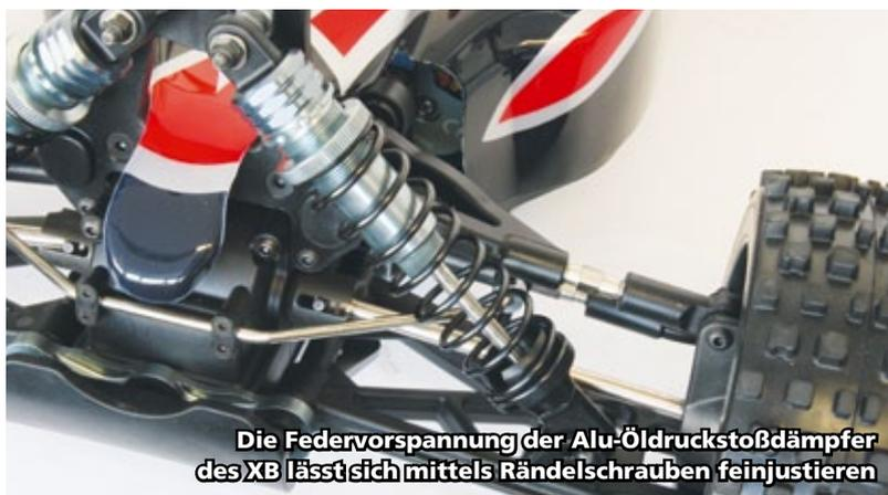
**Die Federvorspannung der Alu-Öldruckstoßdämpfer des XB lässt sich mittels Rändelschrauben feinjustieren**
