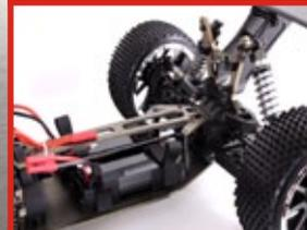
Bereit für den Offroad-Einsatz: Alu-Chassisplatte und robuste Federung 4 x 4 Antrieb
