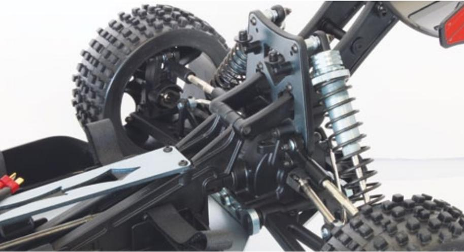
Die Hinterachse ist über lange Kunststoffstreben mit dem Chassis verbunden. Für zusätzliche Verwindungssteifigkeit sorgt das Oberdeck
