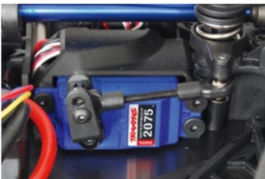
**Beim Traxxas 2075 handelt es sich um ein Digitalservo mit einer Stellkraft von 9 Kilogramm. Die Stellzeit beträgt 0,17 Sekunden auf 60 Grad**
