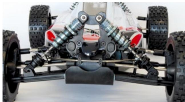
Die Vorderachse basiert auf einem großen Diffgehäuse in Kombination mit Doppelquerlenkern, Öldruckstoßdämpfern und serienmäßigen Stabis
