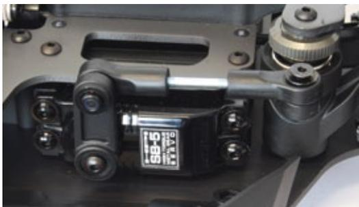
**Beachtliche 11,8 Kilogramm Stellkraft bewerkstelligt das HPI SB-5-Servo auf der Lenkung**
