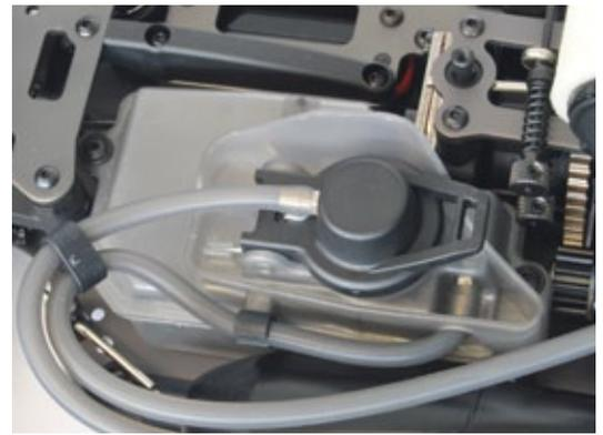
Der Tank verfügt über einen Spritzschutz. Eine Tankfüllung reicht für gut zehn Minuten Fahrspaß
