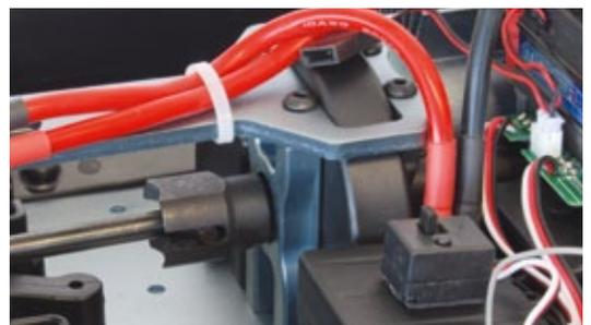
Das gekapselte Hauptzahnrad ist in einer soliden Halterung platziert und bildet einen Teil des kugelgelagerten Antriebsstrangs
