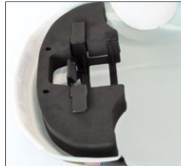
Damit die Karo während eines Laufs nicht hochklappt, wird sie am Frontbumper verriegelt
