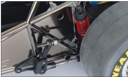
An der Hinterachse befindet sich ein ausgeklügeltes Dreilink-System inklusive Stabis und Dämpfern
