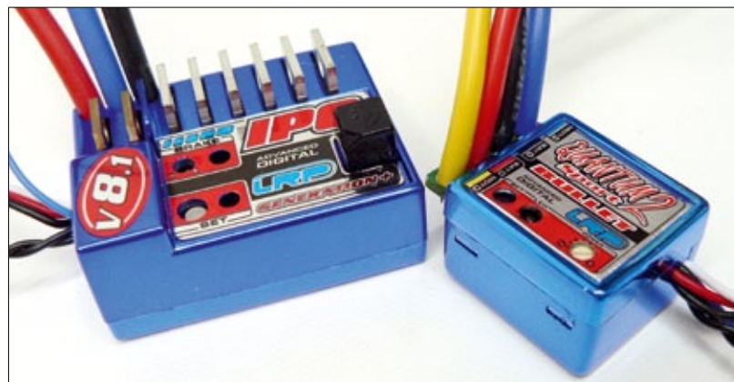
Beide Regler haben in etwa gleiche Leistungsdaten, die kompaktere Bauweise verdankt der rechte Regler neueren Mosfets
