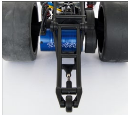
Die Wheelie-Bar ist einstellbar und schützt das Modell – im Speziellen den Motor – vor Rückwärtssaltos beim Start
