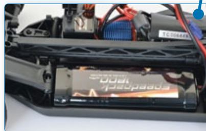
Auf der linken Seite befindet sich der Akkuschaft, in dem bereits werkseitig ein NiMH-Akku mit 1.800 Milliamperestunden Kapazität untergebracht ist.
