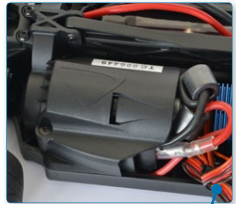
Der Dynamite-Büstenmotor ist im Chevrolet Camaro RS auf der rechten Chassisseite unter einer Kunststoffabdeckung platziert
