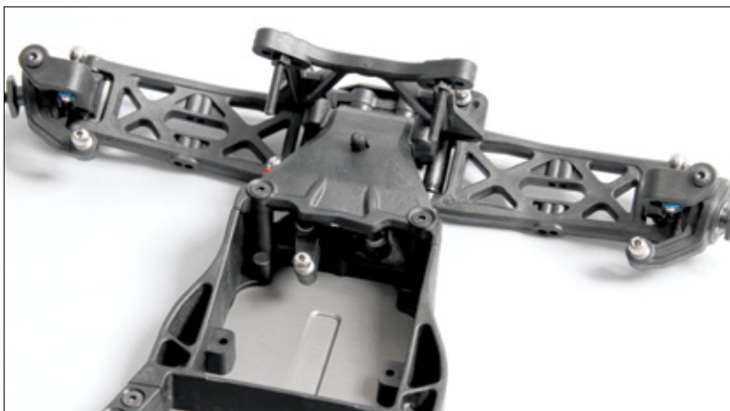
Die angewinkelten Gullwing-Querlenker an der Vorderachse des B5M
