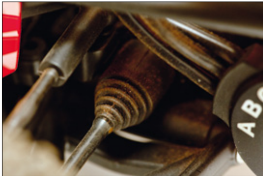
Die Antriebswellen sind mit Gummimanschetten geschützt. In der Hinterachse arbeitet das innovative Viskose Torque Vectoring-Diff, kurz VTV
