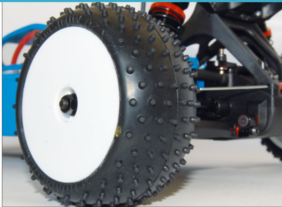
Gummimischung und Profilausführung sind die zwei zentralen Parameter bei der Reifenbestimmung
