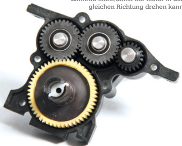
Die mehrstufige Getriebeeinheit des B5
