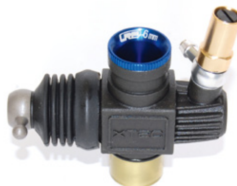
Neben dem werksseitig verbauten 6er-Venturi lassen sich in den wärmeabgeschirmten Dreinadelvergaser auch mitgelieferte Einsätze mit Durchlässen von 6,5 und 7 Millimeter platzieren
