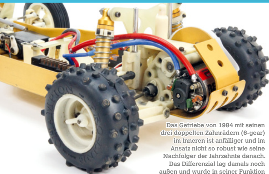
Unterschiedlicher, wie Zwillinge nicht sein können. Die neue Mid-Motor-Generation mit dem 4-Stufengetriebe unterscheidet sich erheblich von der alten Generation
