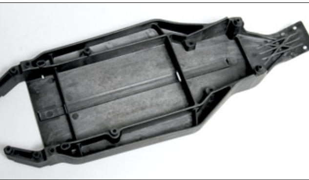
Das typische Wannenchassis aus Kunststoff eines Offroaders mit Heckmotor (B5)
