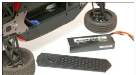
Die Stromversorgung übernimmt ein Dynamite-LiPo mit zwei Zellen. Er wird über eine praktische Klappe auf der Modell-Unterseite eingelegt
