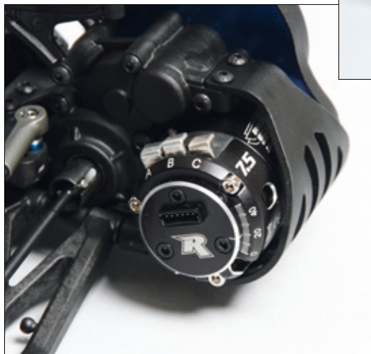
Hier gut zu erkennen, die Positionierung des Motors am Heck des Modells
