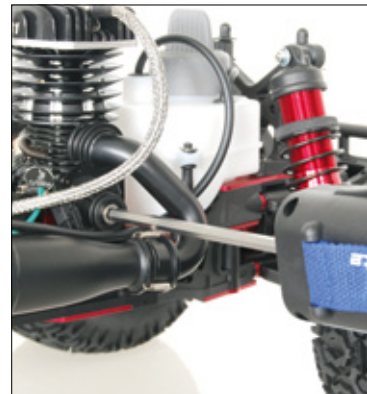
Praktisch: gestartet wird über den beiliegenden 7,2-Volt-Elektrostarter. Der Akku ist jedoch separat zu besorgen
