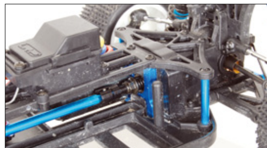
Zentrale Knochenwelle und Rutschkupplung garantieren einen zuverlässigen und haltbaren Antriebsstrang
