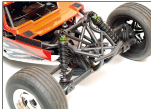
Die Öldruckstoßdämpfer sind zwar größtenteils aus Kunststoff gefertigt, überzeugen jedoch mit butterweichem Dämpfverhalten
