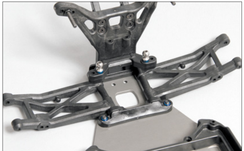
Identische Schwingen und Halterungen finden sich an der Hinterachse beider Buggys, hier am Beispiel des B5M
