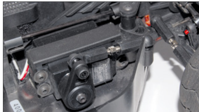
Das Standard servo verfügt serienmäßig über einen Servo-Saver. Die Lenkung wartet mit Rechts-links Gewindestangen auf
