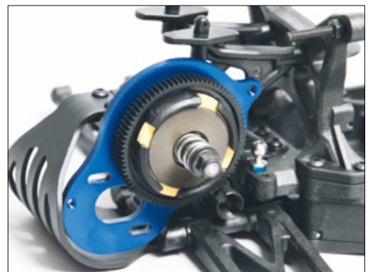
Die komplette Getriebeeinheit und Motorhalterung der Heckmotorversion (B5)
