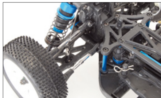
An der Vorderachse verbinden CVD-Wellen das Diff mit den Radachsen
