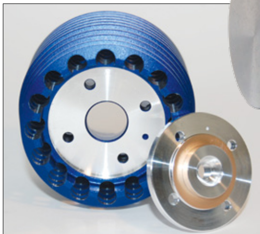
Diverse Bohrungen erleichtern den Kühlkopf. Sein separater Brennraum nimmt Glühkerzen in Turbo-Bauweise auf
