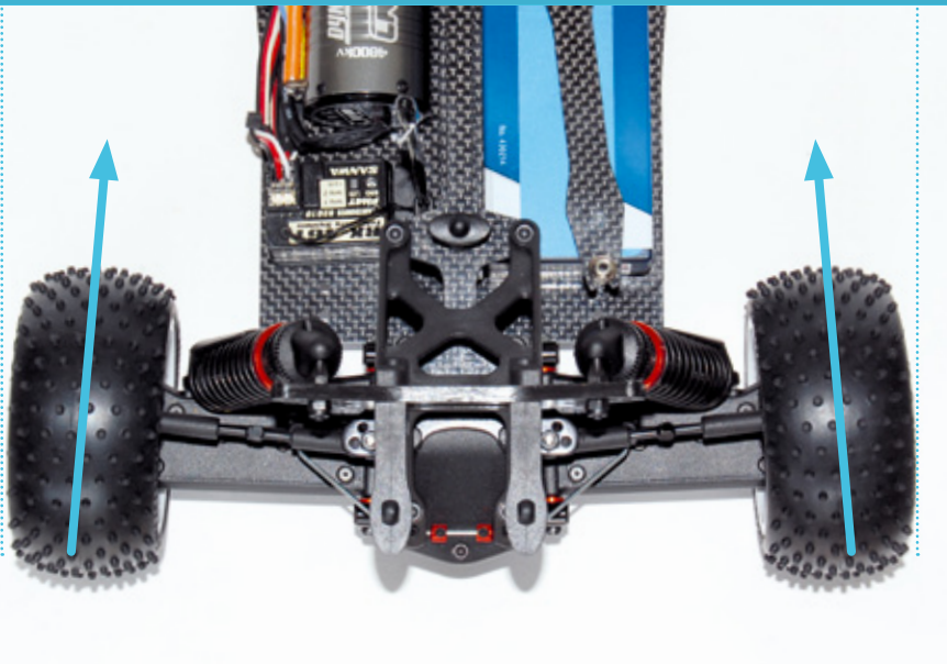
Diese Hinterachse zeigt eine Vorspur, bei der die Räder aufeinander zulaufen
