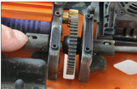
Nach dem Test auf der Rennstrecke sind am Mitteltrieb kaum Abnutzungen zu erkennen
