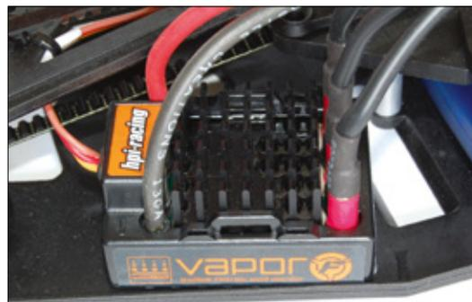
HPIs Flux-Vapor-Regler sorgt für die Umsetzung der Gas- und Bremsbefehle
