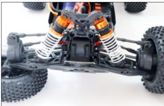
Die Vorderachse des Buggys. Deutlich sind die drei Einstellmöglichkeiten oben und unten am Dämpfer zu sehen
