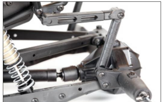
Das etwas ausgefallene Long Travel-Stabilisatorsystem sorgt für eine optimale Kraftübertragung der Räder auf den Boden, da die Seitenneigung reduziert wird
