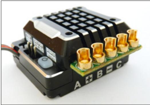
Unterhalb der gut zugänglichen und nicht zu dicht stehenden Lötspalten befindet sich der Sensoranschluss
