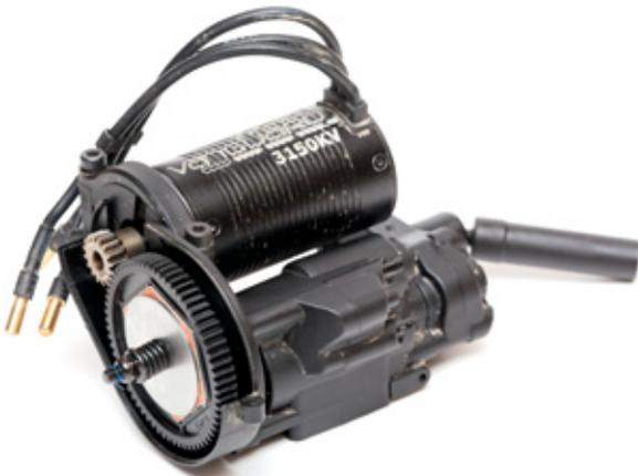
Der fertig montierte Antriebsblock nach einer ausgiebigen Nachschmierung der Stahlinnereien
