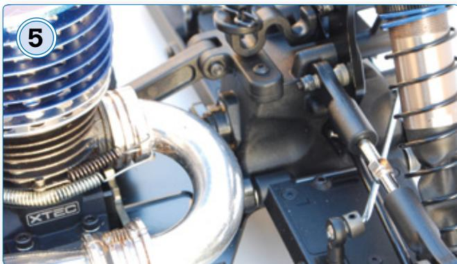
Um die neue Kombination aus Triebbling und zentraler Antriebswelle umsetzen zu können, wurden völlig neue Getriebekästen entworfen
