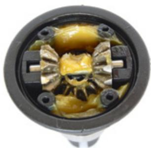
Um die Drehzahlunterschiede zwischen den Rädern einer Achse auszugleichen, verfügt der Sprint über zwei Kegelrad-Differenziale. Deren Zahnräder wurden aus Stahl gefertigt, was angesichts des starken Antriebs eine gute Wahl darstellt
