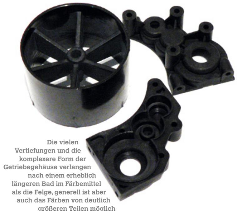
Die vielen Vertiefungen und die komplexere Form der Getriebegehäuse verlangen nach einem erheblich längeren Bad im Färbemittel als die Felge, generell ist aber auch das Färben von deutlich größeren Teilen möglich
