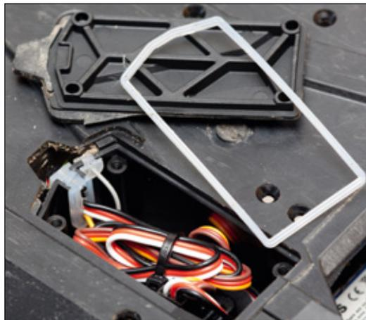
Das Fach für den Empfänger ist unter dem Chassis zu finden. Das Fach und die Kabeldurchführungen sind wasserdicht. Testfahrten durch größere Pfützen brachten keine Feuchtigkeit ins Innere
