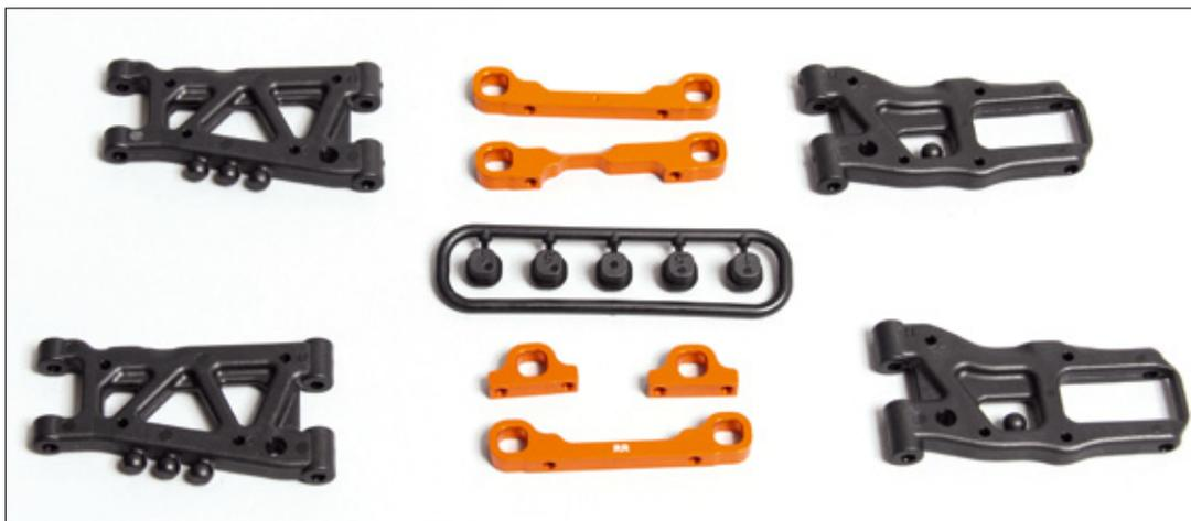
Die Schwingen und deren Halter. Mit den Einsätzen kann die Position der Schwingen verändert werden
