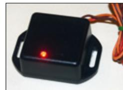
Der GPS-Empfänger für die Geschwindigkeitsmessung
