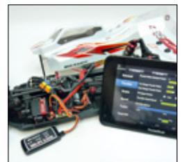
Der Regler verfügt über eine optionale W-Lan-Schnittstelle. Das Setup wird dadurch sehr vereinfacht, da die Android-App wirklich gut und übersichtlich gemacht ist und auch hier Firmware-Updates möglich sind
