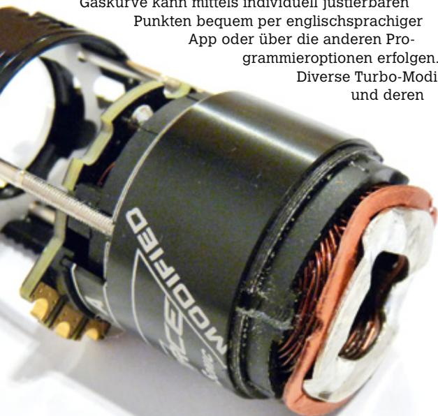
Das sauber gearbeitete Statorpaket besteht aus dicken Kupferwicklungen und sorgt mit Feinschnittblechen für einen optimalen Fluss des Magnetfelds
