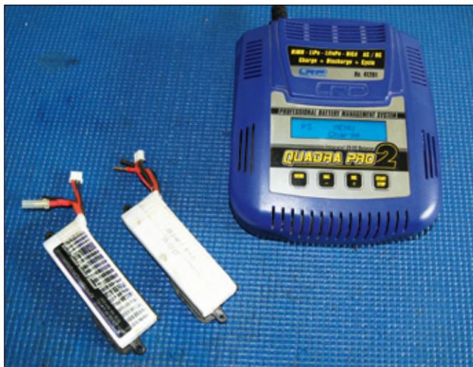
In Sachen Stromversorgung hält sich der Aufwand bei einem Nitromodell in einem überschaubaren Rahmen. Zwei Empfängerakkus und ein Ladegerät der 50-Watt-Klasse sind vollkommen ausreichend
