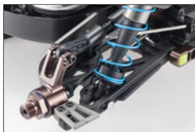
Solide Alu-Achsträger sitzen an den neu-designnten unteren Querlenkern. Selbstverständlich verfügt der TKI4 über ein vollständig einstellbares Fahrwerk
