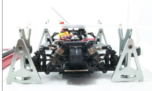
Das Chassis bei der Vermessung von Spur und Sturz. Als Basis-Setup eignen sich die Werksparameter ideal
