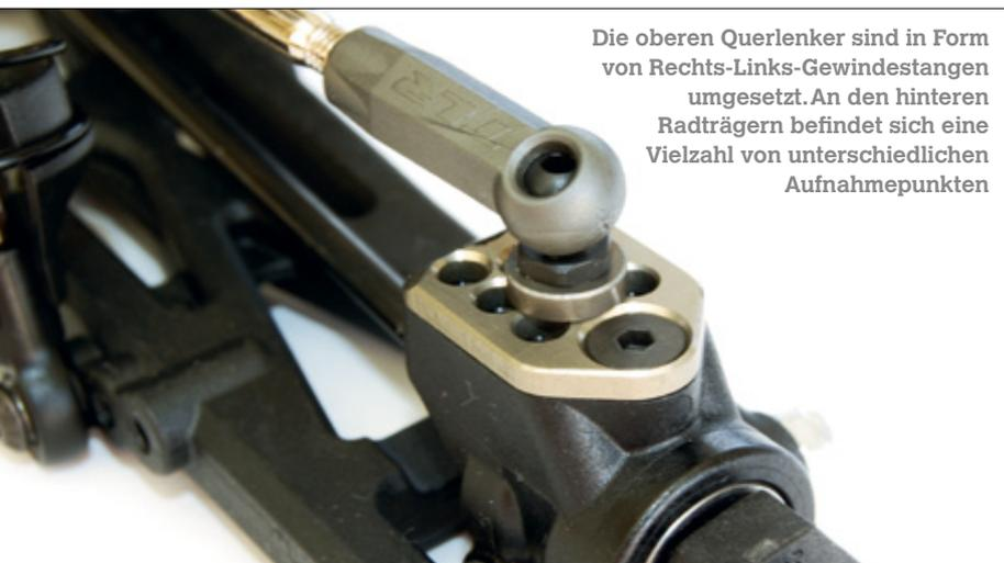
Die oberen Querlenker sind in Form von Rechts-Links-Gewindestangen umgesetzt. An den hinteren Radträgern befindet sich eine Vielzahl von unterschiedlichen Aufnahmepunkten
