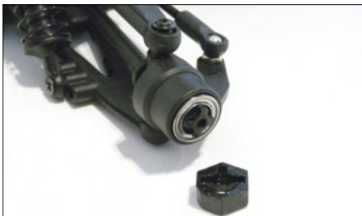
Der genutzte Sechskantadapter im 12-Millimeter-Standard ermöglicht die Nutzung vieler gängiger Reifen-Felgen-Kombinationen
