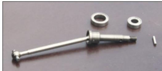
An der Hinterachse sind CVD-Eellen verbaut, die auch kugelgelagert sind
