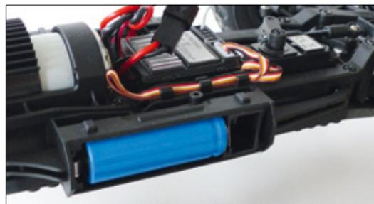
Die seitlichen Abdeckungen lassen sich mit einem Schlitzschraubendreher problemlos entfernen, um die Fahrakku auszutauschen. Da jeweils eine Zelle pro Seite zum Einsatz kommt, ist die Gewichtsverteilung optimal
