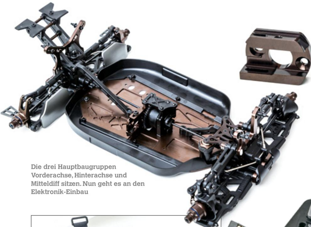
Die drei Hauptbaugruppen Vorderachse, Hinterachse und Mitteldiff sitzen. Nun geht es an den Elektronik-Einbau
