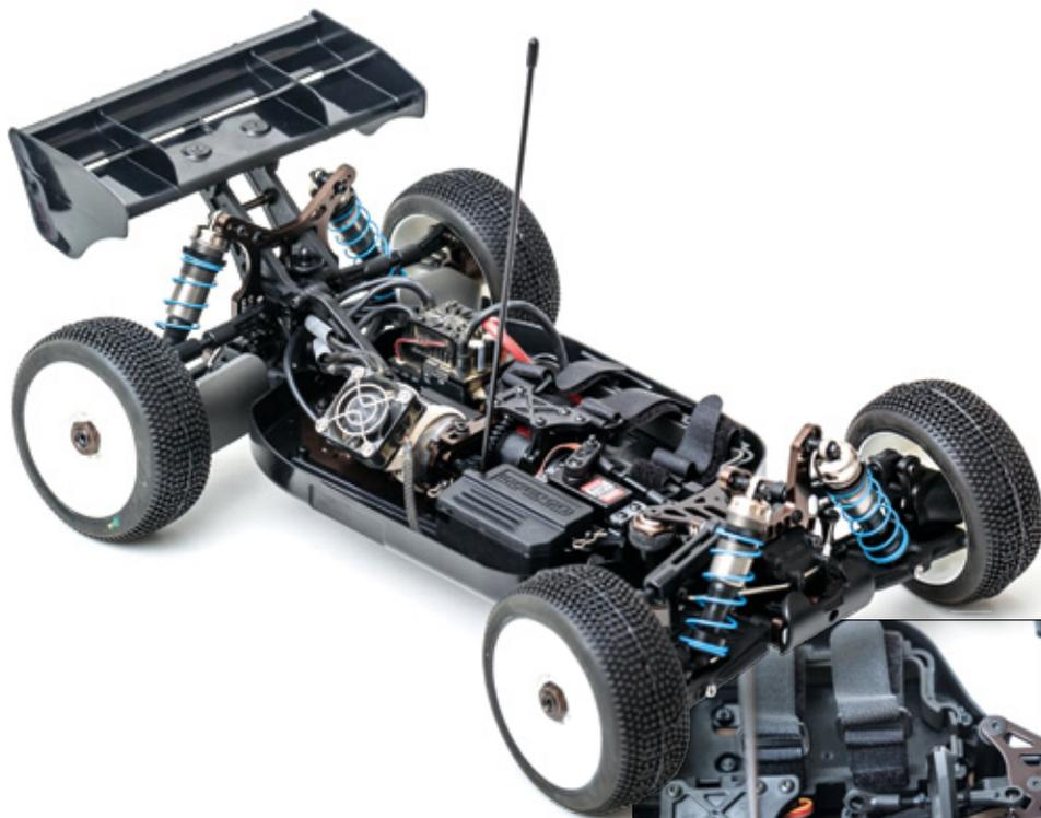
ließ sich sauber um den Kurs zirkeln. Die Differenziale waren wie im Baukasten-Setup mit 5.000-, 5.000- und 3.000-WT-Öl befüllt. Die Bodenfreiheit lag bei 25 beziehungsweise 27 Millimeter und kleinere Änderungen sorgten für eine Verbesserung des Fahrverhaltens. Schlussendlich ist das Baukasten-Setup eine gute Ausgangsbasis, das viele Kyosho-Piloten mit leichten Änderungen fahren.
