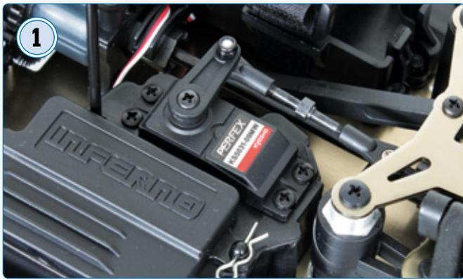
1 Für die kraftvolle Umsetzung der Lenkbefehle sorgt ein wasserdichtes Perfix-Servo des Typs KS5013-09MW
