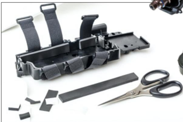
Mit Schaumstoffstreifen wird das Akkufach ausgepolstert
