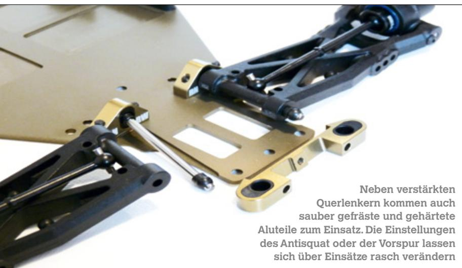
Neben verstärkten Querlenkern kommen auch sauber gefräste und gehärtete Aluteile zum Einsatz. Die Einstellungen des Antisquat oder der Vorspur lassen sich über Einsätze rasch verändern
