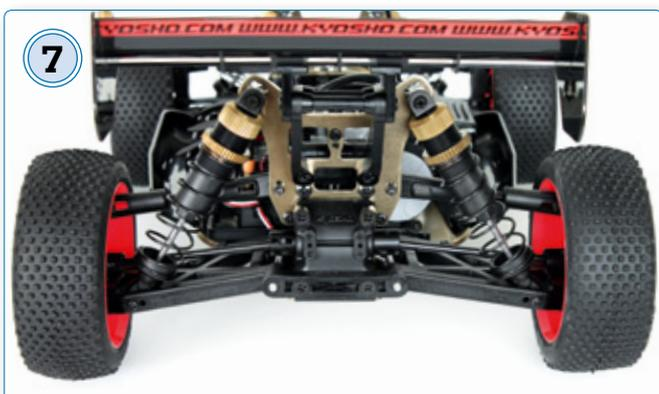
7 Auf einer Doppelquerlenker-Konstruktion basiert auch die Hinterachse des Inferno. Wie bei der Vorderachse sind serienmäßig keine Stabis verbaut
