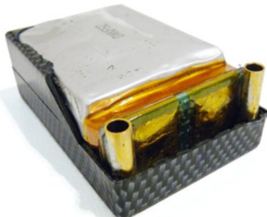
RC-Car-LiPos sind mit einer festen Kunststoffhülle ummantelt, die vor Schäden schützt
