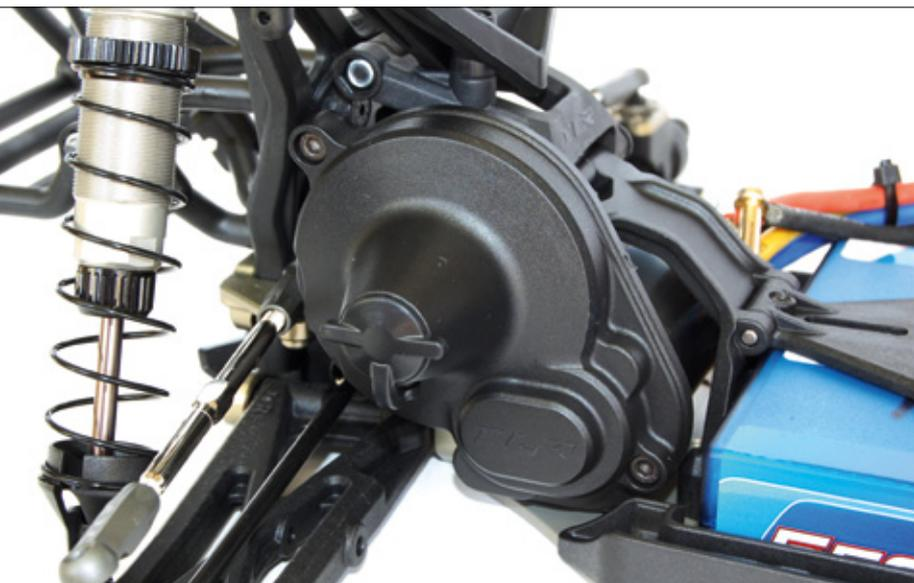
Hauptzahnrad und Motorritzel werden durch eine Kunststoff-Abdeckung vor äußeren Einflüssen geschützt. Für einen leichten Zugang sitzt mittig ein Gummistopfen
