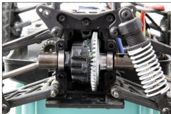
Mit wenigen Schrauben und einem gelösten Dämpfer kommt man an das Differenzial
