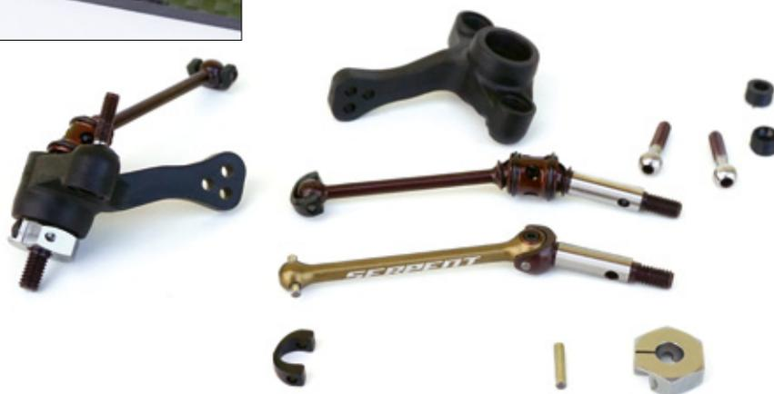
Der Project 4x ist mit Pivot-Ball-Radträgern bestückt. Die Vorderachse ist serienmäßig mit Doppel-Gelenkwellen aus Stahl bestückt. Hinten arbeiten klassische Kardans in Stahl-Alu-Kombination
