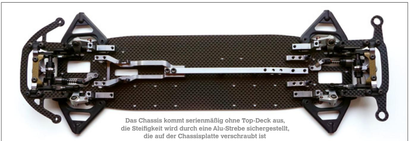
Das Chassis kommt serienmäßig ohne Top-Deck aus, die Steifigkeit wird durch eine Alu-Strebe sichergestellt, die auf der Chassisplatte verschraubt ist
