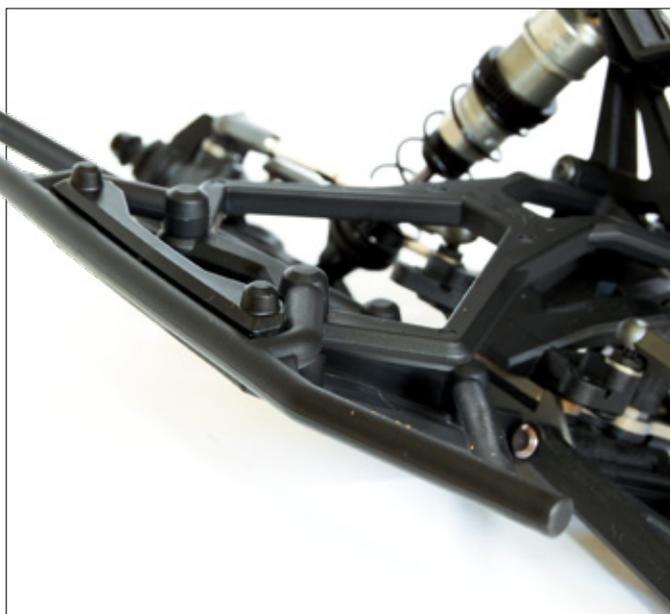
Da es bei Short-Course-Rennen gerne ordentlich zur Sache geht, können Rammer an Front und Heck sicher nicht schaden. Im Gegensatz zu vielen anderen Baugruppen am Losi sind sie aus eher weichem, flexiblem Kunststoff gefertigt. Dadurch können sie Aufprallenergie abpuffern, ohne Schaden zu nehmen
