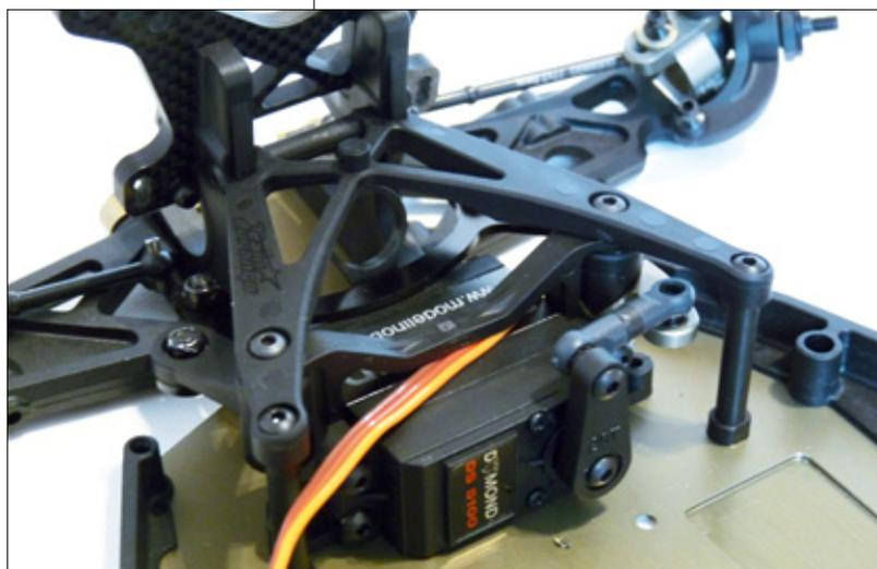
Die ungewöhnliche Position des Lenkservos wurde ebenfalls übernommen, diese ermöglicht sehr viel Platz für den Motor und den Regler. Der Breitenzuwachs ist ebenfalls nicht zu verachten, denn das erste Modell schloss nach der Lenkungsabstützung bereits mit der Karosserie ab
