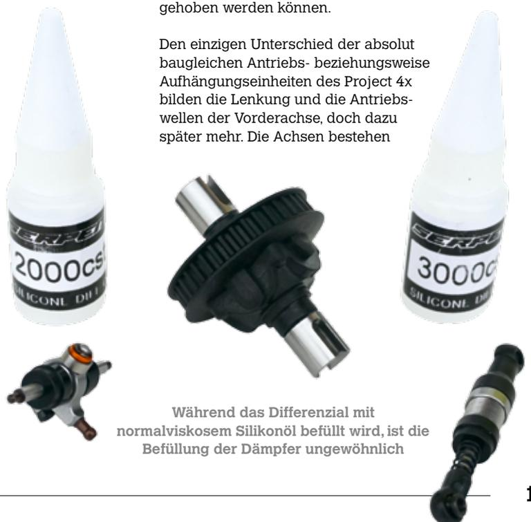
Während das Differential mit normalviskosem Silikonöl befüllt wird, ist die Befüllung der Dämpfer ungewöhnlich
