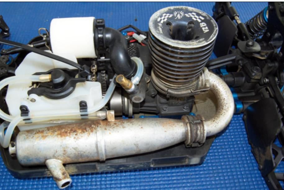
Statt E-Motor und Regler heißt das dynamische Duo bei den Verbrennern Nitro-Triebwerk und Resonanzrohr. Den Nitro-Motoren macht vor allem Reibung zu schaffen
