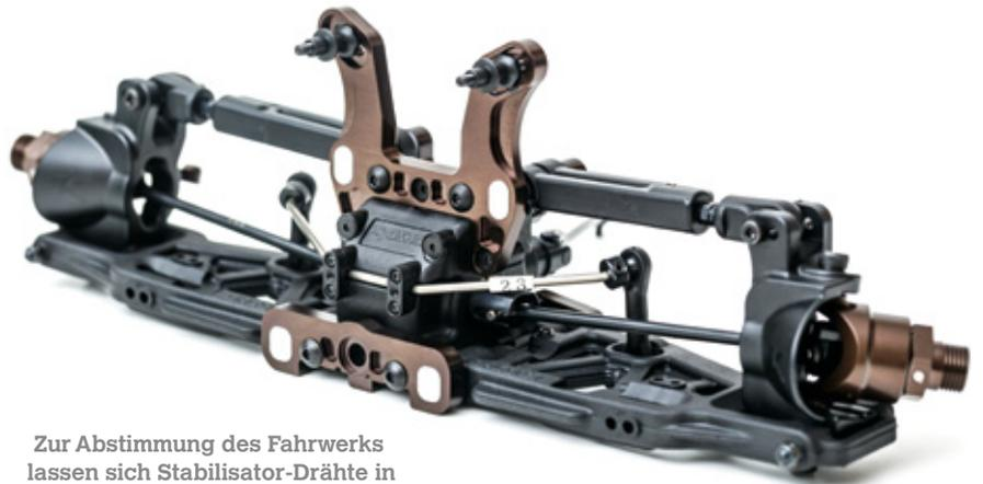
Zur Abstimmung des Fahrwerks lassen sich Stabilisator-Drähte in unterschiedlichen Stärken verwenden
