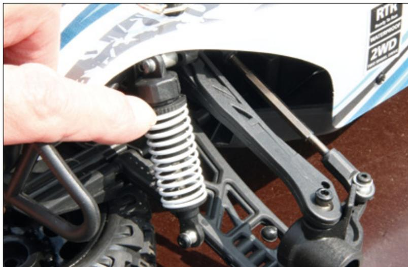
Der Dämpfer ist zwar aus Kunststoff, aber mit einer Rändelmutter verstellbar
