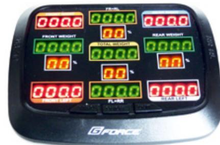
Neben der (nach dem Einschalten) immer aktiven Anzeige kann eine Kalibrierung durchgeführt werden, zudem ist eine Umstellung von zölligen auf metrische Maße einstellbar
