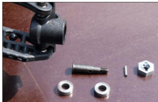
Wie alle drehenden Teile des Cage-R-Antriebs ist auch die Radachse vorne kugelgelagert
