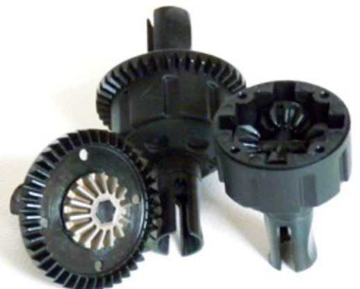
Bei den Differenzialen gibt es keine Überraschungen, denn deren Design blieb unverändert. Die Dichtigkeit und die Stabilität der Konstruktion sind auf einem sehr hohen Niveau und sorgen für einen ordentlichen Leistungsdurchsatz des 4WD-Buggys
