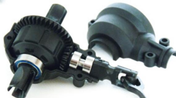
Die zur Spieljustierung benötigten Unterlegscheiben liegen in knapp ausreichender Anzahl bei. Einmal justiert, benötigt das Getriebe des DEX410 V5 so gut wie keine Wartung. Aufgrund der Gestaltung des Getriebegehäuses kann etwaig austretendes Öl aus dem Differential nicht über das Chassis laufen
