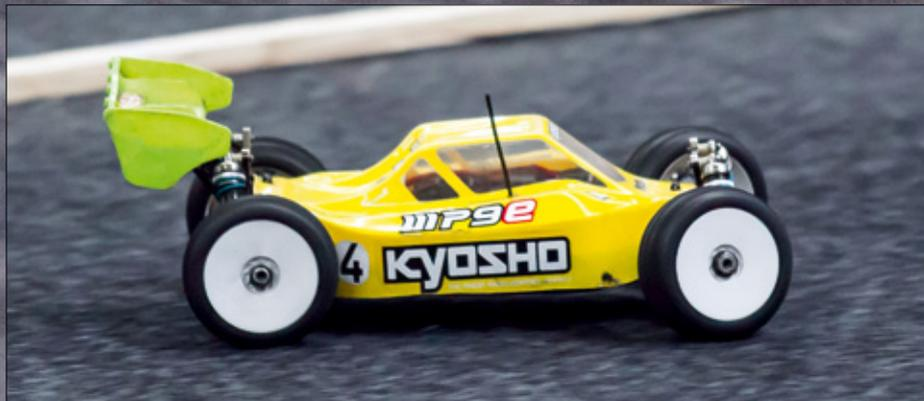
Antriebswellen identisch sind. Doch das war noch nicht alles. Die Anlenkung mit dem einstellbaren Servo-Saver und den neuen Aluminium-Lenkhebeln ergeben eine neue Geometrie, die anhand der Ackermannplatte in drei Positionen variabel ist. Zusätzlich ergeben sich mit den bekannten Kunststoffbuchsen in den unteren und oberen Aufhängungsträgern weitere Einstellmöglichkeiten.
