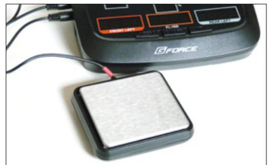
Die Kabel der Pads verfügen über farblich codierte Ringe, um den Anschluss an der passend gekennzeichneten Seite der Anzeige zu ermöglichen
