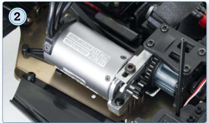
2 Mit einer spezifischen Drehzahl von 2.100 kv wartet der Neon 8-Motor im Inferno auf
