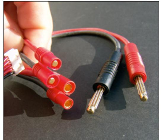
Adäquat dimensionierte Steckverbindungen sind bei LiPos wichtig, damit die hohen, abrufbaren Ströme überhaupt fließen können
