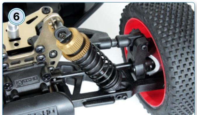
6 Die Federvorspannung der Big-Bore-Dämpfer lässt sich stufenlos über Rändelschrauben einstellen
