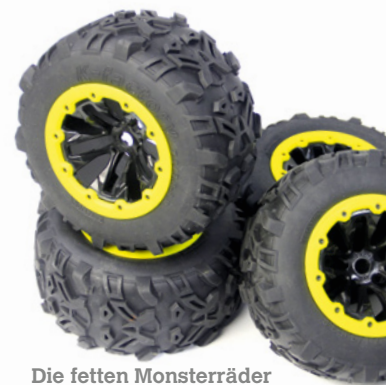
Die fetten Monsterräder haben einen Durchmesser von knapp 180 Millimeter. Die Reifen sind schön weich, mit einer Einlage versehen und auf Beadlock-Felgen verschraubt
