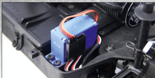
Ein Savox SW0231-Lenkservo mit einer Stellkraft von 15 Kilogramm sorgt zusammen mit dem einstellbaren Servosaver für eine präzise und kraftvolle Lenkung
