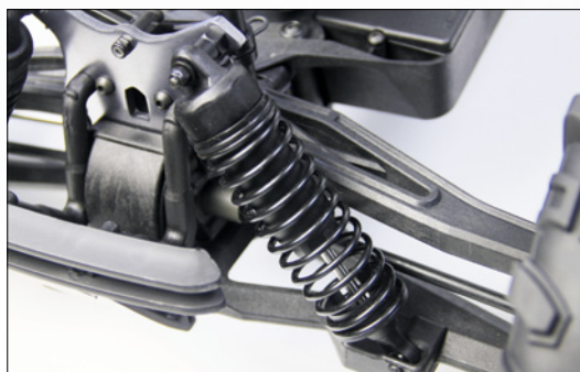
Die Big-Bore-Stoßdämpfer sind komplett aus Kunststoff gefertigt und nicht einstellbar. Mit den mitgelieferten Clips kann die Federvorspannung geändert werden
