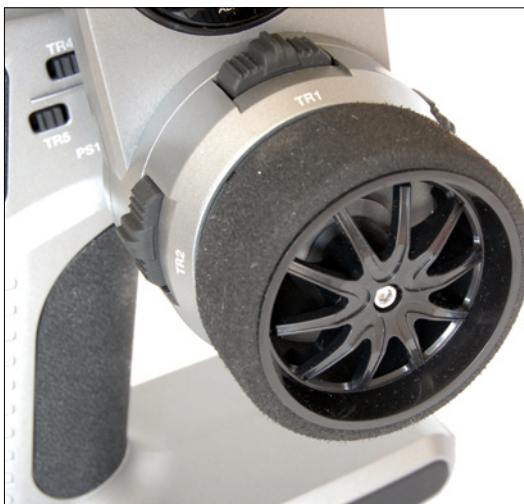
Drei Trimmknöpfe sitzen rund um das Lenkrad mit griffigem Moosgummi-Ring platziert
