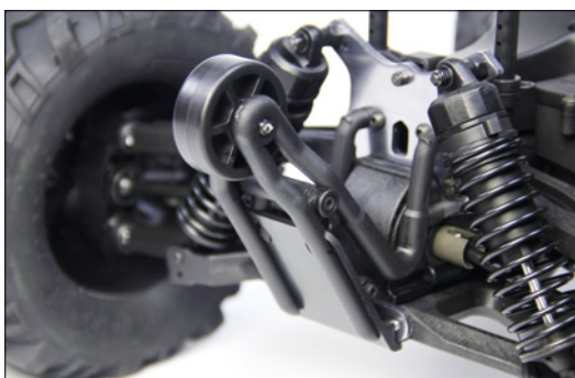
Eine ab Werk angebrachte Wheeliebar ergibt bei so einem leistungsstarken Monstertruck durchaus Sinn
