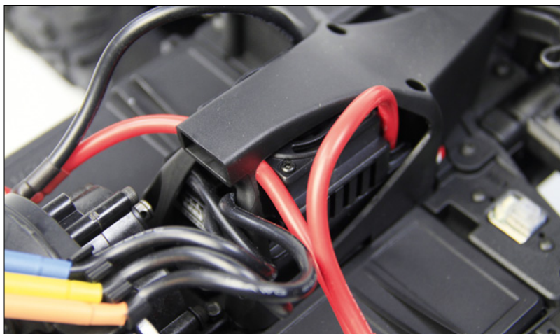
Der wasserfeste Brushlessregler verträgt bis zu 150 Ampere und kann mit bis zu 6s-Lipo-Akkus betrieben werden. Für die optimale Kühlung sorgt der aktive Lüfter, der auf dem Regler montiert ist
