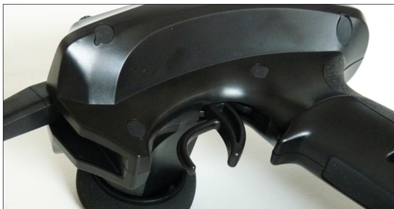
Als reiner Rechtshändersender befinden sich keine weiteren Schalter oder Anschlüsse auf der linken Seite des Senders – leider auch kein Ladeanschluss zum Aufladen des Senderakkus
