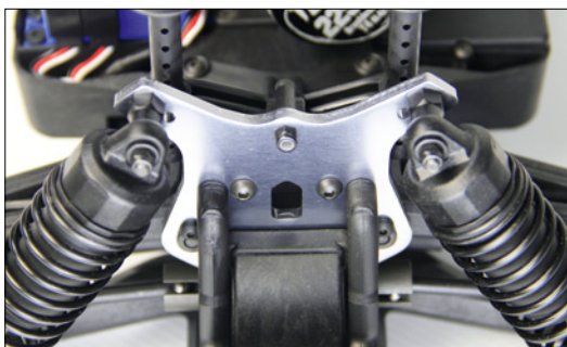
Die 4 Millimeter starken Dämpferbrücken sind aus Aluminium gefertigt und haben sowohl vorne als auch hinten zwei Befestigungspunkte für die Stoßdämpfer
