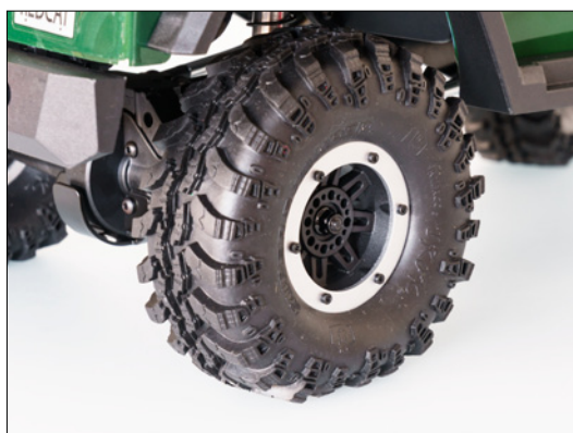
Auf den Beadlock-Felgen sitzen lizenzierte Intercro Super Swamper-Reifen
