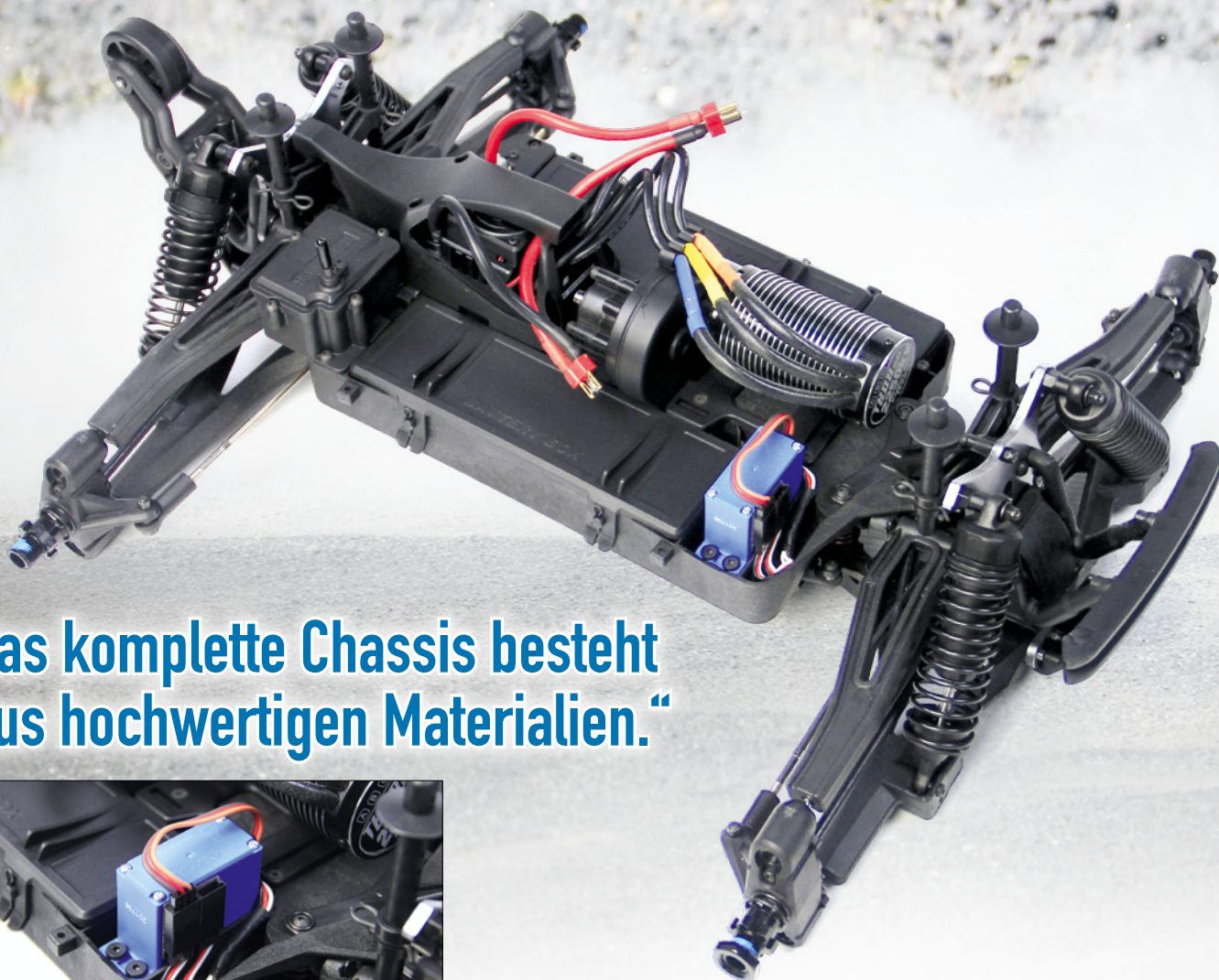
Ein Savox SW0231-Lenkservo mit einer Stellkraft von 15 Kilogramm sorgt zusammen mit dem einstellbaren Servosaver für eine präzise und kraftvolle Lenkung
