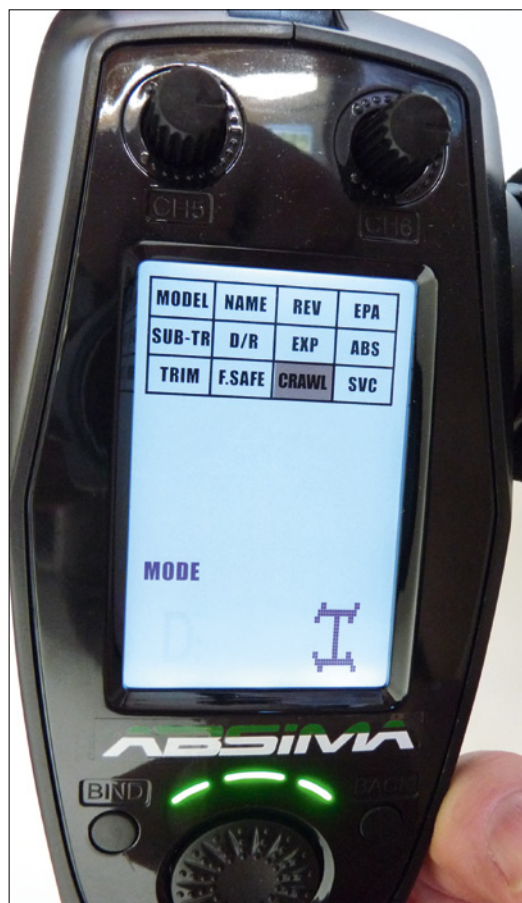
Neben der einstell- und auch abschaltbaren Gyrostabilisierung der beiden ersten Kanäle kann man vor allem sehr schnell auf vier verschiedene Servomodi bei der Lenkung eines Crawlers zugreifen. Letzterer wird zudem sehr anschaulich dargestellt, um einer Fehlbedienung vorzubeugen
