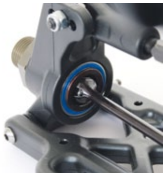
Die Kugellager der Achswellen sind nicht noch, wie so oft, zusätzlich mit Hartgummi ausgebuchst
