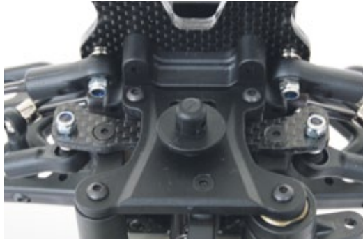
Die Lenkungsbrücke besteht ebenfalls aus CFK
