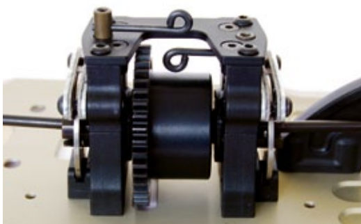
Mit diesen zwei mittigen Hebeln kann man die Vorder- und die Hinterachse unterschiedlich stark bremsen
