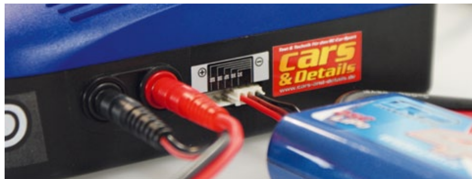
Der Quadra Pro 3 Charger ist in der Lage, bis zu 6s-LiXX-Zellen auszugleichen. Der Balancer-Anschluss ist auf der rechten Gehäusesseite neben den Ladebuchsen platziert. Eine Auswahl an Ladekabeln gehört nicht zum Lieferumfang des Mittelklasse-Ladegeräts
