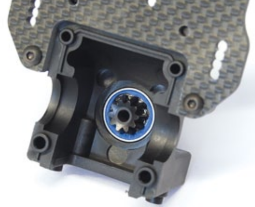
Das Kegelrad und dessen Lagerung erfuhren einer Überarbeitung. Nun steck das Zahnrad in zwei Kugellagern
