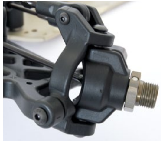
Die Lagerungen der C-Hubs sind ausgebuchst
