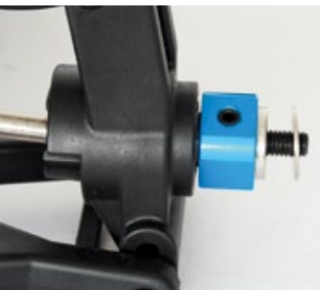
Ein extra Beiblatt verlangt, unter der Radaufnahme diese dicke Beilagscheibe zu verbauen, schweigt sich aber über das Warum aus. Ohne geht's nämlich auch
