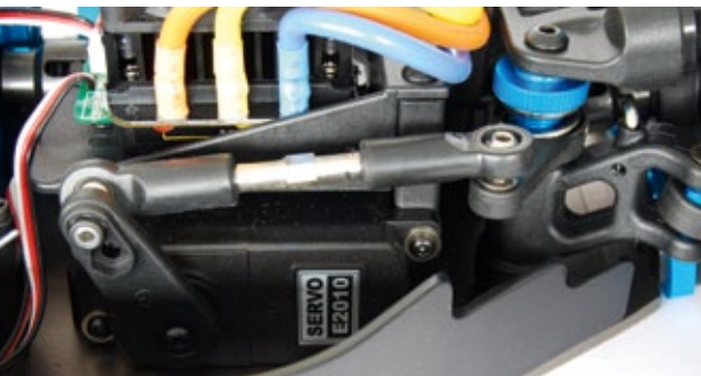
Nicht das schnellste, aber dafür kräftig: das Lenkservo
