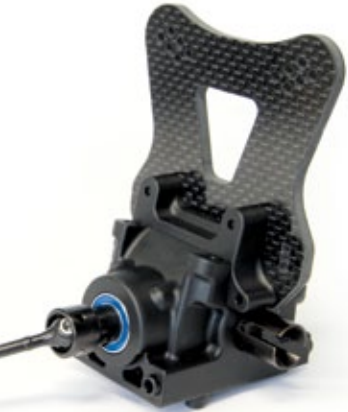
Am hinteren Differenzialgehäuse thront eine mächtige Dämpferbrücke aus feinstem Kohlefaserverbund
