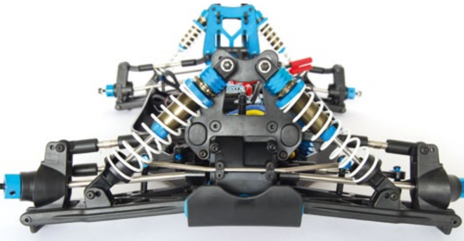
Die Dämpferbrücken bestehen aus blau eloxiertem Alu, sind von einer Seite jedoch mit schwarzem Kunststoff aufgedoppelt
