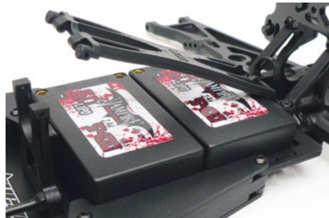
Der Akkuwechsel gestaltet sich eigentlich recht einfach, denn neben dem Stift vor den Akkus muss nur das mittlere Differenzial herausgenommen werden – dies geht dank Schnellwechselklammer aber sehr zügig
