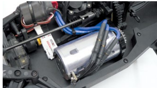
Die Montage eines 550er-Motors mit einer 5-Millimeter-Welle und Modul 1-Ritzeln stellt kein Problem dar und ermöglicht dem eher schweren Modell das gewisse Extra an Leistung
