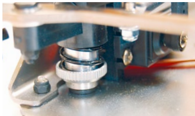
Der einstellbare Servosaver schützt das Lenkservo vor zu starken Schlägen, ist aber leider nicht so gut zugänglich, wie man es sich wünschen würde
