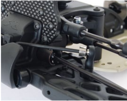
Die Stabis verhindern wirkungsvoll eine Seitenneigung und sorgen so für sichere Kurvenfahrten
