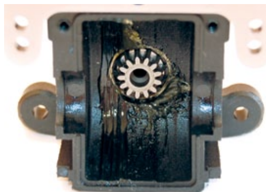
Auch in den Getriebekästen befindet sich ausreichend Fett – so soll es sein
