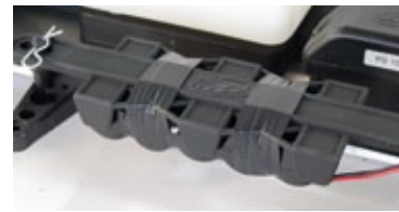
Der Empfängerakku hat eine Kapazität von 2.000 Milliamperestunden bei 6 Volt. Durch Entfernen von zwei Klipsen kann der Akku samt Halter zum Laden abgenommen werden
