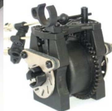
Stand der Technik: das Mitteldiff glänzt mit einem Stahlhauptzahnrad und geschlitzten Scheibenbremsen. Fehlt nur noch ein etwas kernigeres Bremservo
