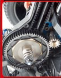
Getrennter Slipper für Vorder- u. Hinterachse
