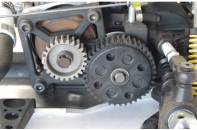
Das 24-Zähne-Motorritzel greift in ein 40-Zähne-Hauptzahnrad, hinter dem sich die Bremse für die Hinterachse befindet
