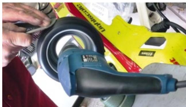
Bei der DM wird mit allen Tricks gearbeitet: Statt die Reifen anzufahren, werden sie per Bohrmaschine und Schmierkelpapier gleichmäßig angeraut
