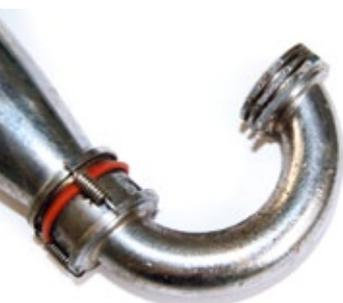
Die Länge des Krümmers nimmt entscheidenden Einfluss auf die Motor-Charakteristik
