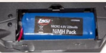
**Der Zugriff auf das Akkupack erfolgt schnell und einfach über eine Klappe im Unterboden**
