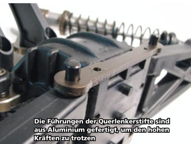
**Die Führungen der Querlenkerstifte sind aus Aluminium gefertigt, um den hohen Kräften zu trotzen**
