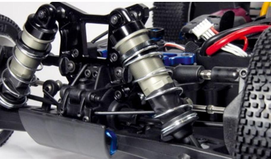
Die großen Big-Bore-Stoßdämpfer lassen sich mittels Rändelschrauben schnell und einfach einstellen. Die titan-nitrierten Dämpferstangen sind durch Gummimanschetten geschützt. Mit dem optional erhältlichen Federnset lässt sich der RC8.2e auf jede Strecke abstimmen
