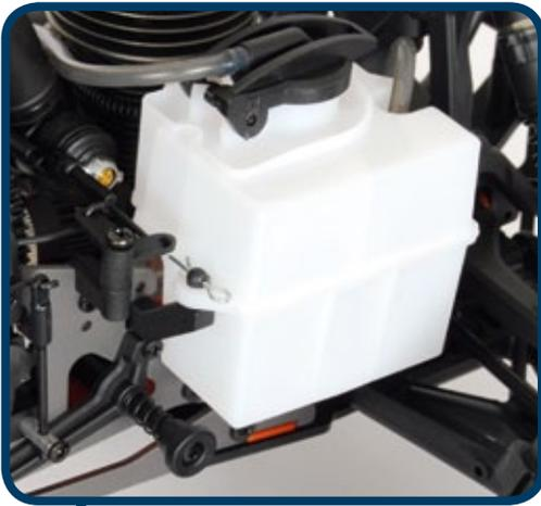
Mit dem kleinen Knopf unter dem Tank lässt sich der Motor abstellen. Das Kunststoffteil drückt bei Betätigung direkt auf die Schwungscheibe
