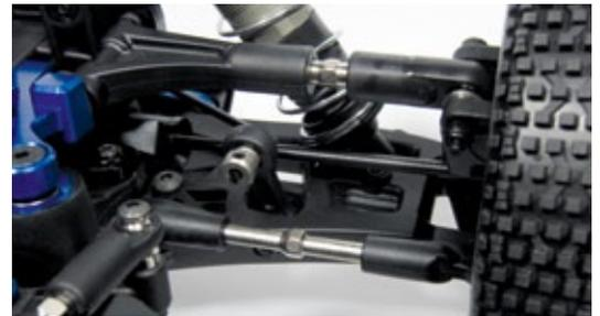
Dicke Rechts-links-Gewindestangen lassen die Einstellung von Spur und Sturz zu
