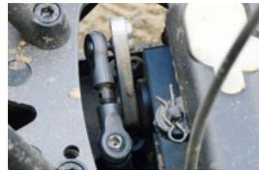
**Zum Lieferumfang gehört auch ein XXL-Lenkservo. Es ist mit 25 Kilogramm Stellkraft bestens für die Belastungen im Baja dimensioniert**
