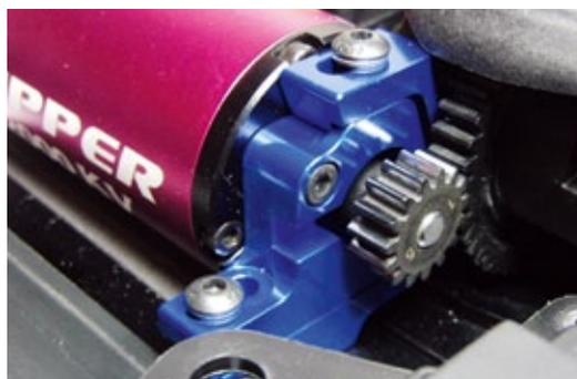
sind. Ganz hinten gibt es dann noch den Illusion-Heckflügel mit neuem Halter zu begutachten. Der Leckerbissen schlechthin ist allerdings der Motorhalter. Aus massivem Aluminium gefertigt, lässt sich jetzt der erste Teil des Halters bereits außerhalb des Fahrzeugs am Triebwerk montieren. Er gleitet dann in die Führung des bereits im Fahrzeug befindlichen zweiten Teils und wird festgeschraubt.
