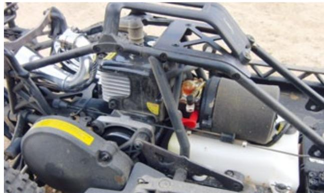
**Wie schon im RTR-Modell sorgt auch bei der Kit-Version des Baja 5SC ein 26er-Fuelie-Motor für Vortrieb**
