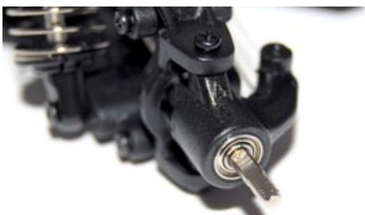
Präzision bis ins Detail: Die Räder des Offroaders drehen sich um Kugellager
