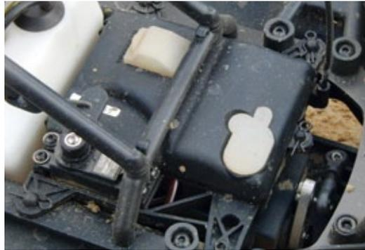
**In die wasserdichte Empfängerbox sind kleine Zugangsöffnungen für den Empfänger und das Laden des Empfängerakkus eingebracht. Sie sind mit kleinen Silikonabdeckungen wieder dicht verschließbar**
