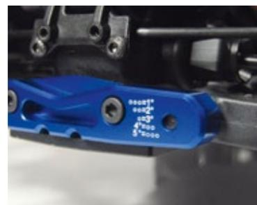
**Im Querlenkerstifthalter an der Hinterachse befinden sich kleine Kunststoffeinsätze, mit denen die Vorspur verändert werden kann. Am Halter ist aufgezeigt, welche Position wie viel Vorspur einstellt**
