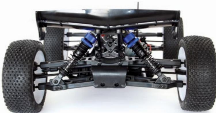
Beide Achsen basieren auf soliden Doppelquerlenkern. Sowohl die unteren als auch die oberen sind in Schwingenform ausgeführt
