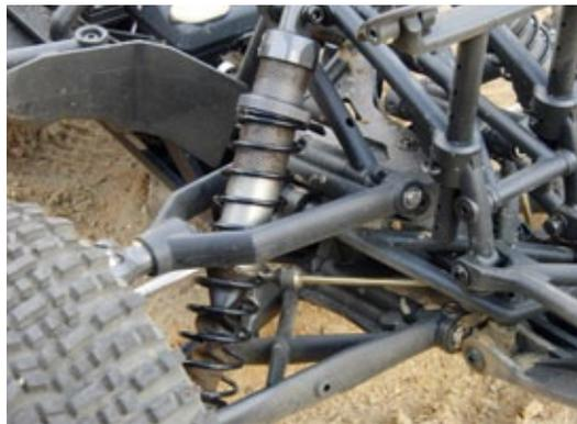
**Die Aluminum-Stoßdämpfer mit 6-Millimeter-Kolbenstangen sind kaum kaputtzukriegen**
