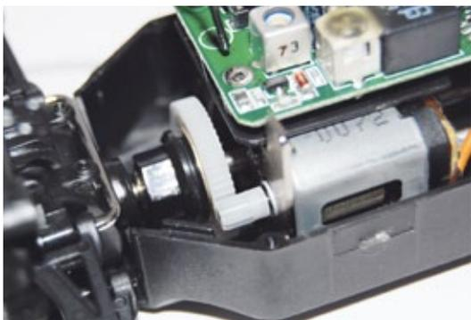
Der Bürstenmotor überträgt seine Drehzahlen auf das Hauptzahnrad im zentralen Antriebsstrang. Eine einstellbare Slipper-Kupplung schützt die filigrane Konstruktion vor Belastungsspitzen
