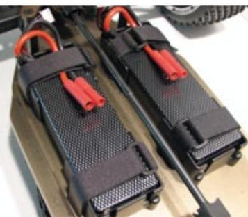
Klettbänder an den Akkualterungen sorgen für sicheren Halt und bieten ausreichend Möglichkeiten für größere Akkus
