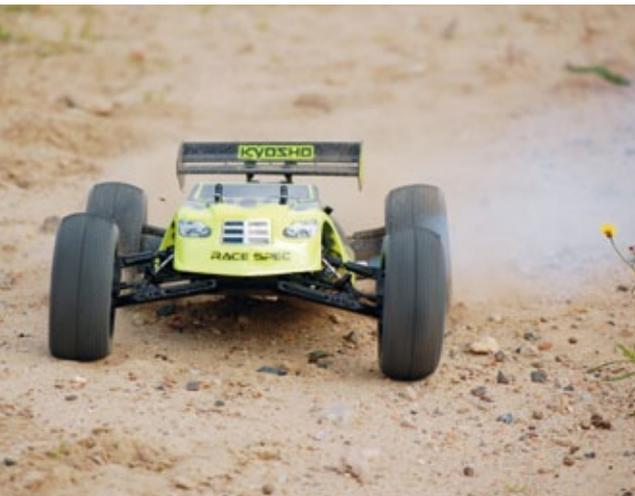
Eine deutlich sichtbare Abgasfahne ist immer ein guter Indikator für eine ausreichend fettes Gemisch
