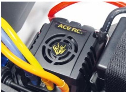
Ein Regler von Thunder Tigers Hausmarke ACE R/C versorgt den Brushlessmotor mit Strom. Er ist mit 150 Ampere belastbar. Über die beiliegende Programmierbox lassen sich wichtige Parameter einstellen
