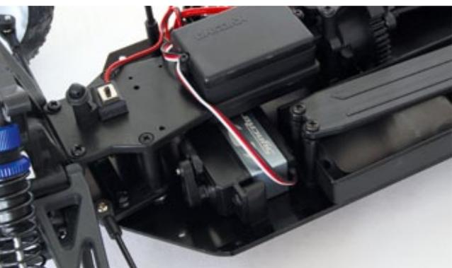
Vorne links ist das Lenkservo platziert. Dieses ist liegend verbaut und gibt die Lenkbefehle über eine Mechanik inklusive Servosaver weiter
