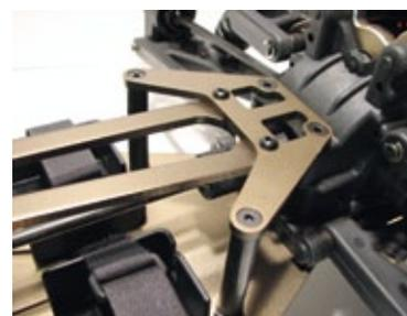
**Eine gute Kombination aus faserverstärktem Kunststoff und Aluminiumverstärkungen sorgt für Stabilität**
