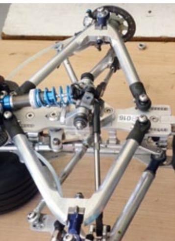
HARM-Racing baute die Doppeldämpfer-Vorderachse zur DM an allen F1-Autos auf eine Monodämpferachse um
