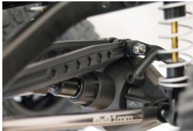
**An der Hinterachse sorgen die alternativen Vierlenker für weniger Eigensteuerung**
