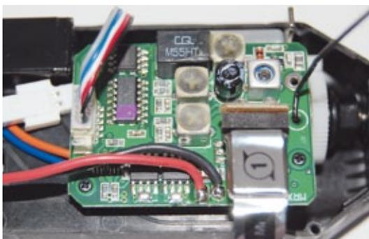
Als zentrale Steuerung dient die Einheit aus Empfänger und Fahrregler
