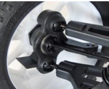
Pivotball-Aufhängungen ermöglichen eine einfache Justierung des Fahrwerkssetups
