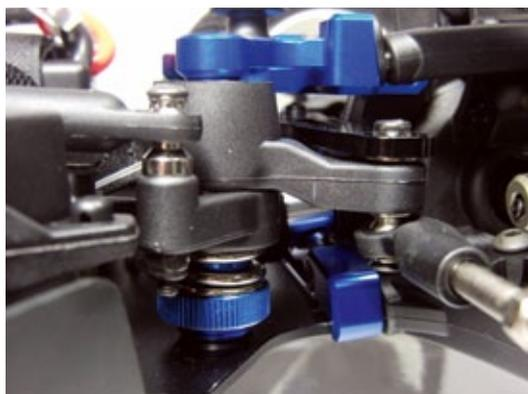
Der Servosaver ist sehr stabil ausgeführt und lässt sich ebenfalls stufenlos per Rändelmutter einstellen
