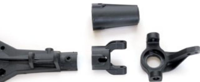
**Die Achsgehäuse sind vorne und hinten identisch und unterscheiden sich nur durch die Aufnahmen**
