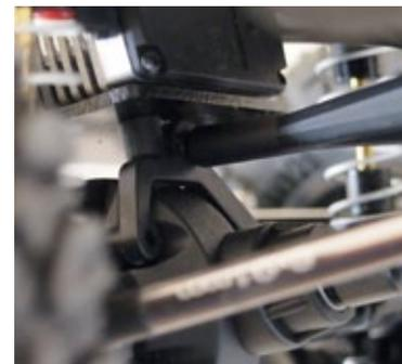
**Die Aufnahme des Dreieckslenkers an der Vorderachse wird durch die Aluminium Servoplatte zusätzlich gehalten**
