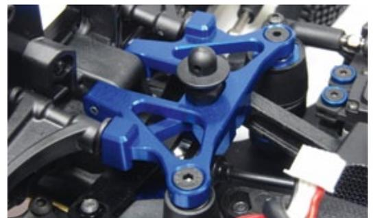
Die vordere Top-Plate aus Kunststoff gehört nun auch der Vergangenheit an. Ein gefrästes Aluminiumteil stellt hier die Verbindung zwischen Lenkung und Vorderachse dar
