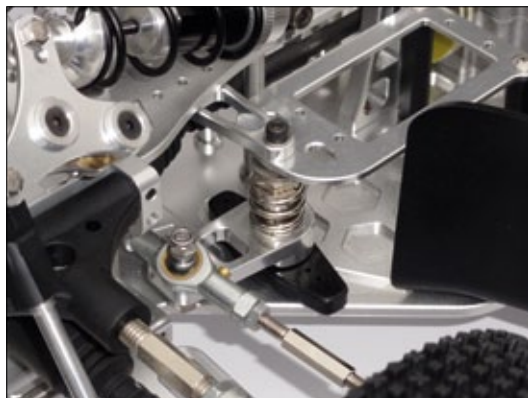
Einer der beiden Servosaver: so können selbst Unstimmigkeiten zwischen den Servos kompensiert werden
