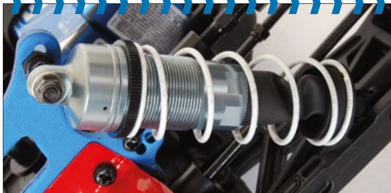
Die Big-Bore-Öldruckstoßdämpfer können sich sehen lassen. Sie verfügen über Rändelschrauben zur Einstellung der Federvorspannung und haben Schutzfüllen an den Kolbenstangen
