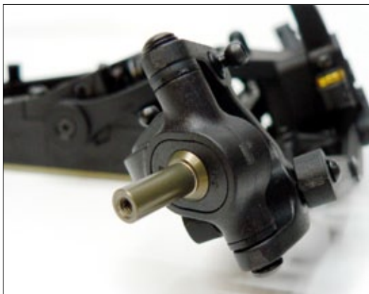
Der Nachlaufwinkel und die Drehachse des Lenkhebels lassen sich an der Vorderachse durch ovale Einsätze und passende Hülsen in diversen Stufen variieren
