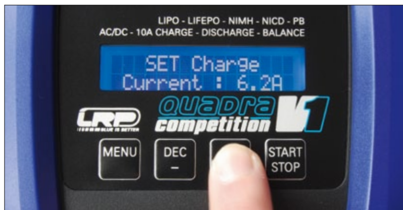
Menüführung und Auswahl der Parameter erfolgen beim V1 über vier Buttons
