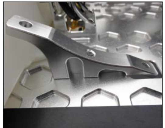
Die Motorabstützung ist in die Chassisplatte eingelassen. Die Befestigung erfolgt von unten
