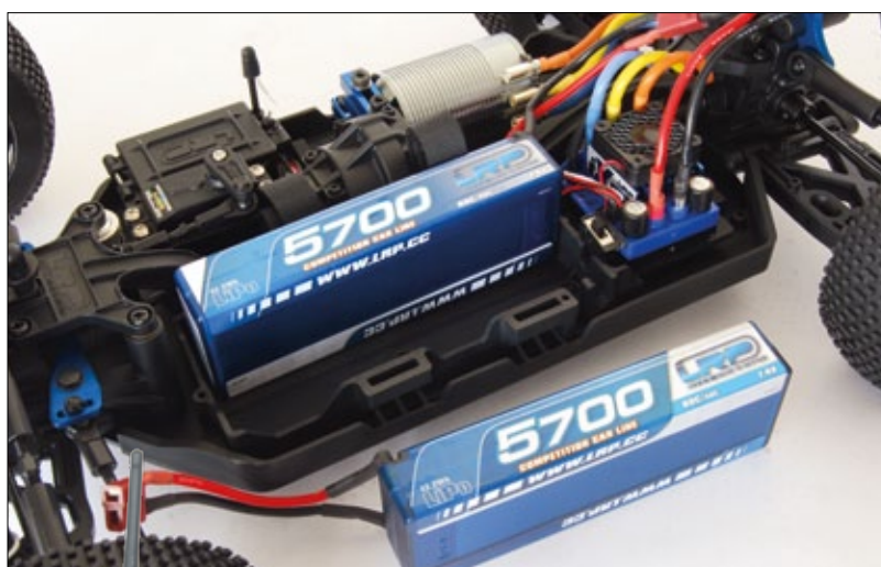
Im Testmodell kamen zwei 2s2p-LiPos mit jeweils 5.700 Milliamperestunden Kapazität zum Einsatz. Die Fahrzeit liegt bei rund 10 Minuten
