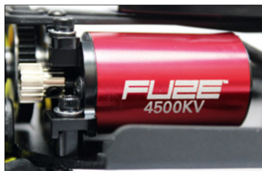
In beiden 1:14er-Modellen schlägt das gleiche Herz: Ein 4.500-kv-Innenläufer von Dynamite
