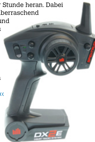
Die Spektrum DX2E gehört zum Lieferumfang. Wie stark das AVC-System eingreifen soll, wird über den Drehgeber unterhalb der Antenne geregelt
