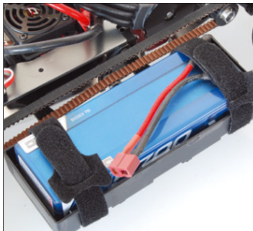
Der Quicrun-Motor hat eine spezifische Drehzahl von 2.000 kv und wird an zwei 2s-LiPos betrieben
