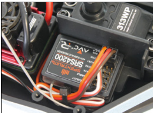
In der wasserdichten RC-Box befindet sich der Spektrum AVC-Empfänger des Typs SRS4200
