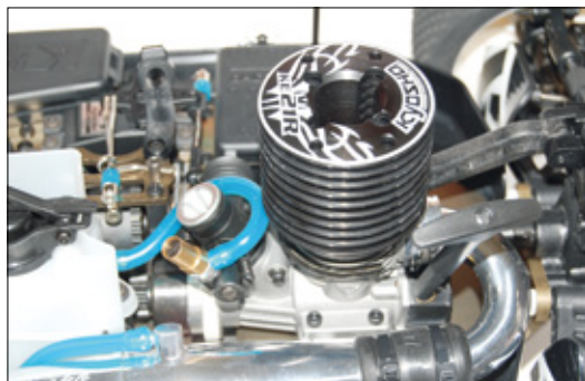
Als Triebwerk dient ein durchaus potenter KE21R mit dem Buggy-typischen Hubraum von 3,5 Kubikzentimeter. Um dem Motor auch das letzte Quäntchen Leistung zu entlocken, hat man ihm ein hartverchromtes Reso zur Seite gestellt
