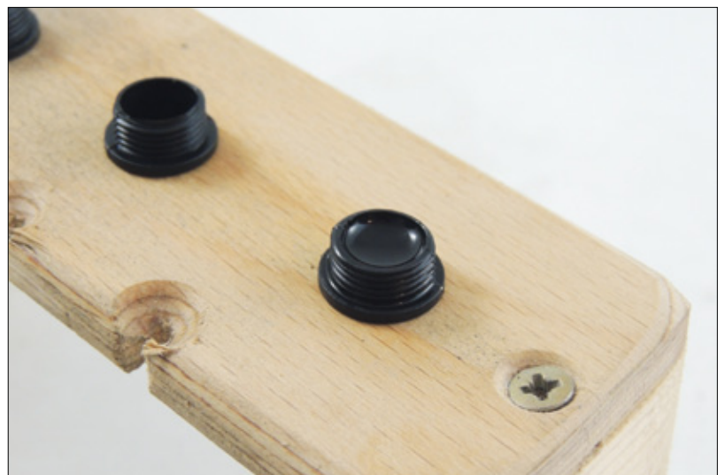
Bei einem korrekt befüllten Dämpfer wölbt sich das Öl noch leicht nach unten
