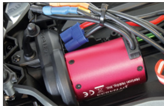
Der Fuze-Brushlessmotor mit einer spezifischen Drehzahl von 3.300 kv ist betriebsfertig im Modell verbaut
