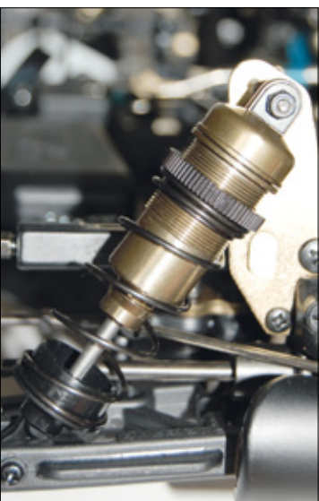
Vier großvolumige Big-Bore-Dämpfer kommen mit allen äußeren Gegebenheiten zurecht
