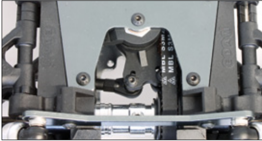
Die spielfreie, auf einem Alupfosten montierte Lenkung, wartet mit einem Servosaver auf
