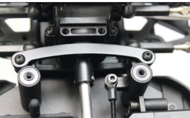
Die Lenkstrukturen beider Modelle sind im Wesentlichen gleich, jedoch verfügt der Buggy über eine Aluminium-Ackermannstrebe. Der Truggy hat hier ein Kunststoffteil
