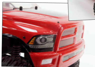
Vorne findet man ebenfalls Schrauben, welche die Frontschürze halten
