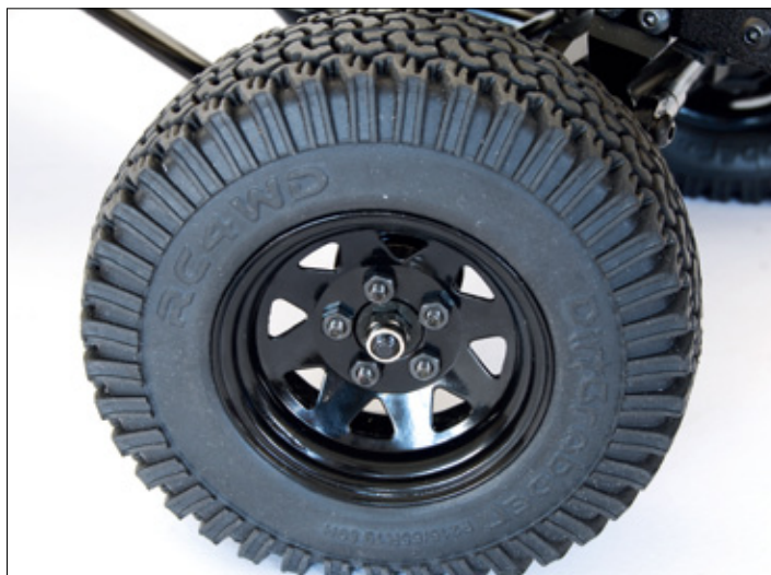
Die zeitgenössischen Stahlfelgen klemmen die weichen Dirt Grabber-Reifen fest ein
