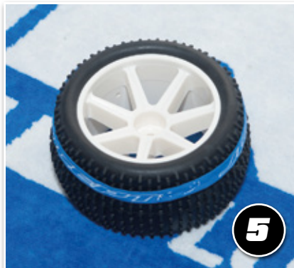
5. Als Hilfestellung kann nun, bis der Kleber abgetrocknet ist, ein Reifen-Klebe-Gummi wie z.B. JConcepts Reifen-Gummibänder (#J2005) verwendet werden. Wer es eilig hat, kann auch ein Aktivatorspray wie ZIP Aktivator Turbo 3 (#65281) benutzen.
