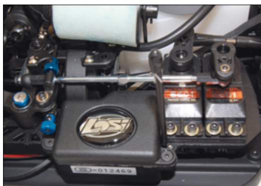
Zwei S601-Servos aus dem Hause Spektrum bedienen Gas, Bremse und Lenkung
