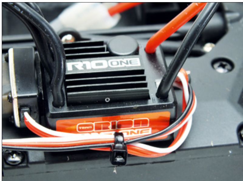
Der R10-Brushless-Regler ist wasserdicht ausgeführt. Ein-aus-Schalter und Setup-Knopf sind in einem kleinen separaten Gehäuse untergebracht
