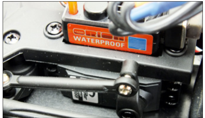
Das wasserdichte Lenkservo ist liegend in der Chassis-Wanne montiert, um den Schwerpunkt niedrig zu halten. Der wasserdichte Team Orion-Regler wurde Huckepack platziert
