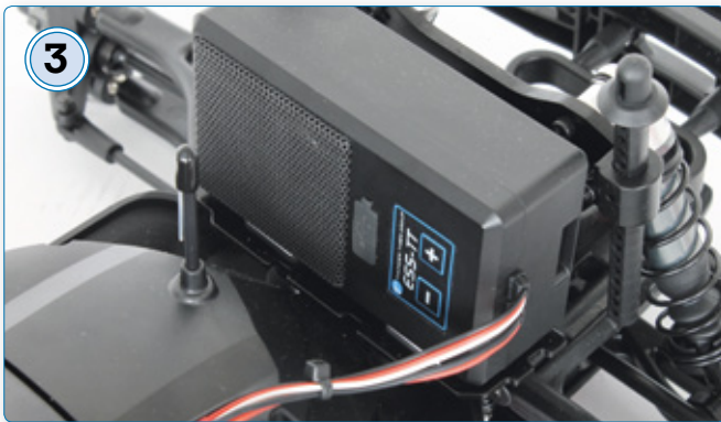
Das ESS-TT-Soundmodul ist serienmäßig beim Kaiser dabei und imitiert einen blubbernden V8-Sound
