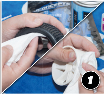
1. Reifen und Felge an der Klebekante vom Trennmittel befreien - z.B. mit LRP X-tra Cleaner 2 Reinigungsspray.
