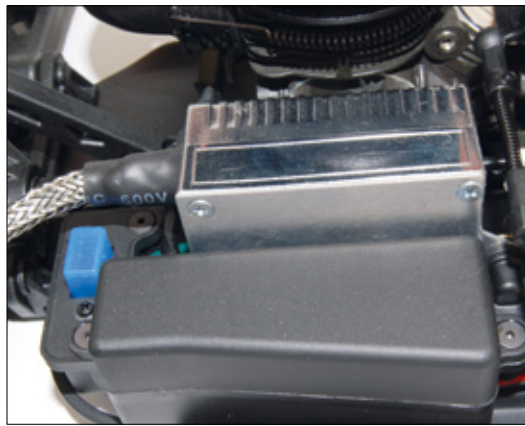
Die sogenannte CDI erzeugt über den Geber am Schwungrad den Zündimpuls und leitet diesen an die Kerze weiter
