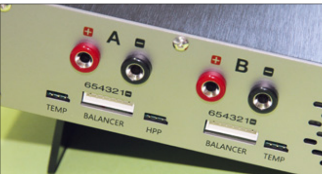
Auf der linken Gehäusesseite befindet sich auch der HPP-Anschluss für Software-Updates
