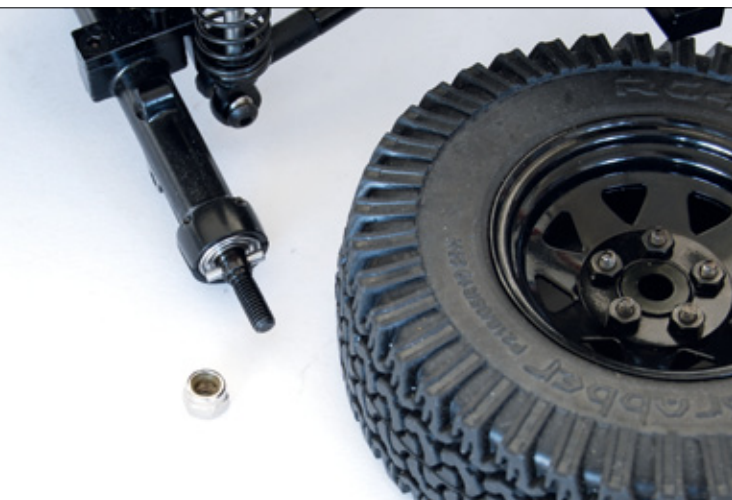
Die Antriebswellen in den kugelgelagerten Starrachsen übertragen ihre Kraft über einfache Querspinn an die Mitnehmer der Felgen
