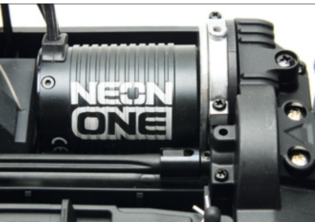
Der wasserdichte Team Orion Neon One-Brushlessmotor sitzt auf einem Exzenter, um das Zahnflankenspiel einstellen zu können
