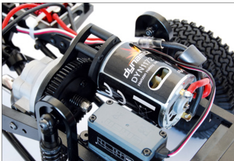
Eine zentrale Einheit verteilt die Motorkraft zu beiden Achsen
