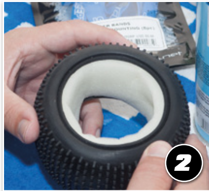
2. Schaumstoffeinlage in den Reifen einlegen.
