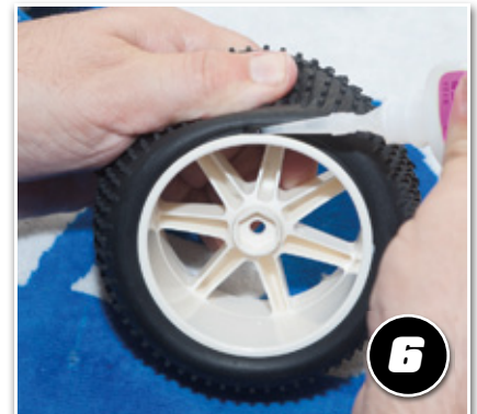
6. Erst wenn der Kleber komplett trocken ist, den Reifen umdrehen und die andere Seite verkleben.
