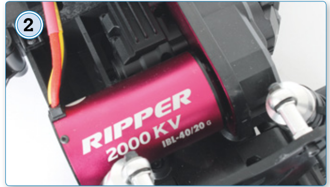
Der Ripper-Brushlessmotor mit 2.000 kv sorgt für reichlich Vortrieb. Er kann mit 4s- oder 6s-LiPos betrieben werden
