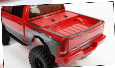
Die Ladefläche ist tiefgezogen und demontierbar
