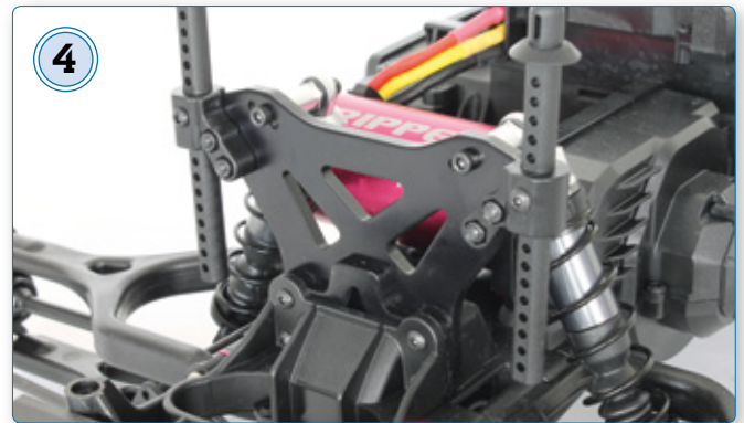
Anders als beim ersten e-MTA verfügt der Kaiser über stehend montierte Öldruckstoßdämpfer an Alu-Dämpferbrücken
