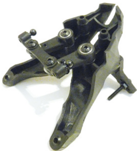
Sowohl von der Materialwahl als auch von der Gestaltung der Teile ist der VBC Racing-Buggy auf der Höhe der Zeit. Federstahl, gummidichtete Kugellager und faserverstärkter Kunststoff sowie hochwertige Stahl- und Aluteile ergeben eine sauber arbeitende und extrem belastbare Hinterachse
