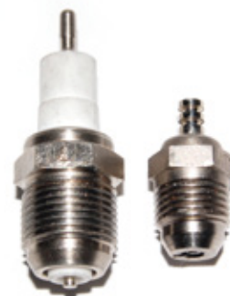
Losis Zündkerze ist deutlich größer als eine Turbo-Glühkerze und verlangt schon durch ihre Bauweise einen angepassten Zylinderkopf
