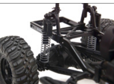
Lange Stoßdämpfer erlauben eine große Verschränkung der Achsen. Die seitlich angebrachten Reservoirs sind natürlich nur Show
