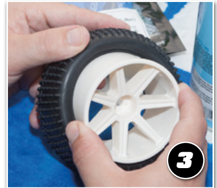
3. Reifen auf Felge aufbringen. Darauf achten, dass der Reifen rundherum 100% richtig sitzt.
