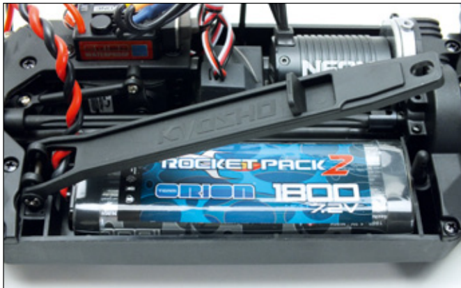
Der Fahrakku liegt gut in der Chassis-Wanne und wird über einen verstellbaren Bügel sicher gehalten
