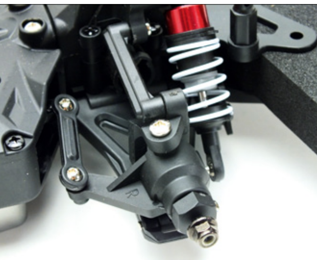
Keine Experimente: Das bewährte C-Hub-System sorgt für Haltbarkeit im leichten Gelände. Spur und Sturz sind nicht einstellbar
