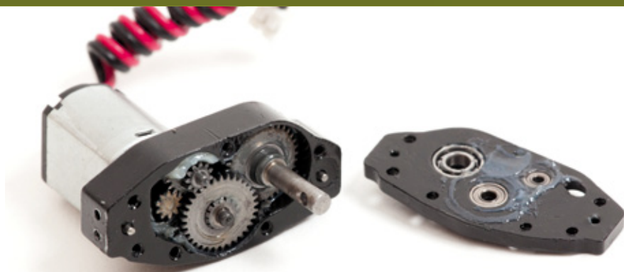
Diese Miniantriebseinheit ist ab Werk schon sehr gut gefettet und sogar kugelgelagert
