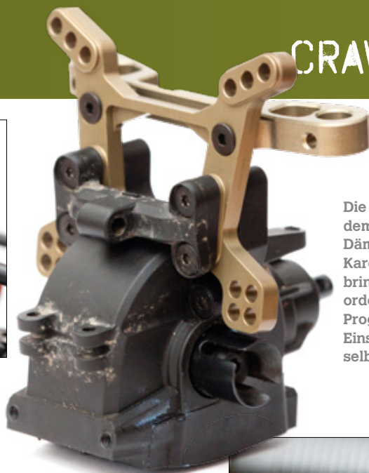
Die Dämpfer-Halterung aus Aluminium sorgt für einen stabileren Halt an der Dämpferaufnahme am Rohrrahmen des Yeti
