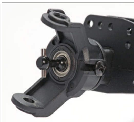
Die stabilen C-Hubs sind aus Kunststoff gefertigt
