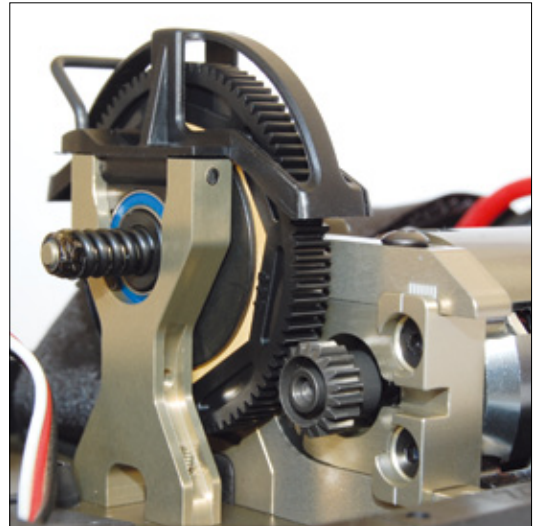
Zu den absoluten technischen Highlights des DEX210F zählt die Kombination aus Motorhalter und Träger für das Hauptzahnrad. Das Zahnflankenspiel lässt sich genauso einfach und präzise justieren wie die Spannschraube der Slipperkupplung
