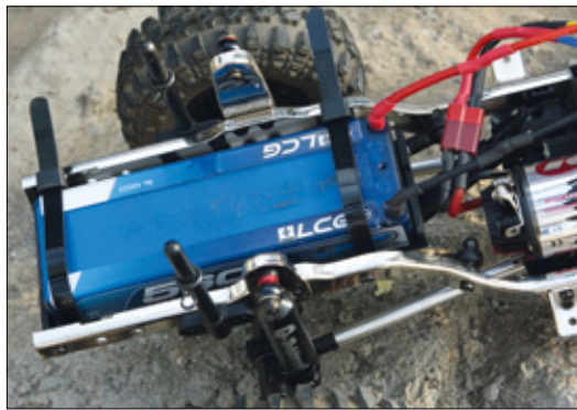
Im hinteren Teil des Chassis, zwischen den beiden Rahmenhälften, wird der Fahrakku befestigt. Die Halteschalen sind schwerpunktünstig sehr weit unten im Rahmen verschraubt
