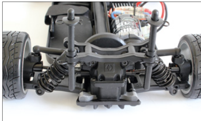
Die Achsen sind in Doppelquerlenker-Bauweise konstruiert und mit einem Kegelraddiff versehen. Am Heck (rechts) wartet der RS4 mit einem Diffusor auf. Die Federvorspannung der Dämpfer lässt sich stufenlos über Rändelschrauben einstellen
