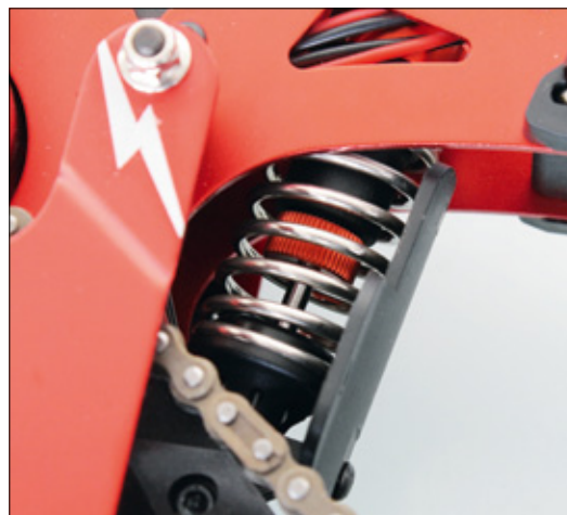
Ein Öldruckstoßdämpfer wie man ihn aus dem 1:10er-Offroad-Bereich kennt, arbeitet an der Hinterradschwinge
