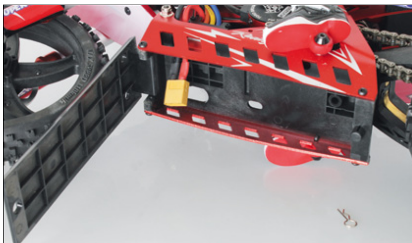
Über die große Klappe auf der Unterseite des Modells wird der sechszellige Nickel-Akku eingelegt
