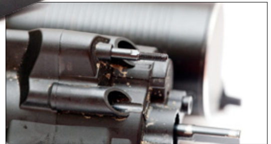
Mittels einer Gewindestange wird zwischen erstem und zweitem Gang geschaltet. Der Schaltweg ist recht kurz und kann während der Fahrt getätigt werden
