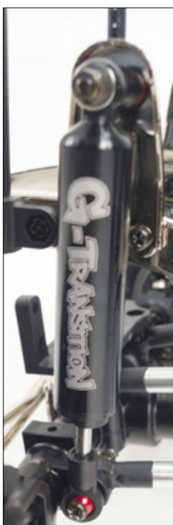
Die unteren Kugelfpannen der Stoßdämpfer sitzen auf gebohrten Aluminiumkugeln und haben wenig Spiel
