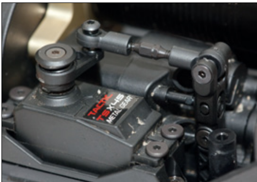
Das montierte Servo macht es jetzt möglich: Fullspeed oder langsames Crawl über Stock und Stein. Das Getriebe arbeitet sauber und zuverlässig. Hier hat sich die Wartezeit gelohnt. Auch nach mehreren Akkuladungen zeigten sich keine Defekte
