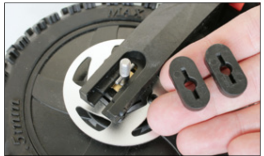
Über verschiedene Einsätze wird die Spannung der Kette eingestellt. Werkseitig war sie deutlich zu straff
