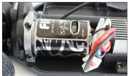
15 Turns hat der 540er-Brushlessmotor, der in der Alu-Motorhalterung platziert und bereits am wasserdichten LiPo-fähigen Controller angeschlossen ist
