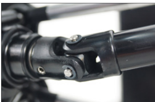
Die E-Klipse an den Kardangelenken sind nicht mehr zeitgemäß
