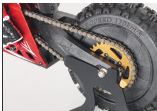
Über eine robuste Stahlkette wird das Hinterrad angetrieben. Der Modellständer gehört zum Lieferumfang
