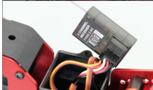
Zentral oben im Chassis sitzt die Empfängerbox
