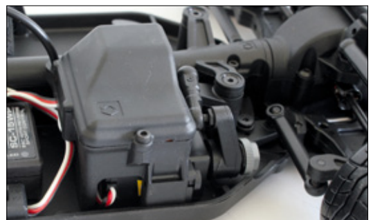
Auf der rechten Chassisseite, direkt vor der Hinterachse, ist das liegende Lenkservo verbaut, darauf befindet sich die RC-Box
