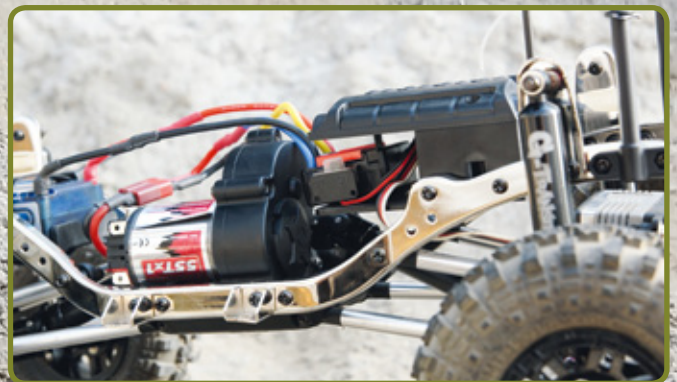
Der 55-Turns-Bürstenmotor von Robitronic hat Kraft und lässt den Komodo langsam und gut dosierbar durch das Gelände krabbeln
