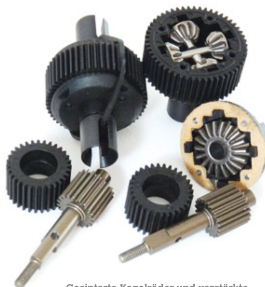
Gesinterte Kegelräder und verstärkte Kunststoffteile ergeben in Kombination mit einer guten Dichtung, gummigedichteten Kugellagern sowie weiteren hochwertigen Teilen sehr gut funktionierende Differenziale
