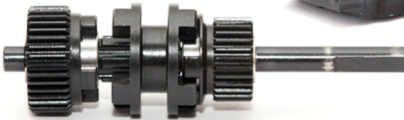
Das Herzstück der Tuningkur ist zweifellos das Zweiganggetriebe. Neben vielen Kleinteilen, gehören gehärtete Zahnräder, ein Schalthebel, ein Servosaver, eine Servohalterung und notwendige Kugellager zum Lieferumfang des Umbausets. Erforderlich ist lediglich noch ein Schaltservo
