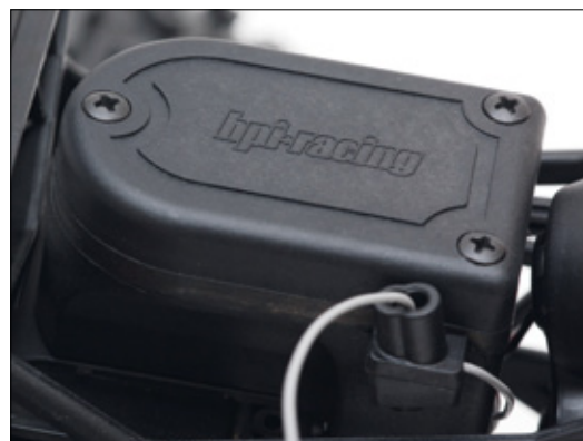
Unter dem Deckel der Elektronik-Box verbirgt sich der Empfänger. Ein Gummiring schützt ihn vor Wasser
