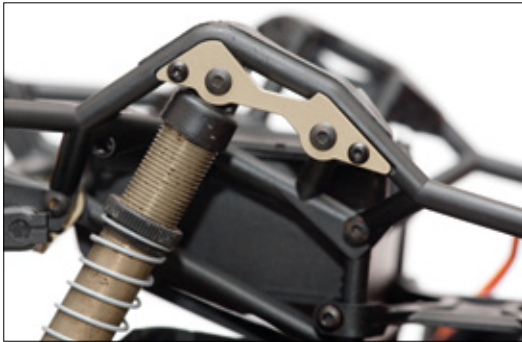
Die Dämpfer-Halterung aus Aluminium sorgt für einen stabileren Halt an der Dämpferaufnahme am Rohrrahmen des Yeti
