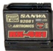
Mit zum getesteten Set gehörte auch der fast schon winzige 4-Kanal-Empfänger mit der Bezeichnung RX-481, der auf ein externes Antennenkabel verzichtet
