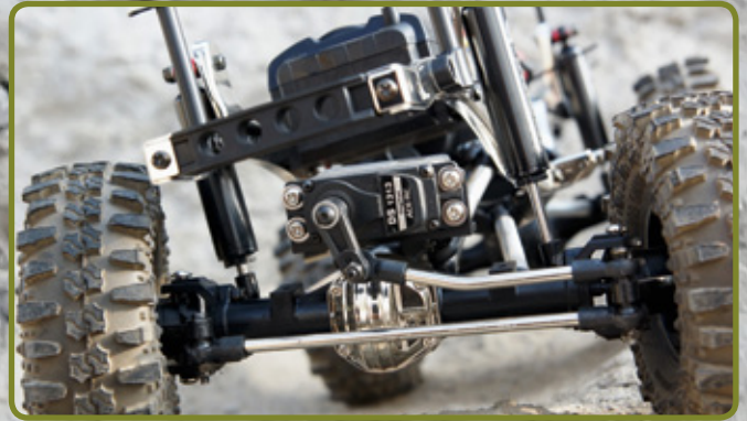
Mit 13 Kilogramm Stellkraft bewegt das ACE RC DS1313 mühelos die Räder
