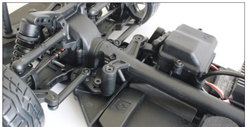
Mittig über das Chassis verläuft der Antriebstunnel, der die zentrale Antriebswelle schützt
