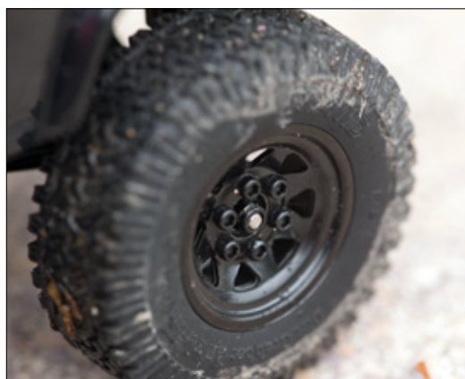
Dank der Beadlock-Felgen, lassen sich die Reifen bei Bedarf auch tauschen
