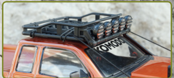
Am Dachgepäckträger aus Kunststoff lässt sich die Lampengalerie anschrauben. Die einzelnen Scheinwerfer kann man nachträglich sehr einfach mit LED bestücken
