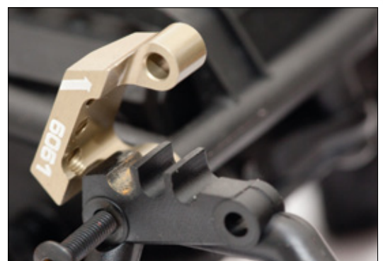
Die Stabilisatoren-Halterung ist auch aus Aluminium gefräst, lässt sich bestens tauschen und ermöglicht eine bessere Einstellung des hinteren Achsstabilisators. Zudem ist er mit Markierungen versehen
