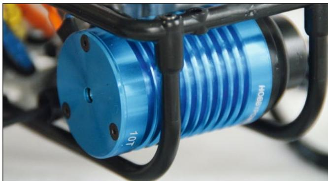
Der Brushlessmotor wird durch einen Kunststoffkäfig gut geschützt
