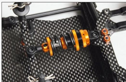
Der neue kurze Stoßdämpfer eingebaut in den X1'17
