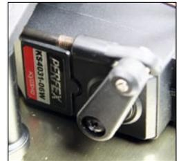
Das Lenkservo ist mit seinen 6 Kilogramm Stellkraft ausreichend dimensioniert und manövriert den DBX-VE 2.0 zielstrebig durchs Gelände
