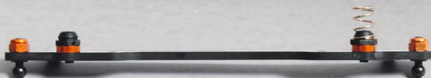
Mit den 2 Millimeter dicken Unterlegscheiben lassen sich die Federteller der Seitenfedern gerade anschrauben und die Federvorspannung auf beiden Seiten gleich anpassen
