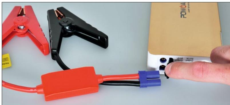
Über den EC5-Anschluss wird das Starthilfekabel mit der Pow-All verbunden. Beim Laden eines RC-Car-Akkus dürfte dieser Ausgang daher deutlich unterfordert sein
