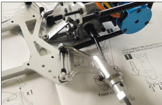
Die Hinterachse weist massive Schräglenker aus Vollaluminium auf. Im Vordergrund sind die Standard-Radmitnehmer gut zu erkennen
