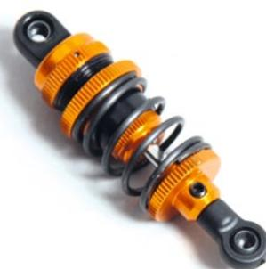
Der neue kurze Big-Bore-Stoßdämpfer. Über den Federteller kann nun recht simpel der Ausfederweg der Hinterachse verstellt werden
