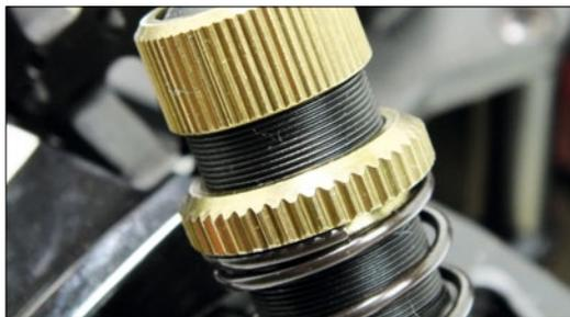
Die Federvorspannung kann stufenlos über Rändelschrauben angepasst werden
