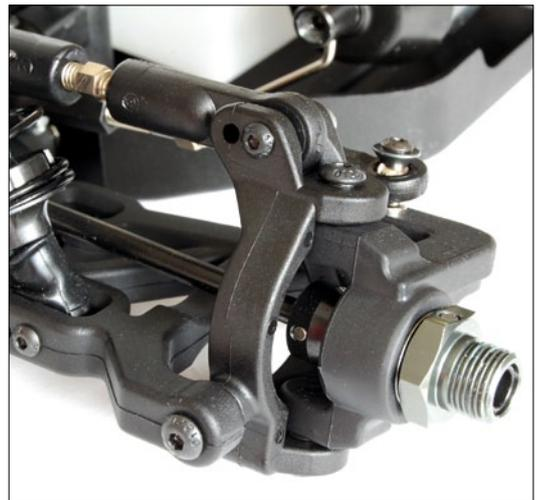
Bei der Lenkung setzt der Buggy auf die bewährte C-Hub-Konstruktion. 17-Millimeter-Radmitnehmer gehören zur absoluten Pflicht bei einem 1:8er-Buggy
