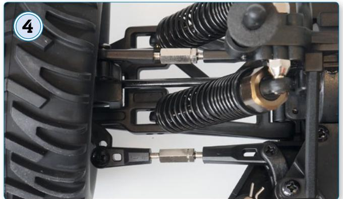
4 Rechts-links-Gewindestangen erlauben eine Einstellung des Fahrwerks
