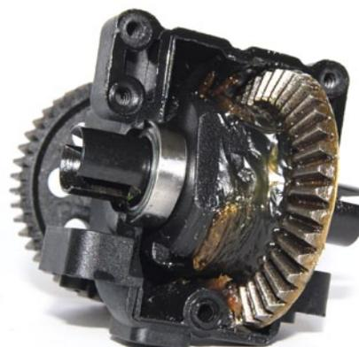
Die Differenziale sind werkseitig gefettet und damit gegen Verschleiß gewappnet. Die recht grobe Verzahnung des großen Tellerrades erzeugt vermutlich einiges an Reibung, überträgt dafür aber auch hohe Kräfte ohne zu ächzen
