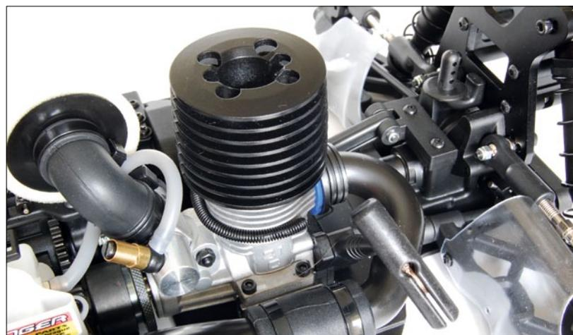
Mit seinem Dreikanal-Design erzeugt der 3,5-Kubikzentimeter-Motor eine gleichmäßige Kraftentfaltung und ordentlich Drehmoment. Zum Leben erweckt wird er per Seilzugstarter
