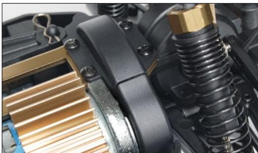
Um Hauptzahnrad und Motorritzel von Sand und Steinchen abzuschirmen, wird der Bereich großräumig durch demontierbare Kappen abgedeckt
