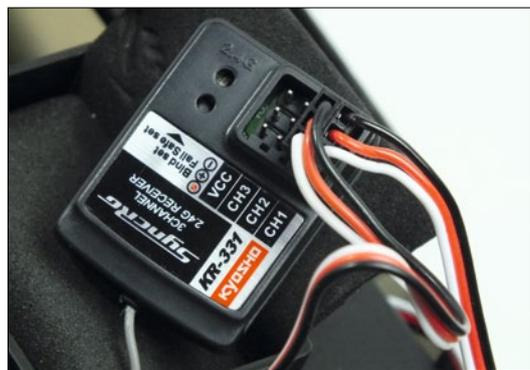
Der Dreikanal-Empfänger KR-331 verfügt über eine Fail-Safe-Funktion und versteckt sich in der spritzwassergeschützten RC-Box
