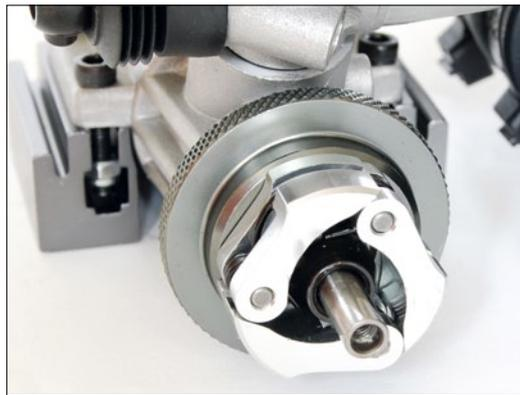
Dass ein RTR-Buggy mit einer schicken und funktionalen Kupplung mit drei Aluminium-Backen aufwartet, ist eher die Ausnahme
