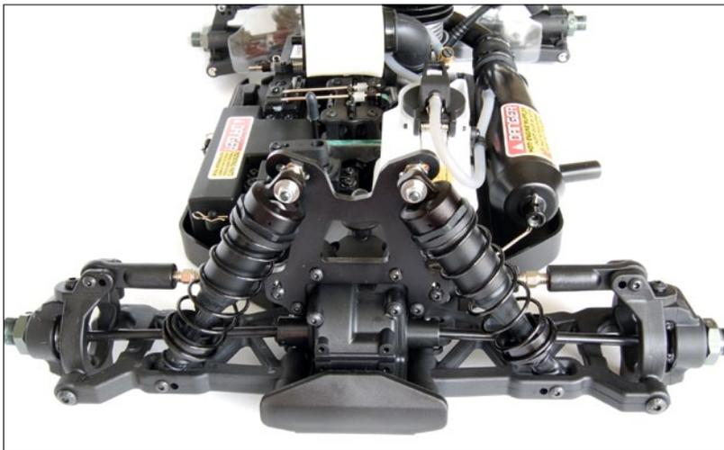
Schwarz ist die alles dominierende Farbe der Konstruktion. Es sorgt dafür, dass sich Kunststoff und Aluminium nicht so leicht unterscheiden lassen. Die langen Stoßdämpfer bestehen aus Kunststoff, bei ihren Kappen kam Aluminium als Werkstoff zum Einsatz
