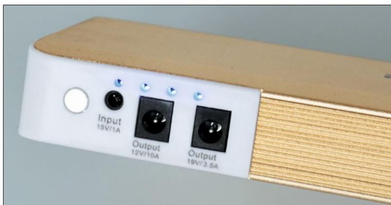
Zwei unterschiedliche Ausgänge, der Ladeeingang und eine Akkustandsanzeige (vier blaue LED) befinden sich seitlich am Gehäuse
