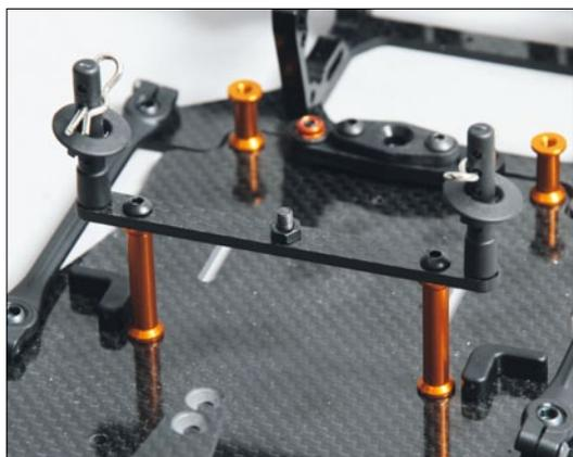
Die Befestigung für den Stoßdämpfer hat ihre Position aufgrund der neuen Dämpferlänge verändert
