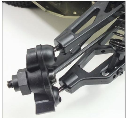
Als Achsschenkel-System setzt der DBX-VE 2.0 auf Pivot-Ball-Aufhängungen, wodurch eine Sturzanpassung ganz einfach möglich ist
