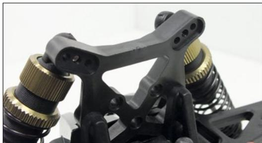
Mit Hilfe von verschiedenen Befestigungsbohrungen sind zahlreiche Einstellmöglichkeiten für die Dämpfercharakteristik gegeben
