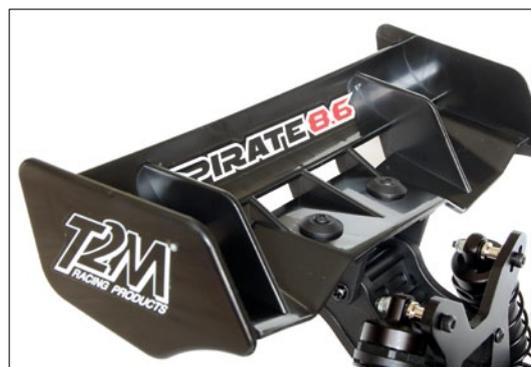
Der große Heckflügel des Piraten wandelt Luftströme in Anpressdruck für die Hinterachse um
