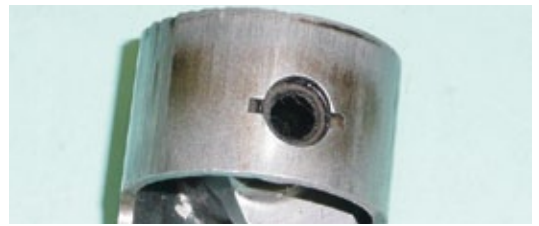
Abrasionsschaden am Feuersteg eines ringlosen Kolbens. Das Kolbenhemd verrät, dass die Zylinderabdichtung bereits verschlissen war
