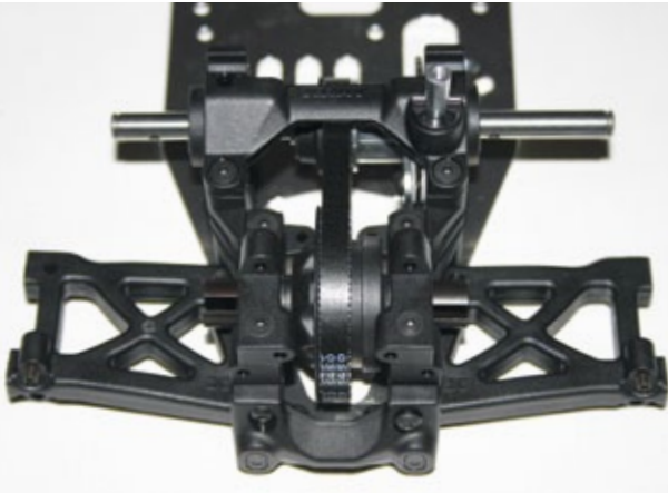
Die Hinterachse wird im ersten Bauschritt erstellt
