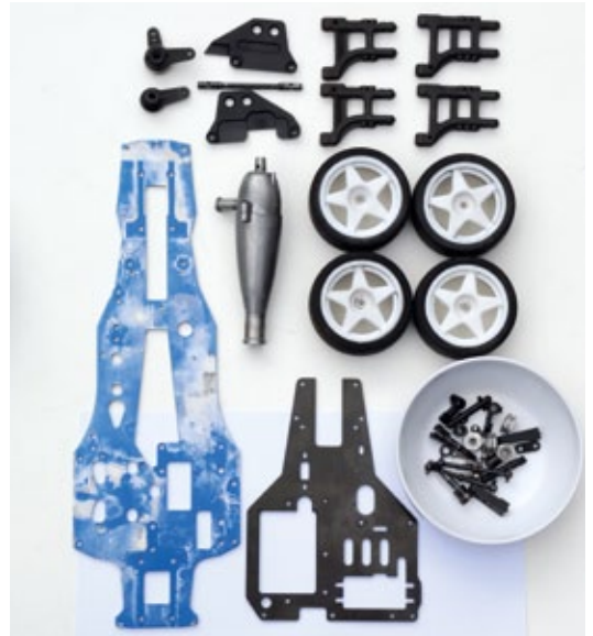
Bedingt weiter verwendbar waren Teile wie die crashbeschädigte Chassisplatte, ein mit Kleber verunstaltetes Oberdeck und Querlenker, bei denen die Bohrung für den Ausfederanschlag zu groß aufgebohrt worden war
