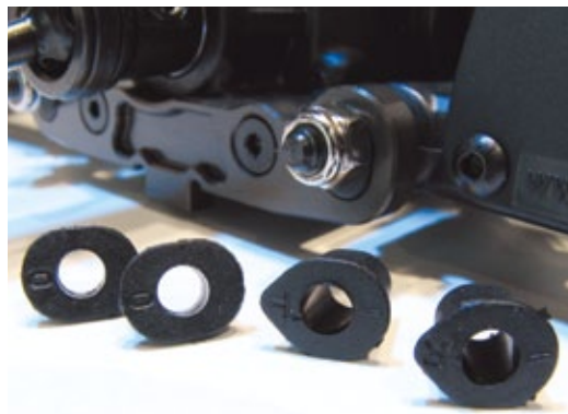
Über verschiedene Einsätze können die Schwingenstifte in unterschiedlichen Winkeln montiert werden. So ergeben sich mehrere Einstelloptionen
