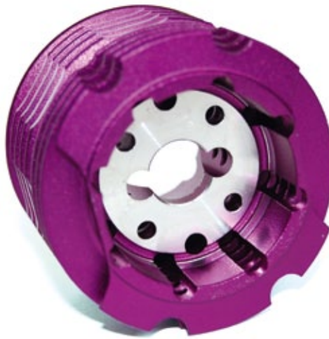
Der Übergang zum separaten Turbobrennraum wurde gute 13 Millimeter in den Kühlkopf eingelassen – Schwerpunktoptimierung ist Trumpf
