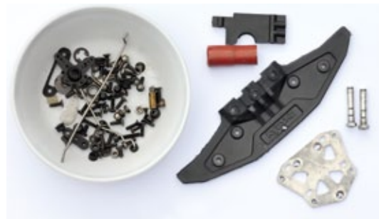
Wirklich defekt waren nur wenige Bauteile und die defekten Schrauben stammen überwiegend von der Chassisunterseite
