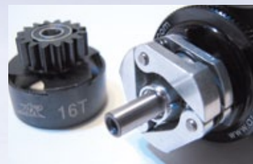
Wettbewerbsgene sogar unter der Kupplung: drei Backen aus Alu und eine gewichts- und kühlungsoptimierte Glocke
