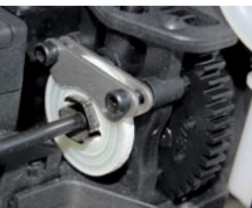
Zwei Bremscheiben aus Glasfaser setzen jeder rasanten Fahrt auf Wunsch ein abruptes Ende
