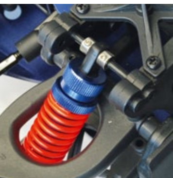
Die Dämpfer sind mit Stellringen auf Stahlwellen fixiert – nicht typisch aber durchaus funktionell
