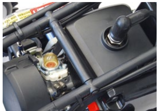
Vergaser und Zündkerze sind gut zugänglich untergebracht
