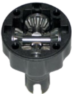
Die Kegeldiffs sind beide gleich aufgebaut und sehr kompakt
