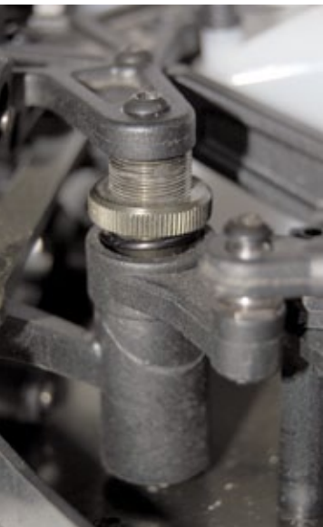
Der einstellbare Servosaver vernichtet Belastungsspitzen und schützt die Lenkung
