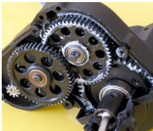
Sauber verarbeitet und gut geschmiert – so präsentiert sich die dreistufige Getriebeeinheit des Punisher
