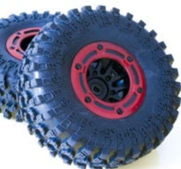
Crawler-typisch sind die Reifen des Punisher über Beadlock-Ringe auf den Felgen befestigt
