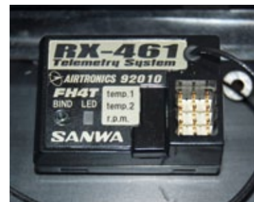
Neben der Erfassung von Empfängerspannung und Drehzahl bietet der leichte RX-461 gleich zwei Anschlüsse für Temperatursensoren
