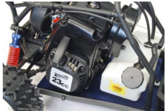
Das Herzstück des Spider-Buggys, der 23-Kubikzentimeter-Benzinmotor, sitzt leicht nach vorne geneigt auf dem Chassis und treibt die Hinterachse an
