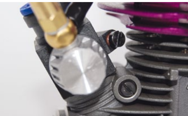
Die Positionierung der Standgasschraube am Komposit-Vergaser wurde optimal umgesetzt
