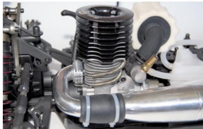
Eines der Highlights des ZRE-2 ist der Go-Motor mit 3,5 Kubikzentimeter Hubraum. Drehmoment, Drehzahl und Thermik stimmen
