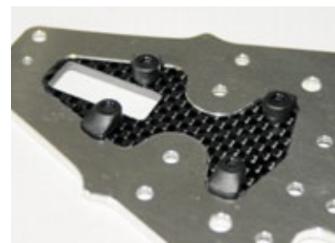
Die Kohlefaserinlays können durch Messinggewichte ersetzt werden
