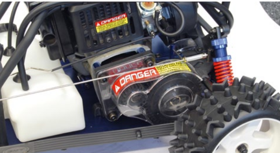
Das Getriebe ist vollständig geschützt, sodass kein Schmutz zwischen die Zahnflanken gelangen kann
