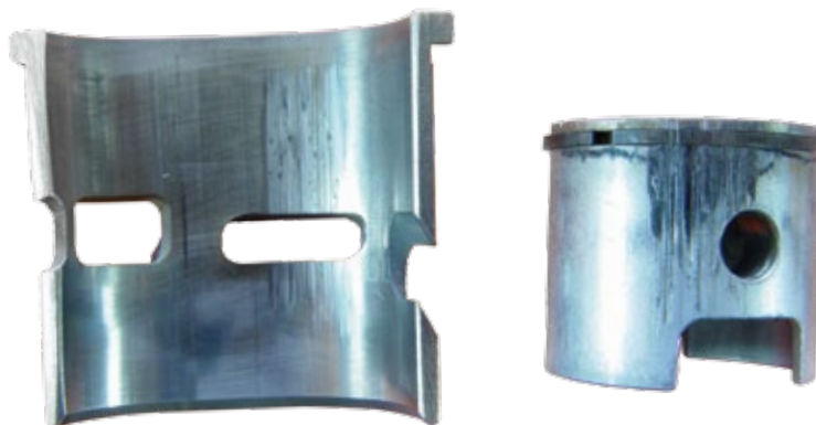
Starker Abrasionschaden eines Ringkolbens nebst Buchse
