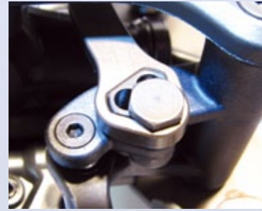
Eine Neuentwicklung von Ansmann: das Insertloc-Ackermann-System erlaubt feinere Abstimmungen im Bereich der Lenkung
