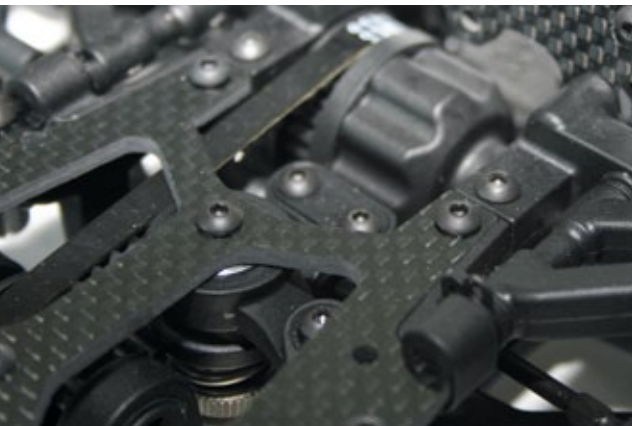
Die Lenkung hat einen einstellbaren Servosaver
