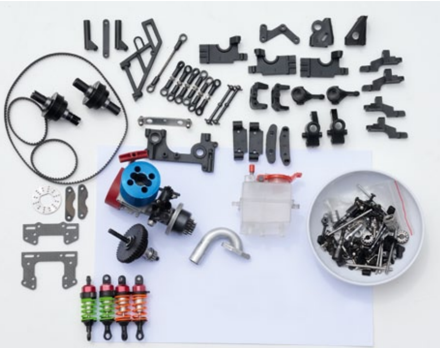
Die meisten Kunststoffteile und auch Verschleißteile wie beispielsweise die Zahnriemen waren uneingeschränkt weiter verwendbar
