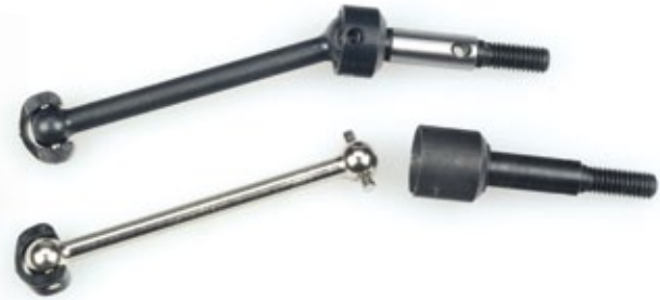
Der Ersatz der Knochenwellen in der Vorderachse durch die Kardanhalbwellen ist eine mehr als empfehlenswerte Tuningmaßnahme
