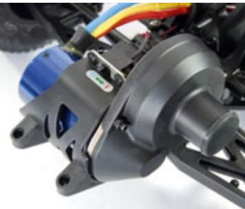
Der Brushlessmotor ist samt gekapseltem Getriebe und Ein-aus-Schalter hinter der Hinterachse der beiden Amewi-Racer platziert
