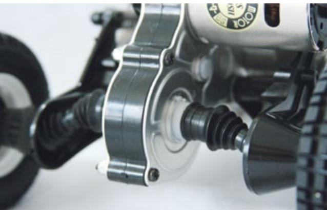
Die Getriebeeinheit in Sandwich-Bauweise ist voll gekapselt, um das Eindringen von Schmutz zu verhindern. Im Getriebeinneren kommen hochwertige Kugellager zum Einsatz
