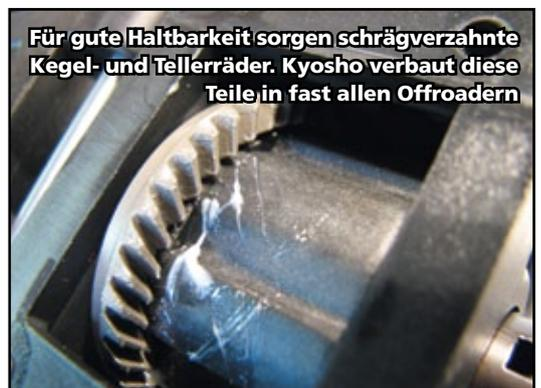
Für gute Haltbarkeit sorgen schrägverzahnte Kegel- und Tellerräder. Kyosho verbaut diese Teile in fast allen Offroadern
