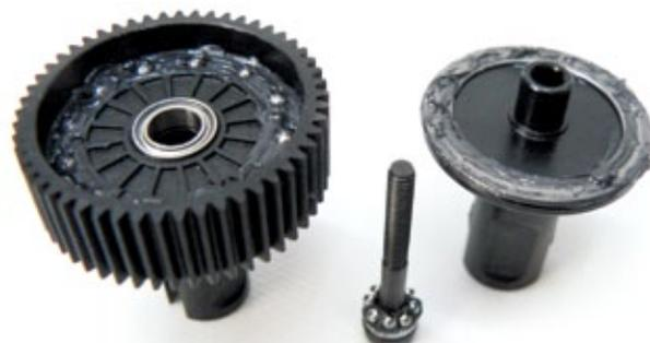
**Ein dutzend Diffkugeln sowie weitere acht Drucklagerkugeln und eine sehr passgenaue Fertigung ergeben zusammen mit etwas Molybdänfett ein sehr geschmeidig laufendes Kugeldifferential**
