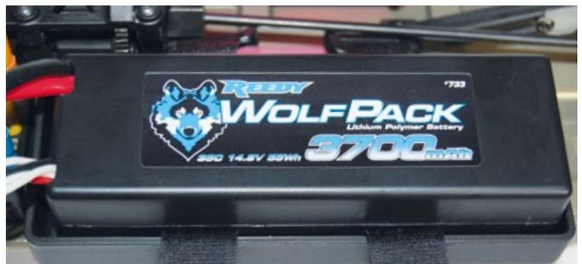
Als Stromspender diente ein 4s-Wolfpack mit einer Kapazität von 3.700 Milliamperestunden und einer Entladerate von 35C
