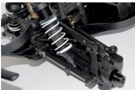
Die robuste Aufhängung des Apache bietet viele Möglichkeiten, das Setup anzupassen. Eine Ausnahme bilden die starren Spurstangen
