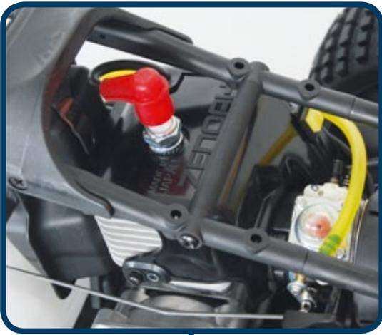
Gestartet wird der Zenoah-Zweitakter über den integrierten Seilzugstarter
