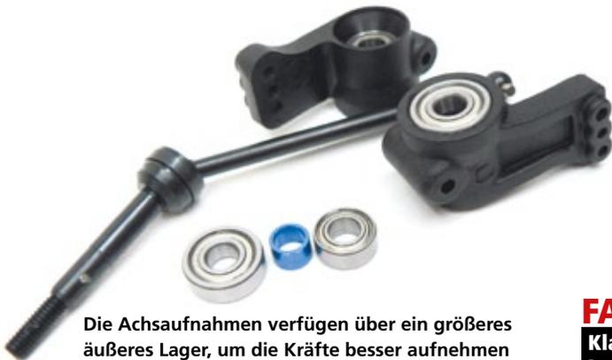
Die Achsaufnahmen verfügen über ein größeres äußeres Lager, um die Kräfte besser aufnehmen zu können. Ebenfalls durchdacht ist der Stützring für die inneren Lagerringe, damit sich diese beim Anziehen der Radmutter nicht verkanten können
