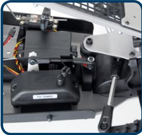
Das Lenkservo ist liegend verbaut und überträgt die Lenkbefehle über einen Servosaver auf ein spielfreies Gestänge
