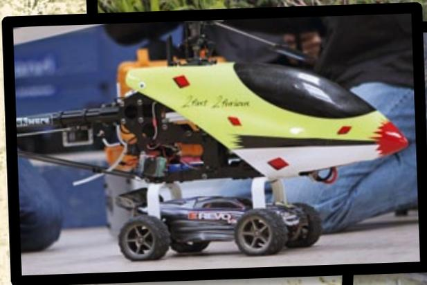
Die erste Version des Rovers wurde für einen Traxxas E-Revo VXL konstruiert. Die Spezialkufen sind eine CAD-Konstruktion und mittels Schrauben direkt auf den Querlenkern befestigt. Der T-Rex 600 wird mit 6s-LiPo-Akkus befeuert, was bei 5.000 Milliamperestunden Kapazität eine Flugzeit von gerade mal vier Minuten ergibt
