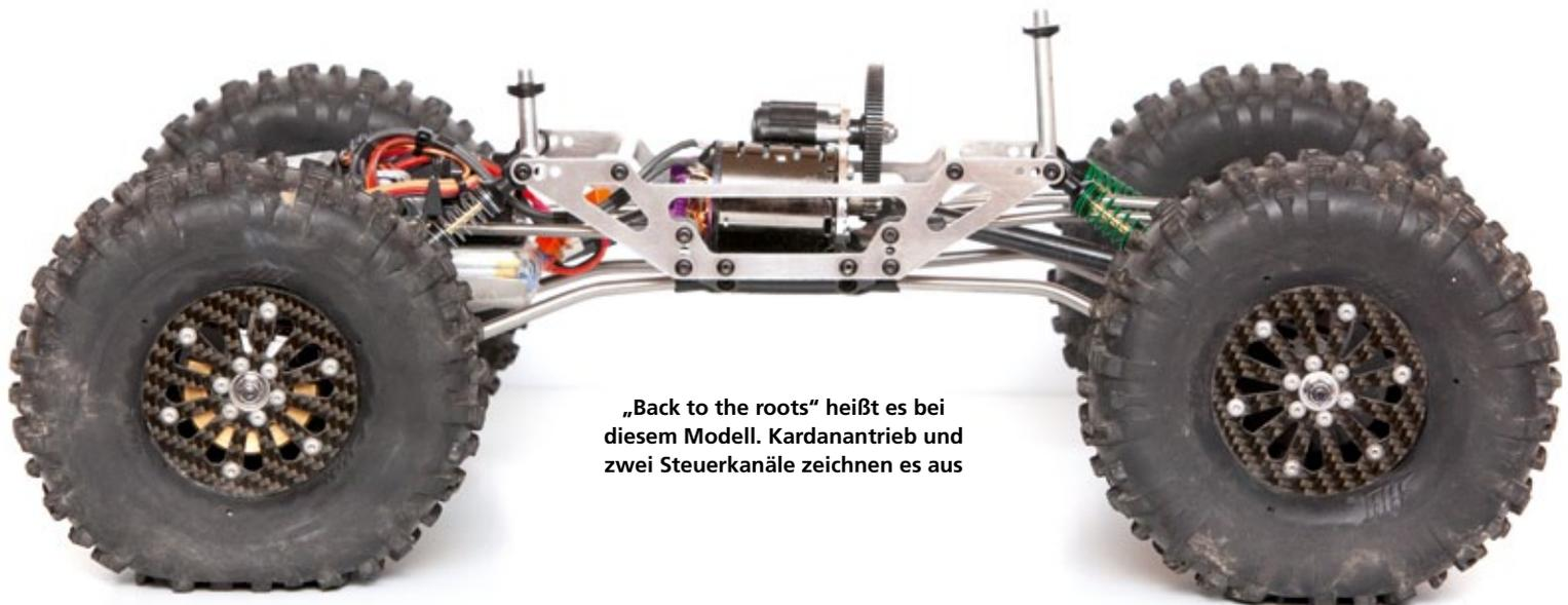
„Back to the roots“ heißt es bei diesem Modell. Kardanantrieb und zwei Steuerkanäle zeichnen es aus
