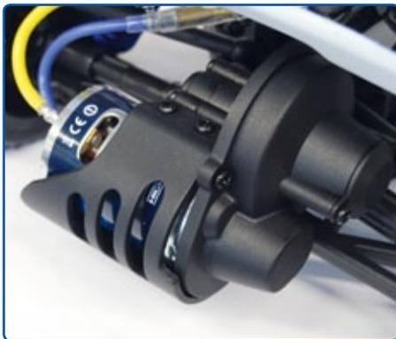
Bei 2WD-Buggys ist der Motor typischerweise an der Hinterachse platziert. Dies sorgt für einen soliden und wartungsarmen Antriebsstrang
