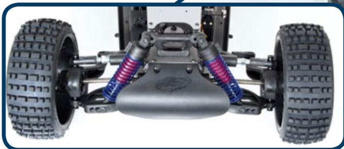
Querlenkerschwingen unten, Gewindestangen oben, eine solide Dämpferbrücke und dicke Antriebswellen sind die Basis für eine haltbare Achskonstruktion
