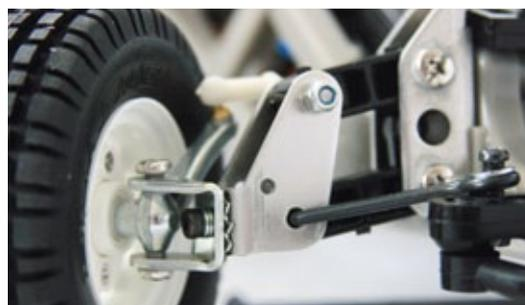
An der Vorderachse wird ein einfacher aber effektiver Dämpfungsmechanismus verwendet. Die Reibungsdämpfer absorbieren die Unebenheiten jedoch nur auf der Straße ganz gut. Positiv fällt die Ausführung der Achsschenkel in Aluminium auf
