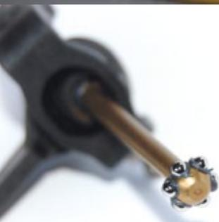
Kyoshos Ball Drive System verbindet die Differenzial- und Spool-Abtriebe mit den Antriebswellen
