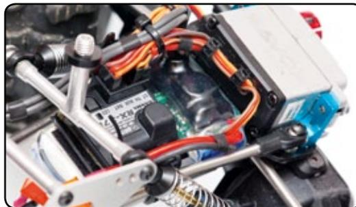
Akku, Empfänger, Regler und BEC sind auf der Vorderachse platziert
