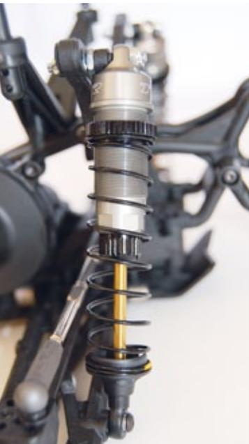
Eine absolut präzise Fertigung kennzeichnet die Stoßdämpfer, aus denen während der gesamten Testfahrten kein Öl austrat
