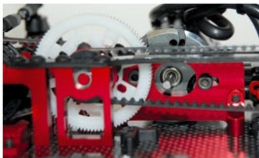
Wer beide Motorschrauben festziehen will, muss den direkten Weg durch das Hauptzahnrad nehmen
