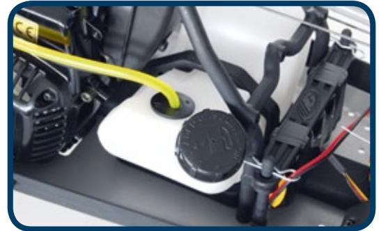
Lange Fahrzeiten garantiert der großvolumige Kraftstofftank, der in der Mitte des Chassis platziert ist
