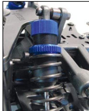
Großvolumige Stoßdämpfer mit Rändelmuttern zum Anpassen der Federvorspannung gehören zur Serienausstattung
