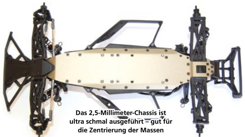
Das 2,5-Millimeter-Chassis ist ultra schmal ausgeführt – gut für die Zentrierung der Massen
