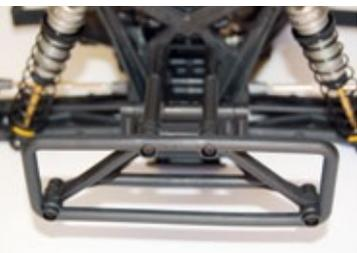
Im Baukasten enthalten sind zwei unterschiedliche Heckkammer: Ein breiter mit den obligatorischen Schmutzfängern und die hier gezeigte, schmale Variante speziell für Renneinsätze
