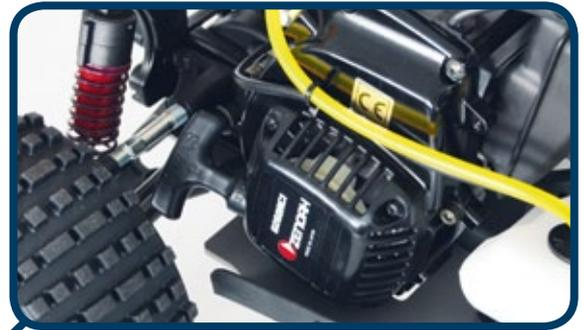
Öldruckstoßdämpfer sorgen für eine gute Federung im Gelände. Die Vorspannung lässt sich über C-Klipse variieren
