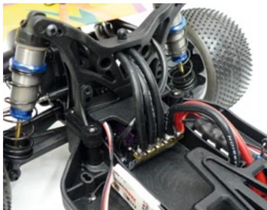
Der Speed Passion GT V2.0 Pro kann ohne Lüfter verbaut werden und ermöglicht daher eine sehr kurze Verdrattung und einen sehr niedrigen Schwerpunkt
