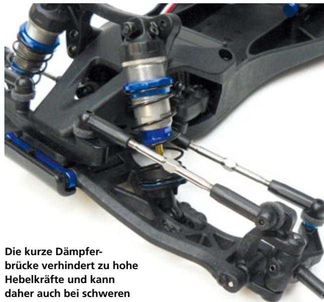
**Die kurze Dämpferbrücke verhindert zu hohe Hebelkräfte und kann daher auch bei schweren Überschlägen die Dämpfer optimal schützen**
