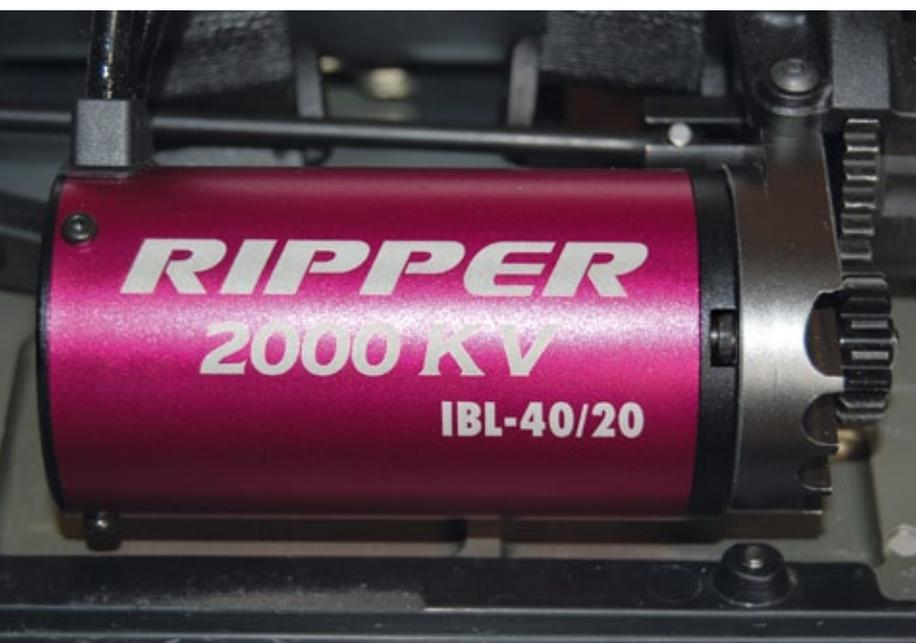
Kern des Antriebssets bildet ein kraftvoller Brushless-Innenläufer mit der Bezeichnung Ripper IBL-40/20
