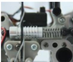
Die Öldruckstoßdämpfer am Heck sind sehr hochwertig in Aluminium ausgeführt und funktionieren einwandfrei
