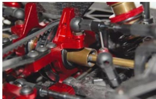
Bei der SP-Version des TF6 wurden jetzt auch die Abtriebe des Spools an der Vorderachse komplett aus Aluminium gefertigt
