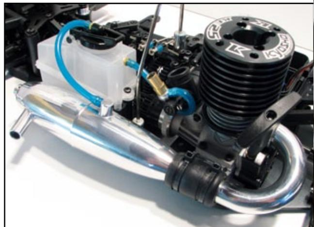
Der KE25-Nitromotor bringt in Verbindung mit dem polierten Reso-Rohr ordentlich Leistung. Angelassen wird das Triebwerk über einen Seilzugstarter
