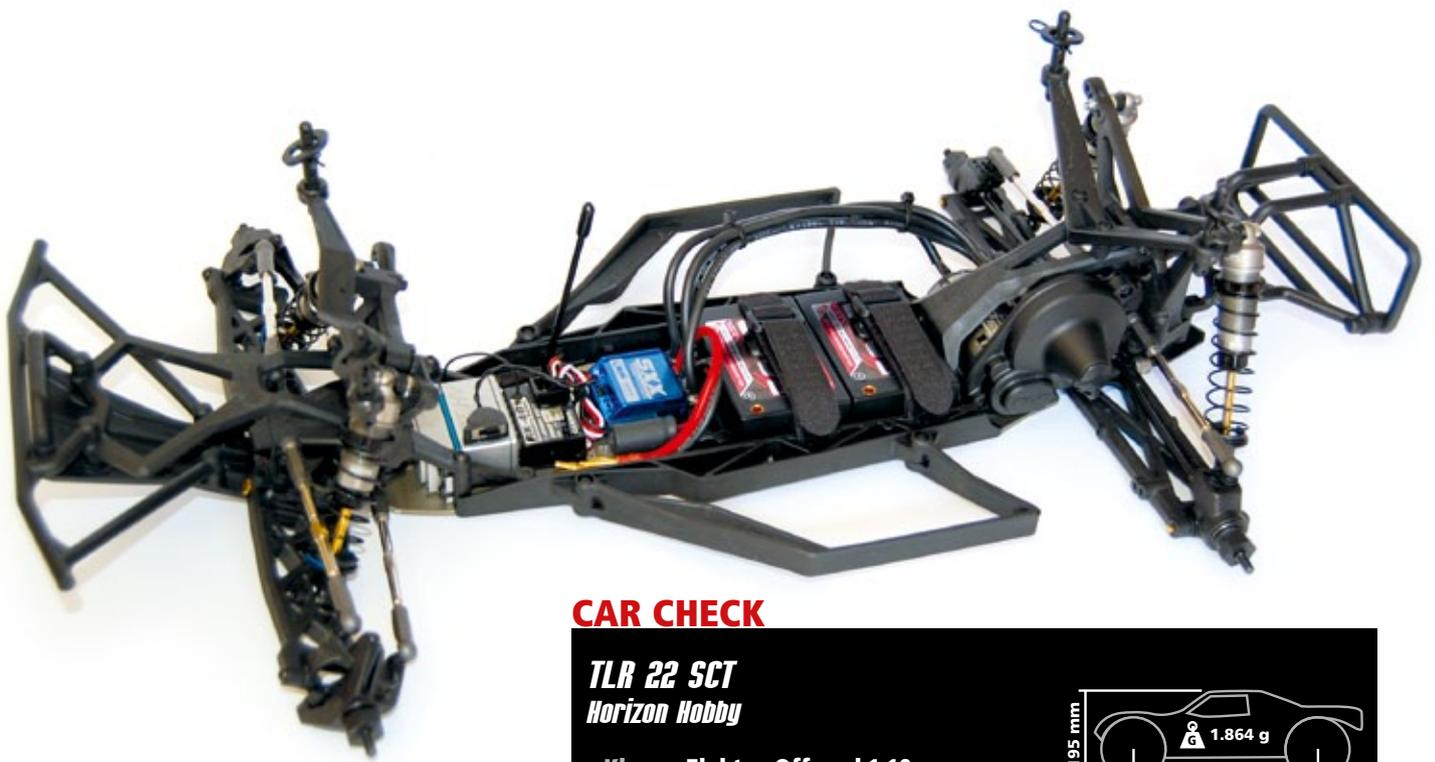
Im fertig aufgebauten Modell lassen sich alle Elektro-Komponenten optimal tief platzieren
