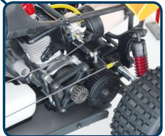
Ein Hitec-Servo im vorderen Chassisbereich übernimmt die Gas-Brems-Funktion. Es ist schnell und stellstark
