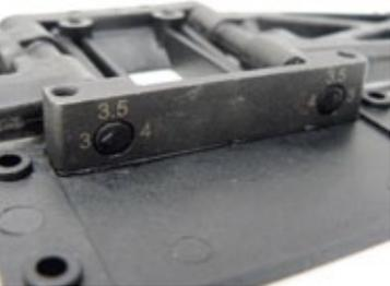
Der Winkel der Vorspur lässt sich an der Hinterachse bequem über die Einsätze und deren Ausrichtung einstellen – der kleine Pfeil zeigt dann die Einstellung in Grad an
