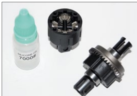
4-Spider-Diffs gelten in Sachen Robustheit und Standfestigkeit als das Optimum
