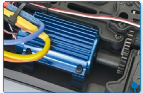
Der Brushlessmotor mit einer spezifischen Drehzahl von 1.968 kv ist passiv gekühlt
