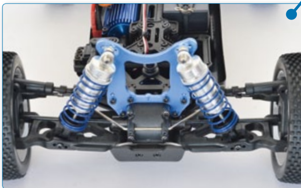
Die Federvorspannung der großvolumigen Alu-Öldruckstoßdämpfer lässt sich über Rändelschrauben einstellen
