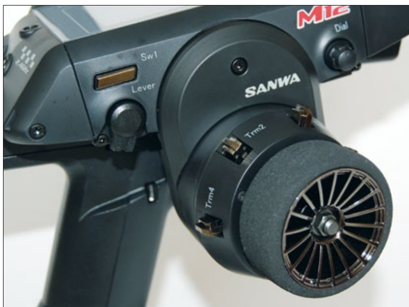
Per mitgelieferten Adaptern lässt sich die Position des Lenkrads verändern
