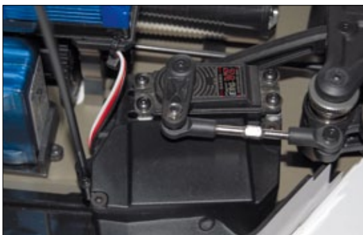
Die Elektronikbox dient gleichzeitig als Lenkservo-Befestigung und nimmt auch größere Empfänger problemlos auf
