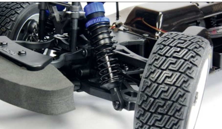
Die Stoßdämpfer sind an allen vier Aufhängungen gleich lang. Dank des enormen Federwegs ist der Ford Fiesta DRX VE fast überall einsetzbar
