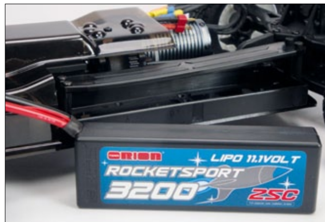
Von Team Orion gibt es den passenden 3s-Hardcase-LiPo vom Typ Rocket Sport mit 11,1 Volt Spannung und einer Kapazität von 3.200 Milliamperestunden. Die Belastbarkeit von 25C, in diesem Fall 80 Ampere, reicht für den leichten Boliden locker aus
