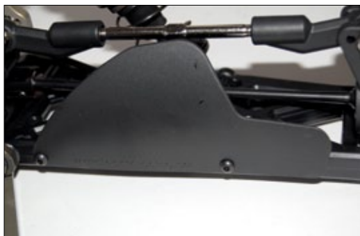
Ebenfalls serienmäßig enthalten sind die unspektakulären, aber sehr nützlichen Schmutzabweiser an der Hinterachse
