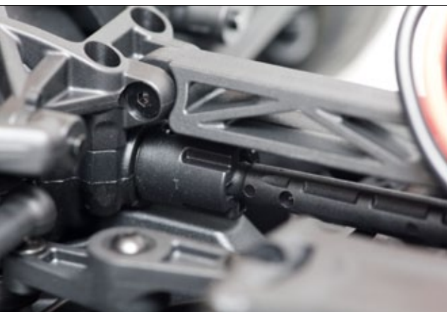
Antriebswellen aus Kunststoff übertragen die Motorkraft
