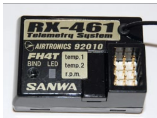
Sanwas RX-461 ist von mittlerer Größe und bietet neben den Anschlüssen für Servos und Fahrregler auch noch Anbindungen für die Telemetrie-Sensoren
