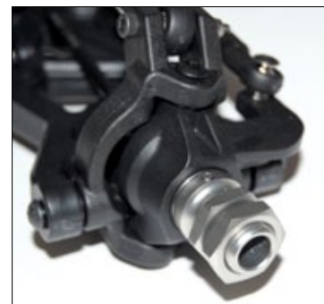
Neben ihrer Funktion als Aufnahme für die Felgen sorgen die 17-Millimeter-Mitnehmer zusätzlich für eine Spurverbreiterung
