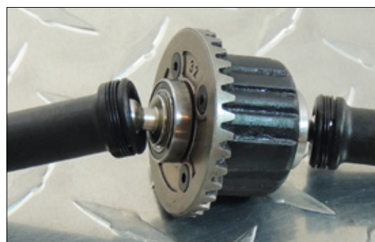
Die ölgefüllten Differenziale verfügen über einen stabilen Zahnkranz aus Metall
