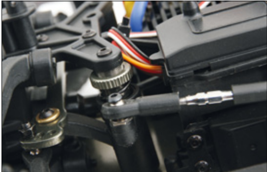
Die Härte des Servosavers kann stufenlos verändert werden
