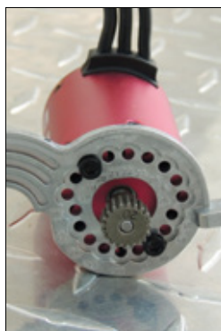
Die Motorhalterung ist sehr sauber gefertigt. Gewöhnungsbedürftig für Perfektionisten: die vorgebohrten Befestigungslöcher für unterschiedliche Ritzelgrößen
