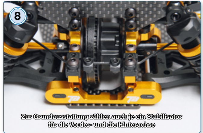
An der Vorderachse ist der DETC410 mit Doppelgelenkkardans ausgestattet. Für die Hinterachse reichen die einfachen. Die Halbwellen sind aus Aluminium
