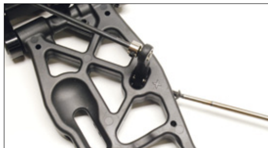
Feiner Unterschied: Dank der neuen Anordnung lassen sich die Stabilisator-Halter der Hinterachse einfach demontieren
