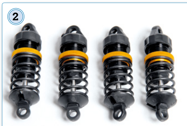
Die vier Öldruckstoßdämpfer mit Rändelschrauben und Gehäusen aus Aluminium gehören zur Grundausstattung
