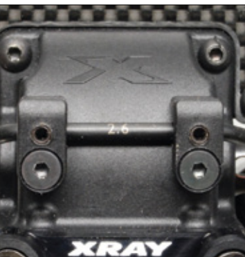
Die Dicke des Stabilisators ist ab sofort als Millimeterwert eingelasert
