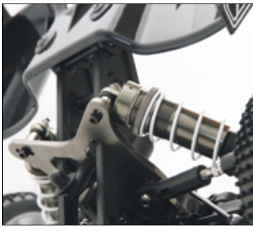
Hochwertig: Dämpferbrücken aus Alu und Dämpfer mit Feingewinde und Rändelmuttern
