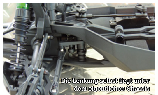
Das spritzwassergeschützte Servo funktionierte während der Tests auch nach Wasserdurchfahrten noch klaglos
