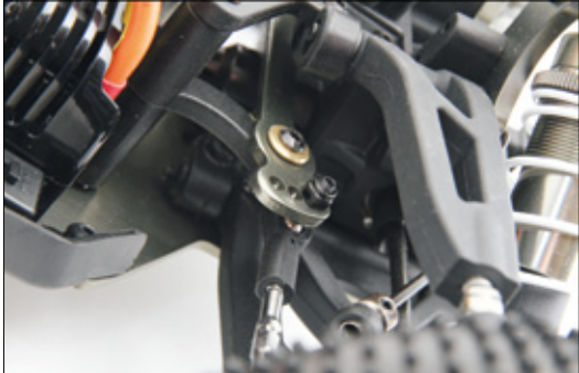
An der Lenkstreupe gibt es drei Befestigungspunkte für die Spurstangen
