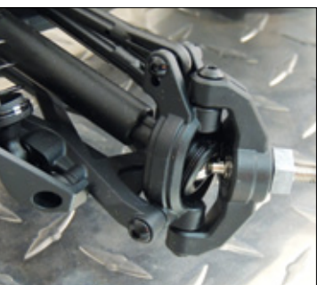
Ein besonderes Detail der Vorderachse sind die stabilen Kardanwellen
