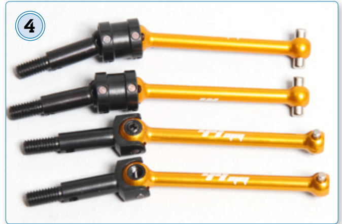
An der Vorderachse ist der DETC410 mit Doppelgelenkkardans ausgestattet. Für die Hinterachse reichen die einfachen. Die Halbwellen sind aus Aluminium
