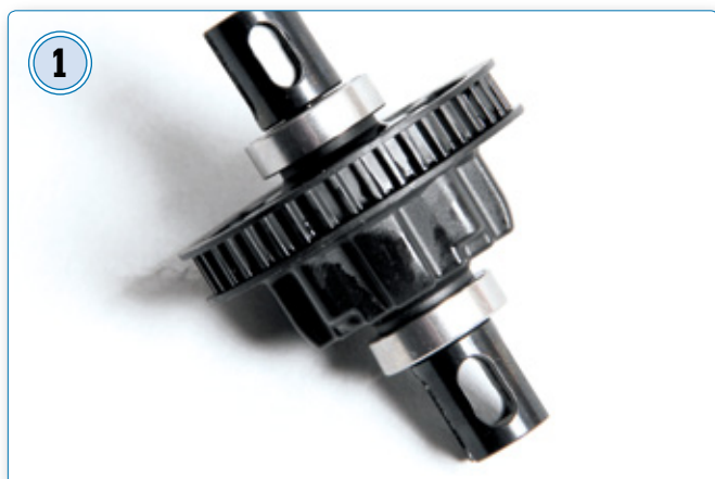
Für die Hinterachse haben die Konstrukteure – wie heute üblich – ein Kegeldifferenzial vorgesehen
