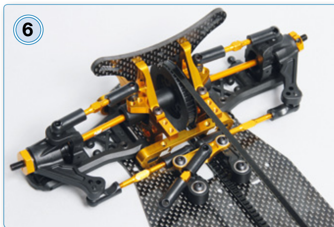
Der DETC410 verfügt über eine zweiarmige Lenkung. Die Arme sind aus Kunststoff, die Lenkplatte aus Aluminium
