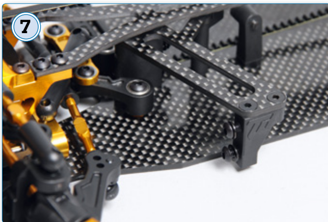
Servohalter aus Karbon – bei dieser heute gebräuchlichen Konstruktion schwebt das Lenkservo quasi über der Chassisplatte. Ein solcher Servohalter gehört aktuell zum Standard
