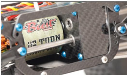
Für ausreichend Drehmoment sorgt ein RC4WD Boost 45-Turns-Motor
