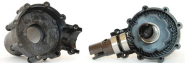
Stählerne Diffs in der Vorder- und Hinterachse sorgen in Kurven für den Drehzahlausgleich zwischen innerem und äußerem Rad
