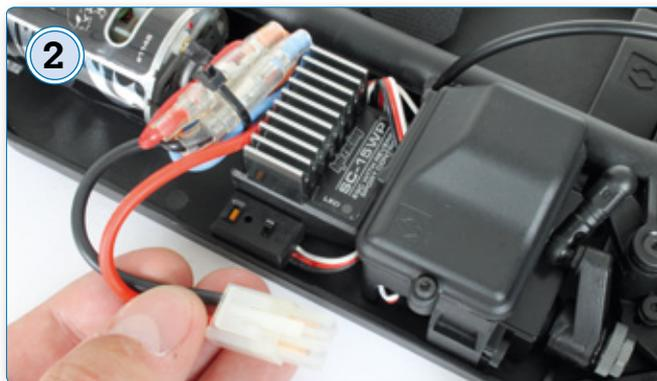
2 Der Regler mit Tamiya-Stecker und die RC-Box mit dem 2,4-Gigahertz-Empfänger sitzen vor dem Motor und sind spritzwassergeschützt. Das Servo befindet sich unter der RC-Box
