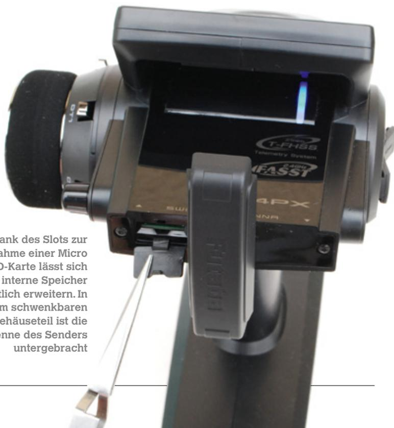
Dank des Slots zur Aufnahme einer Micro SD-Karte lässt sich der interne Speicher deutlich erweitern. In dem schwenkbaren Gehäuseteil ist die Antenne des Senders untergebracht
