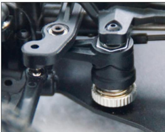
Der massive Servosaver schützt das High-Torque-Lenkservo effektiv vor Beschädigungen
