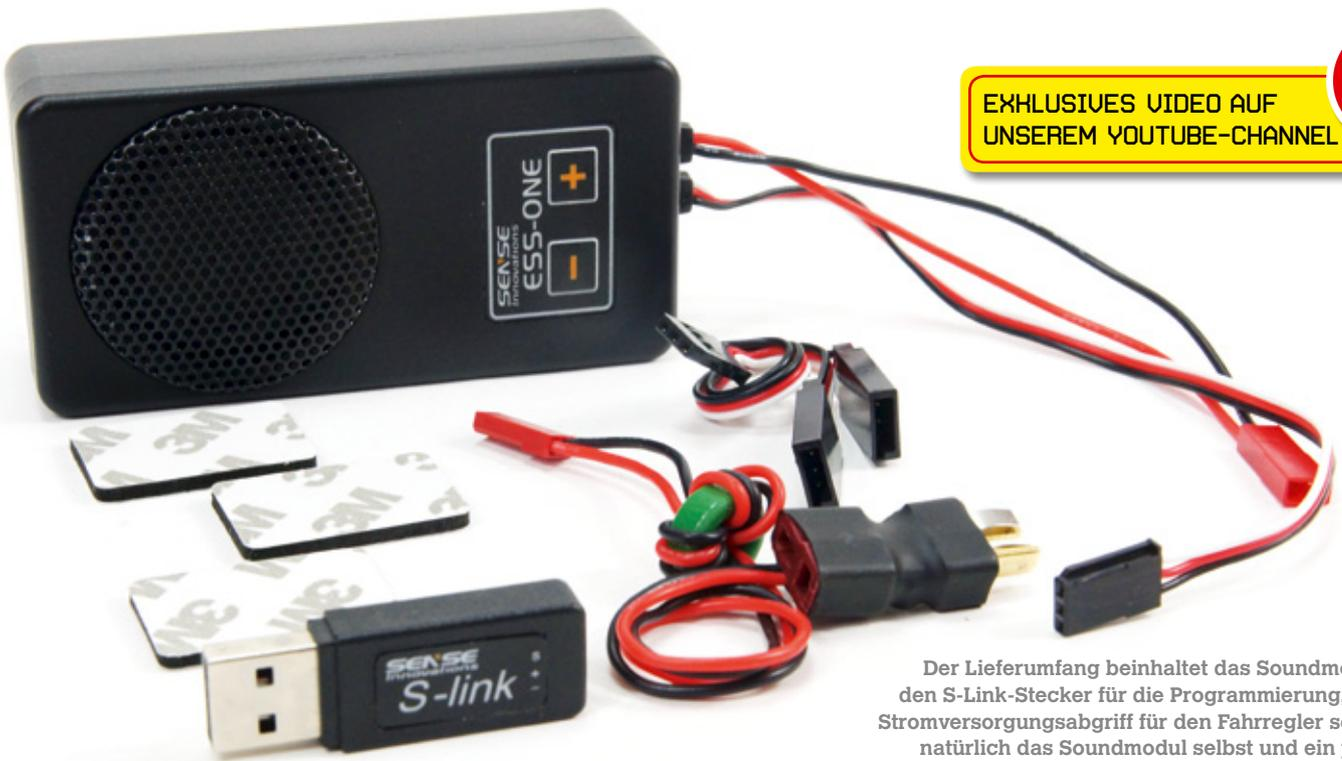
Der Lieferumfang beinhaltet das Soundmodul, den S-Link-Stecker für die Programmierung, den Stromversorgungsabgriff für den Fahrregler sowie natürlich das Soundmodul selbst und ein paar 3M-Klebe pads zur festen Installation
