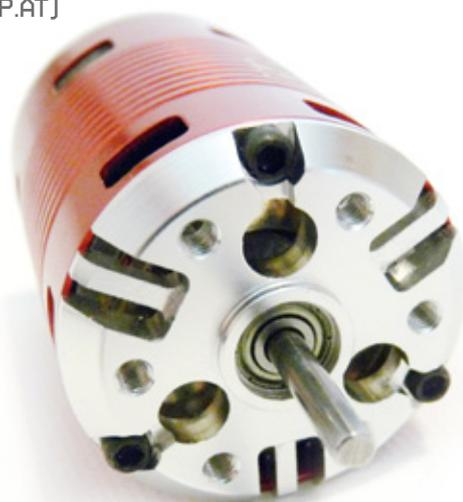
Das nicht mit zu vielen Kühlöffnungen versehene Gehäuse des 6,5-Turns-ZTW-Motors bleibt auch bei Umgebungstemperaturen jenseits der 30 Grad Celsius im grünen Bereich – eine korrekte Unterersetzung vorausgesetzt
