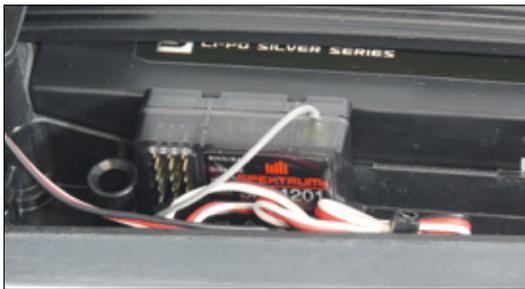
Aufgrund der beengten Verhältnisse im Wannenchassis ist der AVC-Empfänger von Spektrum stehend montiert und ab Werk bereits verkabelt
