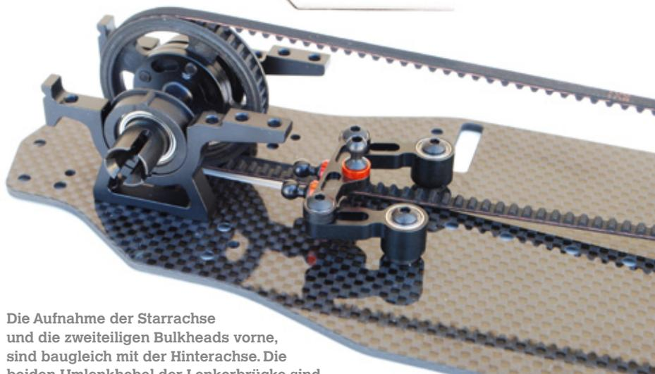
Die Aufnahme der Starrachse und die zweiteiligen Bulkheads vorne, sind baugleich mit der Hinterachse. Die beiden Umlenkhebel der Lenkerbrücke sind unmittelbar auf der Chassisplatte, ohne weitere Verstrebung zum Top-Deck fixiert
