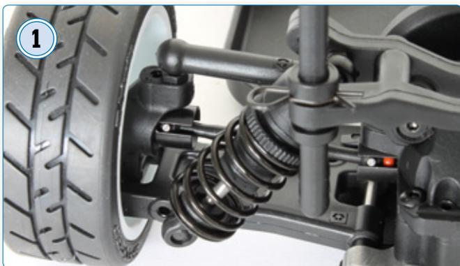
1 Öldruckstoßdämpfer aus Kunststoff, Knochenwellen und wenig Einstellmöglichkeiten: der RS4 Sport 3 ist ein solides Einsteigerchassis
