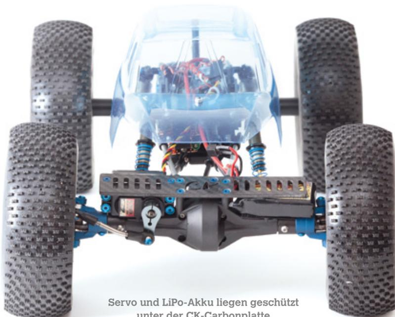
Servo und LiPo-Akku liegen geschützt unter der CK-Carbonplatte
