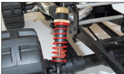
Kunststoffdämpfer mit Rädelerstellung sollen Bodenunebenheiten ausbügeln
