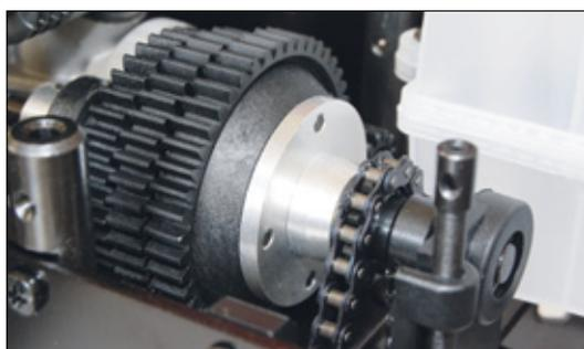
Per Stahlkette werden die Rotationen aus dem Dreigang-Getriebe zum tiefer platzierten, zentralen Antriebsstrang geleitet
