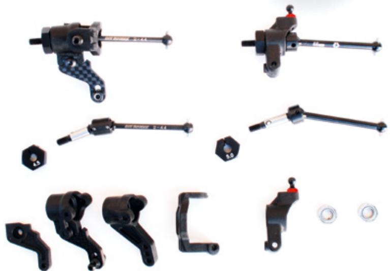
Doppel-Gelenkwellen an der Vorderachse garantieren einen vibrationslosen Antrieb, auch bei kleinen Lenkradien. Hinten kommen einfache CVD-Wellen zum Einsatz
