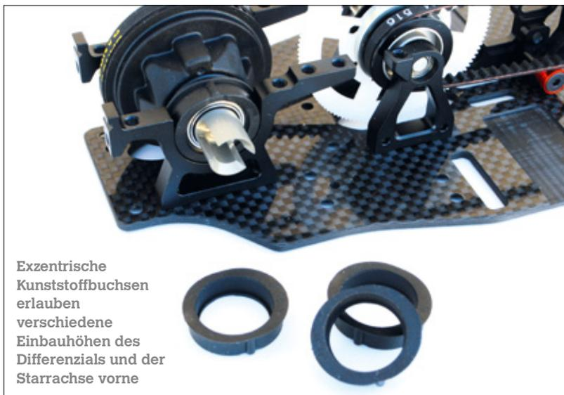
Exzentrische Kunststoffbuchsen erlauben verschiedene Einbauhöhen des Differenzials und der Starrachse vorne
