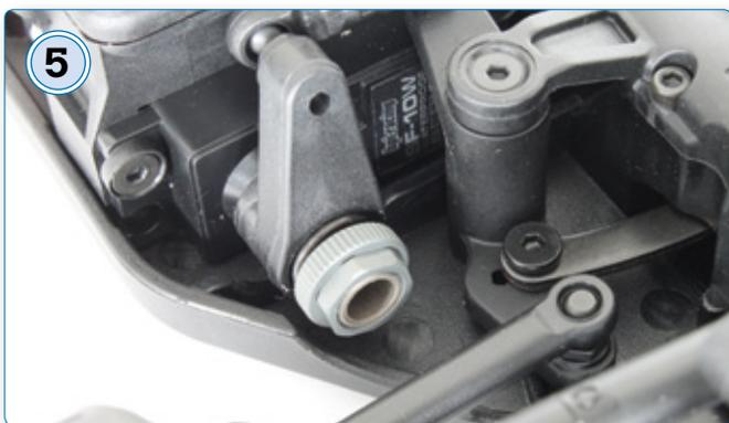
5 Der Servosaver sitzt direkt auf dem Abtriebshebel des Servos
