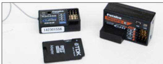
Der neue Vierkanal-Empfänger inklusive Telemetrie-Funktion (links) ist etwa so groß wie eine normale SD-Speicherkarte
