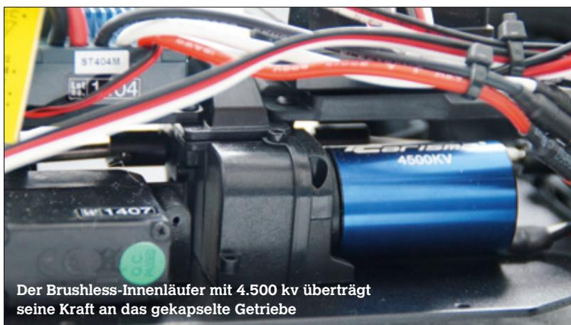
Der Brushless-Innenläufer mit 4.500 kv überträgt seine Kraft an das gekapselte Getriebe
