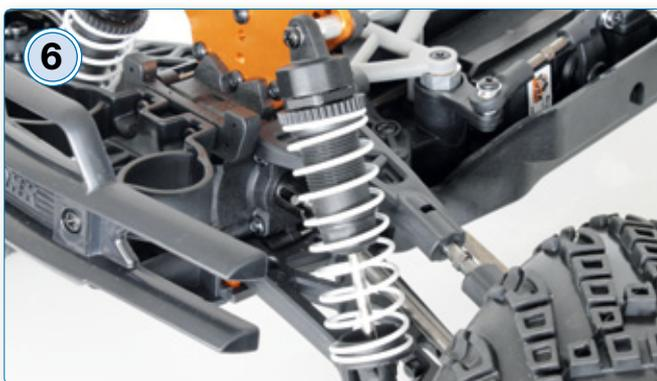
Die Federvorspannung der Dämpfer lässt sich über Rändelschrauben einstellen
