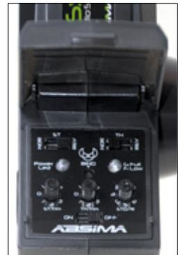
Alle Regler sind an der Fernsteuerung hinter einer Abdeckung versteckt, um diese vor versehentlicher Verstellung zu schützen
