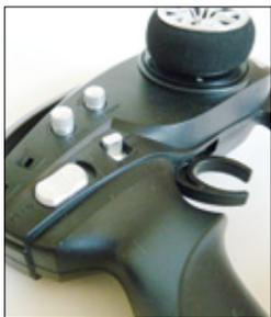
Neben der üblichen Trimmung für die Lenkung findet sich nur noch eine Verstellbarkeit des Hebelwegs sowie der Ein-aus-Schalter am eigenwillig gestalteten Sender
