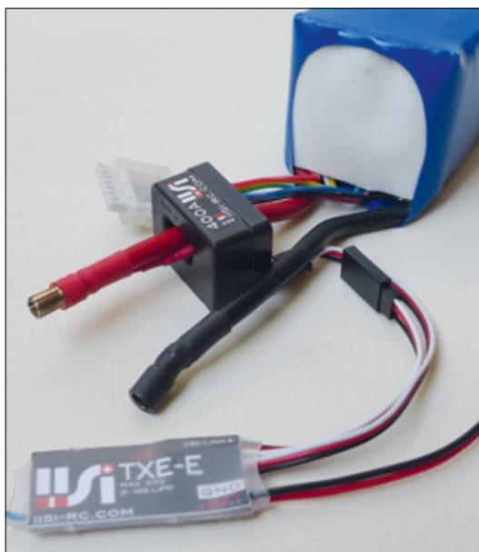
Für eine Messung muss der Akku- beziehungsweise das Reglerkabel lediglich durch den Sensor hindurchgeschoben werden
