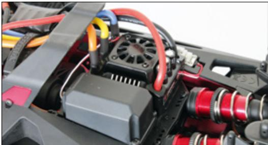
Der 150-Ampere-Regler und die wassergeschützte RC-Box sitzen zentral im Chassis auf einer Platte
