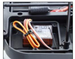
In der großzügigen RC-Box sitzt der kompakte 2,4-Gigahertz-Empfänger
