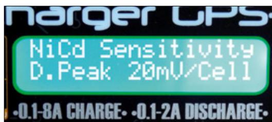
Das Aufladen von NiXX-Akkus erfolgt selbstverständlich mit einer sicheren Delta Peak-Abschaltung, wobei der Wert des gegen Ladeende erkannten Spannungsknicks stufenlos und getrennt nach NiMH- und NiCd-Technologie zwischen 5 und 20 Millivolt verändert werden kann
