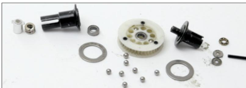
Eines der beiden Kugeldifferenziale in zerlegtem Zustand. Es ist sehr gut zu bauen, stabil und funktioniert wie es soll. Verschleiß war nach dem Test nicht zu sehen
