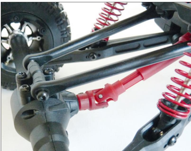
Die Teleskopkardanwelle der Hinterachse ist aus faserverstärktem Kunststoff gefertigt und sehr solide ausgeführt. Die Spielarmut der Aufhängung führt zudem zu einem sehr agil und direkt reagierenden Modell – ideal für feinfühliges Rangieren im Gelände
