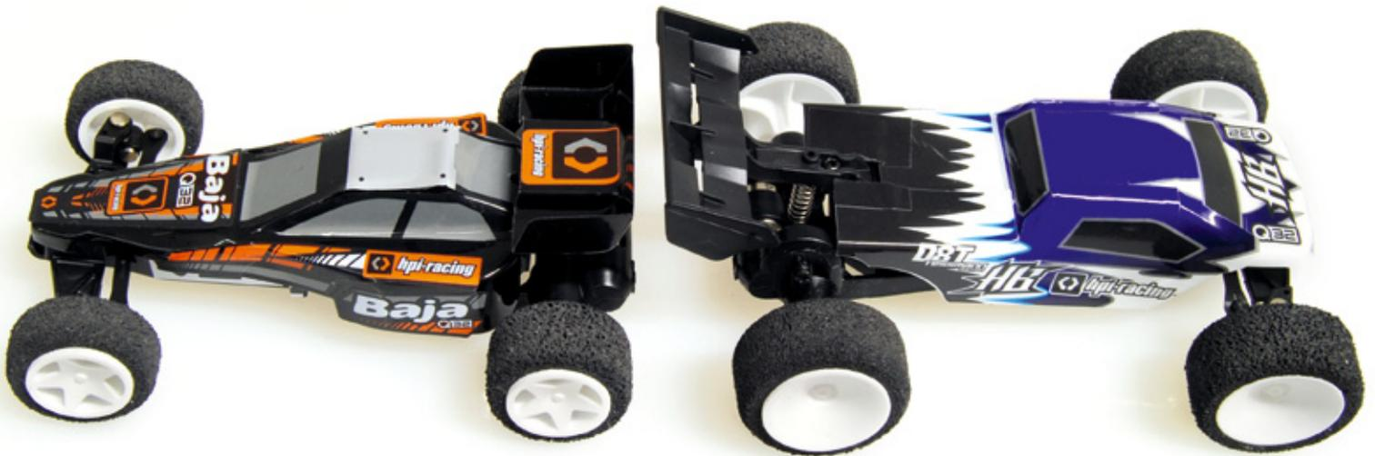
Während bei der Baja-Variante (links) der Spoiler aus weichem Kunststoff besteht und mit der Hinterachse abschließt, ragt das um einiges festere Exemplar beim Truggy deutlich über das Modell heraus
