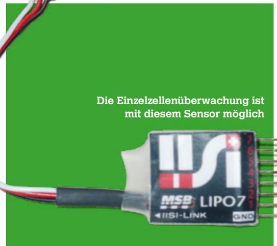
Die Einzelzellenüberwachung ist mit diesem Sensor möglich
