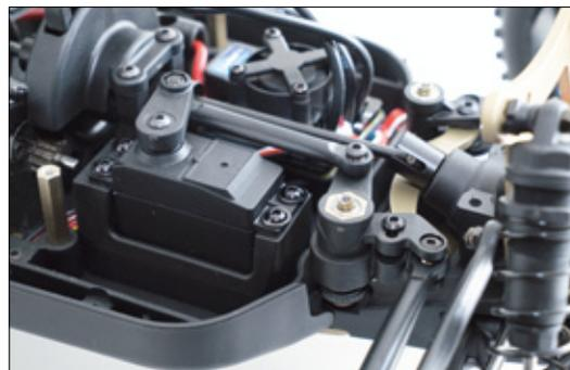
Das No-Name-Lenkservo bewegt die Räder über eine kugelgelagerte Zweiposten-Lenkung
