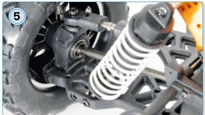
Sowohl an der Vorder- als auch an der Hinterachse ist der Crosse Brushless mit CVD-Wellen ausgestattet
