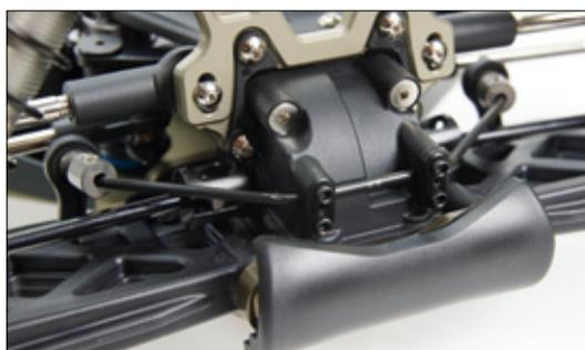
Stabilisatoren an beiden Achsen sind Standard beim TLR-Truggy. Sie liegen dem Kit in verschiedenen Stärken bei. Die vordere Aufnahme der Querlenkerstifte wird zudem noch durch einen kleinen aber effektiven Frontbumper geschützt
