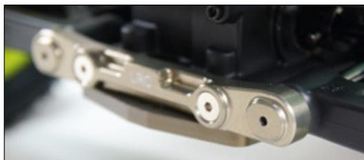
An beiden Achsen lassen sich Anti-Squat, Spur, Kickup und Nachlauf unter Zuhilfenahme von kleinen Kunststoffeinsätzen einstellen. Durch die kleinen Löcher in den hochwertigen Haltern lassen sie sich ganz einfach herausdrücken
