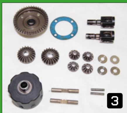
3 Im nächsten Schritt sind alle Einzelteile und mögliche Beschädigungen und Verschleiß zu kontrollieren. Speziell bei den verschiedenen Zahnradern ist ein sehr gewissenhaftes Vorgehen gefragt. Kleine Brüche oder Absplitterungen sind leicht zu übersehen, können aber rasch zu größeren
