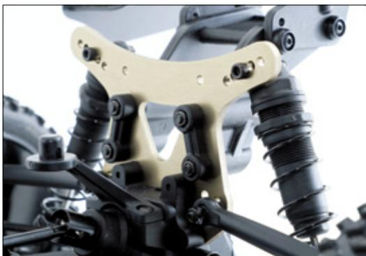
Eines der wenigen Aluminium-Teile am Desertwolf sind die Dämpferbrücken
