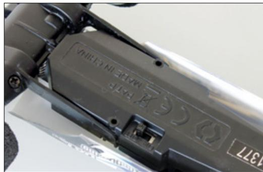
Bei beiden Modellen befindet sich der Ein-aus-Schalter auf der Chassis-Unterseite
