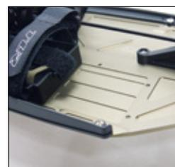
Auf der Chassisplatte lässt sich der Akkuhalter je nach Wunsch vorne oder hinten platzieren. Hier hätte Losi die vorhandenen Löcher für eine Aufnahmeplatte des Reglers nutzen können
