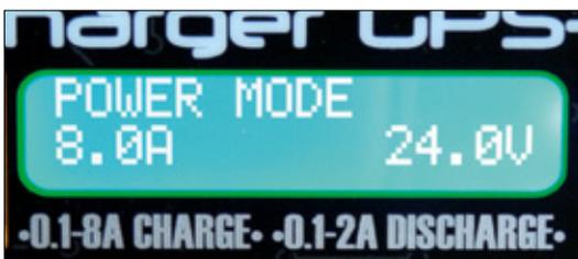
Erstaunlicherweise beherrscht das Gerät sogar einen Netzteilmodus und kann innerhalb der 80-Watt-Grenze maximal 8 Ampere oder bis zu 24 Volt Gleichstrom ausgeben, um Geräte mit Strom versorgen zu können
