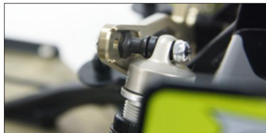
Um den Winkel der Dämpfer zu verändern, braucht man nur noch ein einziges Werkzeug. Die Gegenseite wird von der Dämpferbrücke gegen Verdrehen gesichert
