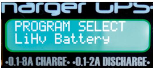
Die neueste Akkutechnik wird bereits vom GPS-1 unterstützt, denn im LiHV-Modus können die Akkus mit einer höheren Ladespannung von 4,3 Volt pro Zelle aufgeladen werden
