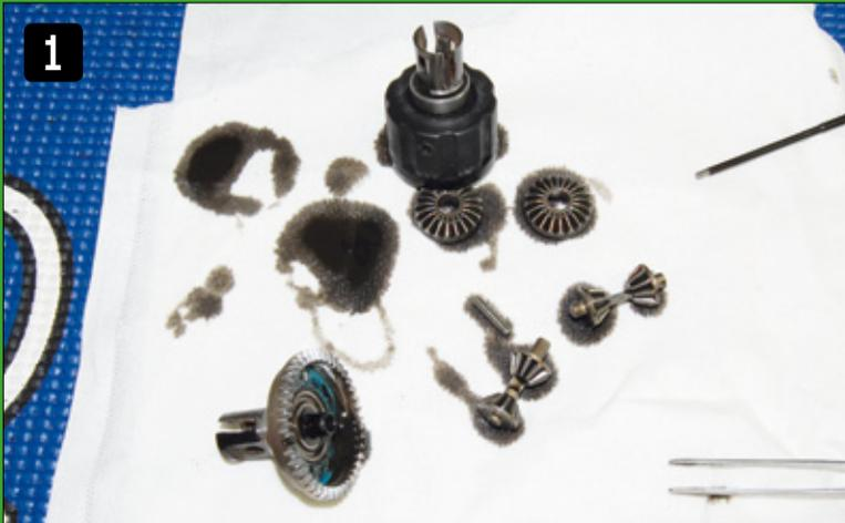
1 Ist es Zeit für eine Wartung, wird das Differential in seine Bestandteile zerlegt und das alte Silikonöl abgelassen.
