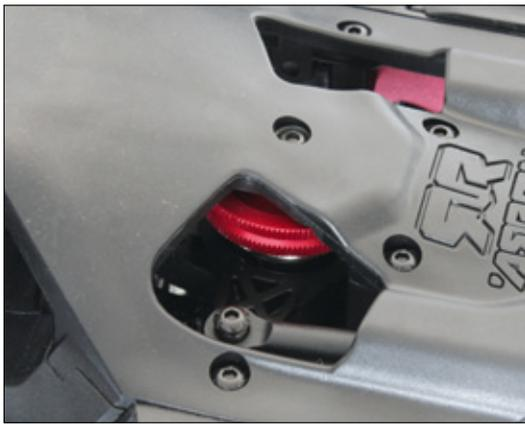
Im zentralen Lenkhebel ist ein Servosaver integriert, dessen Vorspannung sich über die von unten gut zugängliche Rändelmutter verstellen lässt
