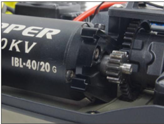
Der überaus robuste Motorhalter aus fettem Aluminium hat den großen Brushlessmotor fest im Griff. Das Zahnflankenspiel lässt sich ganz einfach durch das Lösen einer einzigen Schraube und Verschiebung der Platte realisieren
