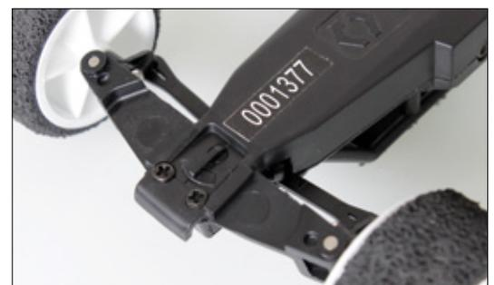
Neben den Trimmungen am Sender kann man die Lenkung mechanisch über dieses Element feinjustieren
