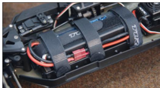
Etwas umständlich ist die Befestigung der Akkus mit vier Klettbindern. Man muss erst alle drei oberen Klettbinden komplett öffnen, um an das unterste zu gelangen
