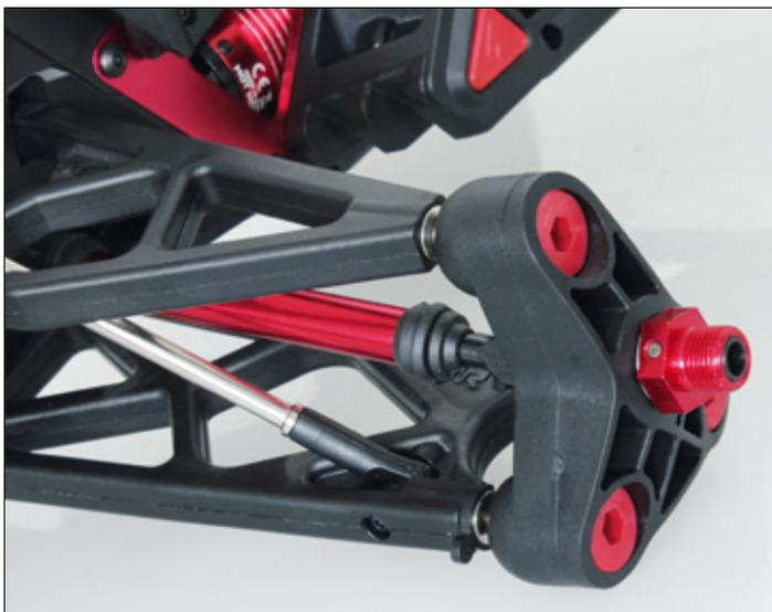
Auch an der Hinterachse erlaubt Pivot-Ball-Aufhängungen eine Einstellung von Spur und Sturz
