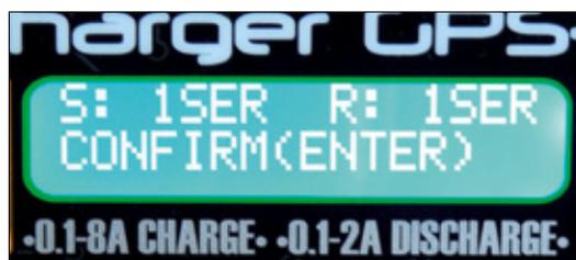
Vor jedem Ladestart fragt das Gerät den Nutzer nach der angeschlossenen Zellenzahl. Sind gemessene und reale Zellenzahl unterschiedlich, kann hier noch der Ladevorgang abgebrochen werden, bevor es zu ernstern Schäden kommt
