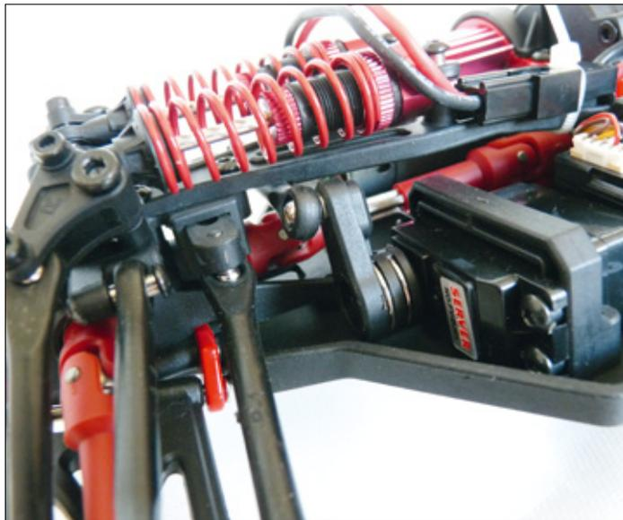
Die Lenkung basiert auf einem Schiebemechanismus und das Servo wird sogar mit einem Saver vor allzu harten Belastungen geschützt. Sehr gut sind auch die verhältnismäßig bullig dimensionierten roten Kardanwellen zu den Rädern und dem Mittelgetriebe zu erkennen
