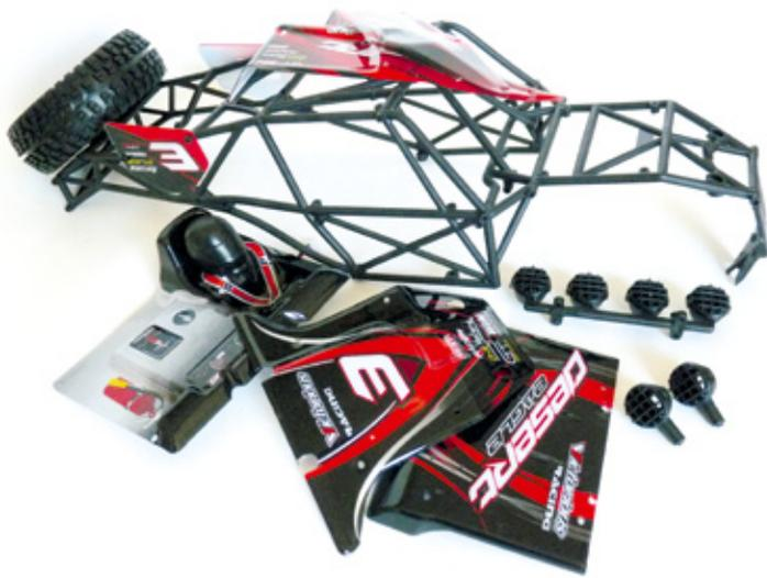
Die plattenähnlichen Teile der aus etlichen Einzelteilen zusammengesetzten Karosserie sind werkseitig noch mit Schutzfolien versehen. Die dadurch notwendige Demontage der optisch toll anzusehenden Karosserie ist allerdings etwas fummelig
