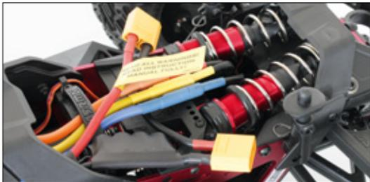
Über XT-90-Stecker werden zwei 2s- oder zwei 3s-LiPos mit dem Regler verbunden. Die entsprechenden Gegenstücke zum Verlöten an den Akkus liegen dem Set bei
