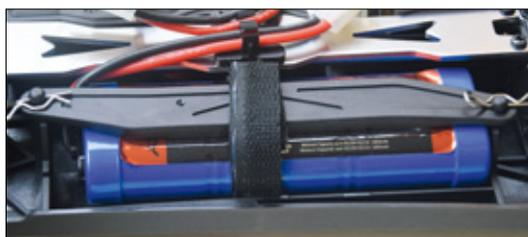
Der NiMH-Antriebsakku wird zusätzlich mit einem Klettband gesichert
