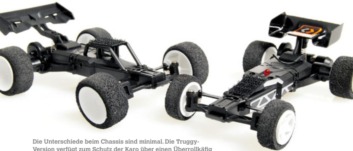
Die Unterschiede beim Chassis sind minimal. Die Truggy-Version verfügt zum Schutz der Karo über einen Überrollkäfig
