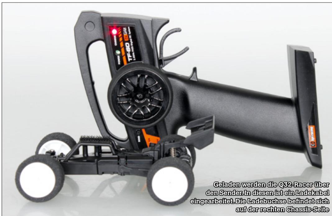
Geladen werden die Q32-Racer über den Sender. In diesen ist ein Ladekabel eingearbeitet. Die Ladebuchse befindet sich auf der rechten Chassis-Seite
