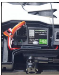
Der kleine 2,4-Gigahertz-Empfänger ist in einer spritzwassergeschützten Box platziert
