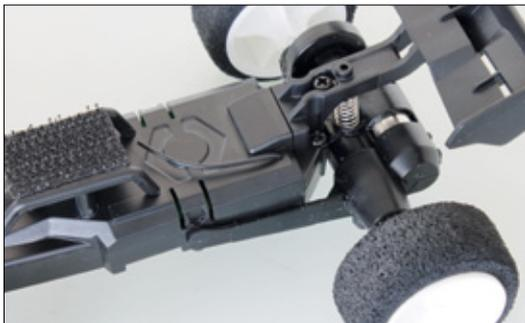
Die Hinterachse ist über Längslenker mit dem Chassis verbunden. Für die Dämpfung sorgt eine kleine Spiralfeder
