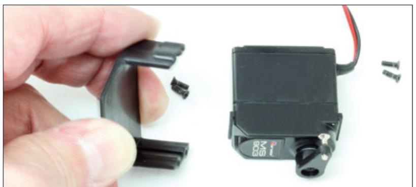
Die vorgesehene Montage des Servos: Halteösen absägen bis auf einen Millimeter. Servohalter von oben drauf stecken und im Chassis mit vier Schrauben von unten montieren
