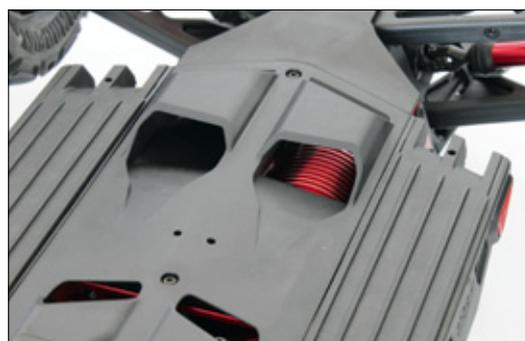
Über Kühlöffnungen auf der Chassis-Unterseite gelangt Kühlluft direkt zum Motor
