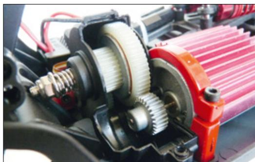
Eine saubere Sache ist die Verwendung einer von außen einstellbaren Rutschkupplung und der Einsatz sehr breiter Zahnräder. Da an allen relevanten Stellen zudem Kugellager verbaut wurden, kann man sehr lange Spaß mit dem Modell haben
