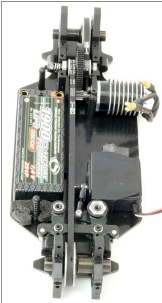
So sieht der Riemenantrieb ohne Topdeck und Achsen aus. Der LiPo passt perfekt ins Chassis, wenn man vorne und hinten Schaumstoff auf die Chassisplatte klebt
