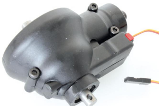
Das Differenzial sitzt samt Triebbling und Sperrmechanik in einem eigenen Gehäuse
