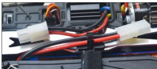
Selbst die Kabel sind sauber verlegt und sicher befestigt
