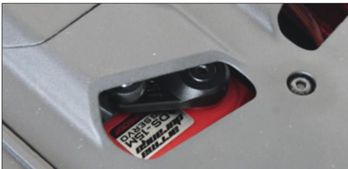
Das ADS-15M Servo hat mit 15 Kilogramm genügend Stellkraft und ist wasserdicht
