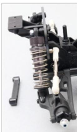
Die Hinterachse von der Seite. Auch hier wie bei der Vorderachse: Alles sehr robust und spielfrei. Links im Bild ist ein zusätzlicher Spurblock zu sehen, der dem Set beiliegt
