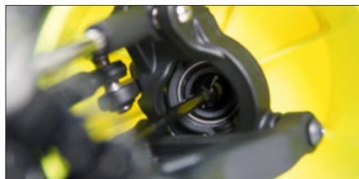
Die CVD-Wellen an der Vorderachse laufen in riesigen Kugellagern. Die simple C-Hub Technik ist beim Losi sehr robust ausgeführt
