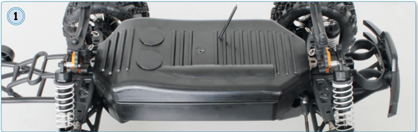
Ein besonderes Feature ist der robuste Staubschutzdeckel, der unter der Karosserie platziert ist. Lüftungsschlitze sorgen für einen Luftaustausch
