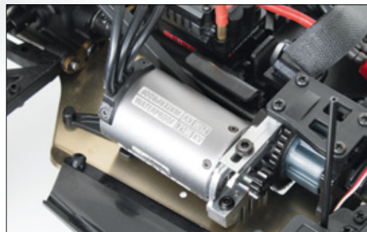
Der Neon 8-Motor von Team Orion hat 10-Turns und verfügt über eine spezifische Drehzahl von 2.100 kv
