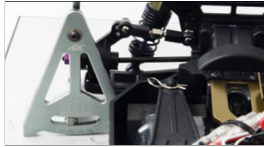
An der Hinterachse ist viel Sturz eingestellt. Dieser lässt sich aber verändern, sodass man das Fahrverhalten an die Streckenverhältnisse und die persönlichen Vorlieben anpassen kann
