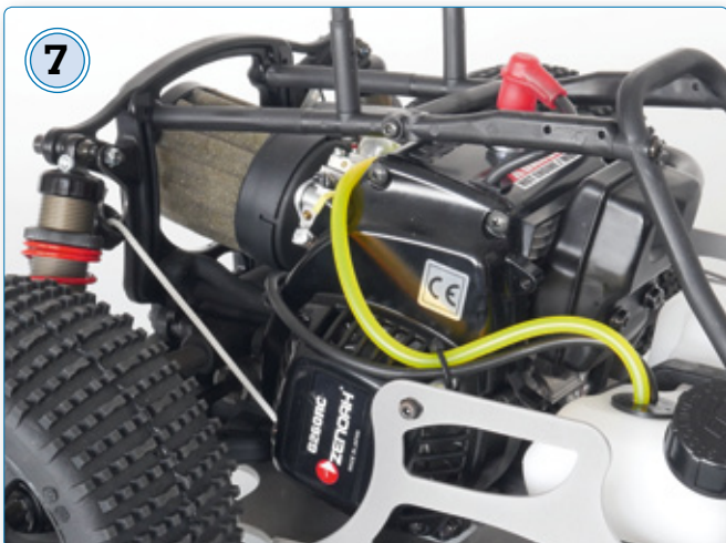
7 Der 26-Kubikzentimeter-Benzinmotor arbeitet nach dem Zweitaktprinzip und ist bei der ARTR-Variante fertig montiert
