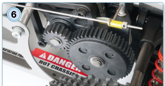
6 Der Motor überträgt seine Kraft auf ein großes Kunststoffzahnrad. Die Kombination ist zu Beginn noch etwas schwergängig
