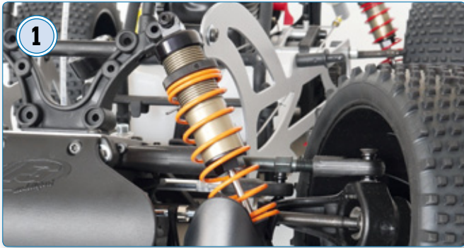
1 Die Aluminium-Öldruckstoßdämpfer stammen von den FG-Wettbewerbs-Offroadern ab und sorgen für ein ruhiges Fahrverhalten
