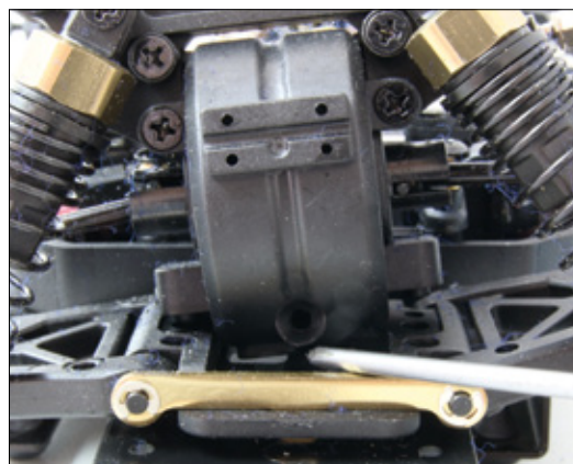
Das Getriebegehäuse muss los geschraubt werden, um die untere Schraube des Deckels entfernen zu können, wenn man das Differenzial ausbauen möchte
