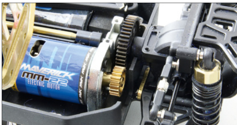
Hier sind Hauptzahnrad und Ritzel zu sehen, wenn der Schutz abgeschraubt ist
