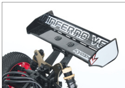
Der Heckspoiler ist ordentlich dimensioniert und sorgt für Anpressdruck auf der Hinterachse
