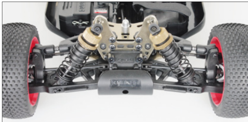
Die solide Vorderachse: Eine bewährte Doppelquerlenker-Konstruktion mit Öldruckstoßdämpfern
