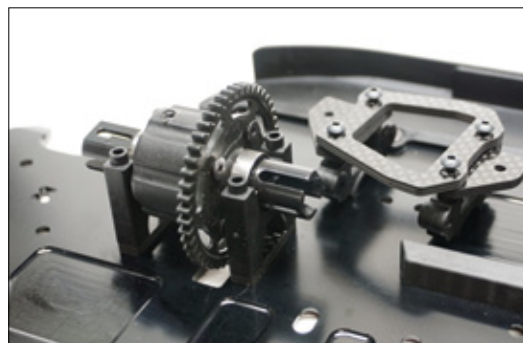
Die Lagerböcke des Mitteldifferenzials sind geteilt, das erleichtert die Wartung sowie Änderungen in Bezug auf die Viskosität des Öls
