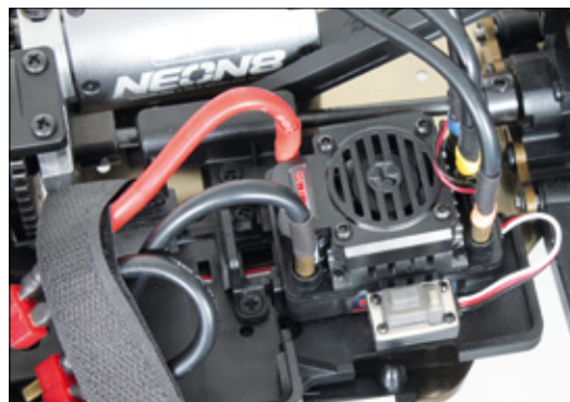
Mit 120 Ampere ist der Vortex R8-Regler dauerhaft belastbar. Er kann natürlich programmiert werden
