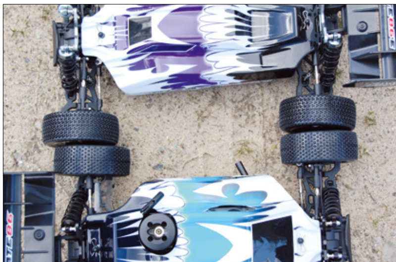
Gut erkennbar ist der größere Radstand des Elos. Tendenziell ist er damit stabiler beim Geradeauslauf, während sich der kürzere Nitro enger um Kurven steuern lässt
