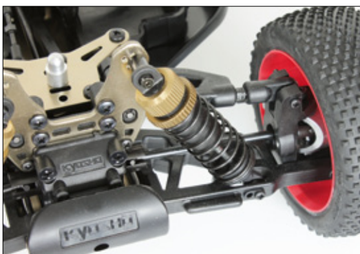
Durch die Rändelschrauben lässt sich die Federvorspannung der Big-Bore-Dämpfer stufenlos einstellen
