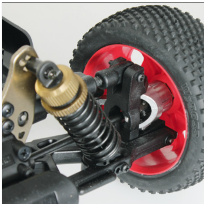
An der Vorderachse übernehmen CVD-Wellen die Übertragung der Motorkraft an Radachsen und Räder
