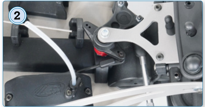
2 Der zentrale Servosaver wird von einem Jumbo-Servo bedient, das in dieser Ausstattungsvariante noch selbst beizusteuern ist
