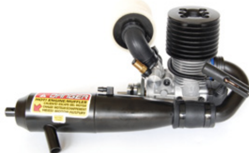
Mit seinen 3,5 Kubikzentimeter Hubraum sorgt der Zweitakter des Nitro-8.6ers für ordentlich Dampf in der Hütte. Das obligatorische Resonanzrohr optimiert die Leistungsgewinnung zusätzlich
