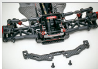
Extrem flache 3-Millimeter-Kohlefaserbrücken wurden dem Fahrzeug für einen niedrigen Schwerpunkt spendiert
