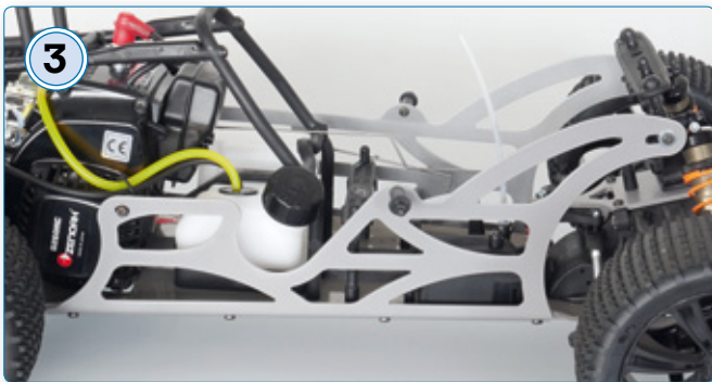
3 Die großen Seitenplatten sorgen für mehr Steifigkeit des Chassis und stützen die gesamte Vorderachse ab
