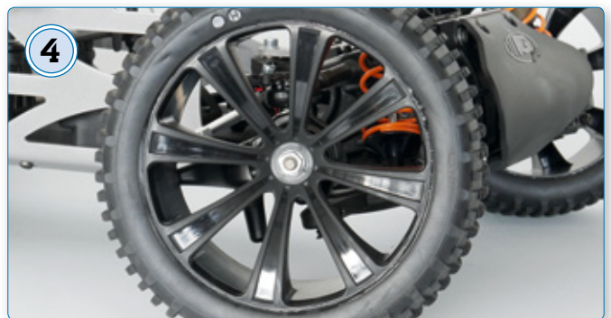
4 Die großen Achtspeichen-Felgen sind mit Truggy-Reifen bestückt und sauber verklebt
