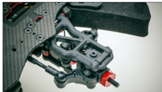
Blick auf die vordere Aufhängung. Die unteren Querlenker können auf beiden Seiten eingesetzt werden
