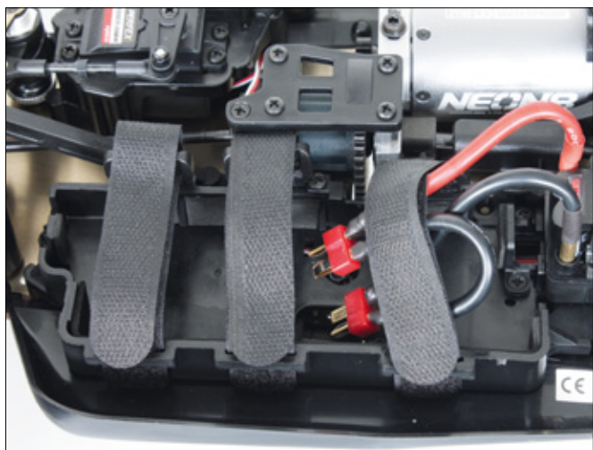
Im Akkusacht finden zwei 2s-LiPos oder zwei sechszellige NiMH-Packs Platz. Die Befestigung ist etwas fummelig
