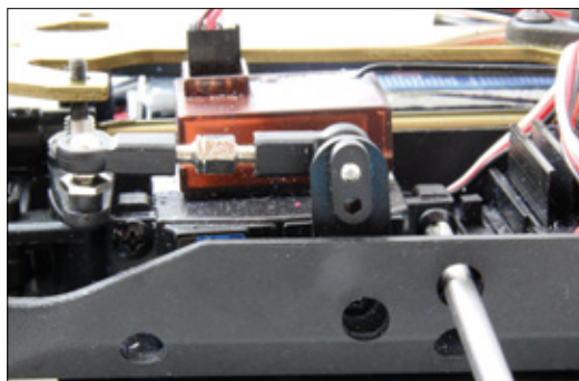
Die Löcher in der Seite der Chassiswanne erlauben es, ohne Umstände das Servo und auch den Servoarm abzuschrauben oder nachzuziehen
