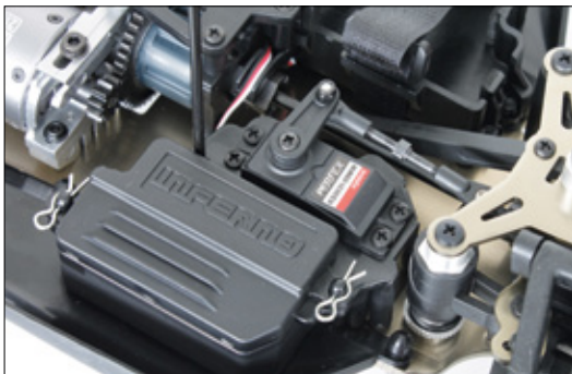
Ein wasserdichtes Perfex-Servo des Typs KS5013-09MW sorgt für die kraftvolle Umsetzung der Lenkbefehle. Daneben sitzt die vergleichsweise große RC-Box
