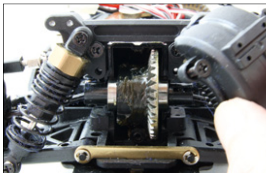
Der Getriebedeckel ist abgeschraubt und das Differenzial kommt zum Vorschein
