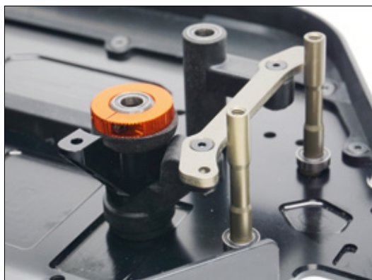
Lightweight-Lenkpfosten, Kugellager, Servo-Saver-Arm aus Alu und Einstellmutter mit Arretierung – das sind die Zutaten der Trapez-Lenkung
