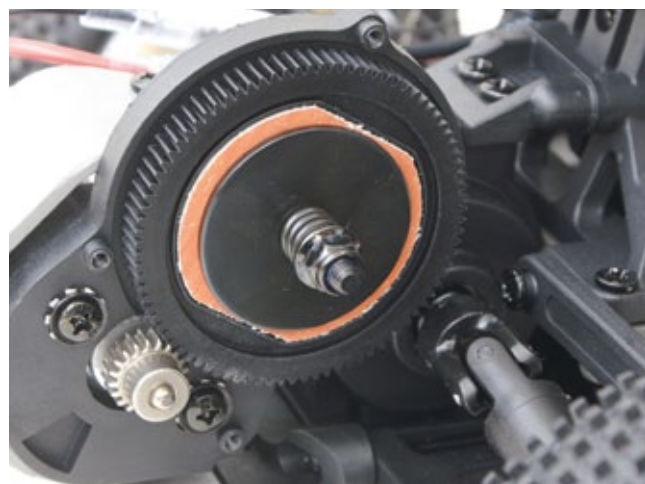
Schön zu sehen: der einstellbare Slipper, der die Getriebekomponenten vor Belastungsspitzen schützen soll
