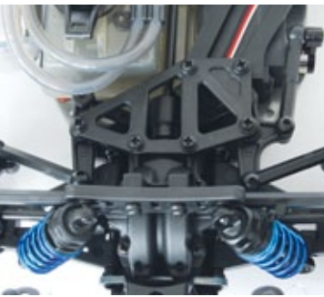
Die Lenkmechanik des Tomahawk VX funktioniert nahezu spielfrei
