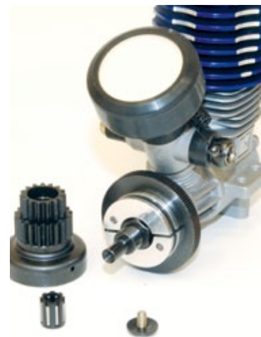
Die Zweibackenkupplung mit umlaufender Feder und ein Nadellager gehören schon zu den betagteren Systemen, funktioniert aber tadellos
