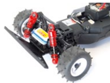
Die Achsen des Buggys sind solide ausgeführt und basieren auf Doppelquerlenkern und Öldruckstoßdämpfern
