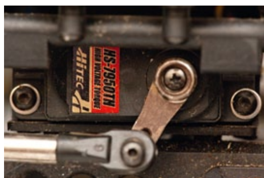
Das Hitec 7950 sorgt für ordentlich Druck am Lenkgestänge
