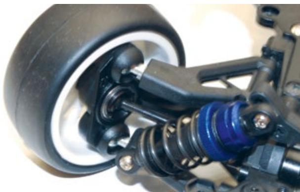
Leider keine CVD-Wellen an der Vorderachse aber immerhin ist alles kugelgelagert
