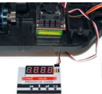
Mit der optionalen Programmierkarte ist das Regler-Setup einfach zu bewerkstelligen
