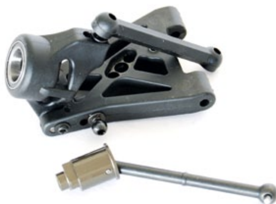
Vorbildlicherweise sind an Vorder- und Hinterachse Antriebswellen in CVD-Auslegung verbaut
