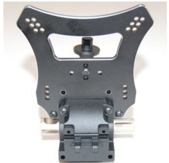
Die vordere Dämpferbrücke aus Alu bietet reichlich Möglichkeiten, den BR-5 an die Streckenverhältnisse anzupassen
