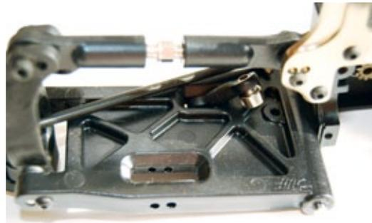
**Die Querlenker sind komplett geschlossen und extrem stabil**
