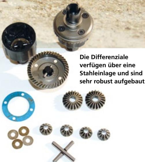
**Die Differenziale verfügen über eine Stahleinlage und sind sehr robust aufgebaut**
