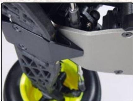
Im Aluchassis ist ein Kickup von 30 Grad vorgegeben. Mittels Kunststoffblöcken lässt sich der Winkel verringern
