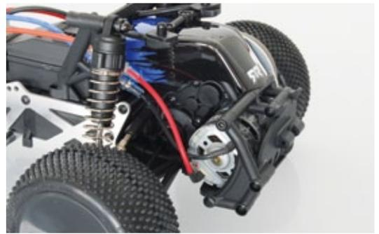
Die Motor-Getriebe-Einheit ist an der Hinterachse verbaut. Die Kraftübertragung zu den Rädern erfolgt über Knochenwellen. Beim Antriebsmotor handelt es sich um ein 15-Turns-Bürstenaggregat in 550er-Baugröße
