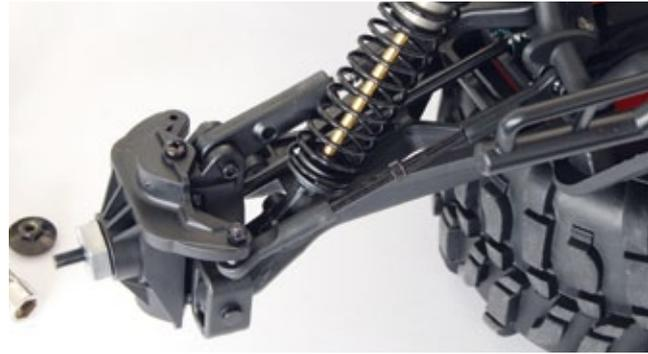
Die massiven C-Hub-Querlenker an Vorder- und Hinterachse sind fast unzerstörbar. Gleiches gilt für die fetten Querlenker
