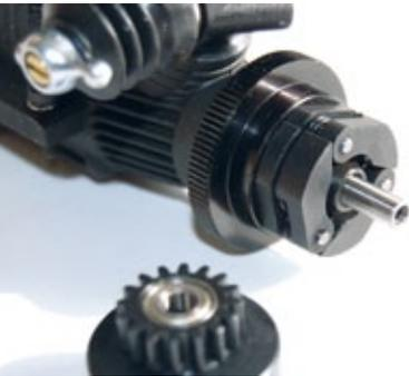
Die Dreibacken-Racing-Kupplung sorgt für einen ordentlichen Kraftschluss mit der Kupplungsglocke
