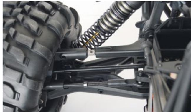
Sturz und Spur lassen sich an beiden Achsen stufenlos über Rechts-links-Gewinde einstellen
