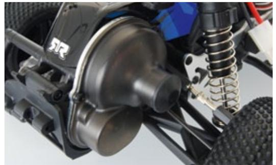
Das Getriebe ist komplett gekapselt. Auf diese Weise sind die Innereien vor eindringendem Schmutz geschützt. An der Hinterachse sind die oberen Querlenker zudem als Gewindestangen ausgeführt
