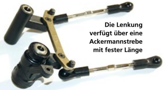
Die Lenkung verfügt über eine Ackermannstrebe mit fester Länge
