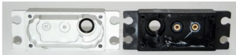
Die Wellenführungen der 700er-Servos wurden mit Messingbuchsen verstärkt. Bei der Aluminium-Abdeckung der 1000er-Serie kann darauf verzichtet werden
