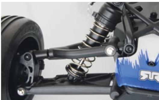
An der Vorderachse sind die oberen Querlenker gabelförmig ausgelegt. Die Dämpfer werden hindurchgeführt
