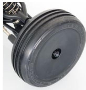
Während an der Hinterachse breite, genoppte Reifen zum Einsatz kommen, sind vorne längsgerillte dBoots Multi-Ribbed-Pneus verbaut
