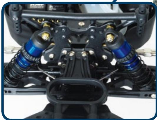
Aluminium-Big-Bore-Dämpfer sorgen für ausgewogene Fahreigenschaften und eine gute Federung im Gelände
