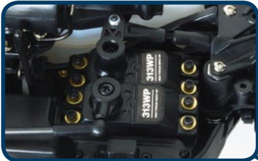
Zwei schnelle und stellstarke 313WP-High-Torque-Servos sind für die Umsetzung der Lenk- beziehungsweise Gas-Brems-Befehle zuständig
