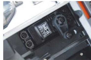
Das schnelle Lenkservo SB-5 hat eine Stellkraft von knapp 12 Kilogramm pro Zentimeter
