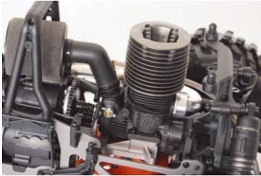
Alter Bekannter: Der 4,6-Kubikzentimeter-Nitromotor wird per Roto-Start-System angelassen
