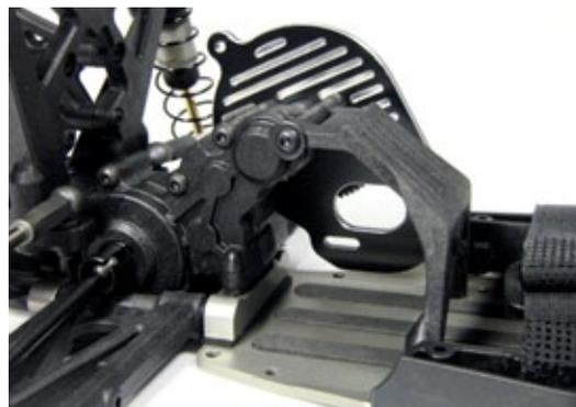
Bei der Mittelmotorvariante bekommt der 22T ein neues Getriebe mit vier Zahnrädern im Inneren. Eine dicke Aluminiumplatte sorgt für angenehme Temperaturen des Motors
