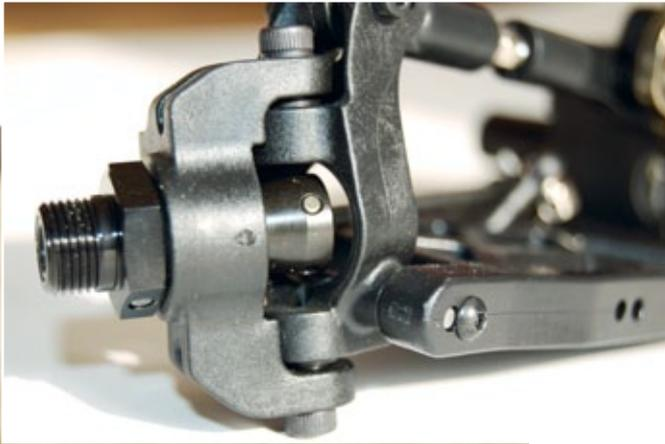
**CVD-Antriebswellen an der Vorderachse gehören zum guten Ton, selbst bei RTR-Modellen**
