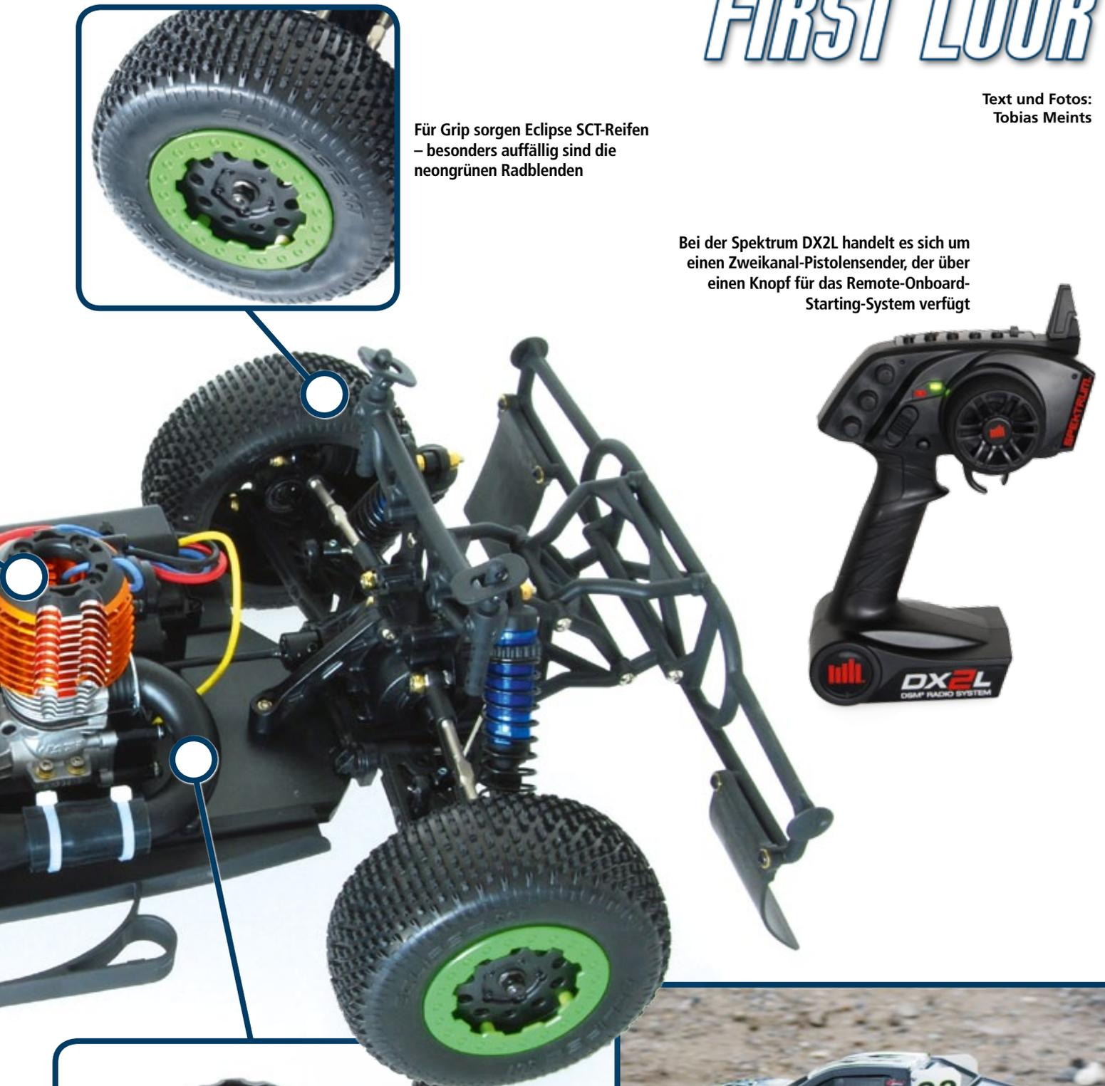
Für Vortrieb sorgt ein 3,4-Kubikzentimeter-Motor inklusive einer abgestimmten Auspuffanlage
