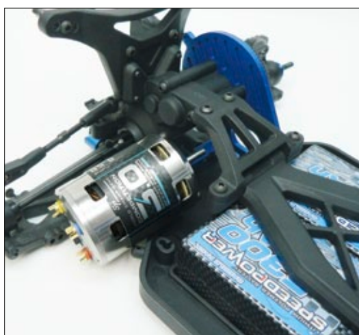
Der Motor kann leicht ausgebaut werden, dies ist bei anderen Mittelmotor-Konstruktionen teilweise schwierig
