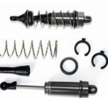
An den Öldruckstoßdämpfern kommen Kunststoff-C-Klippe zum Einstellen der Federvorspannung zum Einsatz
