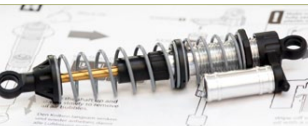
Der fertig montierte Dämpfer ist mit dem beiliegenden Öl befüllt. Hier ist auf eine korrekte Ölmenge zu achten. Erfahrungsgemäß reicht die Füllung bis zirka 6 Millimeter vor der Oberkante des Dämpferrohrs
