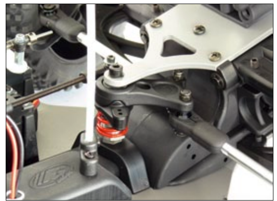
Der Servosaver ist doppelt gelagert. Charakteristisch: die rote Feder
