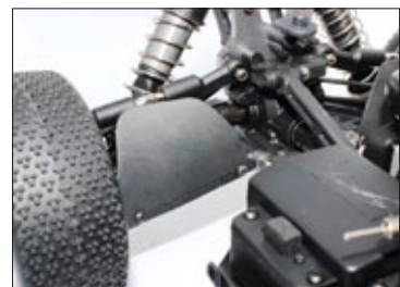
Mudguards an den hinteren Querlenkern schützen die Antriebswellen vor Schmutz
