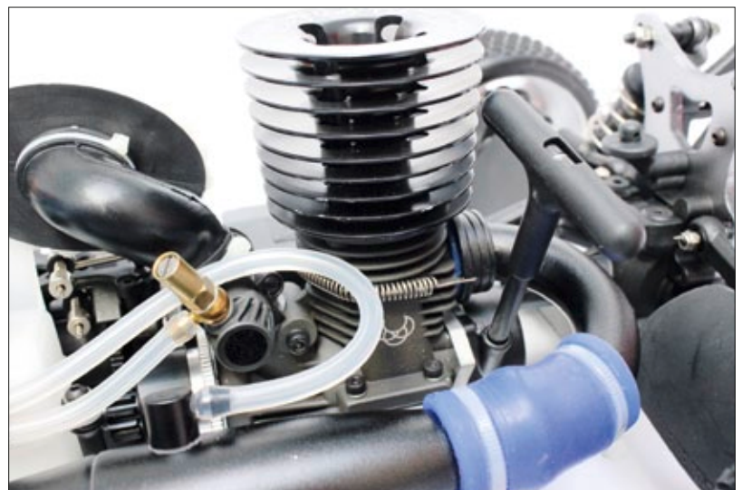
Der Motor ist werksseitig fertig eingebaut und sauber mit dem Auspuff sowie dem Tank verbunden
