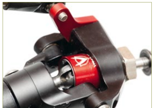
Die CVD-Wellen von Vanquish Products gehören derzeit zu den haltbarsten Bauteilen. Auch sie dürfen natürlich nicht fehlen
