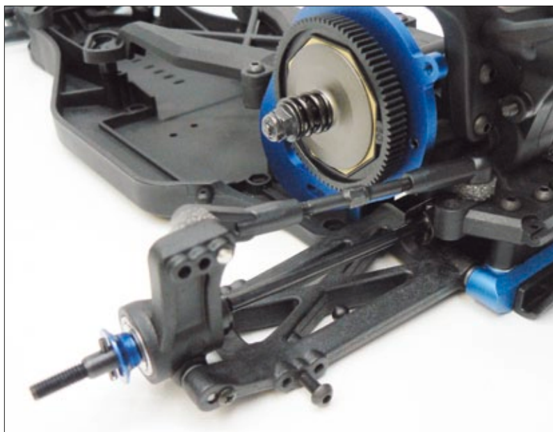
Große Reibpads, mit einem Clip gesicherte CVD-Wellen und die Verwendung von faserverstärktem Kunststoff machen zusammen mit der hervorragenden Passgenauigkeit deutlich, wohin der B-MAX2 MR möchte: auf die Rennstrecke
