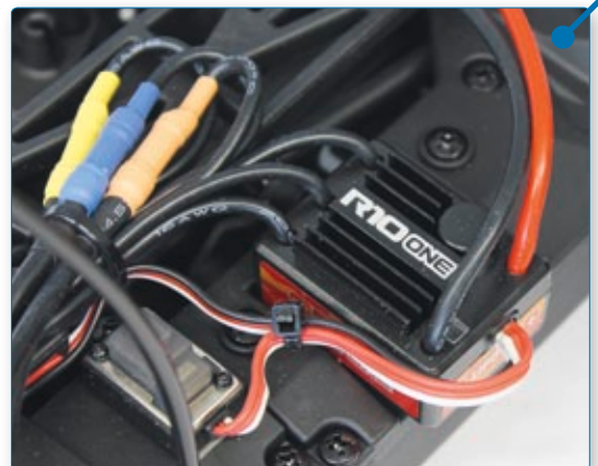
Der R10 One-Regler ist hervorragend für den Einsatz in kleineren Offroadern geeignet, da er sehr kompakt baut und 25 Ampere Strom verträgt
