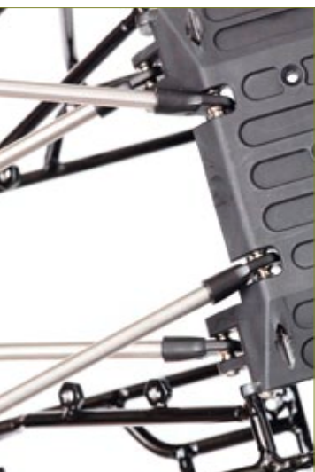
Die originalen Komponenten von Axials Wraith können verwendet werden. Bei diesem Modell kamen jedoch Titan-Links vom Crawlerkeller-Shop zum Einsatz
