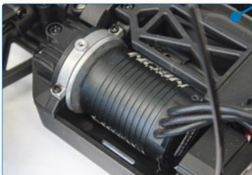
Der Neon One-Brushlessmotor hat eine spezifische Drehzahl von 2.400 Umdrehungen pro Minute und Volt. Er verfügt über ein schlichtes, mattschwarzes Alugehäuse
