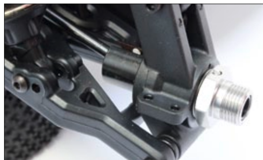
17-Millimeter-Sechskantmitnehmer an den Radachsen sind Standard bei 1:8er-Buggys
