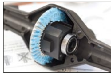
Das Tellerrad samt Fettung ist im Achsgehäuse montiert
