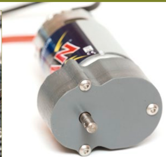
Der Motor von Traxxas an dem selbst hergestellten Vorsatz-Getriebe. Das Kunststoffgehäuse soll für einen ruhigen Lauf sorgen
