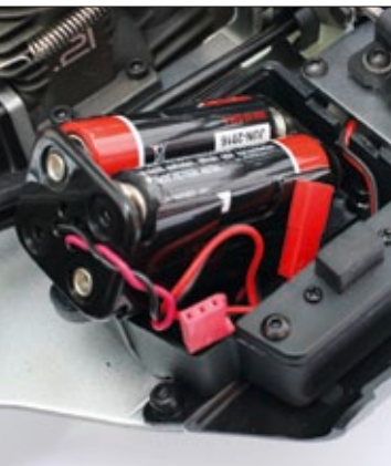
Eine Batteriebox liegt dem Modell zwar bei, doch leider passt der Anschluss nicht zum Empfänger-Kabel
