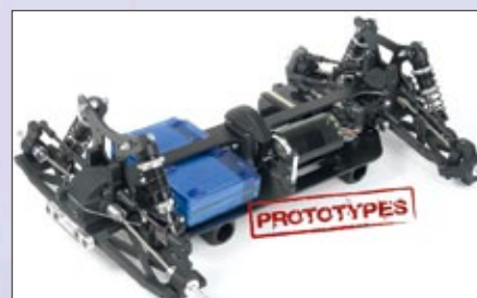
Neben ersten Tests mit gefrästen Teilen wird das Modell im Laufe der Konstruktion stetig verfeinert und immer mehr Teile werden für die Fertigung der Formen vorbereitet
