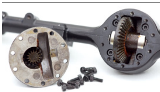
Gut zu sehen, dass die Getriebeteile zwar gefettet sind aber eine Nachfettung noch von Nöten ist
