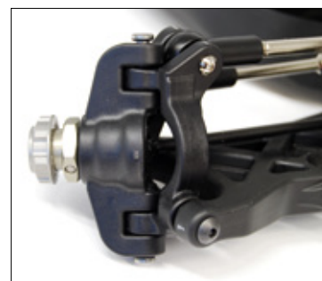
Die C-Hubs sind aus Kunststoff. Die komplette Aufhängung ist sehr spielarm
