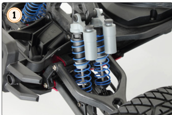
Der e-MTA G2 verfügt insgesamt über acht Öldruckstoßdämpfer. Vier pro Achse sorgen für eine gute Federung im Gelände
