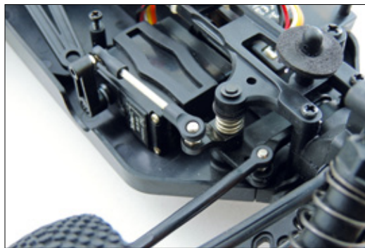
Ein relativ harter Servosaver sorgt für Schutz und gute Lenkpräzision
