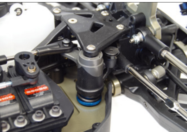
Ebenfalls neu bei der Version 3.0: Der obere Teil des Servosavers besteht aus Alu
