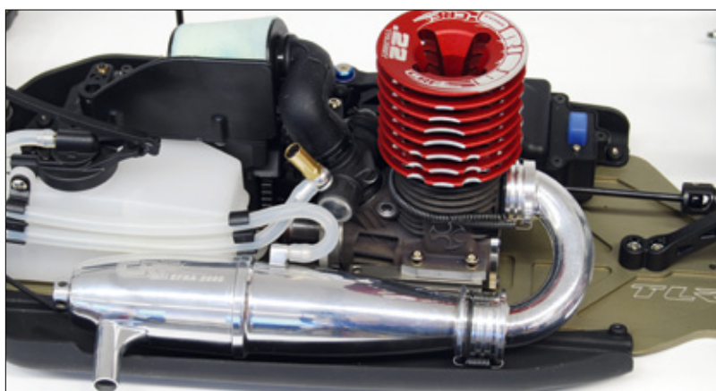
Ein 3,6-Kubikzentimeter-Motor mit entsprechender Auspuff-Anlage sorgt für Vortrieb
