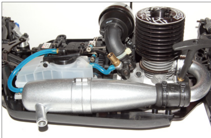
Kyoshos KE21R-Triebwerk und das Resonanzrohr bilden ein kraftvolles Duo
