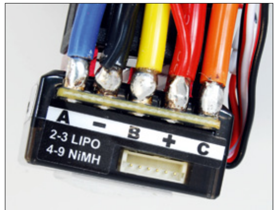
Beim 10BL60-Regler ist der Anschluss für Sensorkabel seitlich am Gehäuse platziert. In Modellen mit einem geringen Platzangebot kann dies zu einem Problem werden
