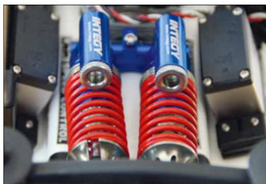
Die Integy-Öldruckstoßdämpfer mit Piggy-Back-Reservoir verbessern das Fahrverhalten spürbar
