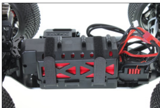
Der Schutzkäfig um die LiPos konnte im Test voll überzeugen
