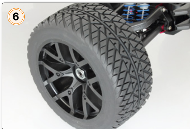
Auf den groß-dimensionalen Felgen sind Straßenreifen mit asymmetrischem Profil verklebt
