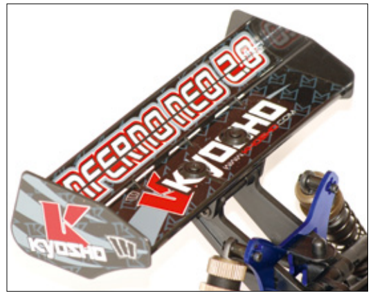
Ein großer Heckflügel sorgt für aerodynamischen Anpressdruck
