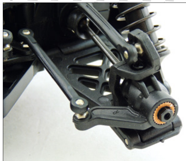
Detail der Vorderradaufhängung: Im Radträger sind leider nur Gleitlager verbaut
