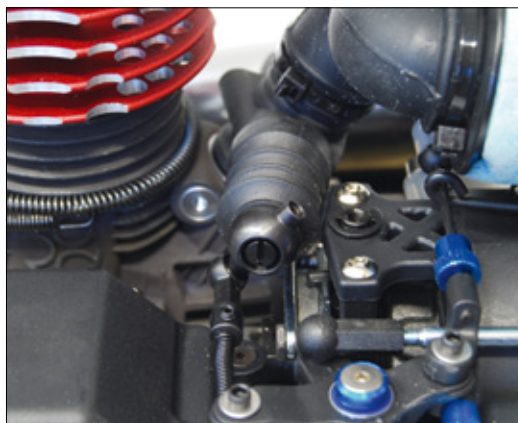
Gerade am Gas-Brems-Gestänge geht es eng zu. Das Vergaserküken musste bei diesem Motor leicht verdreht werden, damit die Drossel komplett aufgeht
