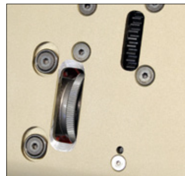
Ein kleines Manko: Damit die Startbox richtig greifen kann, musste die Chassisplatte mit einem Dremel bearbeitet werden
