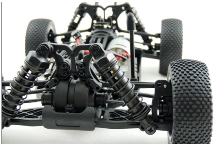
Die vordere Aufhängung: Die Federbeine verschmutzen leider schnell und benötigen regelmäßige Wartung
