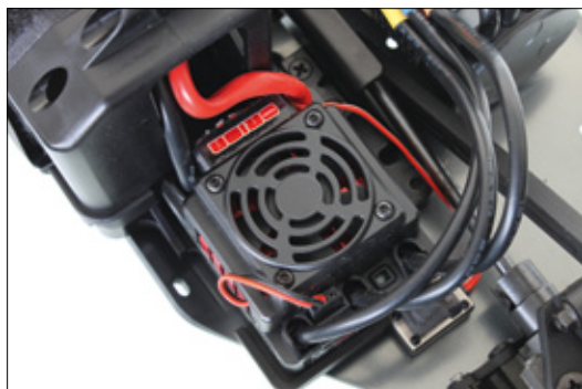
Der R8one-Fahrregler ist gut geschützt auf dem Chassis verstaut und aktiv gekühlt
