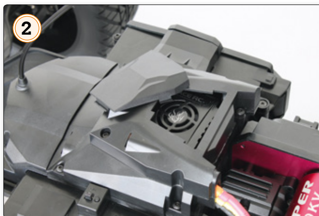
Unter dem futuristisch wirkenden Chassis-Aufbau ist der aktivgekühlte-Regler des Typs ACE RC BLC-150C platziert
