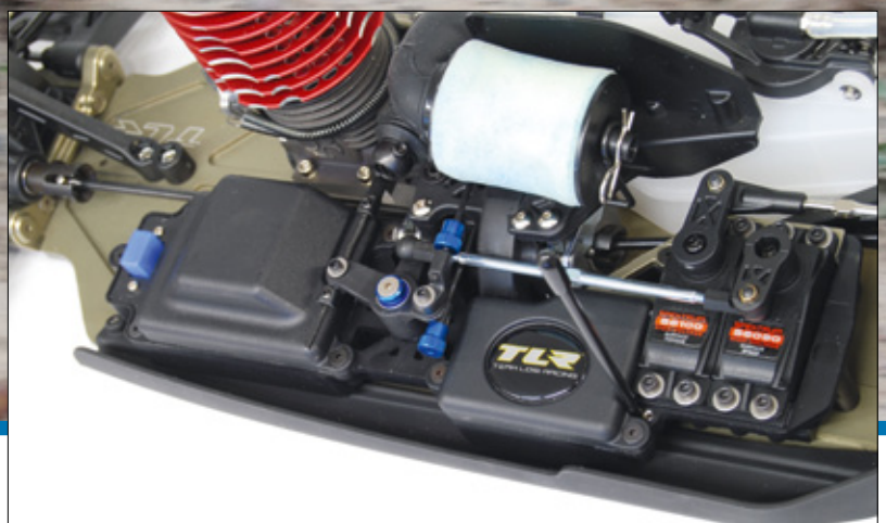
Der neue RC-Träger GEN III sorgt für eine verbesserte Gewichtsverteilung. Bemerkenswert ist die Umlenkmechanik des Gas-Brems-Gestänges, wodurch das zugehörige Servo ganz nach vorne wandern konnte
