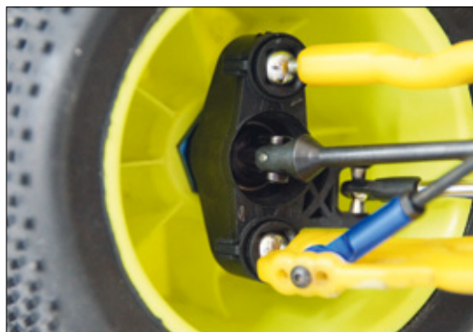
Die Stahlkardans bringen die nötige Standfestigkeit für die Power des RB-Motors mit
