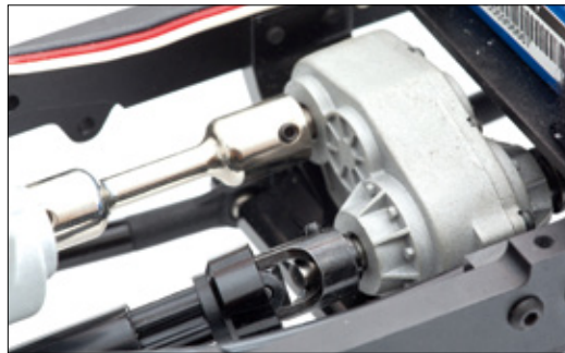
Das Verteilergetriebe ist auf einer CNC-gefrästen Platte montiert
