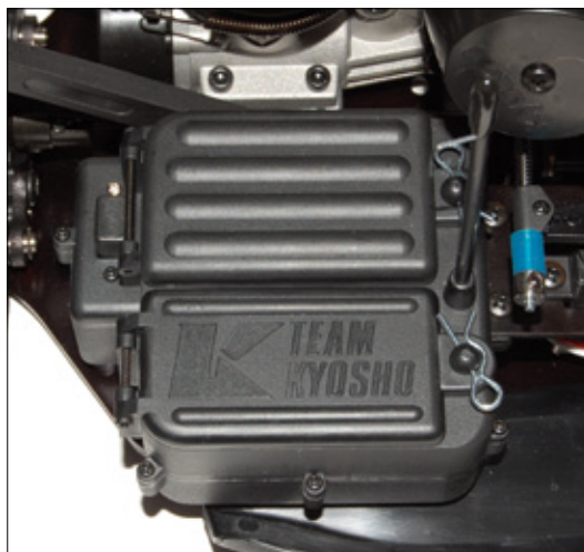
In der geräumigen Elektronikbox lassen sich alle Komponenten problemlos unterbringen
