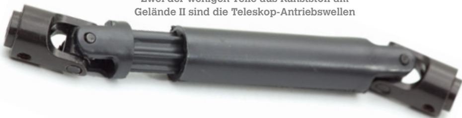
Zwei der wenigen Teile aus Kunststoff am Gelände II sind die Teleskop-Antriebswellen
